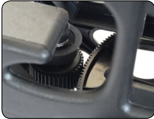
Das Zahnflankenspiel des Heckabtriebs sollte sehr genau eingestellt werden
