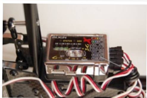
Dreh- und Angelpunkt der Super Combo ist das 3GX-Flybarless-System von Align
