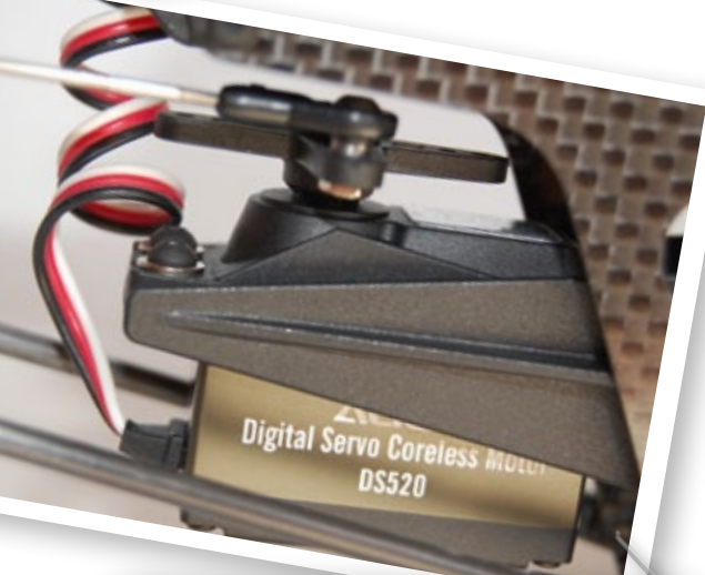
Das schnelle DS520-Heckservo sitzt nicht wie meist üblich am Heckrohr, sondern am Chassis
