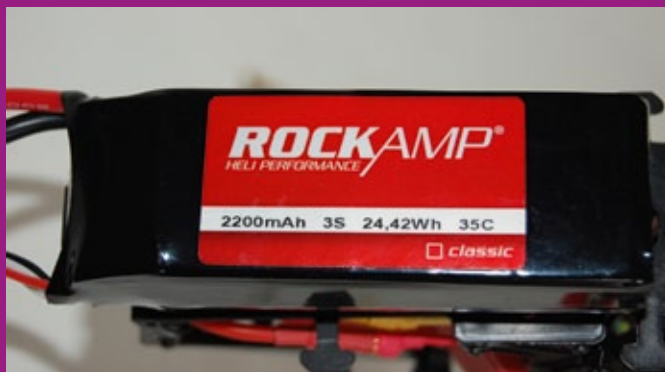
Als Stromversorger diente ein 2.200er-Rockamp-LiPo mit einer maximalen Entladerate von 35C. Das genügt bei einem gemessenen Maximalstrom von 47 Ampere locker
