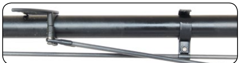
Die Stütze der Heakanlenkung hält auch, wenn die Schelle nicht so stark angeknallt wird
