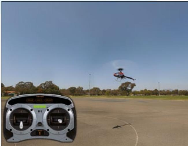
Kurz vor dem Aufsetzen lässt man den Heli flaren. Das bedeutet, mit einem Zug an Nick hebt man die Nase des Helis an. Die Fahrt wird dadurch abgebremst und in Drehzahl umgesetzt
