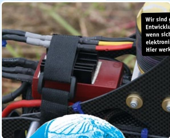
Wir sind gespannt, in welche Richtung sich die Entwicklung der Motorregler bewegen wird, wenn sich die Drehzahlregelung durch das elektronische Stabilisierungssystem durchsetzt. Hier werkelt natürlich ein Jive 120 HV
