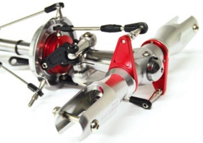
Die Hebelarme der Blatthalter können noch durch etwas kürzere Exemplare aus CFK ausgetauscht werden. Mehr Agilität soll die Folge sein – was aber überhaupt nicht nötig ist
