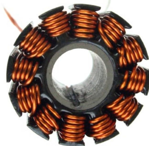
**Eine maschinell erstellte Wicklung made in Germany, wie sie zum Beispiel beim Pyro Anwendung findet. Diese Technik sieht schon wesentlich besser aus, der Füllgrad beträgt ähnlich wie bei der Multifilarwicklung knapp 10 Quadratmillimeter, aber es gelangt ordentlich Kühlluft durch den Stator**
