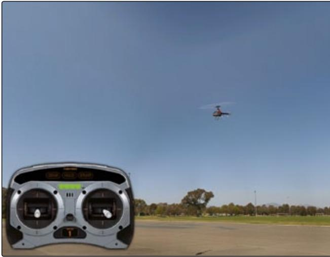
Sobald der Antrieb abgeschaltet ist, sollte der Heli gerade und das Pitch auf negativ gestellt werden
