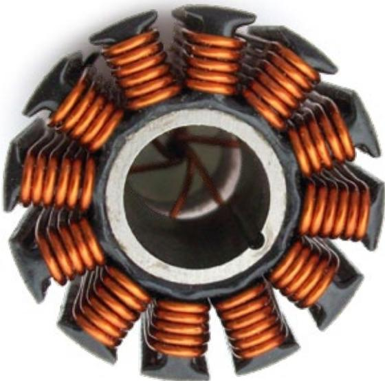
Die gleiche Wicklung wie nebenstehends Bild mit knapp 10 Quadratmillimeter, aber sauber von Hand statt maschinell gewickelt. Es würden sogar noch mehr Drähte in der ersten Lage draufpassen. Der gleiche Füllgrad wie bei den ersten zwei Bildern, doch mit noch mehr Kühlluft im Stator. Alle Drähte berühren den Stator und können so bestens Wärme ableiten
