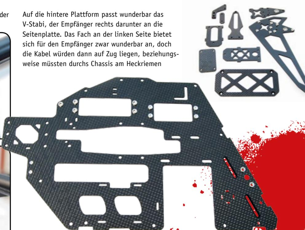
Alle CFK-Platten sind sauber gefräst sowie entgratet und besitzen teils schon Einsätze für Schrauben
