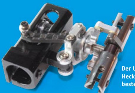
Der Umlenkhebel der Heckrotoranlenkung besteht aus CFK
