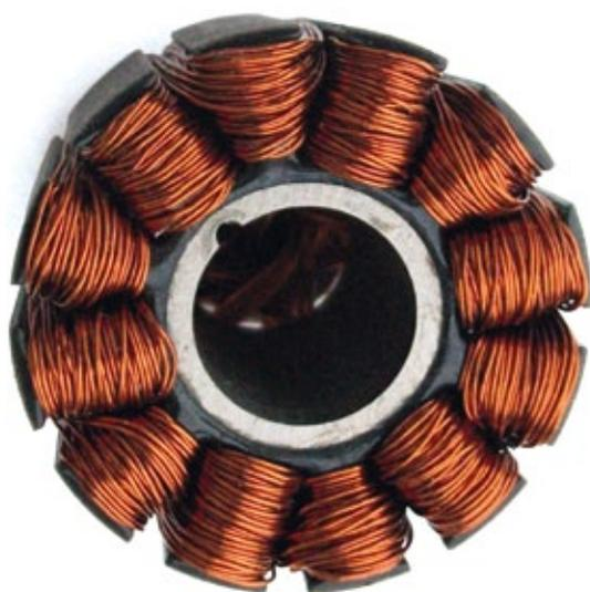
**Eine typische Multifilarwicklung: Der Füllgrad beträgt knapp 10 Quadratmillimeter pro Nut, Kühlluft kann durch diese Wicklung nicht mehr gelangen. Da diese Wicklung viellagig ausgeführt wurde, können die eingeschlossenen Drähte kaum ihre Hitze abgeben. Hier besteht erhöhte Brandgefahr bei Überbelastung**
