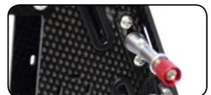
Die Sollbruchstellen an den Haubenhaltern brechen bei Überbelastung und schützen so das Chassis
