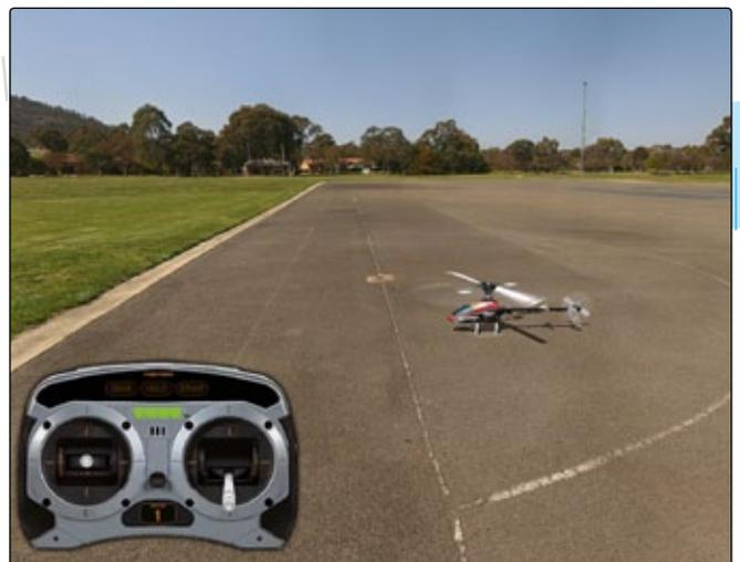
Gibt man gleichzeitig zum Aufsetzen Negativpitch, vermindert sich die Gefahr eines Umfallers
