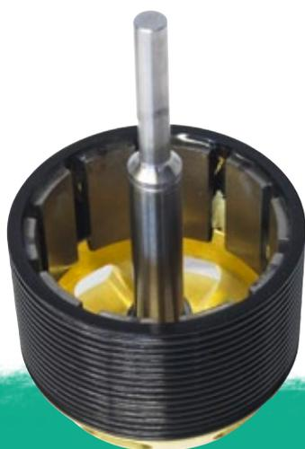
Die Welle ist im Motorinneren 10 Millimeter dick und verjüngt sich außen auf 6 Millimeter
