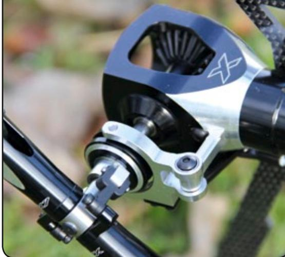
Die Scherenanlenkung greift oben und unten auf die Schiebehülse des Heckrotors ein
