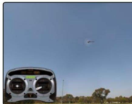
Mit einer halben Rolle gleich im Anschluss dreht man den Heli in die Normalfluglage zurück. Die Rollrichtung ist egal
