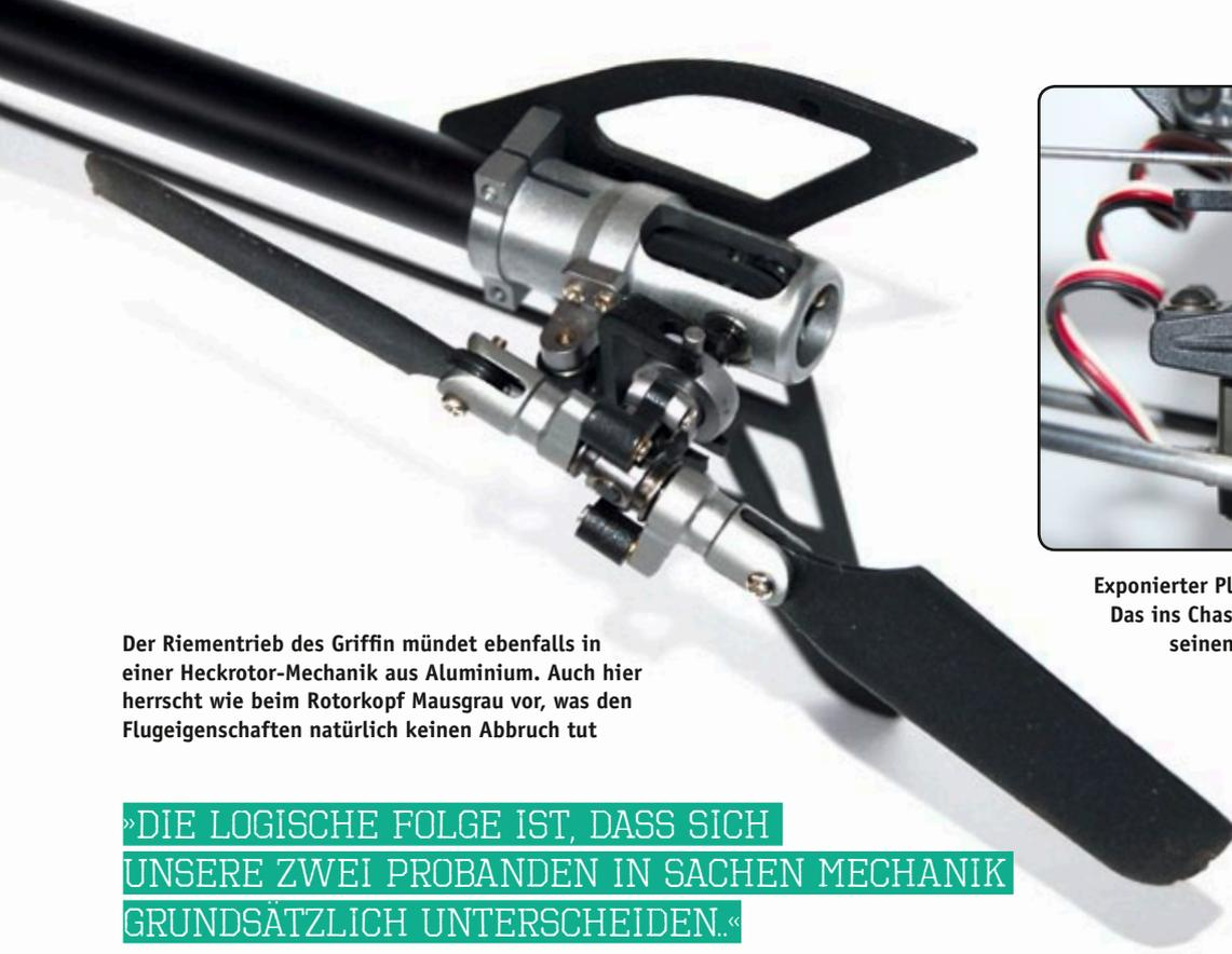
Der Riementrieb des Griffin mündet ebenfalls in einer Heckrotor-Mechanik aus Aluminium. Auch hier herrscht wie beim Rotorkopf Mausgrau vor, was den Flugeigenschaften natürlich keinen Abbruch tut
