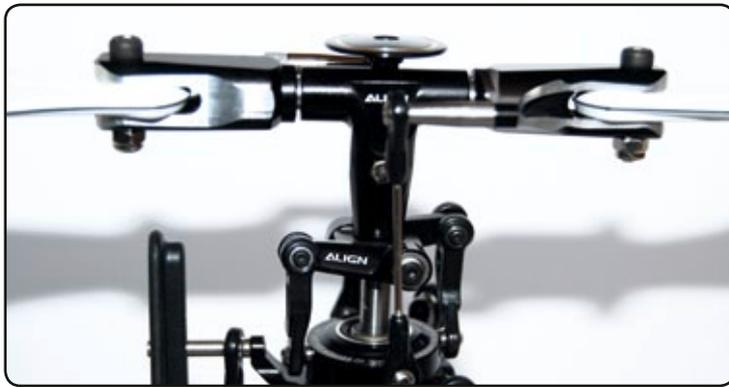
Aufgrund der Flybarless-Konstruktion ist die Anzahl der Einzelteile des Rex-Rotorkopfs sehr überschaubar. Alles, was noch übrig ist, präsentiert sich in einem technisch und optisch perfekten Finish
