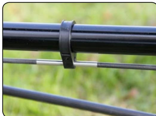
Ein im Bereich der Führung angebrachtes Aluminiumröhrchen schützt die CFK-Anlenkung der Heckrotoransteuerung vor Abnutzung
