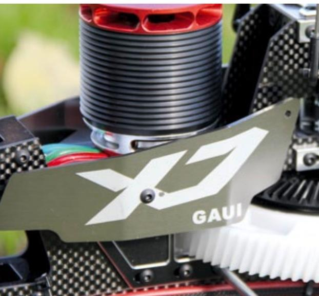
Das Aluteil mit dem X7-Schriftzug sitzt direkt auf der Motorbefestigungsplatte und fungiert als Kühlblech
