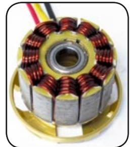
Die zwölf Nuten des Stators sind einlagig mit 1,4 Millimeter dickem Kupferlackdraht bewickelt
