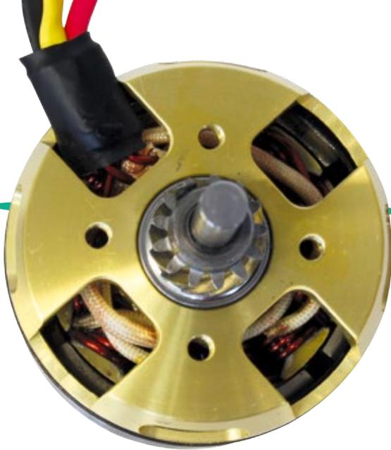
Am sehr geringen Luftspalt zwischen Magneten und Stator erkennt man einen hochwertig gefertigten Motor
