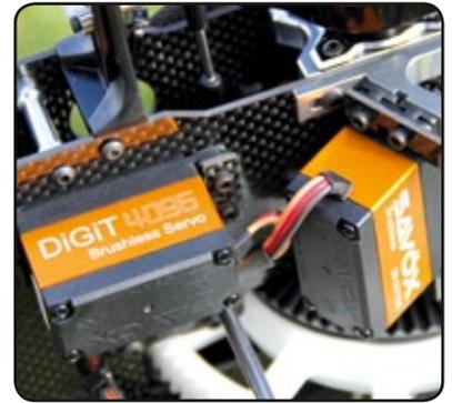
Die Savöx SB-2271 besitzen einen bürstenlosen Motor sowie ein Stahlgetriebe – und sind natürlich hochvoltfähig
