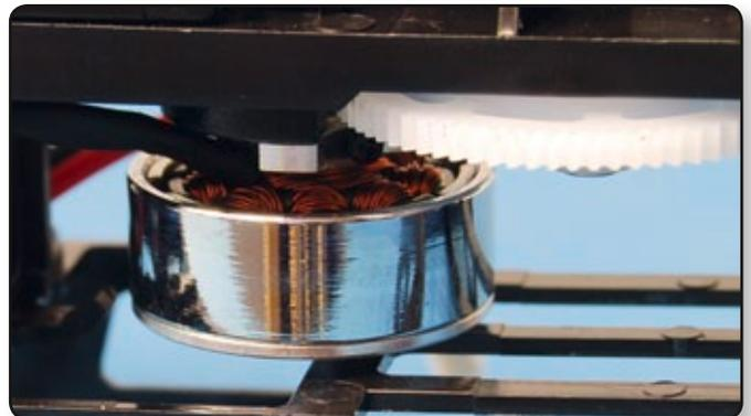
Inzwischen gehören Brushlessmotoren schon zum guten Ton. In dieser Größenklasse waren bürstenlose Außenläufer bisher jedoch eher selten anzutreffen. Das im Blue Arrow 1.8 verbaute Motörchen stellt ordentlich Leistung zur Verfügung, sodass dem Heli auch bei Vollpitch in Rückenfluglage nicht die Puste ausgeht. Nähere Informationen zum Antrieb finden sich leider nicht
