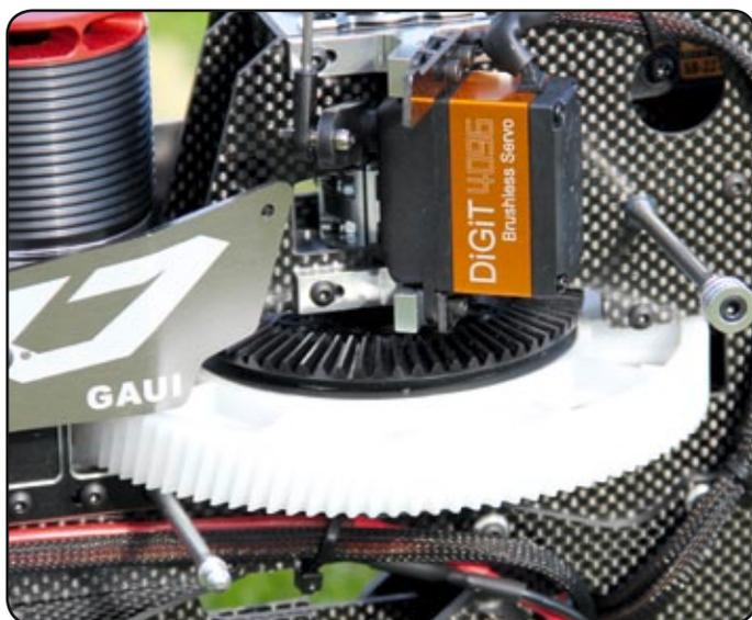
Über dem Hauptzahnrad sitzt das schwarze Tellerzahnrad für den Heckabtrieb
