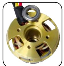
Die Lager sind nicht eingeklebt. Das ermöglicht leichtes Wechseln
