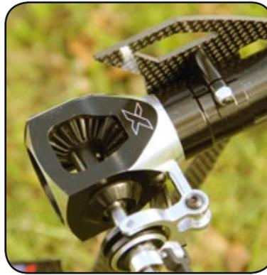
Das massive Heckgehäuse aus Alu beherbergt das 90-Grad-Winkelgetriebe
