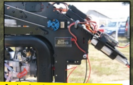
Der Gryphon Auto Booster heizt auf Fernbefehl die Glühkerze an
