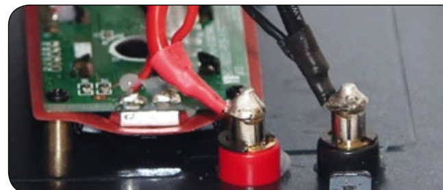
Verkabelung der besonders aufwändigen Art. An die Hochstromladebuchsen führen jeweils zwei Leitungen. Eine für den Strom, die andere nur zur Spannungsmessung
