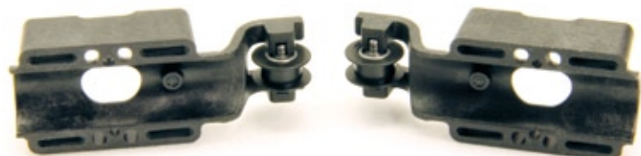
Die Servos sitzen alle auf einem Block, in dem auch die Domlager untergebracht sind
