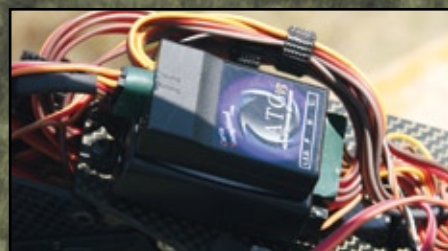
Hier hatte der Altmeister Curtis seine Finger im Spiel: Der Drehzahlregler ATG V3 kümmert sich automatisch um eine konstante Motordrehzahl
