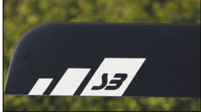
Die speziell von SpinBlades entwickelten Matt Black-Rotorblätter zeichnen sich durch einen leisen Lauf aus
