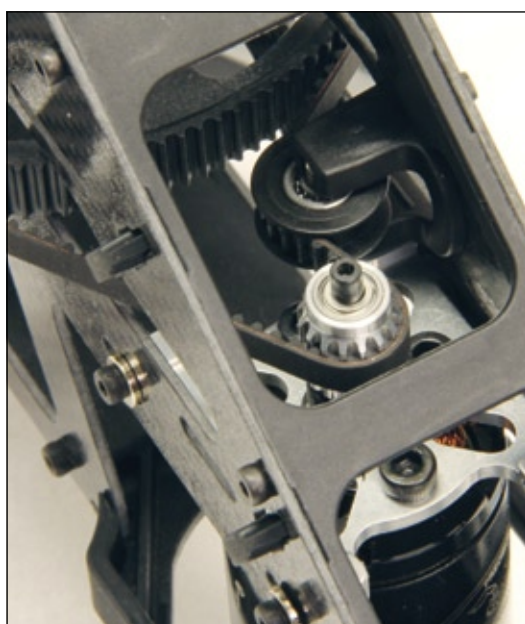
Im Motorritzel sitzt gleichzeitig auch der Freilauf
