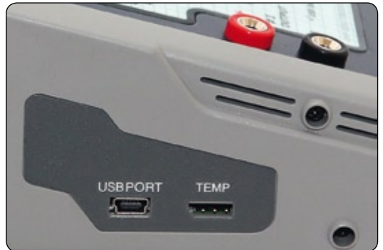
Auf der linken Seite sind der USB- und ein Temperaturfühleranschluss zugänglich. Auf der rechten Gehäusesseite befindet sich der zweite Temperaturfühleranschluss
