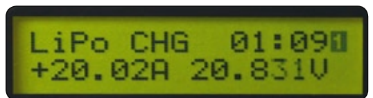
20 Ampere sind locker möglich am 5s-LiPo, sofern er dafür geeignet ist
