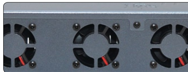
1.000 Watt Lade- oder 80 Watt Entladeleistung erzeugen Wärme, die abgeführt werden muss
