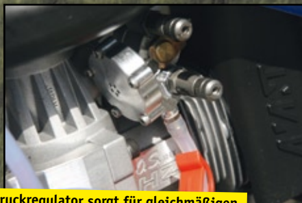
Der Druckregulator sorgt für gleichmäßigen Spritfluss – auch bei Überkopffiguren
