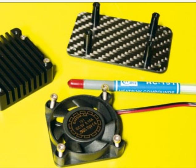
Zum Lieferumfang gehört auch Wärmeleitpaste, die zwischen Jive und dem Kühlelement aufgetragen wird
