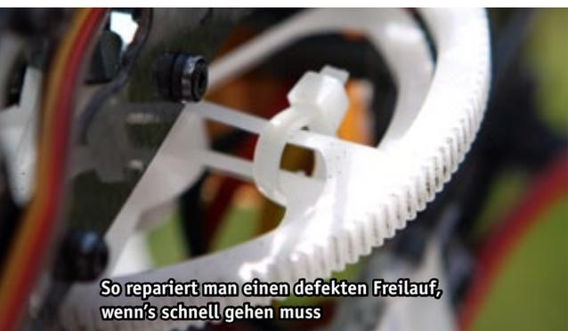
So repariert man einen defekten Freilauf, wenn's schnell gehen muss
