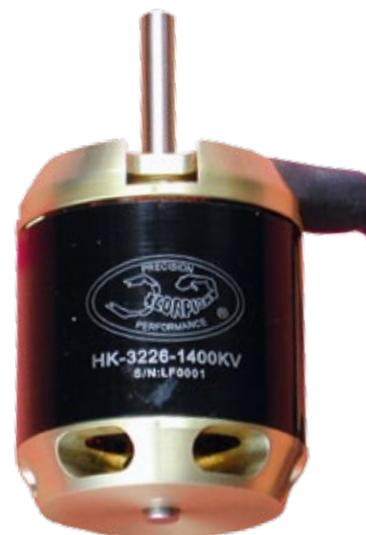
Die Scorpion-Motorbezeichnungen sind transparent. HK steht für (bevorzugten) Helikoptereinsatz, die Zahlenkombination 3226 beschreibt das Statormaß (Länge und Durchmesser in Millimeter) und gibt mehr noch als die Außenmaße Aufschluss über die Leistungsklasse des Motors. 1400 KV schließlich offenbart die spezifische Drehzahl des Motors
