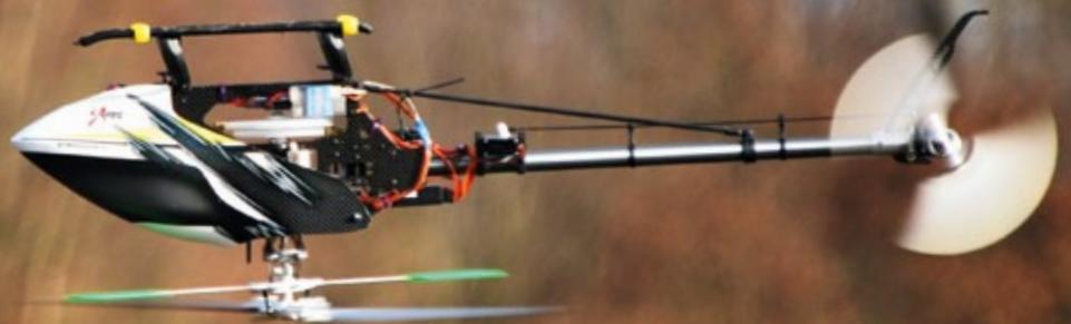
An den einteiligen Kufenbügeln sind kleine Gummibremsen angebracht, um auf glattem Untergrund einen sicheren Stand zu gewährleisten
