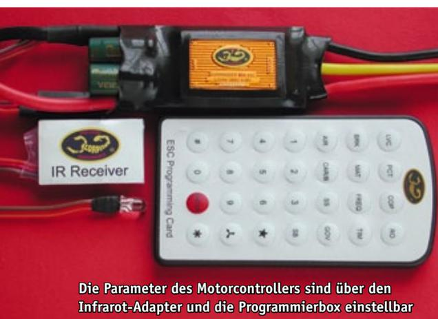
Die Parameter des Motorcontrollers sind über den Infrarot-Adapter und die Programmierbox einstellbar
