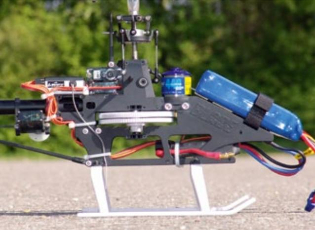
**Ganz vorn sitzt der gesicherte 3s-LiPo-Akku. Deutlich zu erkennen sind auch die beiden Hauptzahnräder mit unterschiedlichen Modulen und Zähnezahlen – das obere mit Freilauf für den Antrieb des Hauptrotors, das untere für den Zahnriemen-Heckantrieb**
