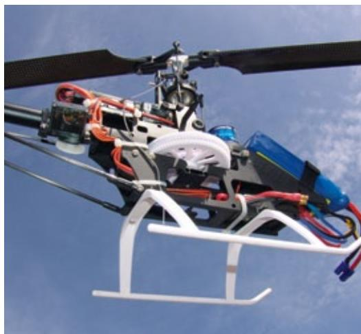
Das Kufengestell ist einteilig, die Heckabstrebung doppelt. Am Heckrohr sitzt das schnelle Digi-Servo EFLRDS76T
