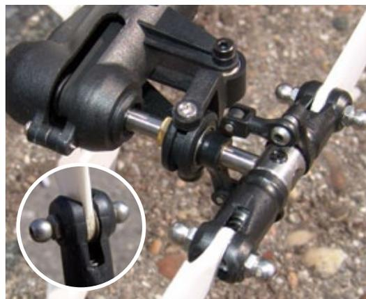
Die Heckblatthalter verfügen jeweils über Kugel- und Drucklager. Durch das offene Gehäuse lässt sich die Spannung des Heckriemens kontrollieren. Die im Text erwähnten Propellermomentgewichte in Form von Kugelköpfen (kleines Bild) sitzen auf den Blattschrauben
