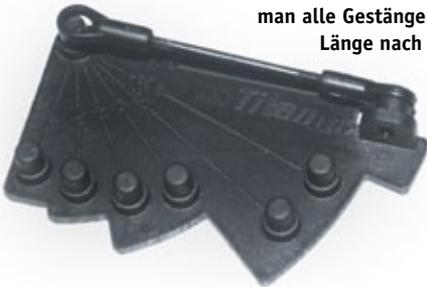
Der aus Aluminium gefertigte Rotorkopf ist korrekt montiert, die Drucklager und die Dämpfergummis sind mit Fett und Öl versehen. Die Paddel sind lediglich aufgedreht, aber noch nicht gesichert und ausgerichtet. Sie wurden heruntergeschraubt und mit ein wenig Uhu plus endfest 300 wieder aufgedreht. Mit einer Paddellehre wurden sie zueinander und zu den Paddelstangen-Anlenkungen fluchtend ausgerichtet. Hierbei darf man nicht vergessen, den korrekten Abstand
