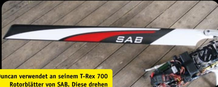
Duncan verwendet an seinem T-Rex 700 Rotorblätter von SAB. Diese drehen sich im Flug 2.170 mal in der Minute – mehr als genug für hartes 3D
