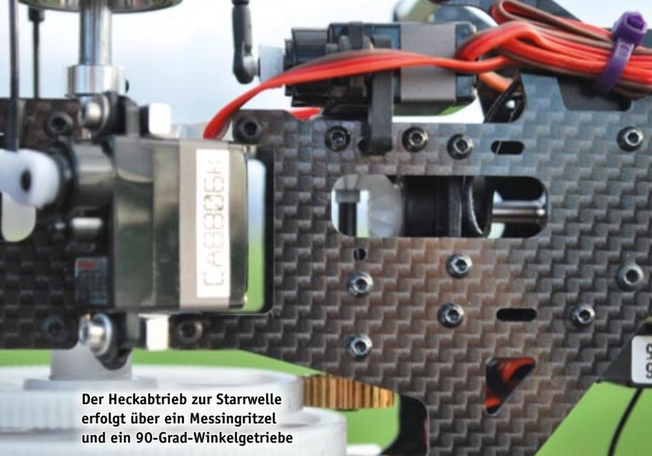
Der Heckantrieb zur Starrwelle erfolgt über ein Messingritzel und ein 90-Grad-Winkelgetriebe
