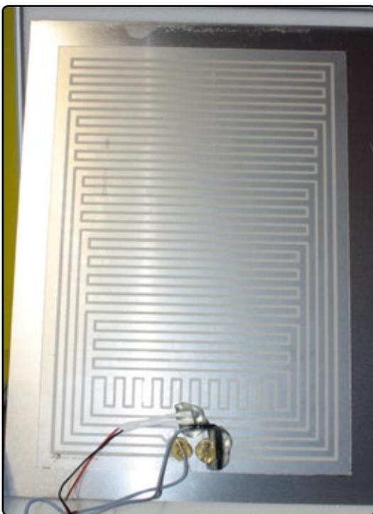
Die Heizmatte ist flächendeckend auf der Aluplatte angebracht. Die hier zu sehenden Ränder sind im kompletten Aufbau mit Dämmmaterial versehen
