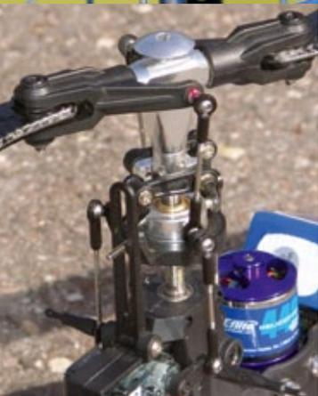
Der Zweiblatt-Rotorkopf besitzt ein Zentralstück aus Aluminium und eine harte Kopfdämpfung. Für die Mitnahme des Taumelscheiben-Innenrings sorgen die zwei am Zentralstück befestigten Arme
