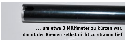
Der Heckrotor wird über einen Zahnriemen angetrieben, der in einem leichten Aluminiumrohr verläuft, das ...
