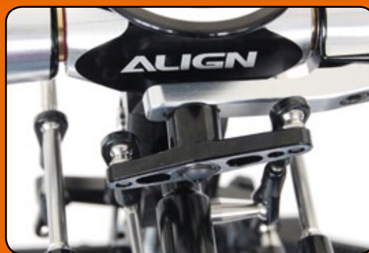
Am Anlenkhebel des Blatthalters lässt sich der Bell-Hiller-Mischer an drei verschiedenen Positionen montieren, um die Delta-Drei-Rücksteuerung einstellen zu können
