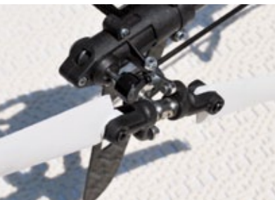
Der Heckrotor ist klassisch aufgebaut und funktioniert recht spielfrei
