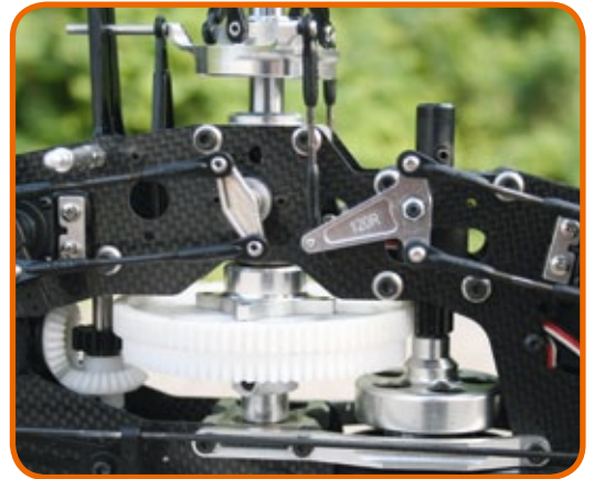
Christopher fliegt seinen X50 in der 120-Grad-Variante. Auch hier sorgen Aluhebel für die nötige Steifigkeit der Anlenkung
