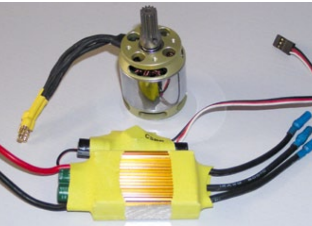
Der Motor wartet mit Durchzug auf und der Steller benötigt aufgrund fehlendem Governormodus eine Gaskurve im Sender
