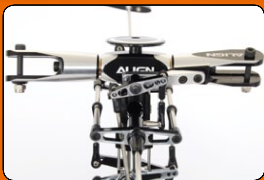
Schraubt man oben am Bell-Hiller-Mischer wie auch unten am Pitchkompensator die Kugelköpfe der Anlenkung weiter innen ein, werden die Steuerreaktionen zahmer
