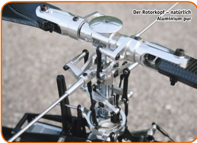
Zahnriemen seien was für Schönwetterpiloten. Deshalb setzt Christopher ganz auf den X50 Torque Tube, der mit einem Starrantrieb ausgerüstet ist
