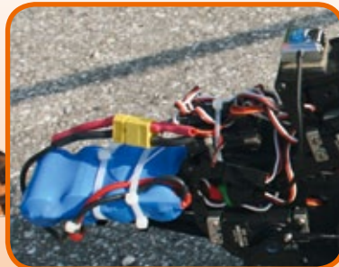
Pragmatismus auch bei der Stromversorgung der RC-Anlage: Vier Sub-C-Rundzellen direkt auf den Empfänger – fertig. Um die Hochachsenstabilisierung kümmert sich ein Futaba GY 520. Kommentar Christopher: „Wenn's passt, lass ich's auch drauf“
