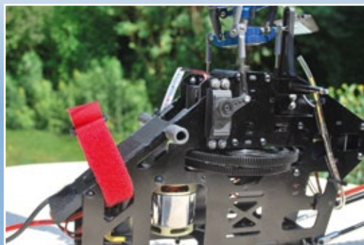
Das Aluminiumchassis ist klar gegliedert und sehr robust. Der Gewichtsunterschied zum CFK-Pendant vernachlässigbar
