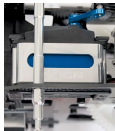
Das Nickservo sitzt in einem Aluminium-Servoträger und steuert von dort über kurzen Weg die Nickwippe an
