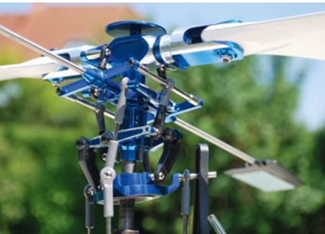
Der Rotorkopf sollte vor dem Betrieb noch mit etwas Fett versehen werden
