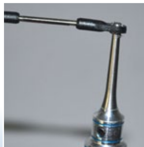
Leichtgängigkeit ist das Geheimnis für sauberen Schwebeflug: vorsichtiges Aufreiben der Kugelköpfe ist der Weg
