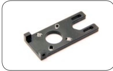
Die Motorplatte musste für den Pyro 650 etwas ausgefräst werden
