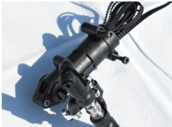
Der Heckrotor wird über einen Zahnriemen angetrieben, der in einem leichten Aluminiumrohr verläuft, das ...
