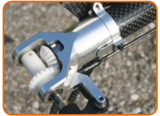
Zahnriemen seien was für Schönwetterpiloten. Deshalb setzt Christopher ganz auf den X50 Torque Tube, der mit einem Starrantrieb ausgerüstet ist
