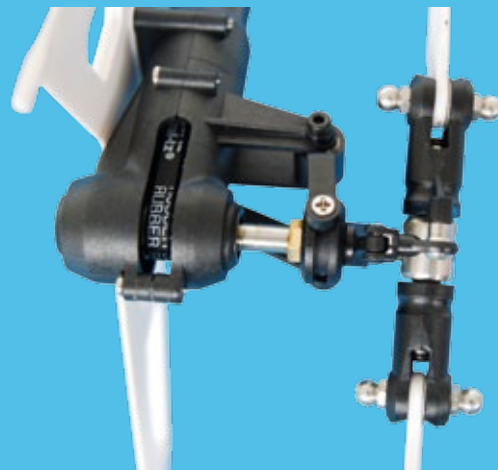
Die Knubbel an den Blatthalterschrauben nennen sich PMG und sollen die vom Servo aufzubringende Ruderkraft minimieren. Zudem wird die Schiebepöhlse der kollektiven Ansteuerung oben und unten angelenkt
