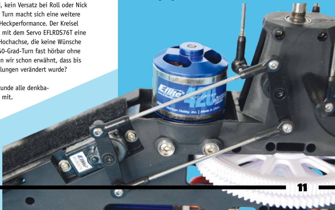
Bis auf die Bell/Hiller-Mischhebel sind alle Gelenke mit Kugellagern versehen
