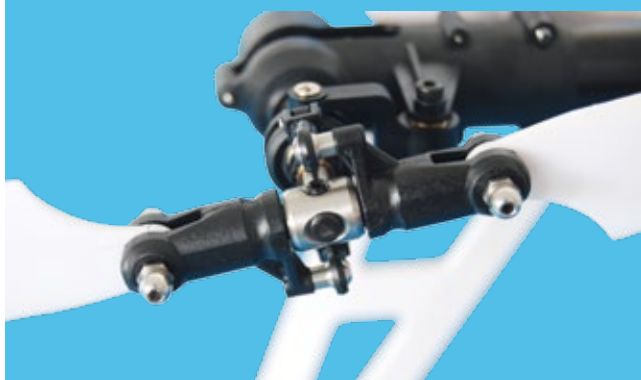
In den Blatthaltern sitzen Drucklager, um auch bei hohen Drehzahlen die Leichtgängigkeit zu erhalten
