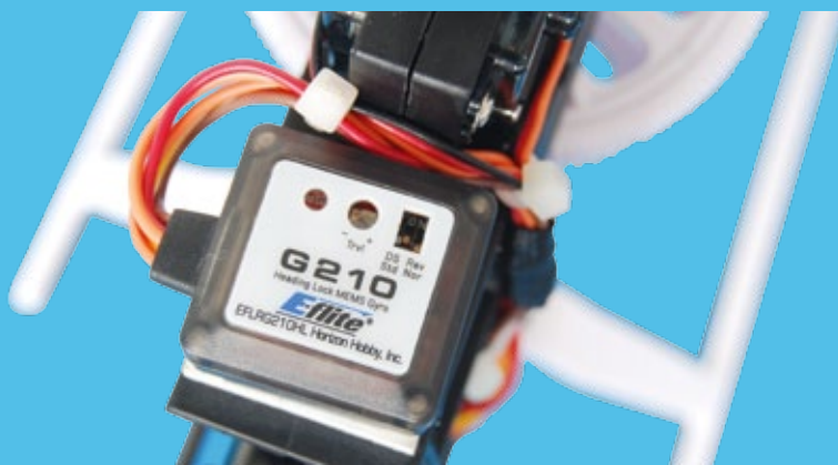
Der G210 besitzt ein Untergehäuse aus Metall, um hochfrequente Schwingungen herauszufiltern
