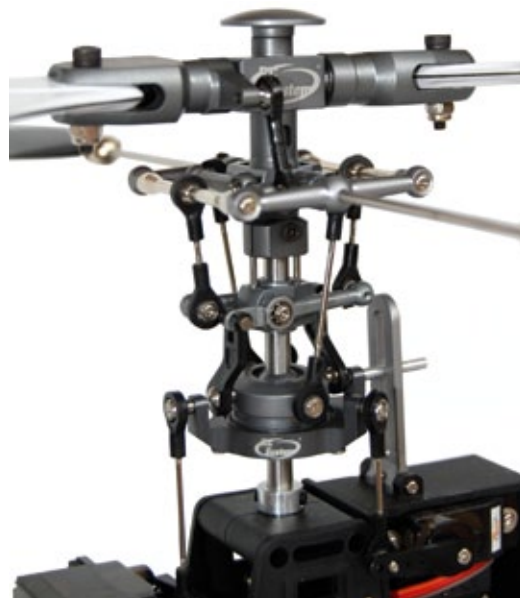
Viele gefräste Aluminiumteile bilden den Hauptrotorkopf und sorgen für ein präzises Flugverhalten
