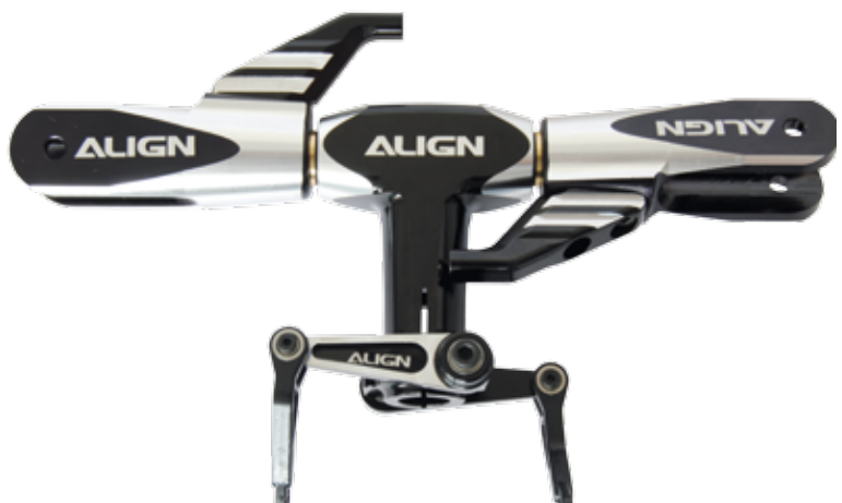
Massiv präsentiert sich der paddellose Rotorkopf der FBL-Variante des T-Rex 600 Pro. Dass der Taumelscheiben-Mitnehmer direkt am Zentralstück montiert ist, vereinfacht die Montage doch erheblich
