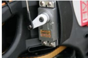
HV ist natürlich auch bei Nirs Heli angesagt: Für schnelle Taumelscheibenbewegungen und knackige Reaktionen sorgen DS6315 von JR
