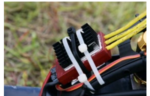
Um die Motorstromversorgung kümmert sich zwar nur ein 80er-Jive, doch der ist mit einem dicken Kühlkörper und viel Hitzeleitpaste garantiert ausreichen dimensioniert
