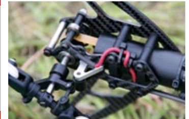
Um die Gefahr des Aufladens des Zahnriemens zu vermeiden, erdete Nir Meiri beide Riemenräder
