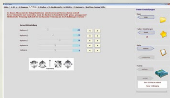
Die Mittelstellungen der Servos stellt man hier im Menü ein. Natürlich wird eine exakt winklige Montage der Servohebel vorausgesetzt
