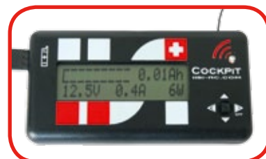
Links oben ist der Balken bei vollem Akku komplett schwarz. Rechts oben steht die verbrauchte Kapazität, weiter findet sich im Display die Spannung, anstehender Ruhestrom und Leistung in Watt
