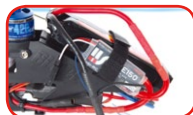
Platz ist in der kleinsten Hütte. Selbst das 150-Ampere-TXE passt noch bequem unter die Haube des Blade 450 3D
