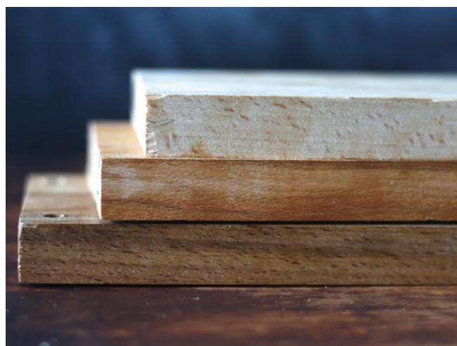
Durch das Einbrennen bekommt das Holz im Vergleich zum unbehandelten Holz (oben) eine dunklere Farbe (unten und Mitte)
