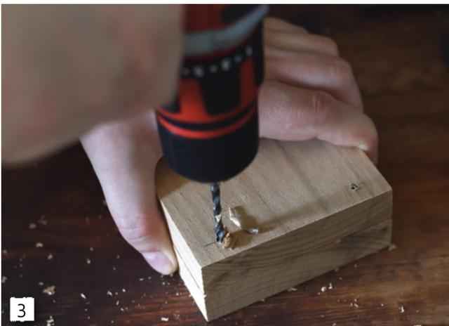
3 Nun die Löcher für die Schrauben mit einem kleinen Holzbohrer vorbohren
