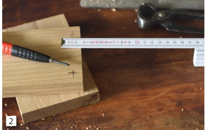
2 Die Position der Bohrlöcher wird abgemessen und mit einem Kreuz markiert
