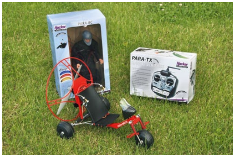
Das Komplettsset beinhaltet erstens den Schirm samt Piloten, Gurtzeug und Rucksack für den Segelbetrieb, zweitens das Trike und drittens die Fernsteuerung samt Empfänger. Außer einem 3s-LiPo wird kein weiteres Zubehör benötigt
