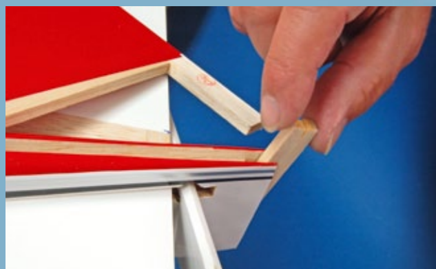
Diese zwei Hölzchen müssen vor dem Einkleben des Seitenleitwerks entfernt werden
