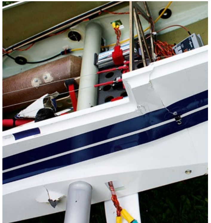
Der Rumpf und die Tragflächenanformung haben mehrere Stauchungen im Haubenbereich abbekommen
