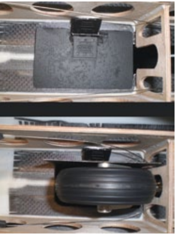
Die innenliegende Fahrwerksklappe im offenen und geschlossenen Zustand
