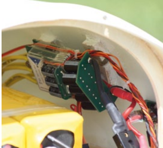
Der Regler sitzt nahe bei den Akkus an der Rumpfwand
