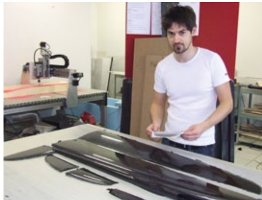
Nach dem Entformen der Modellteile müssen diese entgratet werden
