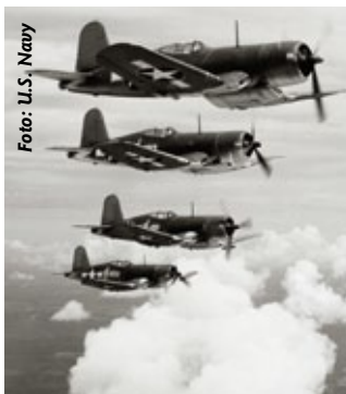
Die ersten Corsair waren noch mit „Birdcage“-Kanzeln ausgestattet, die später durch modernere Vollsichtkanzeln ersetzt wurden
