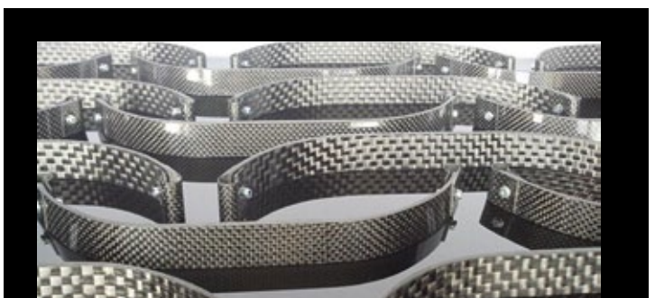
Ungefederte CFK-Landegestelle von Spider-Landegestell
