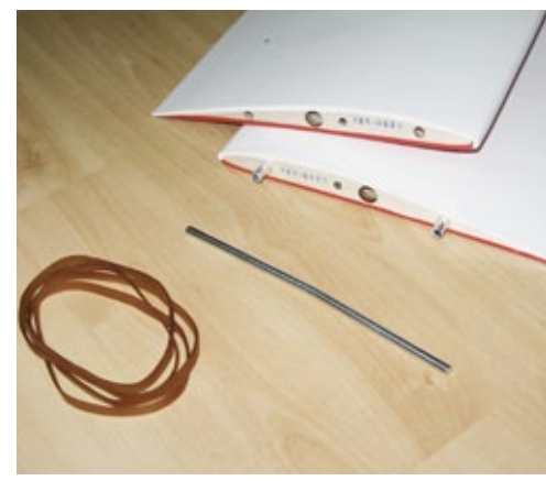
Über einen Stahldraht mit V-Form werden die Tragflächen aneinander gesteckt. Zusätzliche Torsionsstifte sorgen für einen identischen Anstellwinkel
