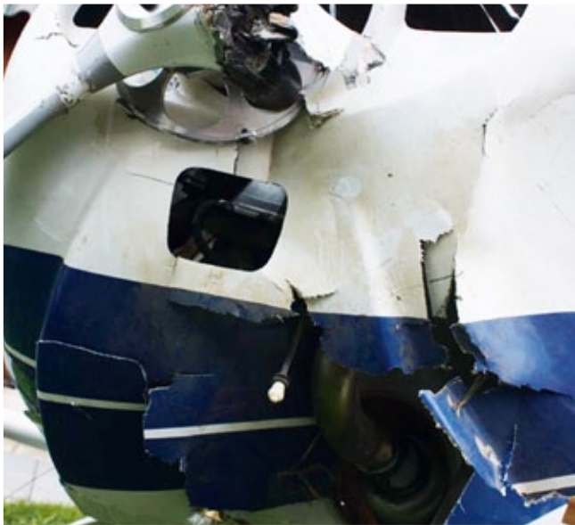
Hier ein Blick auf die Motorhaube. Die war nicht mehr zu retten und wurde ersetzt
