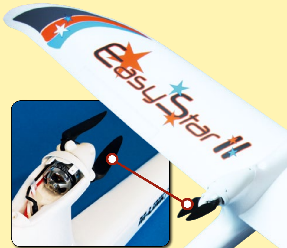
Im Pylon ist ein kraftvoller Brushlessmotor als Pusher verbaut
