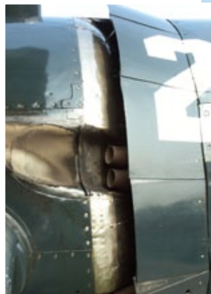
Die Auspuffanlage der Corsair wurde ständig verändert. Hier eine F4U-4
