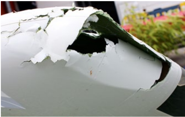
Der Randbogen hat die g-Kräfte sehr gut aufgenommen und absorbiert. Auch wenn es schlimm aussieht, aber das lässt sich selbst reparieren
