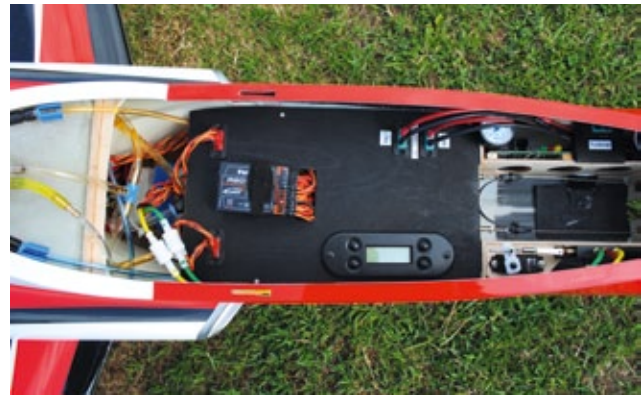
Blick unters Cockpit: Schön aufgeräumt und übersichtlich. Links sind die Verbindungen für Smoker, Luft und Flächenservos erkennbar
