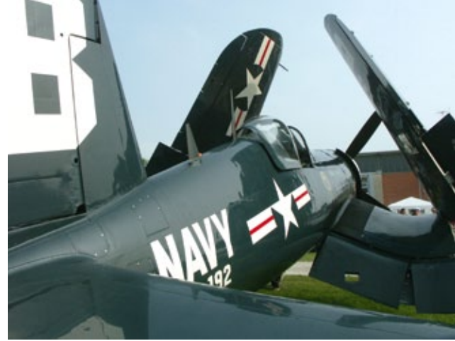
Hier sind die großflächigen Landeklappen und die Spaltruder am Knickflügel gut erkennbar
