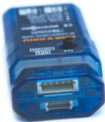
An einer Seite des LinkVarios kann man ein Strom-Spannungssensor sowie das GPS-Modul anschließen
