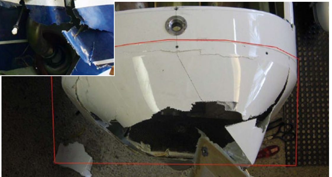
Der Rumpf und die Tragflächenanformung haben mehrere Stauchungen im Haubenbereich abbekommen
