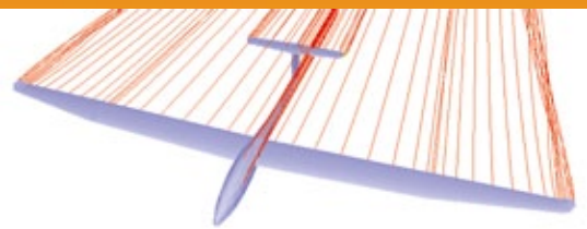
Abbildung 7: Genaue Berechnungen des Strömungsverlaufs sind mit FLZ_Vortex möglich
