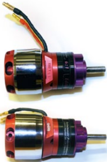
Oben ein Strecker RS 378.20.15-8P mit 15 Windungen, einer Eingangsleistung von 2,5 Kilowatt und etwa 130 Newton Stand-schub. Unten ein RS 378.20.13-8P mit 13 Windungen, einer Eingangsleistung von 3,6 Kilowatt und etwa 165 Newton Standschub
