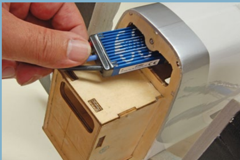
Der 60-Ampere-Regler wird unterhalb des Motordoms eingeschoben
