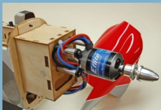
Der Außenläufer E-flite 25 sorgt bereits für eine sehr flotte Gangart
