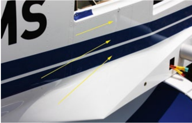
Hier sieht man die Stauchungen auf der rechten Rumpfseite – nach solchen Stellen ist sorgfältig zu suchen und diese zu reparieren
