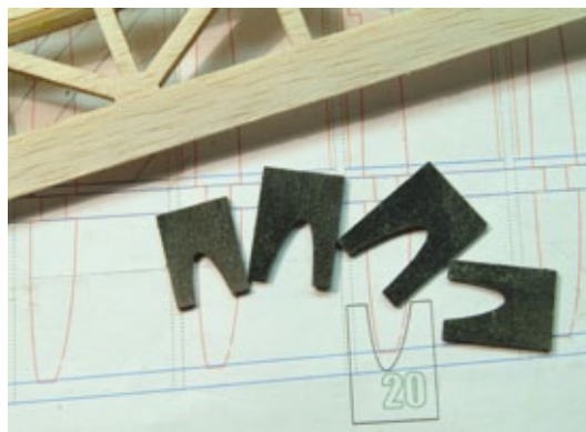
Schablonen für das richtige Profil an der Nasenleiste
