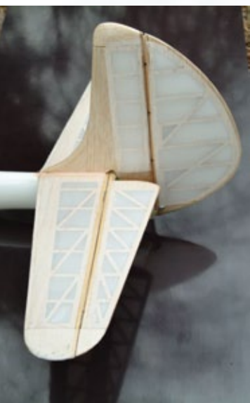
Das mit „Koverall“ bespannte Leitwerk
