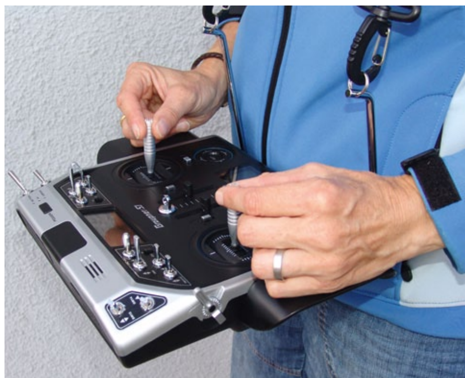
Mit dem Servo-Sequencer können bis zu drei Servos auf Knopfdruck einen zuvor einprogrammierten Bewegungsablauf ausführen. Zu welchem Zeitpunkt welche Wege dabei gefahren werden, ist getrennt einstellbar
