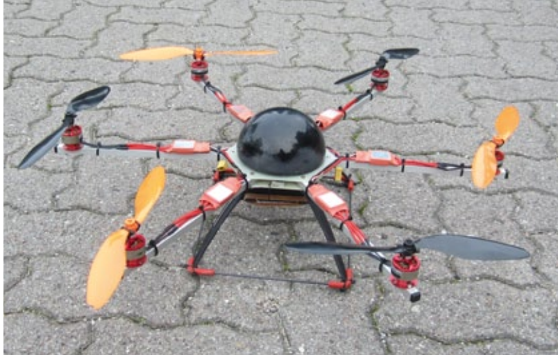
Der Reisecopter mit einem Achsabstand von 600 Millimeter
