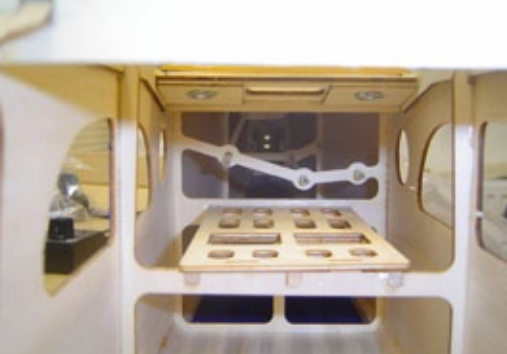
Die Bowdenzugrohre ins Heck sind perfekt abgefangen und bieten den Gestängen optimale Führung
