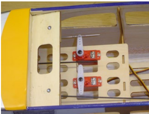
Die Gestänge zu den Heckrudern treffen die Servohebel an den äußeren Einhängenpunkten
