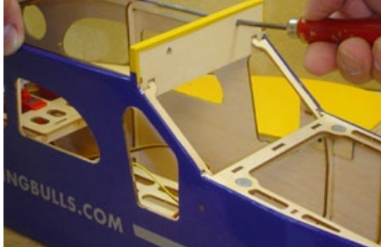
Nach geringfügiger Nacharbeit mit der Rundfeile sitzt der Tragflügel perfekt auf dem Rumpf. Gut zu erkennen: Die geringe Verbindungsfläche des Tragflächenspants
