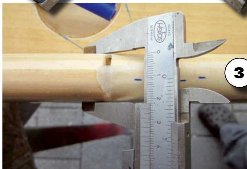
Exakt mittig werden zur CFK-Tasche passend große Schlitzte gefräst
