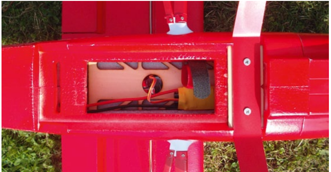
Der Akkuwechsel erfolgt mittels einer Klappe im Rumpfboden
