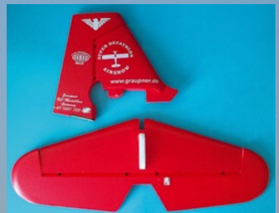
Höhen- und Seitenleitwerk sind symmetrisch profiliert
