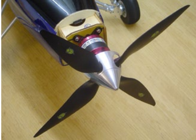
Der Motor hat die große Ehre, einen Edelprop aus dem Hause Ramoser mit vier verstellbaren Blättern antreiben zu dürfen
