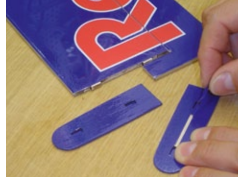
Für eine stabile Verbindung der Winglets am Höhenruder ist ein schmaler Streifen Folie zu entfernen
