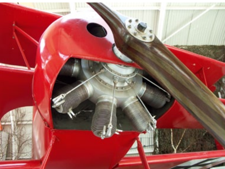
Als Antrieb der Dr.I diente ein 110 PS starker Umlaufmotor (hier ein Nachbau)
