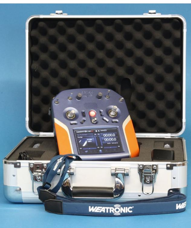
**Verschiedene Sticks und Steuerscheiben, die die Knüppel-Charakteristik bestimmen, sind erhältlich. Oben links die Möwenscheibe, die mechanisch ein haptisches Feedback einer Stick-Funktion gestattet**
