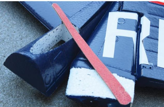
**Um die Farbe an den Klebestellen zu entfernen eignet sich eine Pappnagelfeile**
