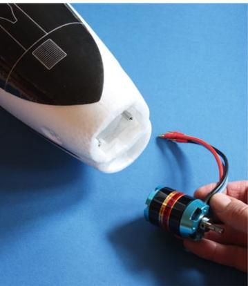
**Vor dem Einbau des Bugrads sind Motor und Regler im Modell zu platzieren**
