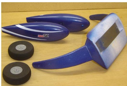
Blessuren führen, wird der Einbau der Hauptfahrwerke vorgezogen. Das komplett vormontierte Fahrwerk der Yak-54 basiert auf einem 4 mm starken Federstahldraht, den Kunststoffapplikationen elegant verkleiden. Binnen Sekunden verschwindet der freie Teil des Stahlbügels in der exakt passenden Kunststoffaufnahme des Rumpfs und ist mit einer anzuschraubenden Plastikabdeckung gegen Herausfallen gesichert.
