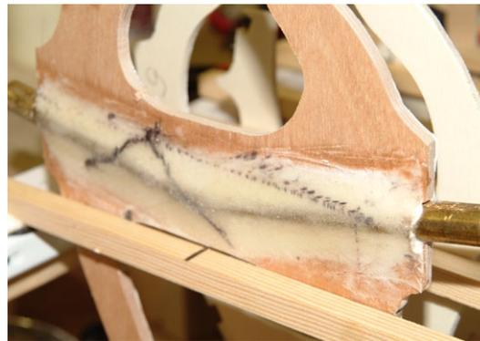
Hauptspant mit zentral eingebauter Steckung
