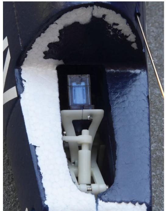
**Das einziehbare Spornrad vor der Verklebung des Leitwerks**
