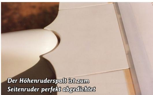
**Der Höhenruderspalt ist zum Seitenruder perfekt abgedichtet**
