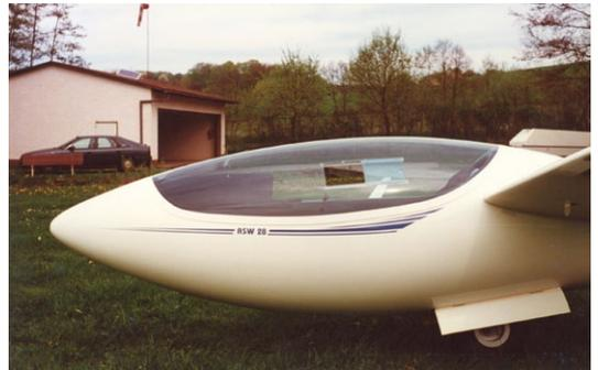
**Das typische Rumpfvorderteil mit dem sehr harmonisch ausgeschnittenen Kabinenhaubenrahmen. Diese Form wurde bei Schleicher ab der ASW-24 eingeführt**
