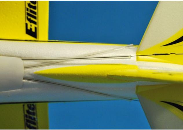
**Sämtliche Ruderanlenkungen werden außen geführt und gewähren so einen guten Zugang für eventuelle Einstellarbeiten**
