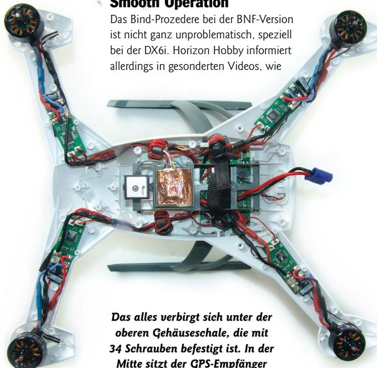
Das alles verbirgt sich unter der oberen Gehäuseschale, die mit 34 Schrauben befestigt ist. In der Mitte sitzt der GPS-Empfänger
