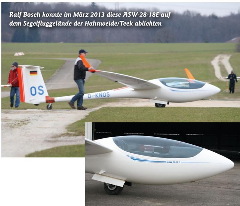
Von der reinen Segelflugausführung lässt sich die E-Version nur durch die Aufschrift und den Triebwerksklappen unterscheiden
