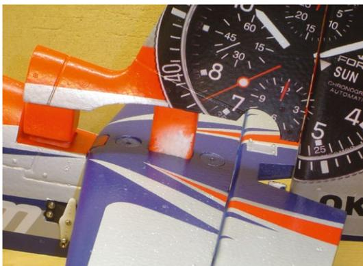
**Stabile Hypodurzapfen zwingen das Seitenleitwerk der Extra 330 in die korrekte Position auf dem Rumpfrücken**
