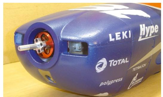
**Zwei große Öffnungen lassen die Kühlluft in den Rumpf der Extra 330. Der Brushless-Antrieb sitzt betriebsfertig montiert unter der EPP-Cowling**
