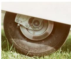
**Das hydraulisch bremsbare Hauptrad hat einen Durchmesser von 350 Millimeter**
