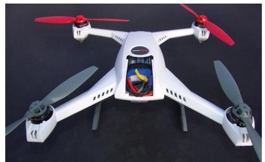
Der LiPo-Akku muss bis zum Anschlag eingeschoben und mit einem Klettband gesichert werden
