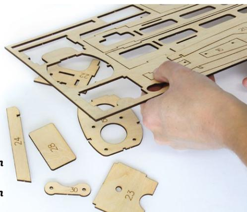
**Alle Holzteile lassen sich leicht aus dem Grundbrett herausbrechen**
