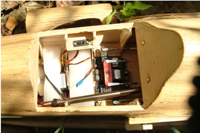
**Zwei Servos für das Höhenruder (für jede Flosse ein Servo) und eines für das Seitenruder. Die Flächen-Steckung wird beim Transport in der Kabine gelagert**
