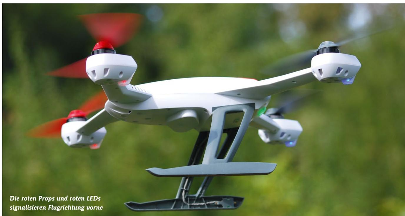
Die roten Props und roten LEDs signalisieren Flugrichtung vorne
