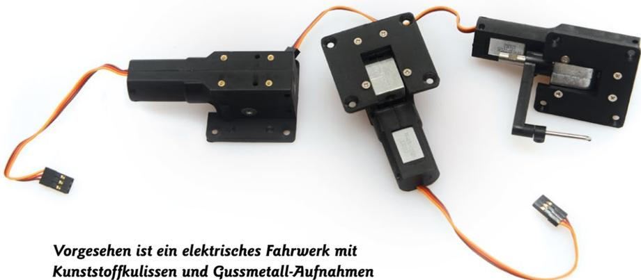
Vorgesehen ist ein elektrisches Fahrwerk mit Kunststoffkulisen und Gussmetall-Aufnahmen
