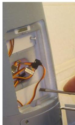
**Um an die Sicherungsschrauben der Tragflächen der Yak-54 zu kommen, muss der Rumpf umgedreht und die untere Zugangs-klappe geöffnet werden**
