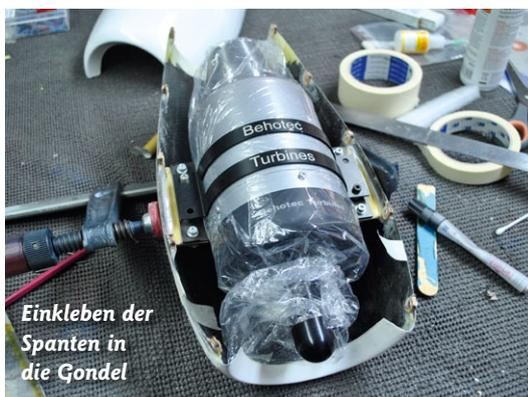
Einkleben der Spanten in die Gondel
