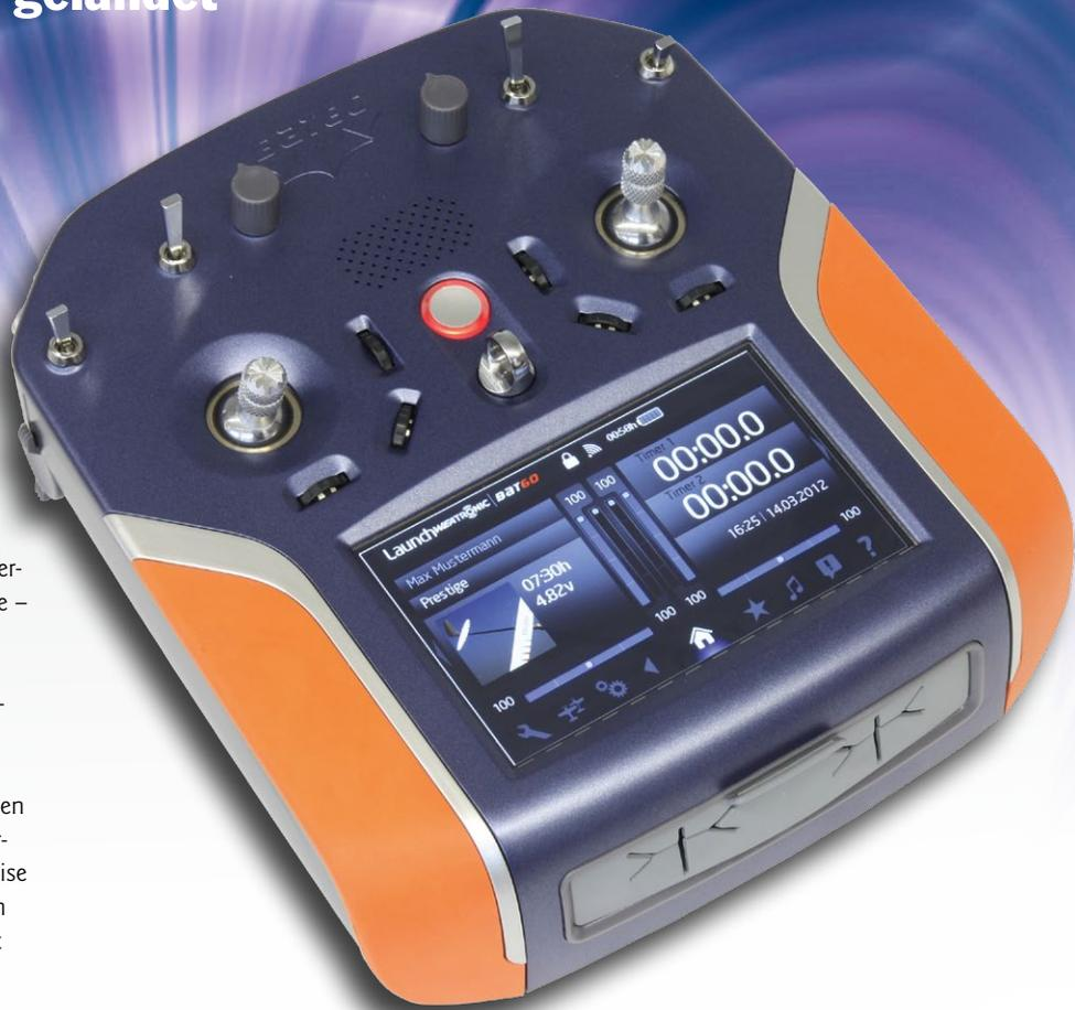
damit ein sehr scharfes Bild zur Wiedergabe feinsten Details, zum Beispiel bei Grafiken oder Kurven. Unterhalb des LCD, also der unteren Gehäusesseite, ist ein Fach eingelassen, in dem sich zwei USB- und eine Micro-USB-Schnittstelle, zwei Klinkenstecker-Buchsen für Audio-Ausgang und PPM-Signal, eine Ladebuchse und ein Slot für Micro-SD-Speicherkarten befinden. Letztere dient zur Daten-Aufzeichnung und als Modellspeicher – 1.000 Modelle sind möglich.
