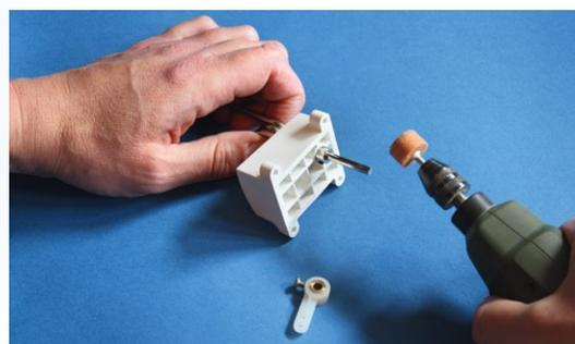
**Mit dem Dremel wurde der Bugraddraht abgeflacht, damit die Madenschraube den Stellhebel sicher arretieren kann**
