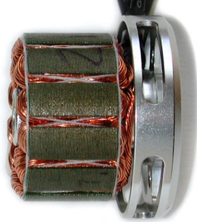
**Die Wicklungen sind durch Spannfäden gegen Herausreten gesichert**
