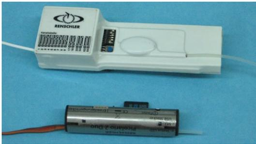
Das neue Picolario2 im Größenvergleich zu seinem Vorgänger, dem Picolario talk. Nicht mit auf dem Bild ist das optional ansteckbare 433-Megahertz-Modul für das Picolario2
