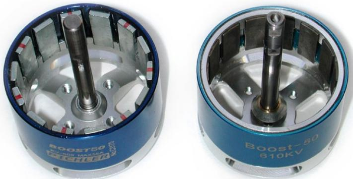
**Auch der Rotor erfährt eine Überarbeitung. Die Magnete sind neuerdings beidseitig in Kulissen geführt und somit besser gegen Herausreißen gesichert (rechts)**
