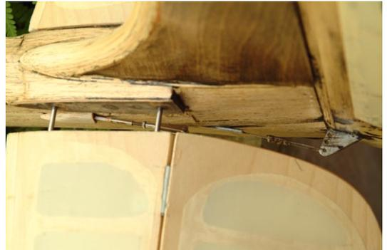
**Die geänderte Leitwerk-Steckung mit zwei Stahldrähten und Magnethalterung**
