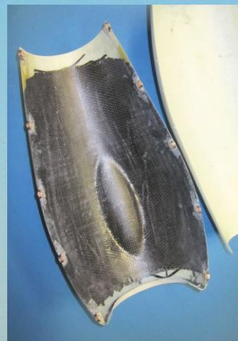
**Die Turbinen-Gondel ist von Elster Modellbau und besteht aus zwei Halbschalen**
