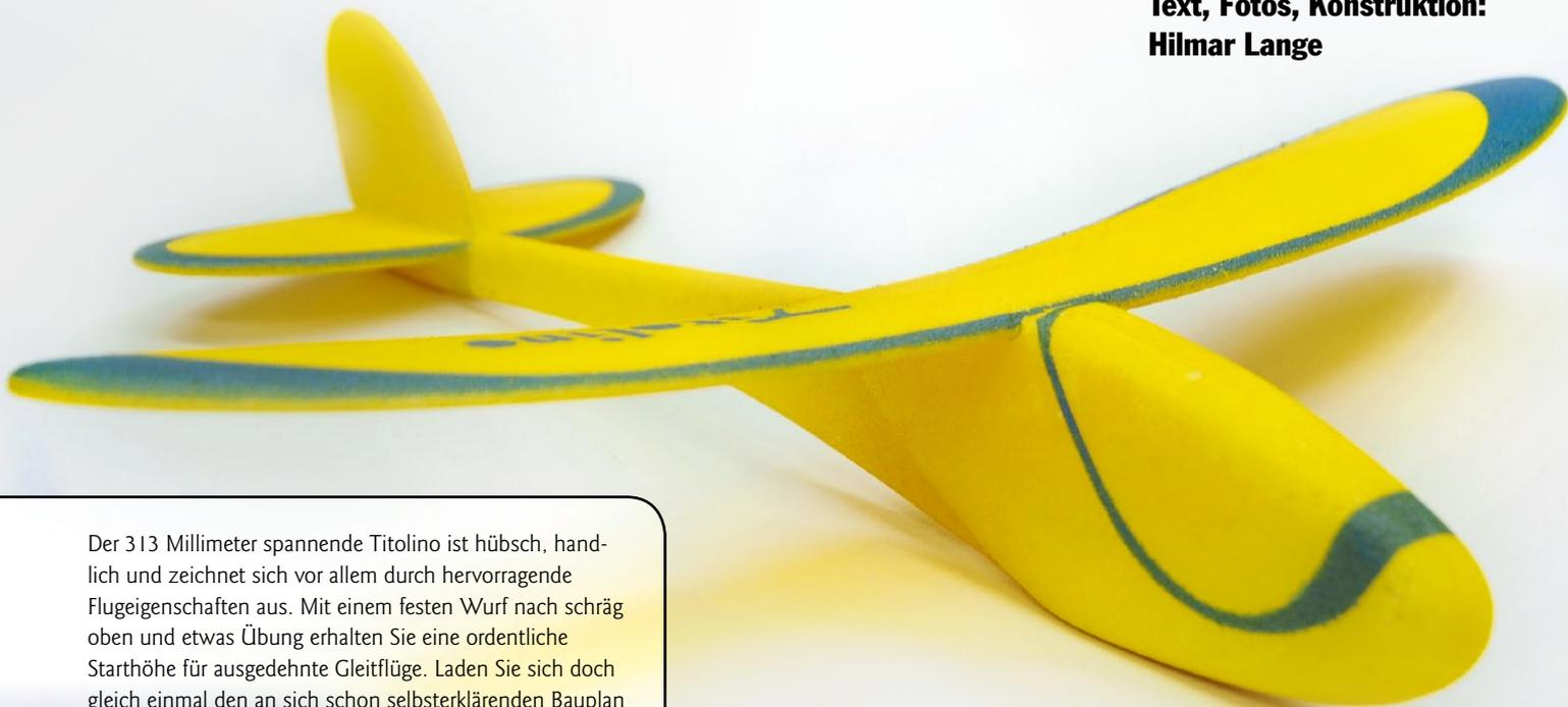
Der 313 Millimeter spannende Titolino ist hübsch, handlich und zeichnet sich vor allem durch hervorragende Flugeigenschaften aus. Mit einem festen Wurf nach schräg oben und etwas Übung erhalten Sie eine ordentliche Starthöhe für ausgedehnte Gleitflüge. Laden Sie sich doch gleich einmal den an sich schon selbsterklärenden Bauplan aus dem Downloadbereich bei [www.modell-aviator.de](http://www.modell-aviator.de) in Form zweier DIN A4-Seiten als PDF-Datei herunter.
