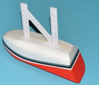
Über die Stützen lassen sich die Schwimmer exakt in der Fläche montieren
