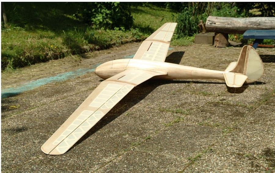
Die Bespannung ist fertig, es fehlt nur noch die Kabinenverglasung
