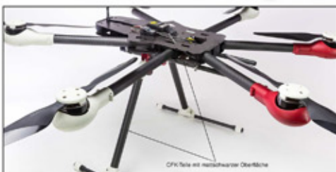
Durch die matte Oberfläche werden Spiegelungen bei Videoaufnahmen auf ein Minimum reduziert.
