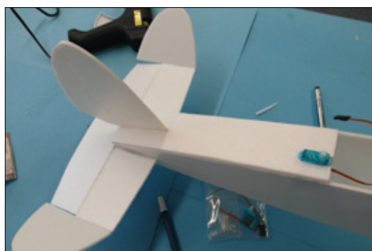
Die Steuerung des Jupiter Kwirl erfolgt alleine über Höhe, Seite und Gas
