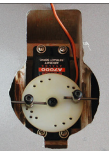
Fürs Fahrwerk ist ein zentral eingebautes Spezialservo mit 160-Grad-Drehwinkel zu verwenden
