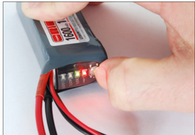
Geflogen wird das Testmodell mit einem 3s-LiPo der Marke Team Orion mit einer Kapazität von 1.600 Milliamperestunden und einer Belastbarkeit von 50C. Der Clou des Energiespenders: Der Ladezustand wird mittels LED angezeigt
