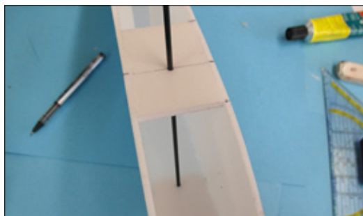
Ein 3-Millimeter-Kohlefaserstab bildet die Rotorachse
