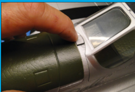
Ein Druck auf die Taste entriegelt die Abdeckung des Batteriefachs
