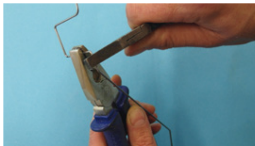
Mit zwei Flachzangen wird das Fahrwerk aus 1,5er-Stahldraht gebogen
