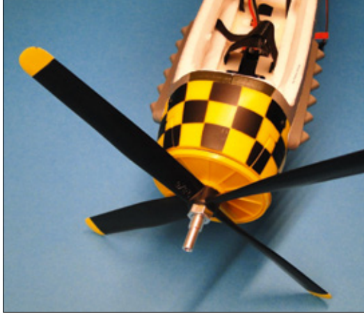
Ein vorbildähnlicher Vierblatt-Propeller sorgt für sehr guten Vortrieb und arbeitet angesichts neun Minuten Flugzeit sehr effizient
