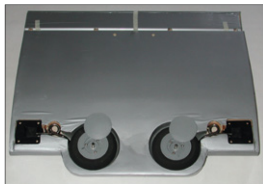
Das Einziehfahrwerk liegt weiter vorn als bei Warbirds sonst üblich, was bei der AT-6 ein großer Vorteil beim Landen ist
