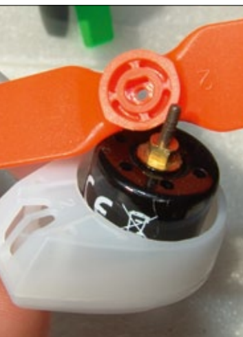
Die Flachstellen im Propeller und auf der Motorwelle sorgen für eine sichere Mitnahme
