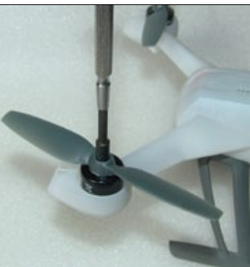
Zum Lösen und Befestigen der Prop-Muttern ist ein 3,5er-Steckschlüssel notwendig
