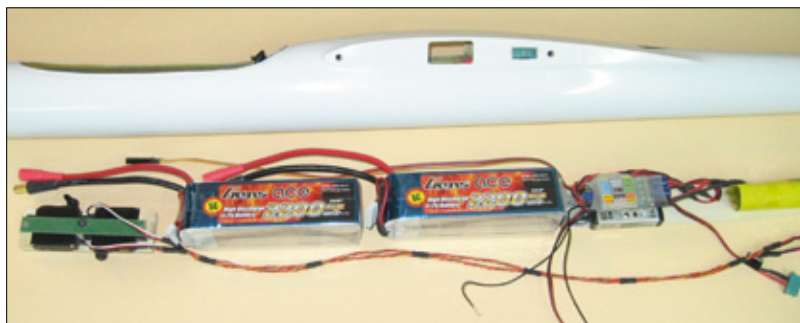
Hier sieht man deutlich, wo welche Komponenten im Rumpf platziert werden. Im Falle eines 3s- oder 4s-Antriebs sieht die Sache entspannter aus
