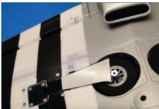
Das elektrisch einziehbares Fahrwerk gehört serienmäßig zum Lieferumfang. Es passt perfekt in die Aussparung
