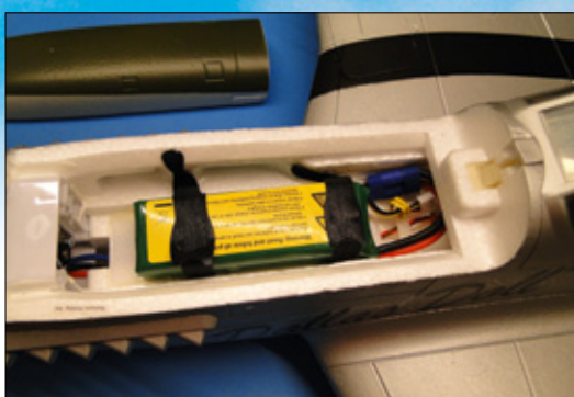
Der dreizellige 2.200er-LiPo wird mit Klettband gesichert und ist leicht in seiner Position verschiebbar
