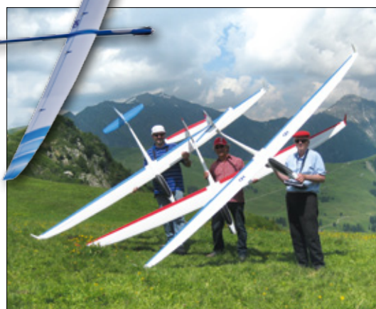
Die Rubina (4.000 Millimeter Spannweite, Profil HQ/DS-2,25/10) ist ein dynamisches Hangflugmodell; hier 2013 am Hahnenmoos
