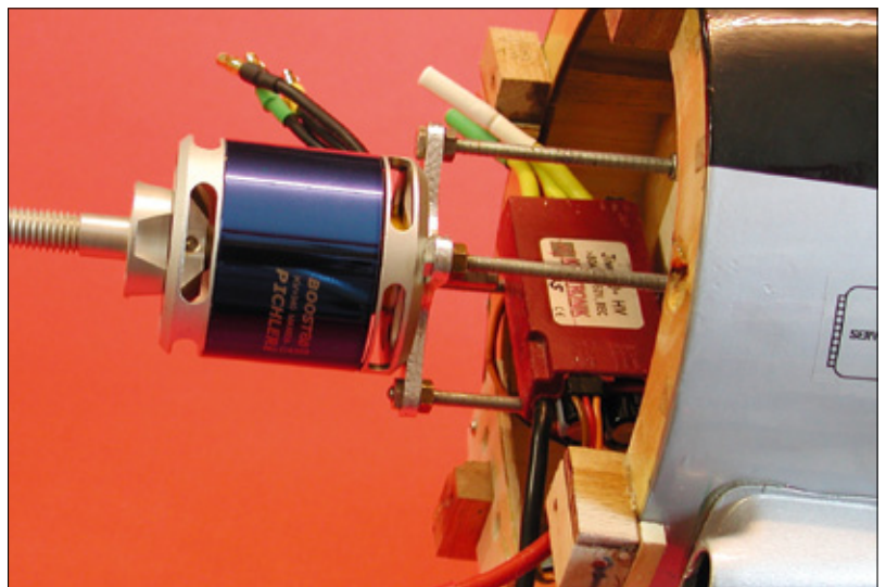
Der Außenläufer Boost 80 mit 340 kv wird an M4-Gewindestangen befestigt und entsprechend dem Motorhaubenausschnitt ausgerichtet
