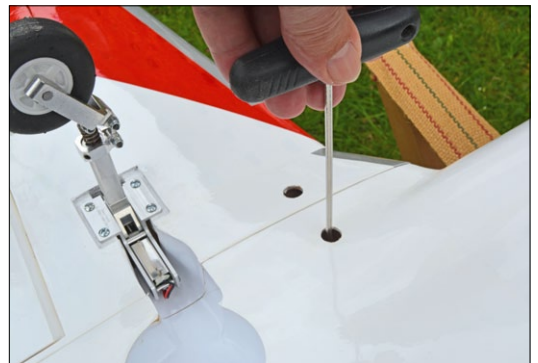
Mit einer Inbusschraube wird die Lasche des Tragflügels im Rumpf geklemmt
