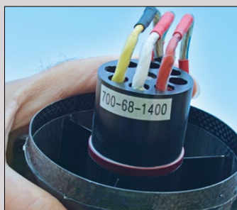
Im Impeller verbaut ist ein HET 700-68-1400 Brushlessmotor
