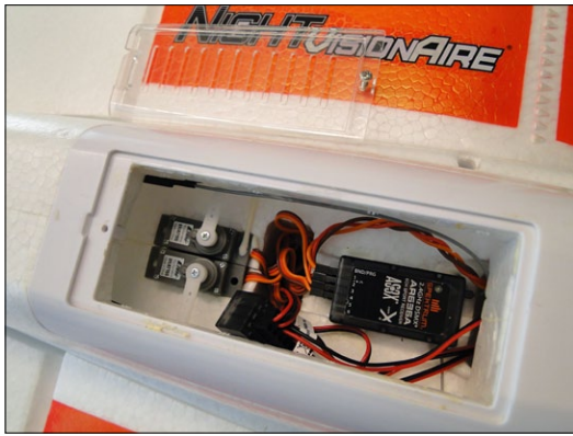
Der AS3X-Empfänger und die Servos für die Höhen- und Seitenrunder sind über eine Klappe an der Unterseite des Rumpfs zugänglich
