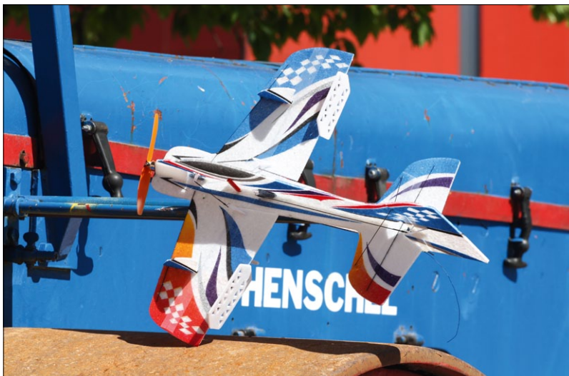
Abbildung 7: Ein Indoor-Silhouetten-Modell mit Widerstandsflächen an den Endleisten – sie machen das Flugzeug im Normalflug nicht langsamer
