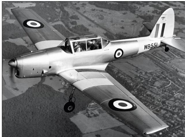
Eine Chipmunk aus kanadischer Produktion mit herkömmlicher Kabinenhaube und ohne die Trudelfinnen vor der Höhenflosse. Diese WB551 war silbergrau lackiert mit gelben Streifen an Fläche und Rumpfheck
