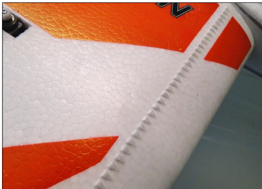
Die Vortex-Generatoren tragen zu den hervorragenden Langsamflug-Eigenschaften bei
