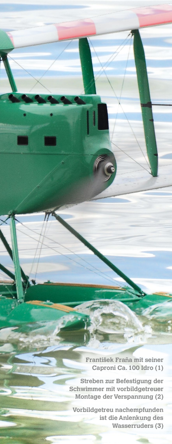
In klassischer Holzbauweise entstand die Ca. 100. Die Schwimmer sind aus GFK-überzogenem Styropor
