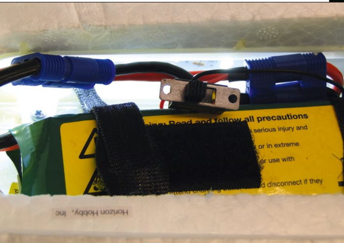
Über den Schalter im Akkuschaft wird die Beleuchtung eingeschaltet
