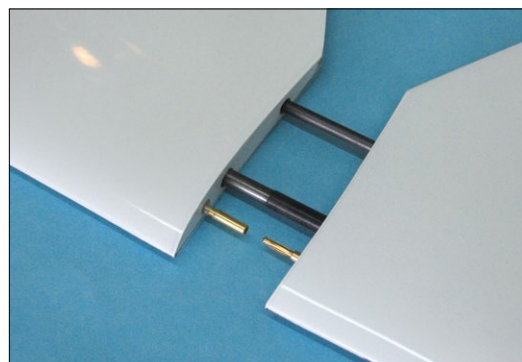
Die Steckung des Pendelleitwerks besteht vorne aus Stahl, hinten aus CFK
