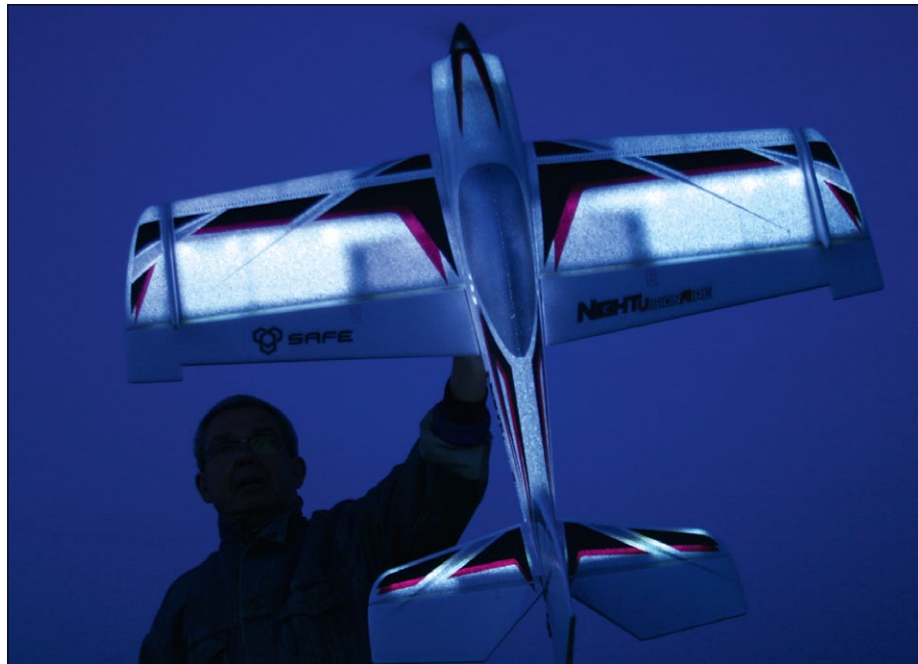
Die Vortex-Generatoren tragen zu den hervorragenden Langsamflug-Eigenschaften bei
