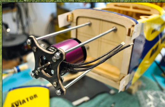
Mit vier M4-Gewindestangen wurde der Motor fixiert. So lassen sich Zug und Sturz einstellen
