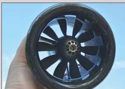
Im Modell verwendeter Zehnblatt-Impeller DS-51-AXI HDS
