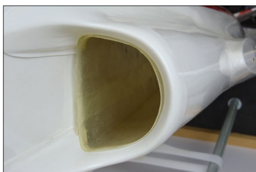
Die Lufteinläufe erfordern etwas Nacharbeit, um größere Verwirbelungen zu vermeiden
