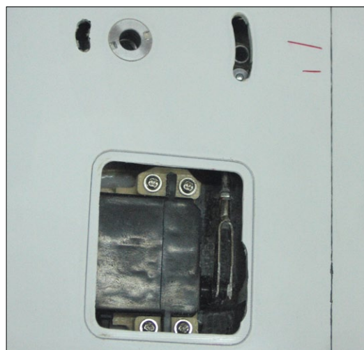
Das Höhenruder wird über eine geradlinige Anlenkung vom hinten sitzenden Servo gesteuert
