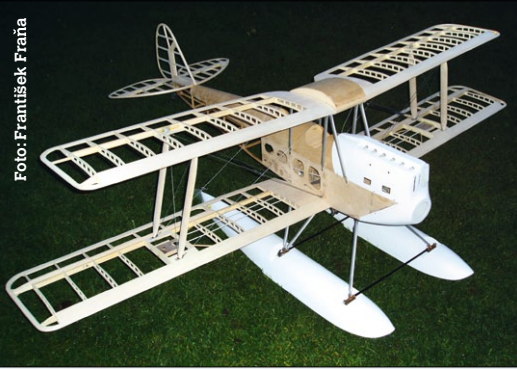
In klassischer Holzbauweise entstand die Ca. 100. Die Schwimmer sind aus GFK-überzogenem Styropor
