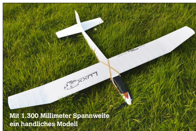
Tragwerk und Leitwerk liegen parallel zueinander, das Seitenruder steht senkrecht dazu
