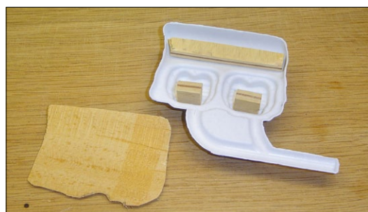
In die Zylinderattrappen eingepasste Füllklötze ermöglichen eine Verschraubung der Inlays
