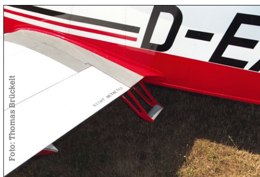
Der Einstieg in die Monsun erfolgt jeweils von hinten über die Tragflächen-Wurzel
