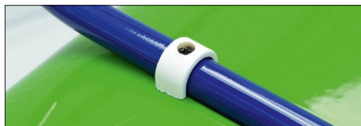
Mit vier Schrauben wird das fertige Kufenlandegestell am Rumpf montiert. Weiße Verkleidungs-Halbschalen, die aufgeklebt werden, sorgen für Scale-Look
