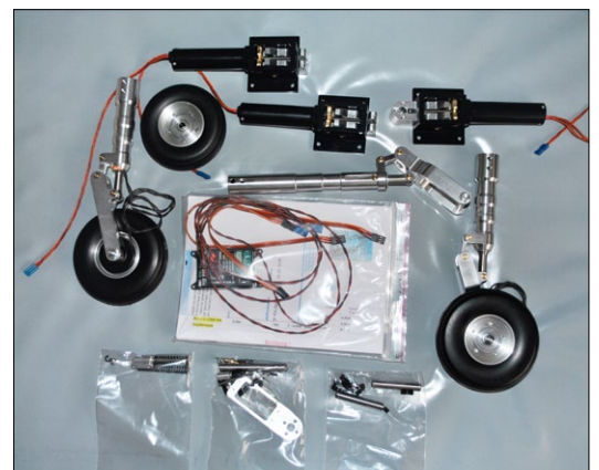
Ein Komplettsset eines elektrischen Fahrwerks von Behotec für eine große Futura. Dabei ist auch die Steuerelektronik, an die noch die elektrischen Bremsen angeschlossen werden
