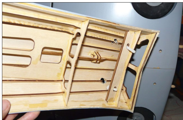
Mit vier Kunststoffschrauben wird die Rumpfanformung –Belly Pan – passgenau unter das Flügelmittelteil geschraubt
