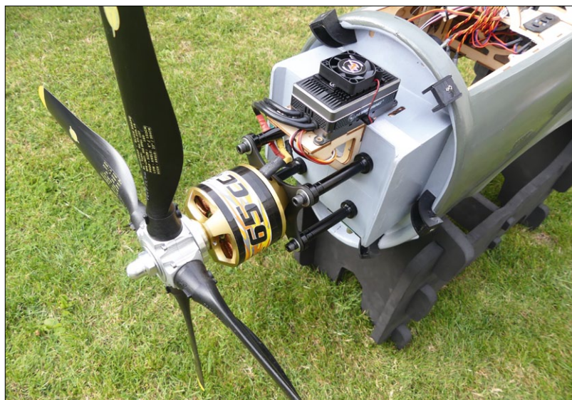
Die aktuelle Antriebseinheit mit dem starken Brushless-Außenläufer Rimfire 65 cc, der leider im Test Probleme bereitete. Der gezeigte Ventilator aus dem Lieferumfang des Reglers Platinum HV-160 passt von der Höhe nicht unter die Motorhaube
