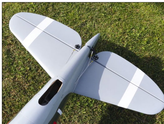
Das Höhenleitwerk ist mittels Rohrsteckung gelagert und passt perfekt an die Profilanformung des Rumpfs
