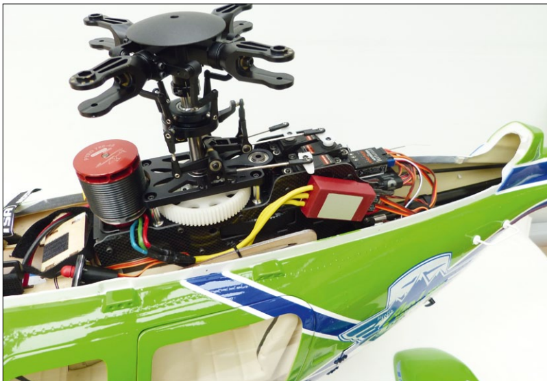
So gut ist die gesamte Mechanik zugänglich, wenn beide Hauben demontiert sind. Der Controller sitzt am Chassis
