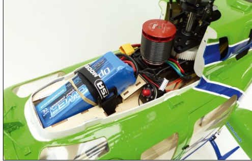
In der geöffneten „Besenkammer“ lässt sich einer der beiden 6s-LiPos unterbringen, der andere kommt nach oben
