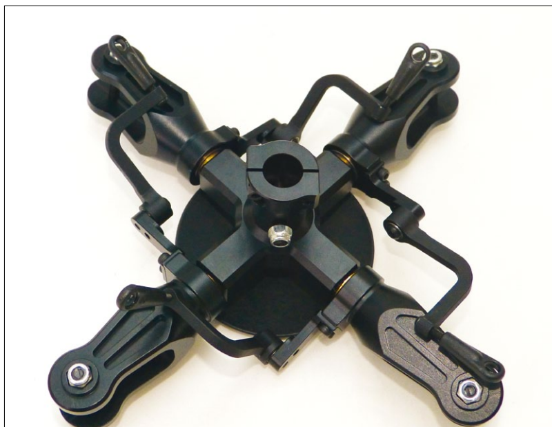
Der Vierblatt-Hauptrotor wird mit 4-Millimeter-Bolzen auf der 12er-Rotorwelle fixiert
