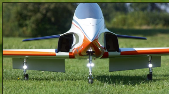
Landescheinwerfer aus dem Uni-light-Sortiment, tief gesetzte Klappen, große Lufeinläufe und modernes Finish – diese Futura hat was
