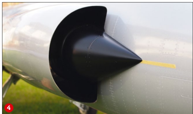
Das Schubrohr wird später über den Trichter mit den Sperrholzaufnahmen verschraubt (3)
