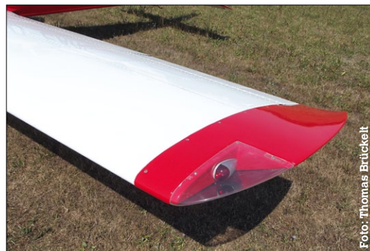
Der GFK-Tragflächen-Randbogen beherbergt die Positionslampen
