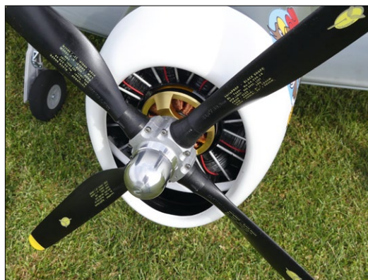
Der in der Steigung verstellbare 23,6-Zoll-VarioProp vor der Motorhaube mit Sternmotor-Attrappe und allen Details aus dem Bausatz
