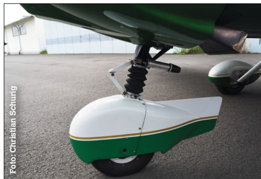
Ausgeliefert wurde die D-EAIG im Jahr 1972 mit einziehbarem Bugfahrwerk, heute ist es aus Sicherheitsgründen fest arretiert
