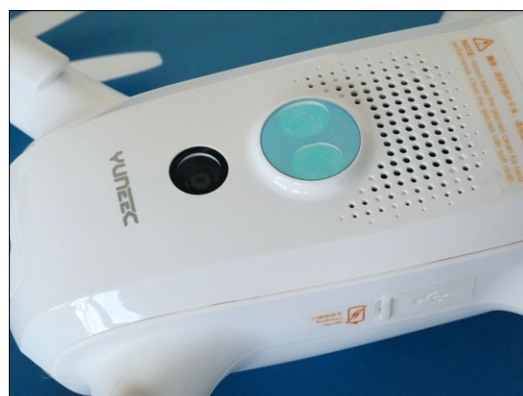
Sensoren im Bauch der Breeze 4k tasten den Boden ab und helfen bei der Höhenkontrolle
