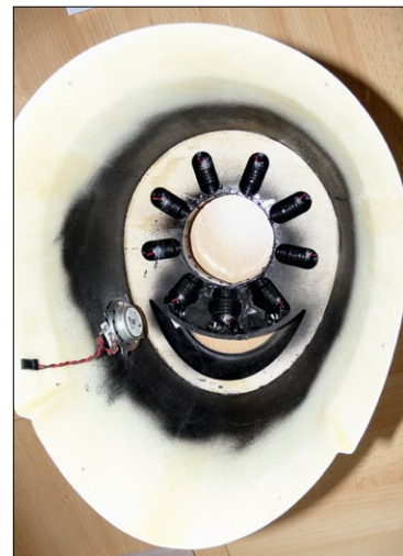
Der passgenaue Holzspant mit Sternmotor-Attrappe. Der in die Motorhaube geklebte Spezial-Lautsprecher des Soundmoduls überträgt den Schall auf die Motorhaube
