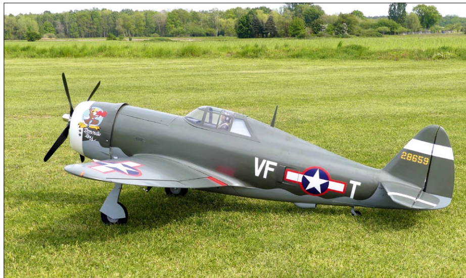
Der 1.905 Millimeter lange Warbird ist ein Hingucker. Auf dem GFK-Rumpfdach sieht man die mit Magnethalter positionierte Antenne
