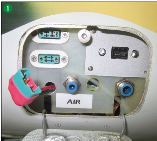
Bei Scalemodellen findet man die Verschlüsse zum Tanken und Füllen mit Druckluft inklusive den Schaltern unter verdeckten Klappen. Wichtig ist, dass man die Tankverschlüsse für Kerosin oder Benzin und Luft sicher kennzeichnet und mit unterschiedlichen Durchmessern trennt, wie hier das Tanken mit einem 6 und die Luft mit einem 4 Millimeter selbstsperrendem Festo-Anschluss (1). Die Steuereinheit des elektrischen Fahrwerkes von Behotec. Das System wird mit einem 2s-LiPo mit Strom versorgt (2)
