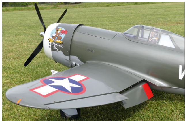
Die Motorhaube hat seitlich und oben angeformte, nach hinten aufgestellte Klappen, die einen optimalen Kühlluftdurchsatz gewährleisten
