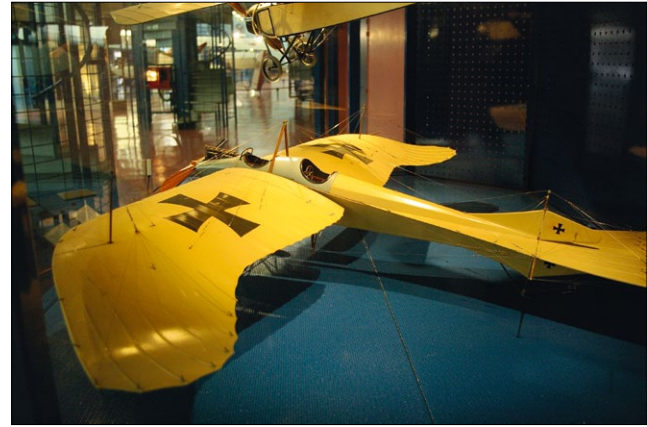
Abbildung 5: Die Etrich Taube besaß eine Mischlösung aus Flächenverwindung und Querrudern
