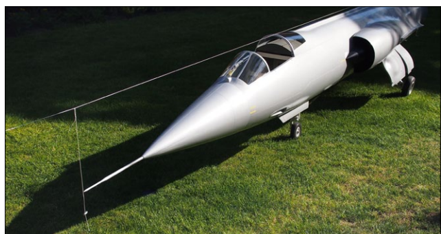
Mit Hilfe einer Schnur und einem Lot kann die Nase zur Verklebung sauber ausgerichtet werden
