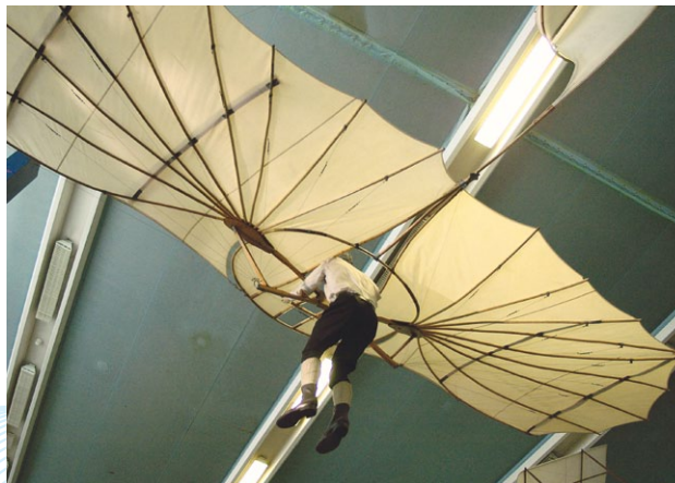
Abbildung 3: Der Lilienthal-Gleiter wurde nur durch Gewichtsverlagerung gesteuert
