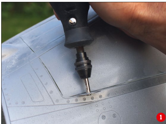
Das Ausfräsen des Haubenrahmens erfordert eine ruhige Hand (1). Die Cockpitscheiben sind verklebt und zur Trocknung mit Magneten fixiert (2)
