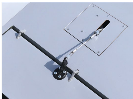
Die fertig angelenkte Landeklappe, bei der der Ruderhebel mittels selbstschneidender Schrauben in die unter der Beplankung liegenden Hartholzklötzchen geschraubt wurde
