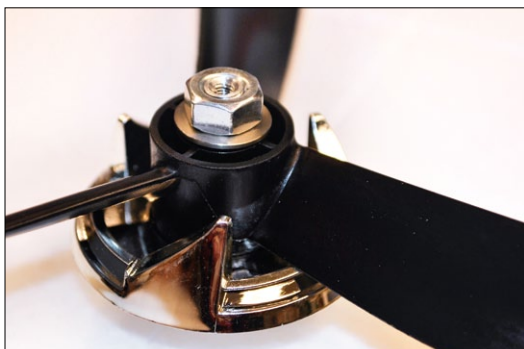
Der Propeller mit dem schon montierten Rückteil des Spinners, der dann nur noch eingeklipst wird
