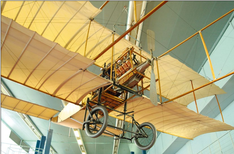
Abbildung 4: Die dünne Profilierung in den Anfängen der Motorfliegerei ließ eine mäßige Flächenverwindung zu – optimal war es nicht
