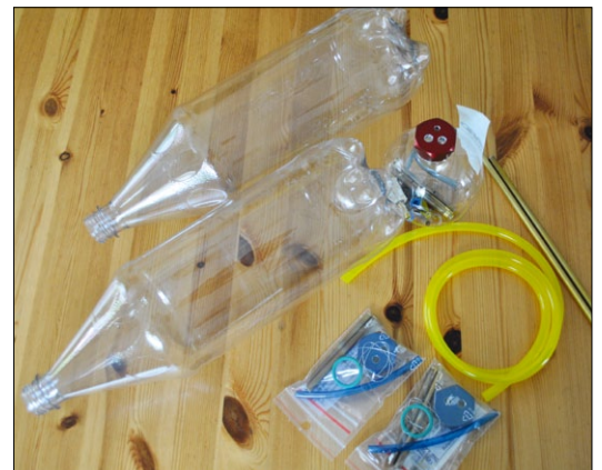
PET-Flaschen eignen sich nicht nur als Benzintanks, auch als Drucklufttanks finden sie Verwendung. Hier sind auch die Aluminiumverschlüsse von Markus Richter zu sehen
