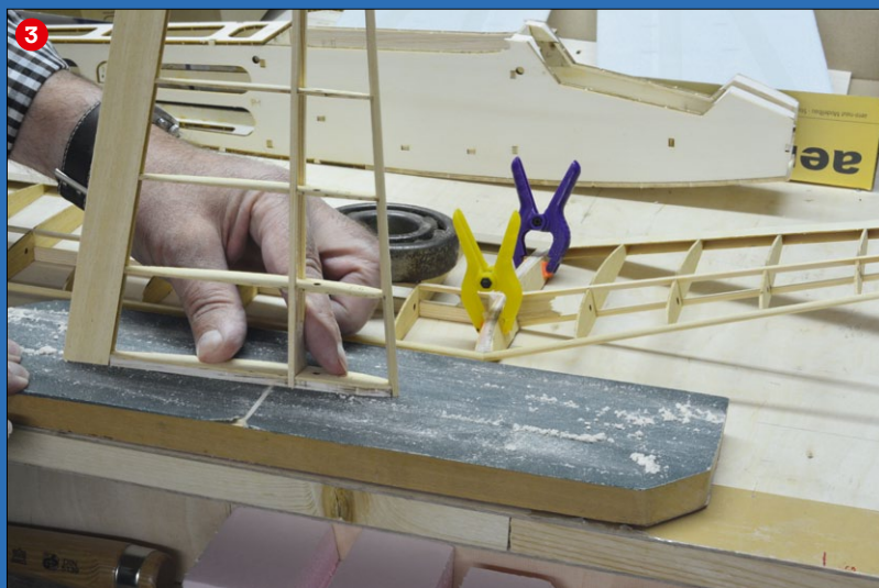
Für einen exakten Planschliff ist solch ein Schleifpapierbrett hilfreich (3)
