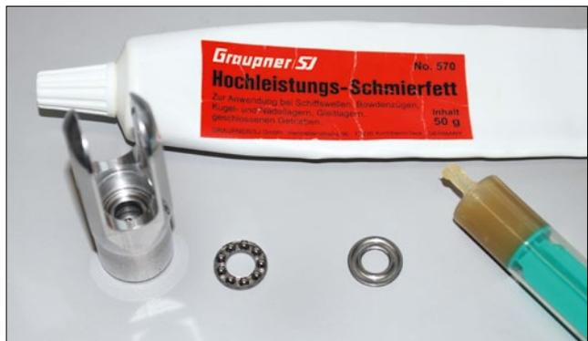
Die Drucklager werden vor dem Einbau geschmiert
