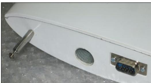
An der Wurzelrippe findet sich ganz vorne der Haltezapfen für die Mono-Block-Flächenbefestigung und natürlich ist auch der Sub-D-Stecker für die elektrische Verbindung der Flächenservos schon passend eingebaut
