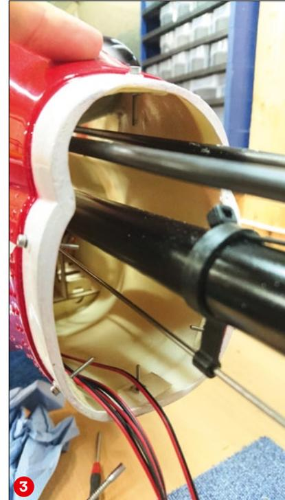
Klebe-Helling aus Pappdeckel für Höhenleitwerk (1). Unterbringung der beiden 6s-LiPos im Rumpfbau (2). Deutlich zu erkennen sind das Heckrohr, darüber die Streben und darunter das Heckgestänge (3)
