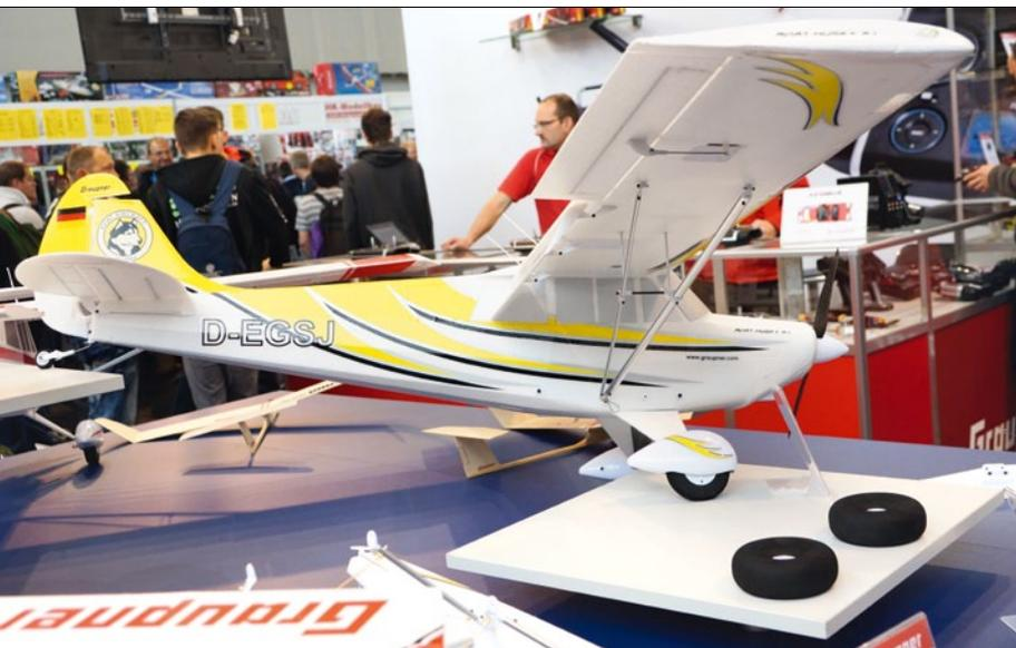
flug-Einstieg. Im Baukasten befinden sich alle Teile, welche zum zügigen Aufbau des Modells benötigt werden. Neben den bedruckten EPP-Bauteilen enthält das Kit sämtliche CFK-Holme und -Abstreibungen, einen CFK-Fahrwerksbügel, Räder, Anlenkteile sowie eine ausführliche Bauanleitung.
