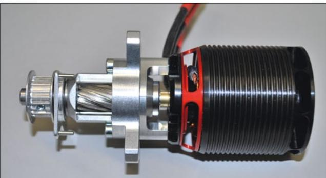
Die montierte Motor-Getriebeeinheit. Zu erkennen ist das schrägverzahnte Ritzel sowie das Riemenrad für den Heckrotor
