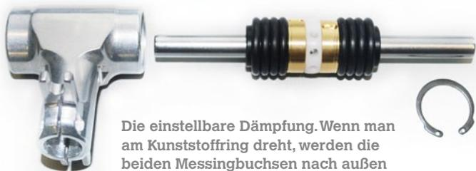
Die einstellbare Dämpfung. Wenn man am Kunststoffring dreht, werden die beiden Messingbuchsen nach außen bewegt und die Blattdämpfung erhöht
