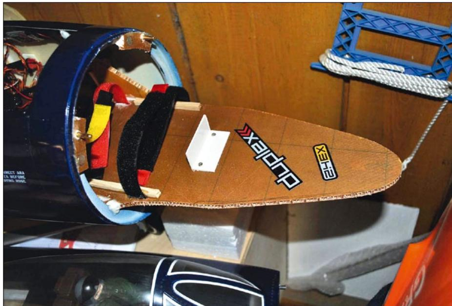
In die demontierbare Rumpfspitze ragt eine stabile, leichte Honeycomb-Platte als Akkuauflage
