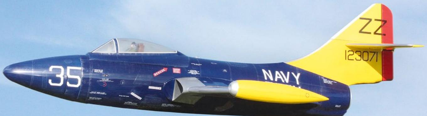
Ausgestattet mit einem 120er-Impeller und 12s-LiPos sind bis zu 6 Minuten Flugzeit möglich
