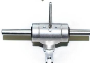
Mittels des Splints wird die Spannschraube gedreht und die Messingdruckmuttern bewegen sich nach außen und erhöhen die Blattdämpfung
