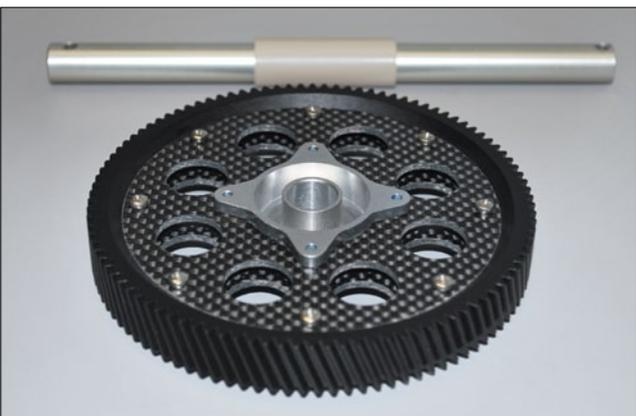
Hauptzahnrad und Hauptrotorwelle mit der Distanzbuchse aus Kunststoff. Das Hauptzahnrad aus Delrin und mit Kohlefaser-Speichen hergestellt
