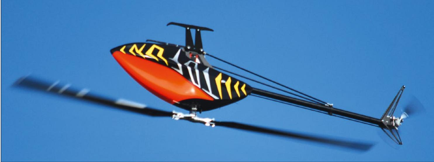
ausgestattet. Im Graupner-Sender mc-20 wurden drei Flugzustände mit unterschiedlichen Drehzahlen – 1.300/1.560/1.800 Umdrehungen pro Minute (U/min) – und Kreisel-Empfindlichkeiten eingestellt. Besonders der Heckrotor muss bei höheren Drehzahlen und Geschwindigkeiten von seiner Kreiselwirkung reduziert werden, um das System nicht aufschwingen zu lassen. Als Flugakku werden SLS Quantum-Akkus (2 × 6s) mit 30C und 65 C sowie einer Kapazität von 4.500 Milliamperestunden (mAh) verwendet.
