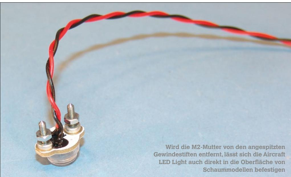
Wird die M2-Mutter von den angespitzten Gewindestiften entfernt, lässt sich die Aircraft LED Light auch direkt in die Oberfläche von Schaummodellen befestigen
