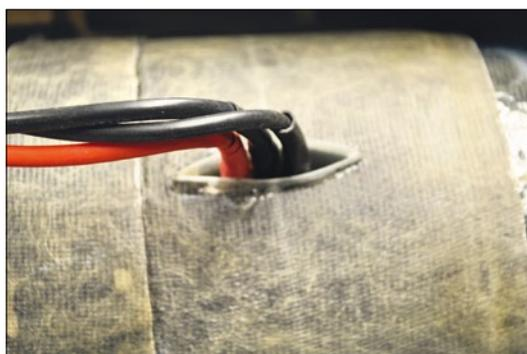
Eine saubere Umströmung der Impeller-Motorkabel war durch zwei GFK-Platten möglich
