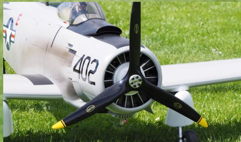
Unter der Haube ist ein DA85 verbaut, der die CFK-Dreiblattluftschraube dreht
