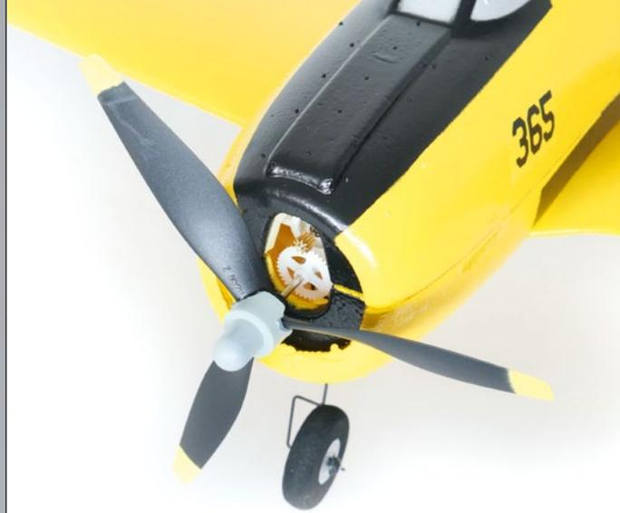
Die Bürstenmotor-Getriebe-Einheit erlaubt in Kombination mit dem Dreiblattpropeller kraftvolle Steigflüge
