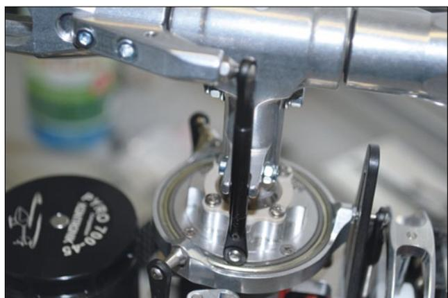
Der Rotorkopf wird mit einer zentralen M4-Schraube montiert und mit zwei M3-Schrauben zusätzlich auf der Rotorwelle geklemmt
