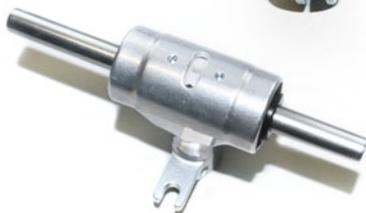
Die Blattlagerwellen-Dämpfung wurde ins Zentralstück eingeschoben. Gehalten wird das Dämpfungspaket durch jeweils einen Seegering im Zentralstück, der ein Herausrutschen verhindert
