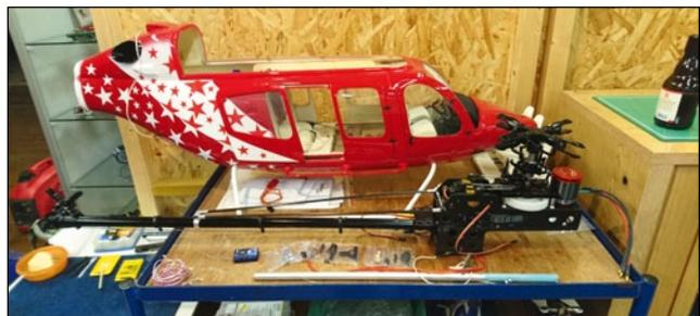
Die Mechanik ist aufgerüstet und bereit für die Montage im Rumpf
