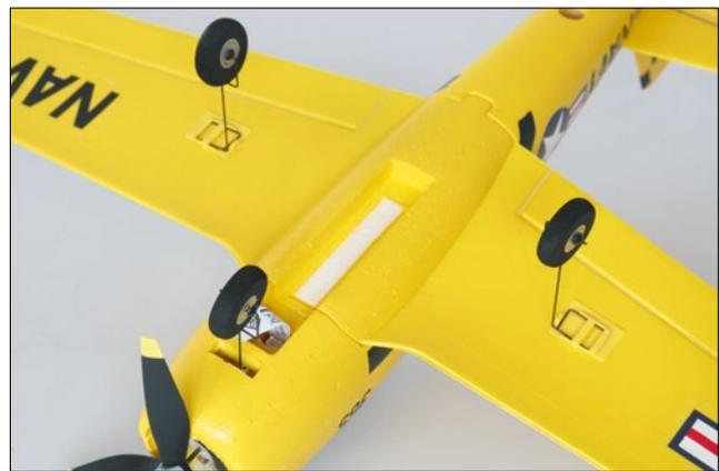
Das Dreibeinfahrwerk sollte man demontieren, wenn keine Hartbahn zur Verfügung steht
