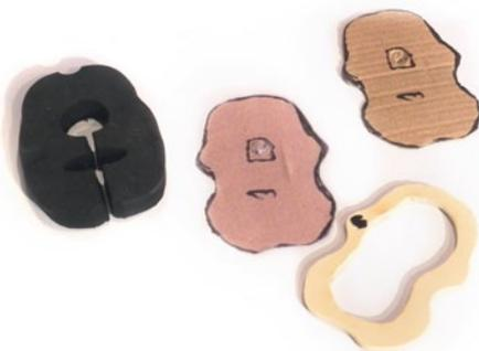
Statt des serienmäßigen Schaumstoffspants zur Führung des Heckrohrs kommt ein selbstgefertigter Holzspant zum Einsatz – eine Pappschablone half beim Erstellen
