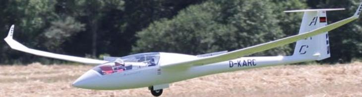
Zur Landungen stehen doppelstöckige Schempp-Hirth-Störklappen sowie die Butterfly-Stellung zur Verfügung, dadurch lassen sich kontrolliert Höhe und Fahrt abbauen
