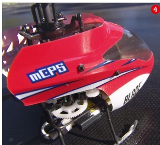
Eines der drei Linear-Taumelscheiben-Servos (Roll rechts) in der Nahaufnahme. Am oberen Ende der Spindel befindet sich ein Kugellager (1). Nicht nur beim Hauptrotorantrieb arbeitet ein leistungsstarker Innenläufermotor, sondern auch am Heckrotor. Das sorgt für hervorragende Heck-Performance (2). Die Kunststoff-Hauptrotorblätter haben serienmäßige Schwerpunktnasen zur optimalen Massenverteilung und Schwerpunktlage (3). Die Kabinenhaube wird über O-Ringe an vier Punkten des Chassis fixiert (4)
