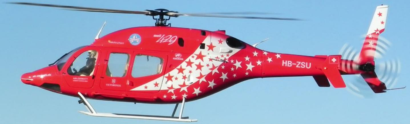
Mit einem 12s-Setup ausgestattet, lassen sich bis zu acht Minuten Flugzeit erzielen
