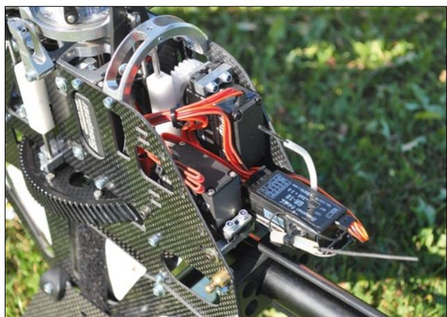
Auf der Lagerplatte wurde der Flybarless-Empfänger Graupner GR18 mit doppelseitigem Klebeband befestigt
