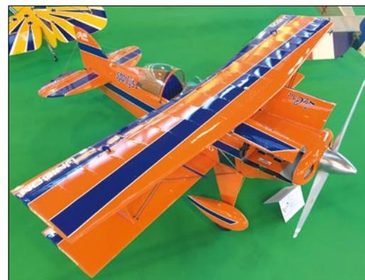
Mit Vierzylindermotor von Kolm ausgestattete Pitts S1-C mit 2.300 Millimeter Spannweite von Tom Bogner
