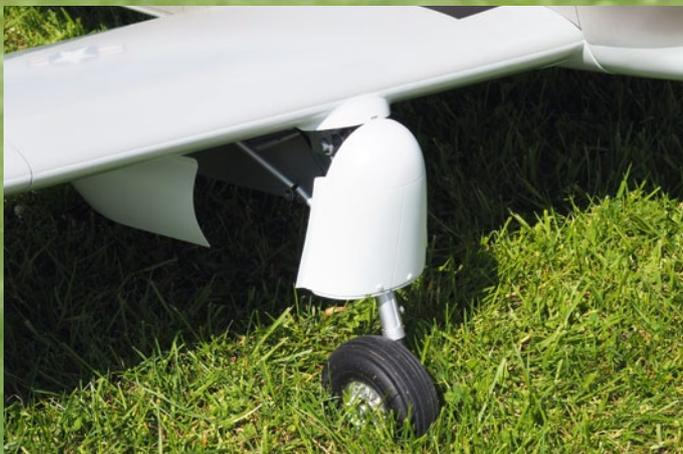
Das Fahrwerk wird beim Einziehen um 90 Grad gedreht
