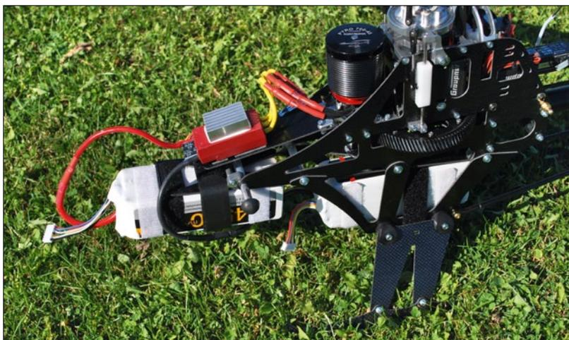
Der Jive Pro 120+ wurde mit einem Kühlkörper versehen. Dieser ist mit wärmeleitenden Zweikomponenten-Epoxidharz aufgeklebt
