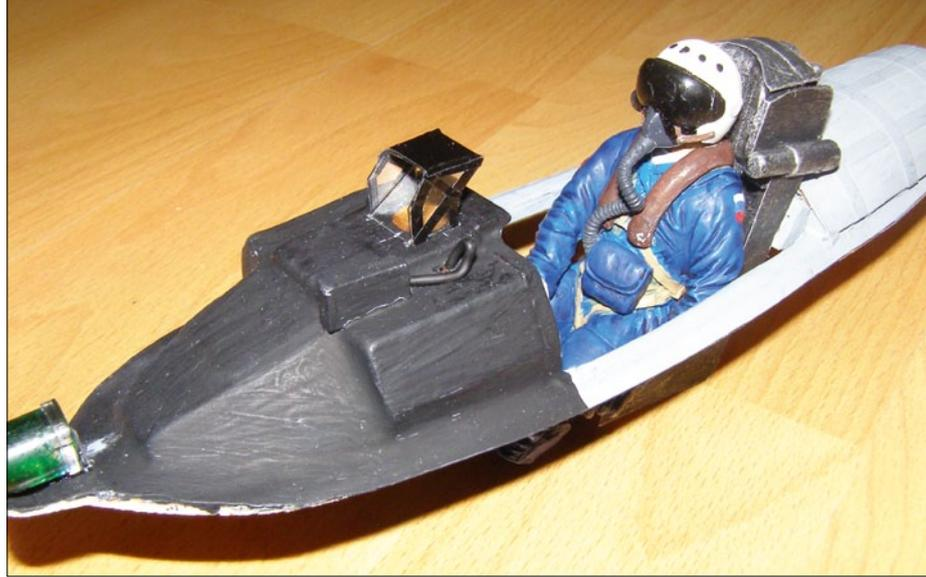
Ideal für einen Semiscale-Jet ist die Andeutung eines Cockpits. Farbe, eine Figur und hier ein Headup-Display sorgen für Eindruck
