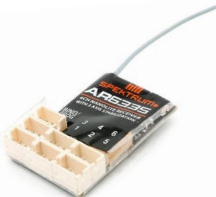
Abbildung 5: Ein Lageregler kann helfen, eine zu geringe Querachsenstabilität aktiv zu erhöhen
