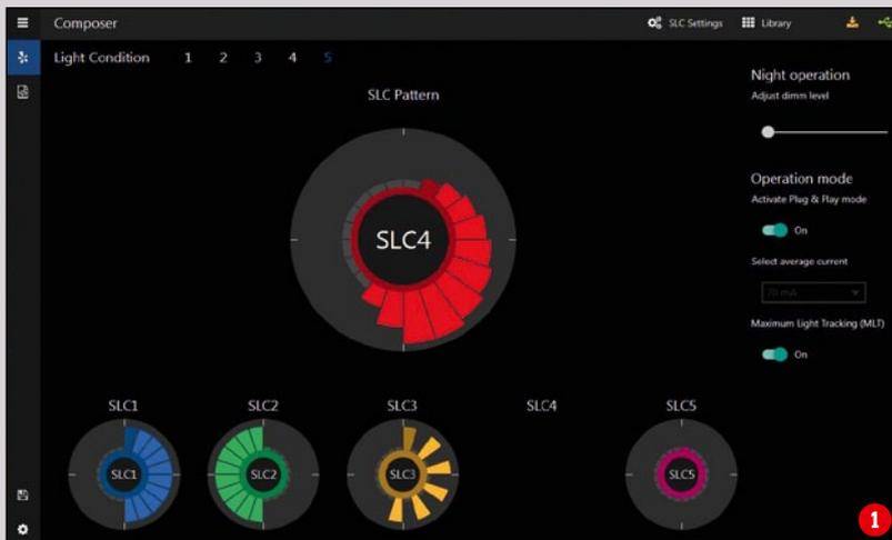
**Composer:** Das Herzstück der Programmierung ist der Composer. Jeder Lichtkanal (SLC) ist farblich gekennzeichnet und lässt sich völlig intuitiv per Maus mit drag&drop bearbeiten. Wir befinden uns gerade in Light Condition 5 und haben für SLC 4 die Settings mit eingeblendet. SLC 1 und SLC 2 lassen hier gerade die beiden LED im Gegenteil blinken (1)
