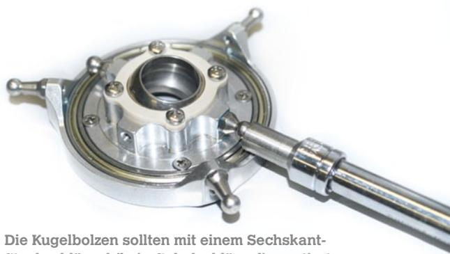
Die Kugelbolzen sollten mit einem Sechskant-Steckschlüssel (kein Gabelschlüssel) montiert werden, um kraftschlüssiger auf den Kugelbolzen einzuwirken und das Gewinde nicht zu beschädigen
