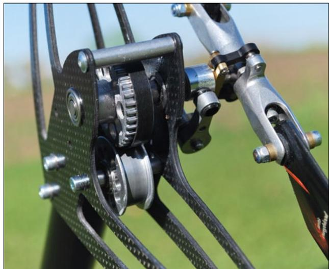
Die Umlenkrolle und die Zahnriemenscheibe des Heckrotors sitzen zwischen den Seitenleitwerken. Die Umlenkrolle sorgt dafür, dass der Zahnriemen nicht von der Zahnriemenscheibe abspringt
