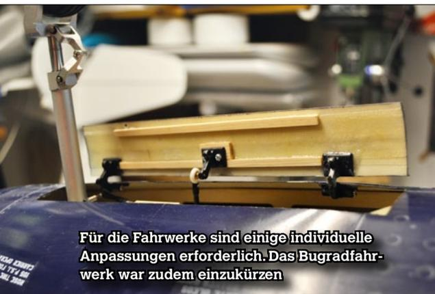
Für die Fahrwerke sind einige individuelle Anpassungen erforderlich. Das Bugradfahrwerk war zudem einzukürzen
