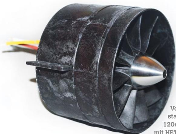
Von e-Jets.at stammt der 120er-Impeller mit HET-Motor
