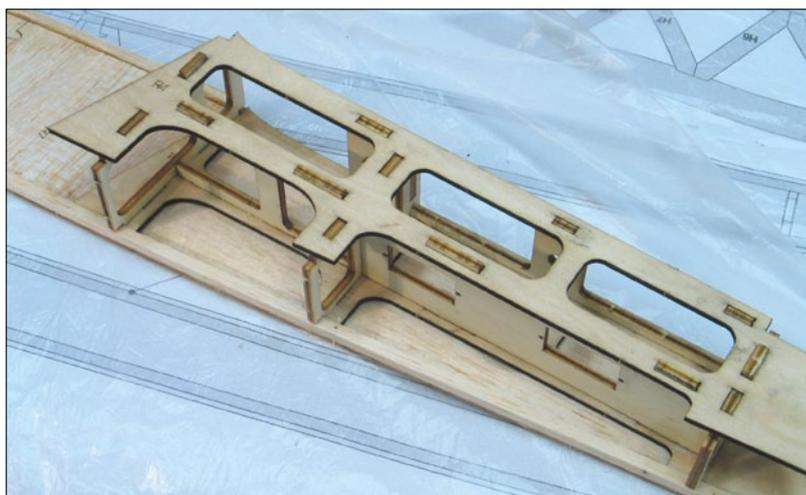
In der Rumpfmittle sorgt ein stabiler Sperrholzkasten für Festigkeit und Verzugsfreiheit
