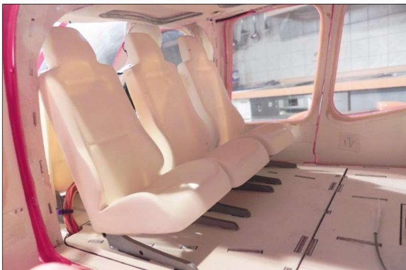
Der Akkuschacht wird später mit der Sitzbank-Einheit verschlossen
