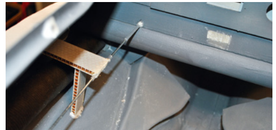
Einmal komplett durch den Rumpf, seitlich und abgestützt geführt, verläuft die Lenkstange für das Seitenruder
