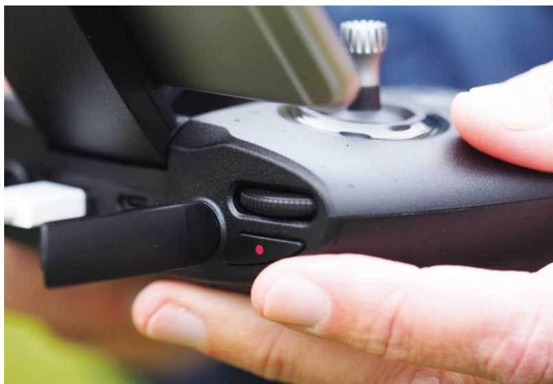
Filmaufnahmen oder Fotos lassen sich entweder über ein Icon auf dem Display starten, der Taste am Sender – das Rollrad dient zum horizontalen Schwenken der Kamera – oder per Sprachbefehl
