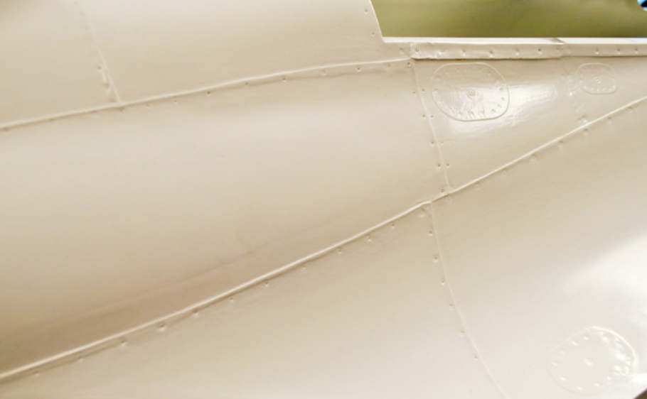
Ab Werk sind Plattenstöße, Nieten, Deckel und viele weitere, rumpftypische Merkmale in den GFK-Rumpf eingearbeitet
