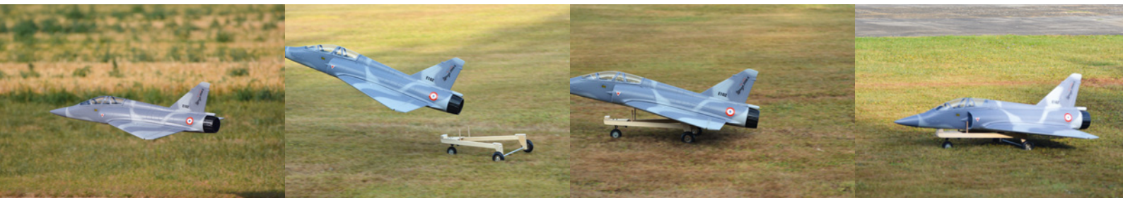
Die Mirage lässt sich sicher starten, da der Startwagen steuerbar ist
