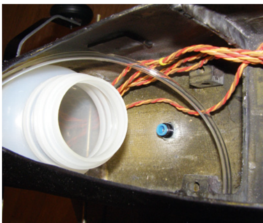
Das Tanksystem wurde ebenfalls neugestaltet, um hier Problemen durch Lecks oder ähnlichem aus dem Weg zu gehen
