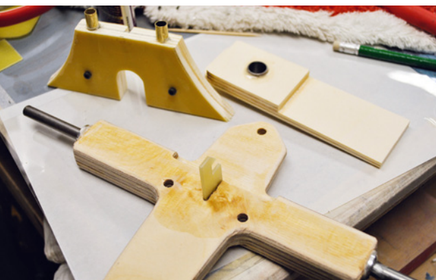
Teile für das Fahrwerksgestell und die Arretierungsbeziehungsweise Abwurf-Halterung im Rumpf
