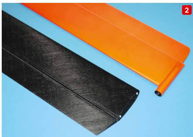
Bei den Querrudern wird eine Überkreuzanlenkung realisiert (1). Die beiden Leitwerkshälften besitzen im unteren Bereich jeweils eine Hülse, die später einfach über die CFK-Leitwerksträger aufgeschoben wird. Der obere Bereich des Dachleitwerks ist miteinander verzapft und wird mit einem Stück Klebeband gesichert (2). Die Leitwerksträger besitzen auf der einen Seite die Aufnahme für das jeweilige Leitwerksservo, auf der anderen Seite sind sie mittels CFK-Rovings verstärkt (3). Die kleinen KST-Servos werden häufig bei F3K-Modellen eingesetzt und auch bei der Ansteuerung der Leitwerksrudder vom Plus haben sie sich bislang sehr gut bewährt (4)
