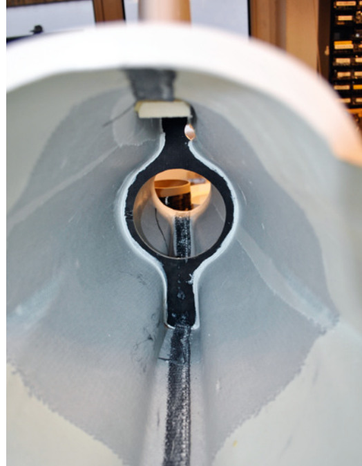
Bereits werkseitig eingeharzt ist dieser CFK-Spant zur Aufnahme des Schubrohrs
