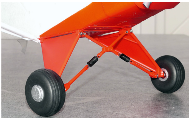
Das Fahrwerk ist sehr schön scale ausgeführt. Nur sollte man vor dem Start schauen, dass die beiden schwarzen Federn mit dem Gestänge fluchten. Wenn sie sich verdrehen, stimmt die Spur nicht mehr
