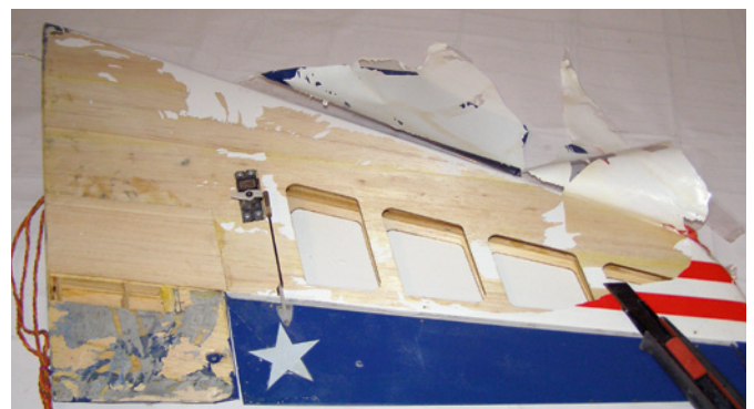
Die alte Bespannfolie war komplett zu entfernen, was sich als durchaus knifflige Aufgabe darstellte
