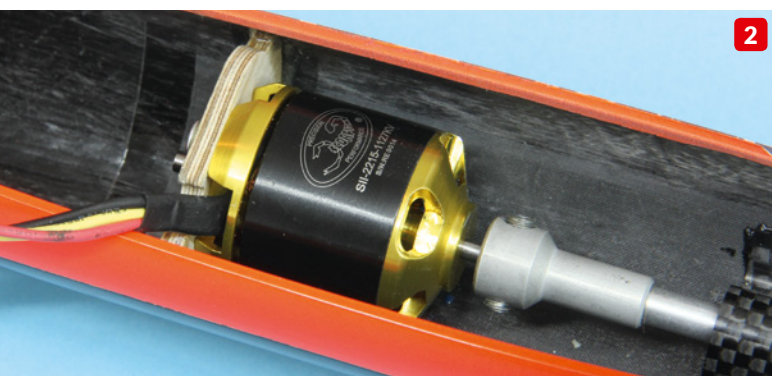
Ein Blick ins Rumpfinnere zeigt den bereits verklebten Motorspant und die Fernwelle samt CFK-Abdeckung (1). Der Motor ist verschraubt und mit der Fernwelle gekoppelt. Zum Einbau muss die Motorwelle gelöst werden, sonst bekommt man den Treibling nicht an Ort und Stelle (2). Die Servos müssen nur noch mit ihrem Abtrieb versehen, in die Rahmen geschraubt und in die Verlängerungskabel eingesteckt werden (3). Der Kabelbaum zum Empfänger ist fix und fertig eingebaut, ebenso die Servorahmen mitsamt den LDS-Anlenkungen (4)
