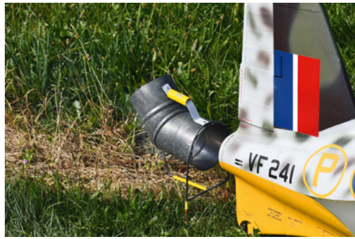
Um die typischen Brandspuren im Gras zu vermeiden, hilft dieses Ofenrohr-Gestell, das einfach hinter der Düse platziert wird
