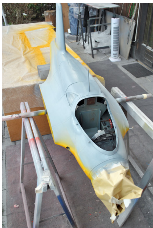
Nach dem Grundieren wurde der untere Bereich gelb lackiert
