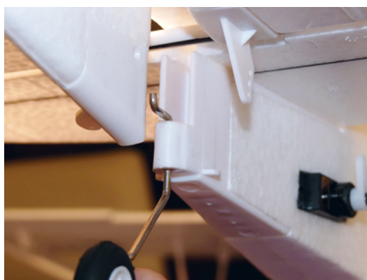
Vor dem Aufstecken der Seitenleitwerksfinne muss der Draht des Spornfahrwerks in das Seitenruder eingeführt werden. Allerdings verursachte die ungedämpfte Anlenkung nach kurzer Betriebszeit einen Servo-Ausfall
