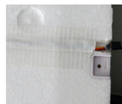
Die Kabel der Flächenservos sind viel zu lang. Man kann sie kürzen und neu verlöten. Stattdessen wurde beim Testmodell mit dem Lötkolben eine breitere Furche gebrannt, das Kabel in einer Schleife eingelegt und mit Klebeband gesichert
