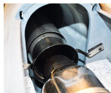
Das Schubrohr stammt von Turbo-Didi und passt sich sehr gut in die Me-163 ein. Hier noch im Bild ist die JetCat P160
