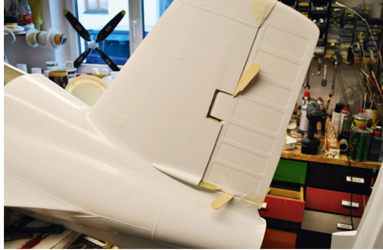
Eine einfache, hochstabile Lagerung des Seitenruders am Rumpf reicht völlig aus
