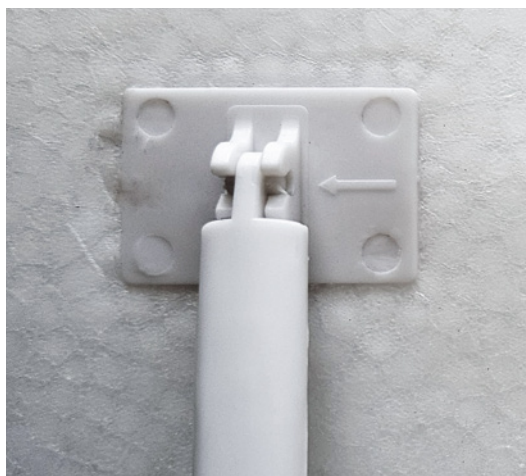
Die Flächenstreben und die kleineren Abstandstreben werden nur in die jeweilige Halterung am Flügel geklickt. Entgegen der anfänglichen Skepsis hält die Konstruktion auch bei hoch belastenden Flugfiguren
