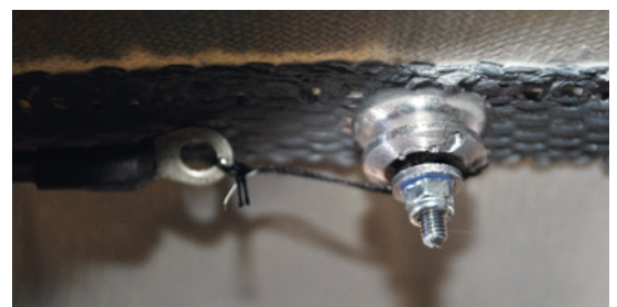
Um die Kabinenhaube sicher am Rumpf zu fixieren, wird sie unter anderem hinten durch einen CFK-Stift fixiert. Der ist wie ein Kugelschreiber mit einer Feder in einem Rohr gelagert und lässt sich über ein Seil ziehen, das an der drehbar gelagerten Antenne befestigt ist
