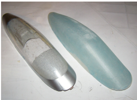
Die gerissene Cockpithaube wurde gegen eine neue ohne Verglasung ersetzt. Erstere diente aber als Grundlage für den Formenbau
