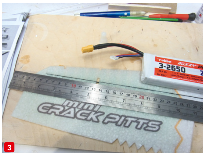
Diese Kleinteile werden als Ruderanlenkungen und Motorhalterung mitgeliefert (1). Kleine Nase, gute Idee! So passen die Rumpfdraufsicht und das Höhenleitwerk nur auf eine Art zusammen und Baufehler sind ausgeschlossen. Gut gemacht! (2). Entlang der Stahlschiene wurden die Schlitz in den Flächen für die CFK-Holme geschnitten. Der große LiPo dient nur als Gewicht zum beschweren (3). Auch beim Verkleben der Flächenstreben sollte man die Flügel mit Gewichten auf dem Baubrett fixieren (4)
