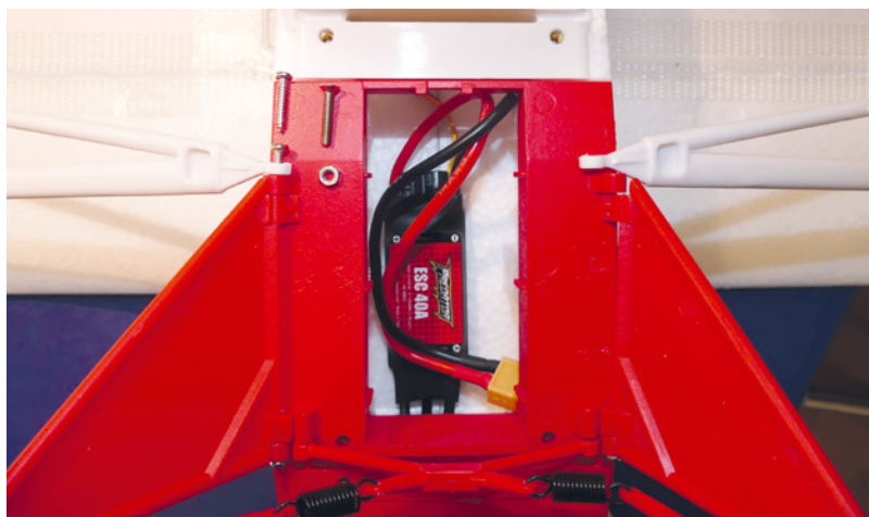
Der Akkuschacht muss von unten befüllt werden. Wer das Modell dafür auf den Rücken legt, sollte eine weiche Unterlage verwenden, damit die Flügel keine Dellen abbekommen. Die Flächenstreben werden bei Fahrwerksmontage per Blechtreibschraube gesichert. Sind die Schwimmer montiert, kommen Gewindeschrauben mit Muttern zum Einsatz
