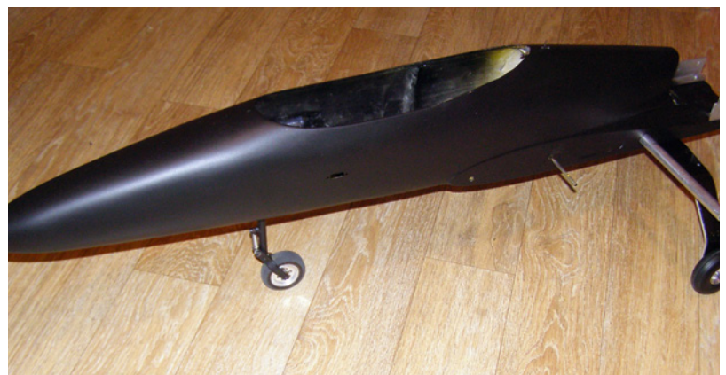
Der Rumpf wurde mit mattschwarzem Auto-Reparaturlack aus der Spraydose lackiert. Dieser Lack ist nicht treibstofffest, weswegen er mit einem Zweikomponenten-Acryl-Mattlack überlackiert werden musste
