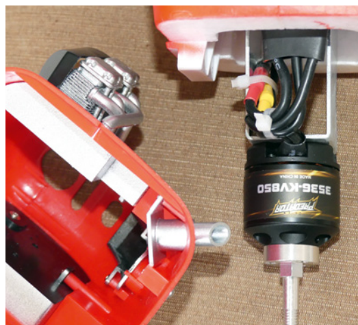
Der Regler wurde möglichst weit vorne positioniert und über die Kabel vor Ort gesichert. In dieser Konfiguration und einem 3s-LiPo-Akku mit 2.600 Milliamperestunden Kapazität stramm sitzend im Schacht stimmte der Schwerpunkt auf Antrieb
