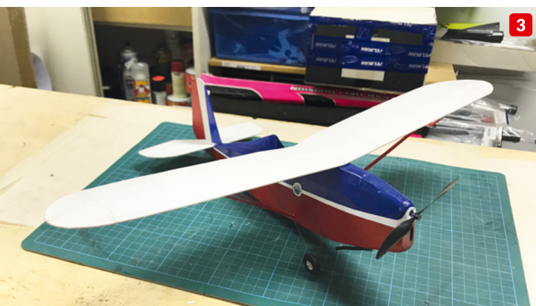
Versiegelt mit zwei Schichten verdünntem Nitro-Lack steht das Modell zum Lackieren bereit (1) Der Rumpf erstrahlt bereits in den Farben Rot und Blau, während der Flügel einheitlich weiß erstrahlt (2) Fertig montiertes und lackiertes Modell der Comper Swift (3)
