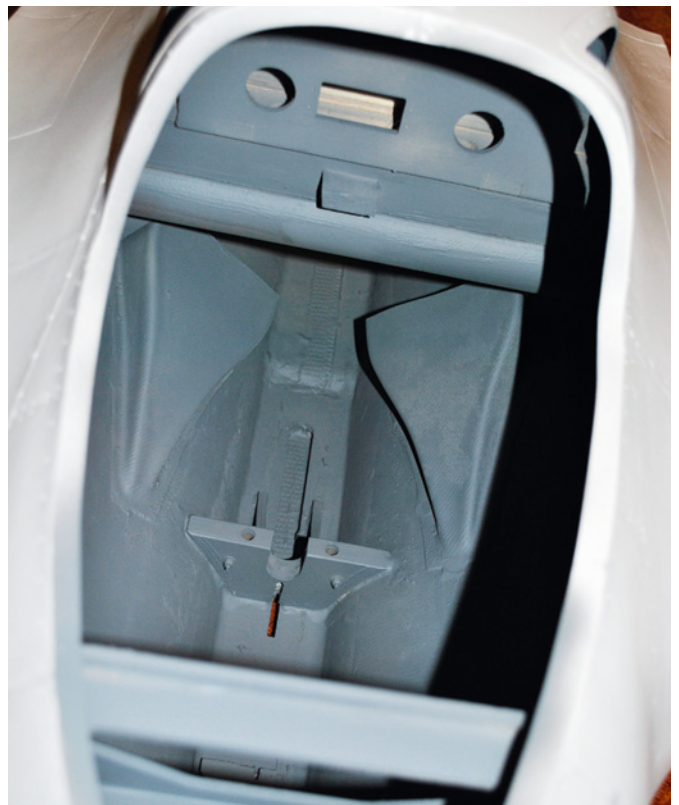
Nachdem alle Inneneinbauten erledigt sind, erfolgt eine Innenlackierung. Sie ist kein Muss, macht den weiteren Innenausbau aber aufgrund der cleanen Optik angenehmer
