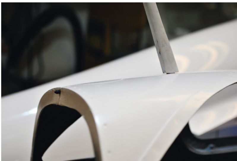
Um die Kabinenhaube sicher am Rumpf zu fixieren, wird sie unter anderem hinten durch einen CFK-Stift fixiert. Der ist wie ein Kugelschreiber mit einer Feder in einem Rohr gelagert und lässt sich über ein Seil ziehen, das an der drehbar gelagerten Antenne befestigt ist
