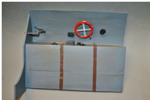
Der Kabinenrahmen aus GFK passt exakt auf den Rumpf. Hier sind schon die Scharniere verbaut
