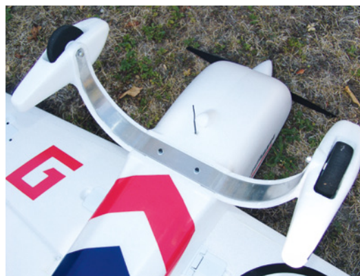
Der Fahrwerksbügel aus Aluminium ist mit zwei M3-Inbusschrauben verschraubt. Direkt davor verlässt die 2,4-Gigahertz-Antenne des Empfängers den dafür vorbereiteten Rumpf
