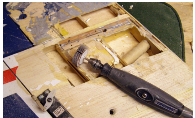
Mit einem Dremel ließen sich alle schwierigen Stellen bearbeiten beziehungsweise schleifen
