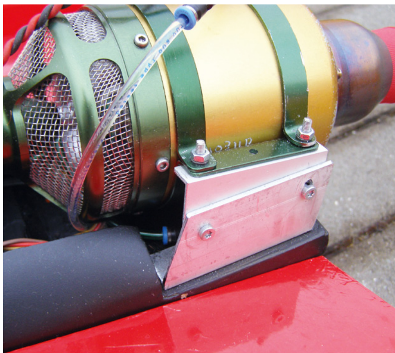
Um die Wren-Turbine sicher zu befestigen und auch den Sturz einstellen zu können, kamen Aluwinkel zum Einsatz
