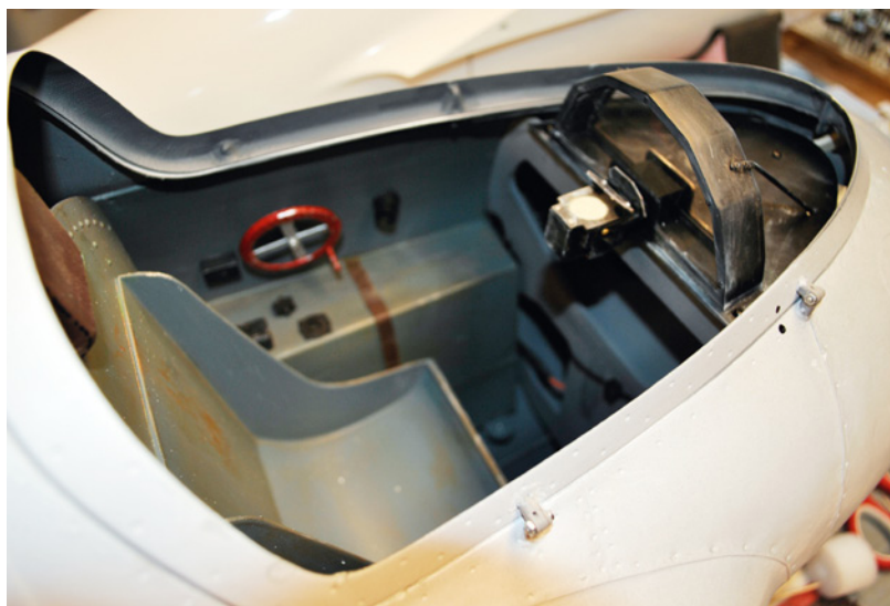
Der Kabinenrahmen aus GFK passt exakt auf den Rumpf. Hier sind schon die Scharniere verbaut
