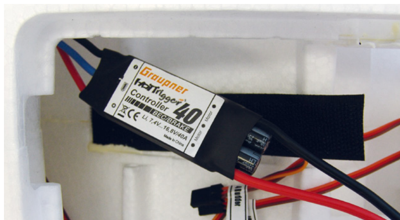
Motor und Drehzahl-Controller sind betriebsfertig montiert. Der Zugang durch die abnehmbare Klappe ist einwandfrei. Nach Einschieben von Akku und Empfänger kann es losgehen
