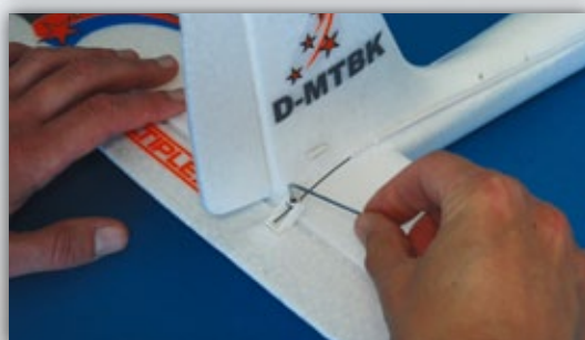
Eine Inbusschraube arretiert den Steuerdraht und lässt sich zwecks Demontage des Höhenleitwerks leicht wieder lösen
