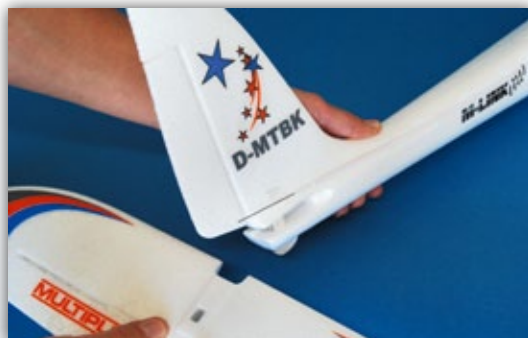
Beim Einschieben ist gleichzeitig das Anlenkungsgestänge in das Ruderhorn einzuführen
