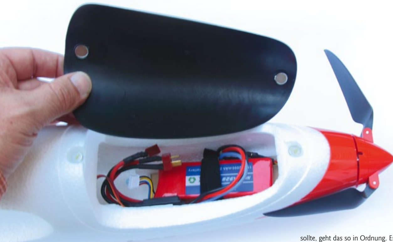
Der Rumpfausschnitt für den LiPo ist genau richtig dimensioniert
