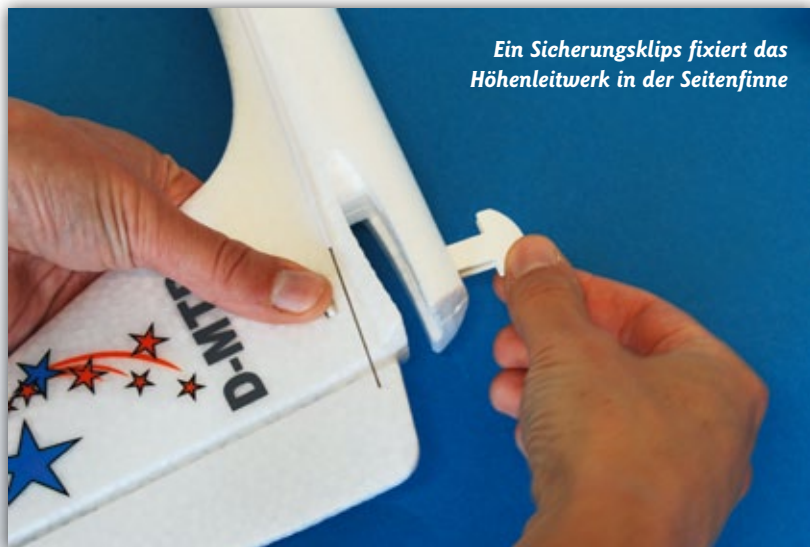
Beim Einschieben ist gleichzeitig das Anlenkungsgestänge in das Ruderhorn einzuführen
