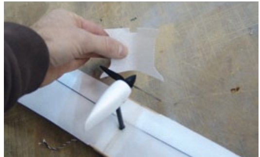
Der CFK-Pylonträger wird aerodynamisch im klassischen Stil mit dünnem Depron verkleidet
