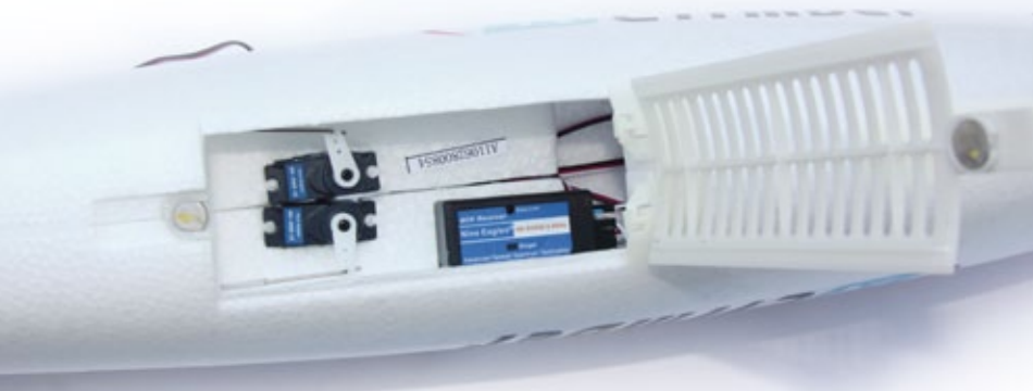
Die Anlenkung des Seitenleitwerks ist vollständig montiert
