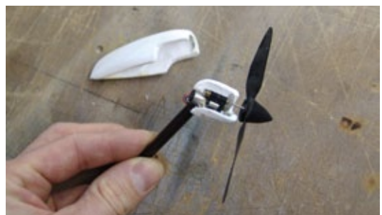
Ein 3 Gramm leichter Getriebeantrieb einer Minium-Cessna und eine vorhandene Motorgondel kamen in die Mini-Piuma
