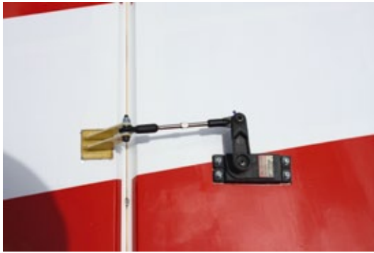
Bei der Yak-55 von GB-Models haben sich bei den Quer- und Höhenruderservos Gabriel-Gabelhebel mit 30 Millimeter Hebelarm bestens bewährt
