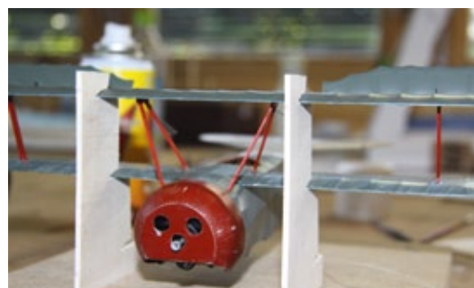
Eine verzugsfreie, EWD-optimierte Tragflächenmontage gelingt mit Hilfe einer Schablone
