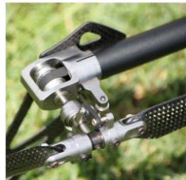
Auch der Heckrotor ist in Ganzmetall ausgeführt. Der Antrieb erfolgt über Zahnriemen, die Anlenkung ist extrem spielfrei
