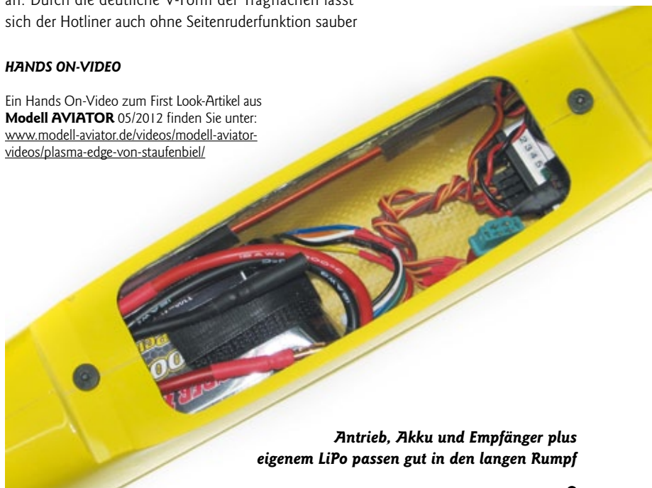
Die Stromversorgung wird samt Empfänger auf einem Brett befestigt, dann in den Rumpf eingeschoben und von unten mittels Schraube fixiert
