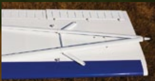
Klappbare Flächenstreben für einfachen Transport
