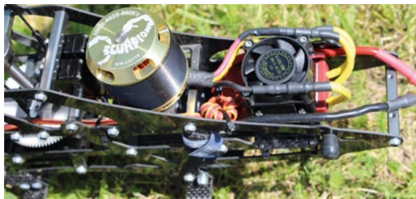
Der Scorpion-Antriebsmotor ist auf dem verschiebbaren Motorträger montiert. Der Controller sitzt unmittelbar davor
