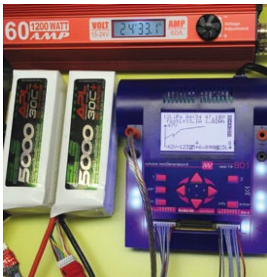
Das nG-14-801 stellt so viel Leistung bereit, dass beide 5s-LiPos in 20 Minuten vollgeladen werden könnten
