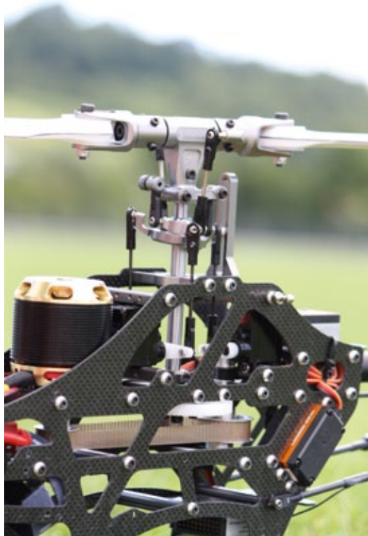
Die Taumelscheiben-Servos (Roll-Servos vorne, Nick-Servo hinten) sind innerhalb des Chassis platziert
