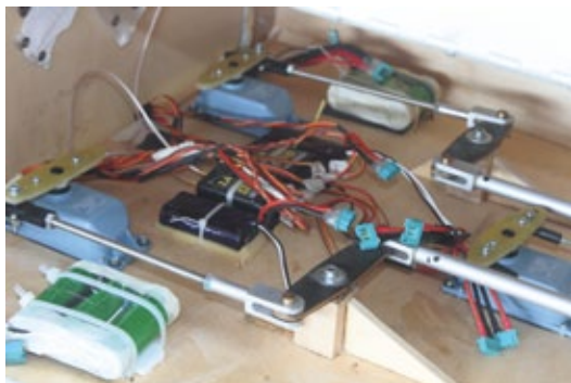
Spezialservos japanischer Herkunft und die Empfangsanlage von ACT europe
