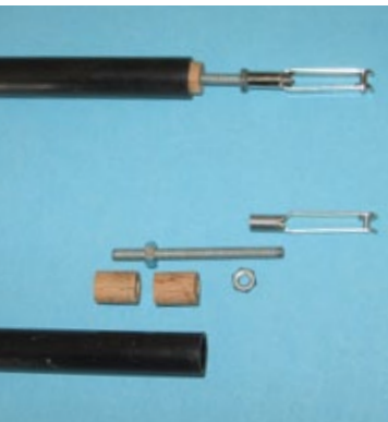
Der Übergang von der CFK-Schubstange fürs Höhenruder zum Gabelkopf wurde mittels Gewindestange und zwei Buchenholzdübeln realisiert
