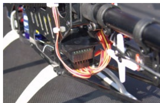
Im hinteren Bereich sitzt kopfüber der Spektrum-Empfänger, dessen Anschlussstecker von unten gut zugänglich sind. Der Satellit ist auf der Lagerleiste verstaut
