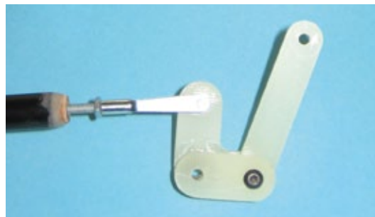
Der Umlenkhebel für das Pendelhöhenruder besteht aus mehreren GFK-Teilen. Die Lagerung sollte beidseitig im Rumpf erfolgen, deshalb wurde zusätzlich eine GFK-Lasche einlamiert. Da die gesamte Einheit verschraubt ist, kann diese im Bedarfsfall auch wieder ausgebaut werden
