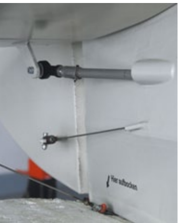
Abspannung und Ansteuerungen im Heck. Kräftig dimensioniert ist die Höhenruderschubstange
