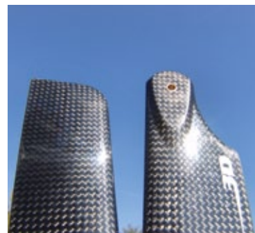
Die sehr harten CFK-Rotorblätter müssen mit Distanzscheiben in den Blatthaltern montiert werden
