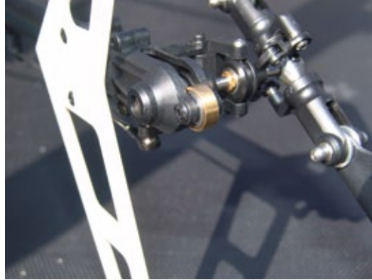
Der spielarme Heckrotor mit Riemen-Anlauflager. Propeller-Momentgewichte an den Blatthaltern reduzieren die aufzubringenden Steuerkräfte
