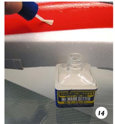
14 Vor dem Wiederaufbringen der Decals auf dem Ersatzrumpf unbedingt einen Haftvermittler, beispielsweise Mr. Mark Setter aus dem Plastikmodellbau, auftragen
