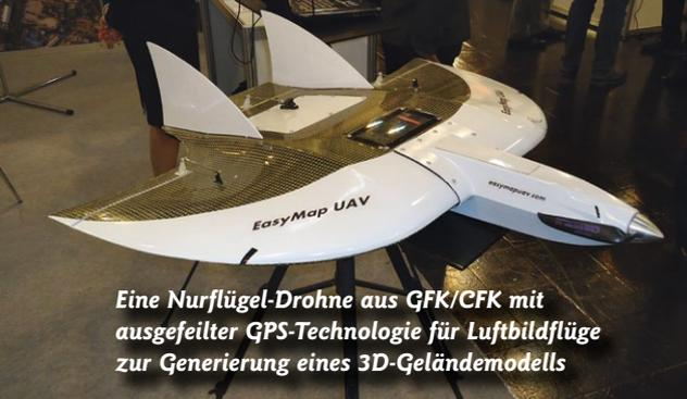
**Eine Nurflügel-Drohne aus GFK/CFK mit ausgefeilter GPS-Technologie für Luftbildflüge zur Generierung eines 3D-Geländemodells**
