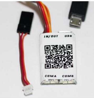
Der ALTIS V4 verfügt über einen Micro-USB-Port und zwei COM-Schnittstellen. Über USB werden Firmware-Updates aufgespielt, über die COM-Schnittstelle die Telemetriedaten zum Empfänger geschickt
