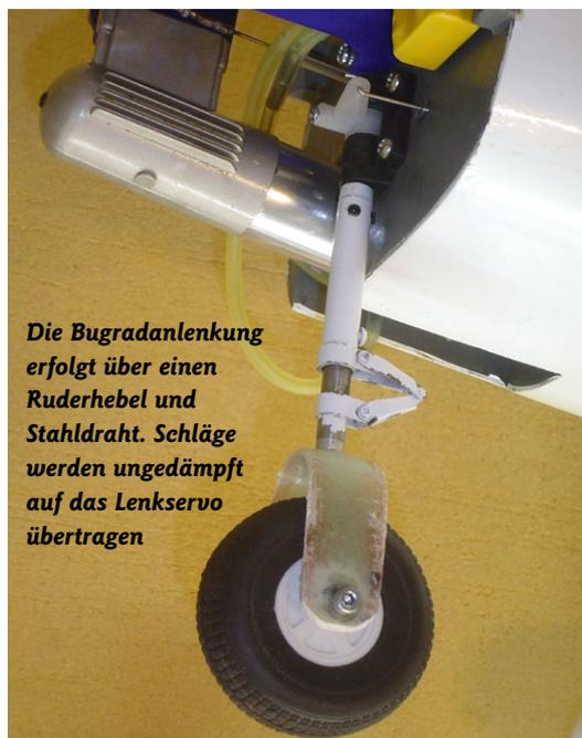
**Die Bugradanlenkung erfolgt über einen Ruderhebel und Stahldraht. Schläge werden ungedämpft auf das Lenkservo übertragen**
