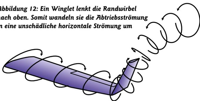
Eine weitere Möglichkeit ist, den schädlichen Wirbel in eine unschädliche Richtung abzulenken. Das geschieht durch Winglets. Durch sie wird der tragende Wirbel am Tragflächenrand in horizontale Richtung gekippt. Somit kann keine senkrechte Strömung mehr zurückwirken und damit den Auftrieb verringern; dargestellt in Abbildung 12.
