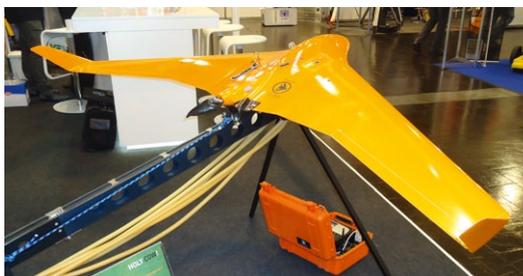
**Professionelle Startrampe und eine mit Sensoren gespickte Rumpfpattie verraten das spezielle Einsatzgebiet dieses Voll-GFK-Nurflügels**
