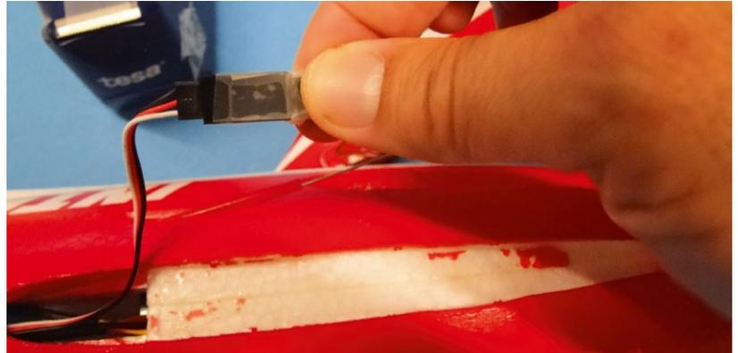
**Die Steckverbindung zum Seitenruderservo unbedingt auf Zugbelastung sichern. Klebeband ist okay, Schrumpfschlauch optimal**
