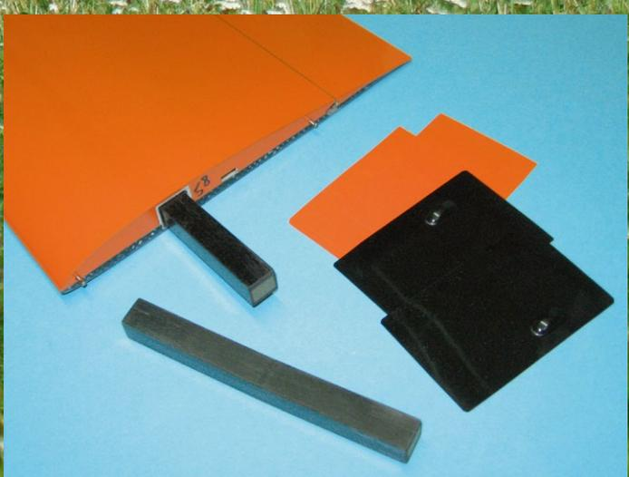
**Im Bereich der Wölbklappenanlenkung hat der Hersteller bereits die Durchbrüche für die Cross-Link-Anlenkungen eingebracht und auch die Aufnahme für die Augschraube zur Anlenkung wurde passgenau erstellt**
