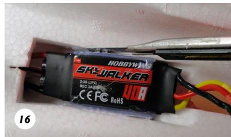
16 Der mit Heißkleber eingesetzte Regler wird vorsichtig aus dem alten Rumpf gelöst. Genauso wird das beim Höhenruderservo gemacht
