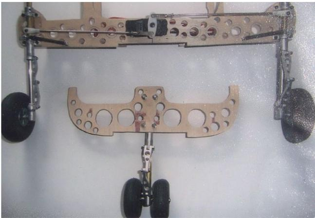
Zum Verdrehen der Räder sitzt ein zentral angeordnetes Servo im Spant des Hauptfahrwerks
