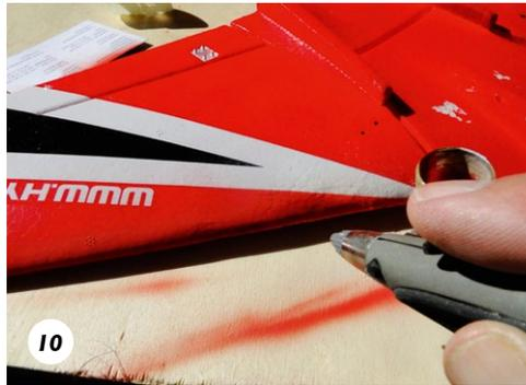
10 Nach dem Verschleifen der gespachtelten Stelle lackiert man diese mit der Airbrush. Das matte Rot von Tamiya passte hier ganz gut
