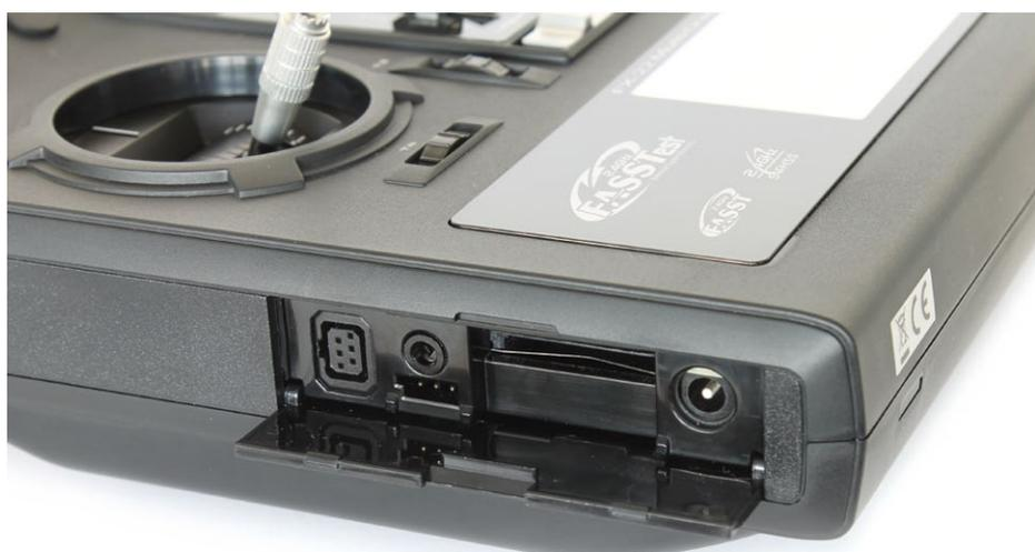
Im Fach befinden sich der SD-Kartenslot, die Trainer-Buchse, der Anschluss für den Lader, der S-BUS-Eingang und die Buchse für Ohrhörer
