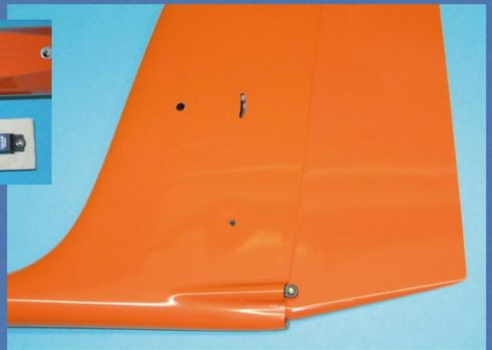
Seiten- und Höhenrudernanlenkung sind beim Cluster ab Werk flugfertig eingebaut
