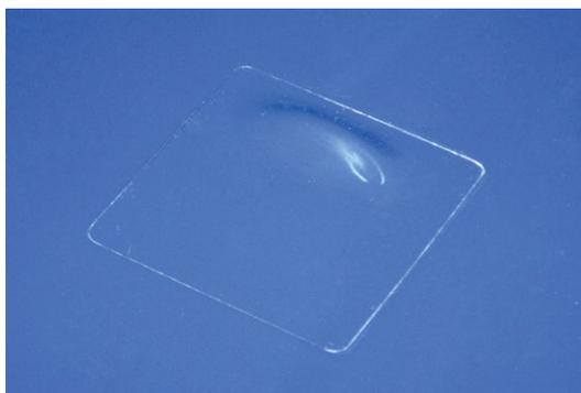
**An den Servoabdeckungen sind strömungsgünstige Hutzen angeformt, um die Überkreuzanlenkung realisieren zu können und gleichzeitig eine gute Aerodynamik zu bieten**
