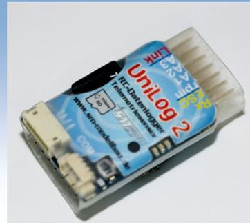
**Der UniLog2 ist das Standardgerät für die Datenerfassung im Modellflugsport. Seit der Softwareversion 1.05 verfügt er ebenfalls über eine F5J-Konfiguration**
