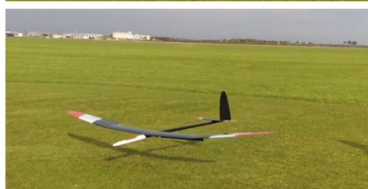
**Bei der Ziellandung sollte das Modell eher flach zum Gras einfliegen, sonst sind Antrieb und Rumpf gefährdet – das ist der Unterschied zu F3J**
