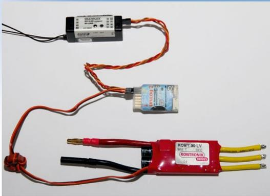
**Damit der Logger nach maximal 30 Sekunden den Motor zum Stillstand bringen kann, wird er zwischen Empfänger und Regler eingeschleift und greift in das Motorsignal ein**
