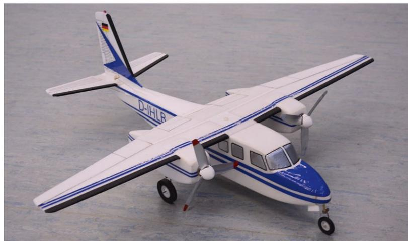
am Stahllineal sehr einfach schneiden lassen. Diese relativ filigrane „Lackierung“ trägt viel zum vorbildgetreuen Aussehen bei. Übrigens sind die Fenster aus silberfarbener Bügelfolie aufgebracht und mit einem schwarzen Edding kontraststark umrandet. Desweiteren bestehen die schwarzen Flächen an den Nasenleisten aus Klebeband.
