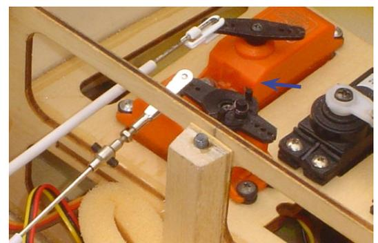
**Die perfekte Lösung für die Bugradanlenkung ist ein separates Servo mit gedämpftem Abtriebshebel. Die Dämpfung darf bloß nicht zu weich sein**
