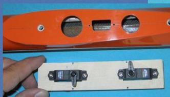
Das Servobrett wird an die zu verwendenden Servos angepasst und dann über die Kabinenhaube nach hinten in den Rumpf eingeschoben
