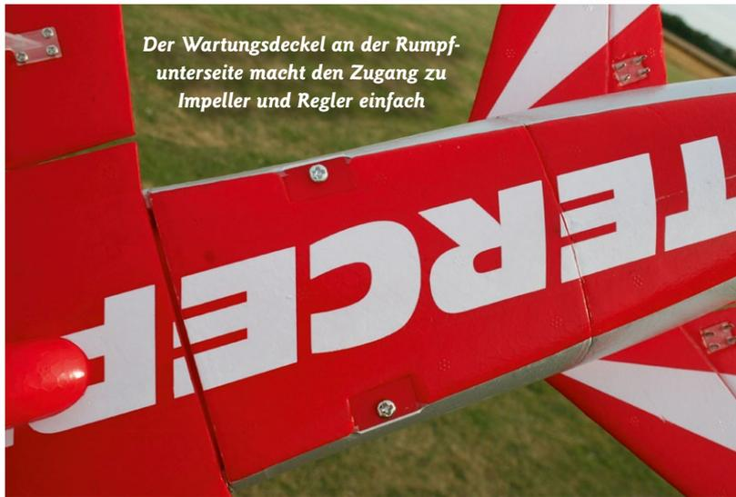
Der Wartungsdeckel an der Rumpfunterseite macht den Zugang zu Impeller und Regler einfach
