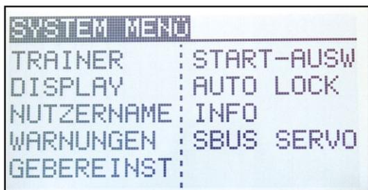
**Senderspezifische Einstellungen und die Programmierung von S-BUS-Servos erfolgen im System-Menü**
