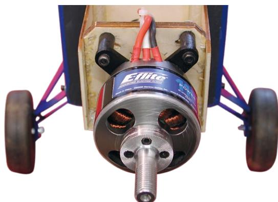
**Dieser souverän dimensionierte E-flite 110 Außenläufer erspart auch 50 Gramm Nasenballast**
