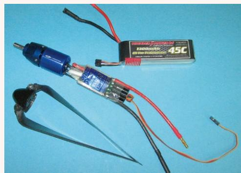
Der verwendete Antrieb besteht aus dem Leomotion-Motor, einem Phoenix ICE LITE 100 Regler von Castle Creations und einem 3s-LiPo von ThunderPower
