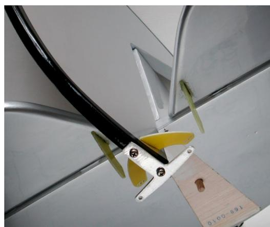
**Leitwerke, natürlich in der De Havilland-typischen Form, müssen zusammengebaut und mit den beiliegenden GFK-Ruderhörnern versehen werden**
