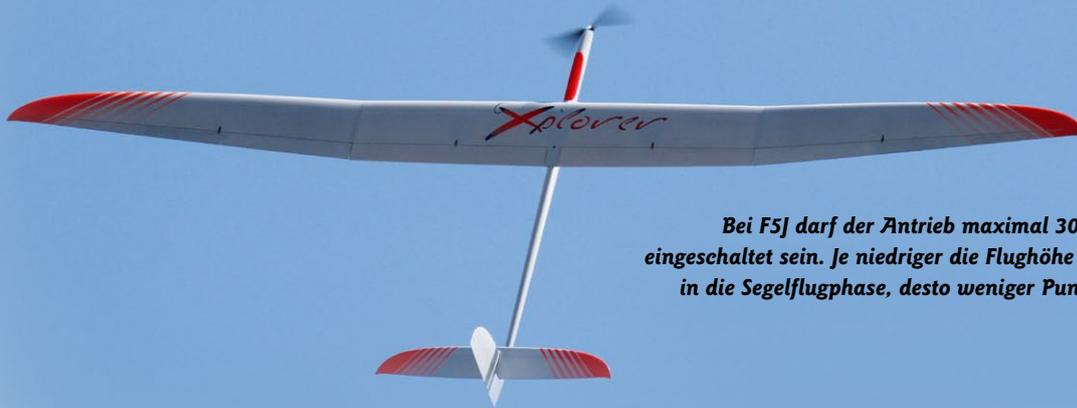
**Bei F5J darf der Antrieb maximal 30 Sekunden lang eingeschaltet sein. Je niedriger die Flughöhe beim Übergang in die Segelflughase, desto weniger Punktabzug gibt es**
