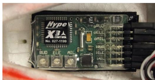
**Eingebauter Flächenkreisel X3-Control – er sorgt für ein sehr stabiles Flugverhalten. 50 Prozent Expo sind dennoch nötig**
