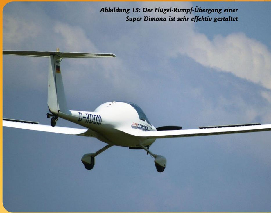
Abbildung 15: Der Flügel-Rumpf-Übergang einer Super Dimona ist sehr effektiv gestaltet
