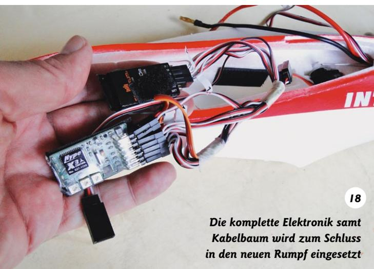
18 Die komplette Elektronik samt Kabelbaum wird zum Schluss in den neuen Rumpf eingesetzt
