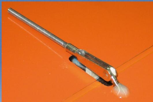
Die Anlenkung der Wölbklappen erfolgt über robuste M2,5-Anlenkungsgestänge
