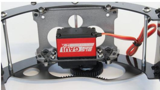
Das BLS GS503-Servo für die horizontale Steuerung ist im Auslieferungszustand bereits mit einem Zahnkranz versehen
