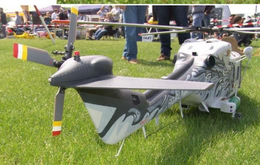
**Die sehr schön profilierte Heckpartie der Super Lynx lässt kaum vermuten, dass hier auch alles aus Holz gefertigt wurde. Die Höhenleitwerkshälfte auf der rechten Seite ist für den problemlosen Transport demontierbar konstruiert**
