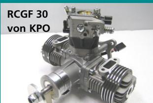
**KPO-Flugmodellbau** Der RCGF 30 ist ein Boxer-Benziner mit 30 Kubikzentimeter Hubraum, der 2,7 PS leistet. Mit diesem können Propeller bis 19 x 12 Zoll verwendet werden. Das zweiteilige Kurbelgehäuse ist wie die Zylinder aus Aluminiumguss. Die Kurbelwelle ist dreifach kugellagert und an der Pleuel kommen Kurbelwellen und kolbenseitig Nadellager zum Einsatz. Die Kolben besitzen zwei Kolbenringe. Das Systemgewicht mit allen Teilen liegt bei 1.066 Gramm. Der Preis: ab 339,- Euro.
