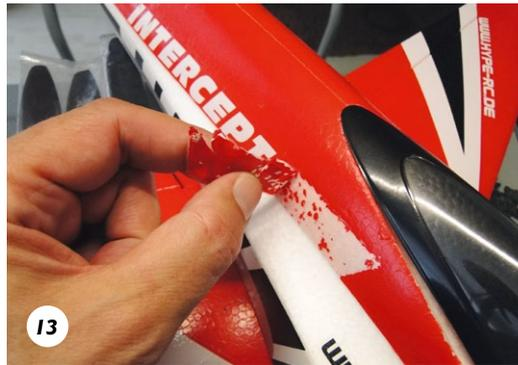
13 Damit war nicht zu rechnen: Die Wasserschiebilder mit den Schriftzügen am Rumpf lassen sich in einem Stück trocken abziehen. So spart man sich den Kauf des Ersatz-Dekorbogens
