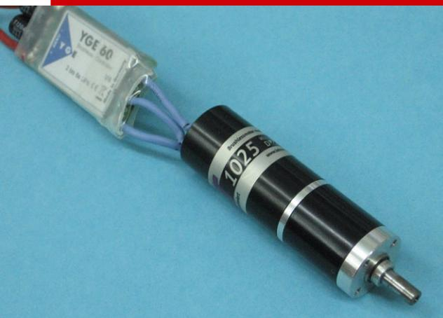
**Der kleine Kraftzwerg von Lehnermotor treibt über ein Getriebe von Florian Schambeck eine 16 x 8-Zoll-Luftschraube an**
