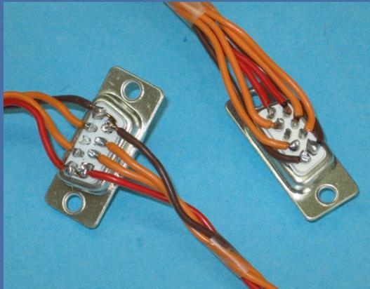
Beim Verlöten des Kabelbaums hat der Hersteller penibel darauf geachtet, dass im Tragflügelmittelstück nur wenig Bauhöhe zur Verfügung steht und deshalb die Kabel seitlich weggeführt. Die Lötstellen wurden mit Heißkleber isoliert und gesichert
