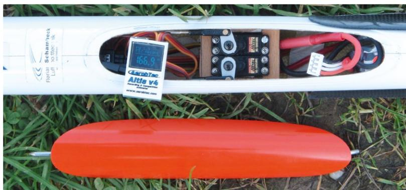
**Der Altis V4, im Vertrieb von Aer-O-Tec, zeigt Daten über das integrierte OLED-Display an**
