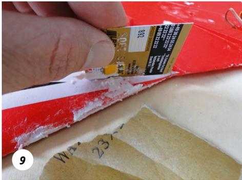
9 Mit Leichtspachtel (robbe Rostuff) können die fehlenden Teile rekonstruiert werden. Als Werkzeug für die „plastische Chirurgie“ eignet sich eine alte Scheckkarte hervorragend
