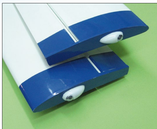
Hier die beiden Positionslichter am Randbogen der Tragflächen, darunter befinden sich eine rot und eine grün leuchtende LED
