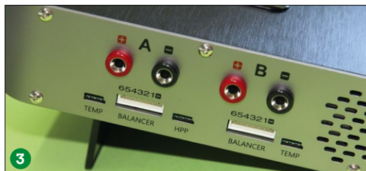
Unterschiedliche Ladekabel und zwei Balancer-Adapter gehören zum Lieferumfang. (1) Große Kühlschlitze und zwei lastabhängig geregelten Lüfter sorgen für den Abwärmehtransport. (2) Auf der linken Gehäusesseite befindet sich auch der HPP-Anschluss für Software-Updates (3)
