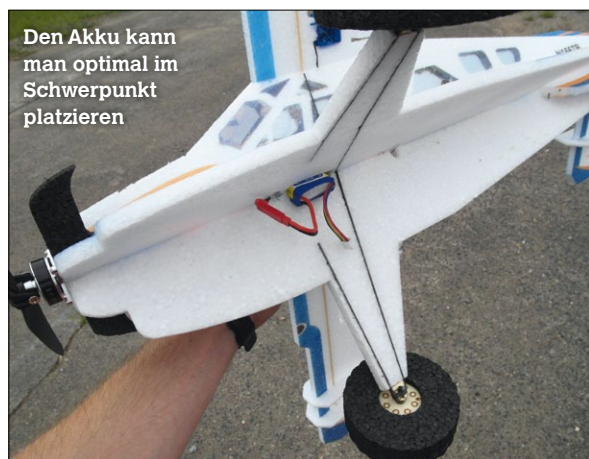
Führungen verhindern ein Durchbiegen der Schubstangen
