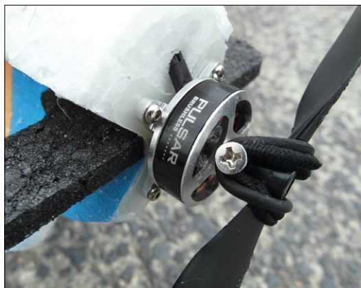
Empfohlen wird ein Pulsar-Motor, der mit 2s- und 3s-LiPos klarkommt
