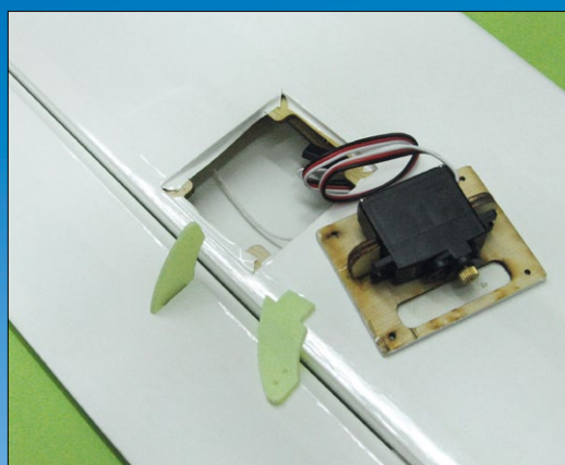
Alle Ruder werden mit kräftigen GFK-Ruderhörnern angesteuert. Die Querruderservos sind direkt innen am Servodeckel angeschraubt
