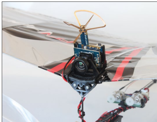
Die Kamera, eine zirkular polarisierte Antenne und die Sende-Elektronik für das Videobild-Signal bilden eine Einheit
