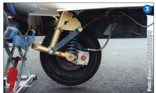
Wappen der Indonesischen „Akademi Angkatan Udara“ am Hinterrumpf der DG-1000. (1) Bei diesem Muster sind die kurzen Außenflügel angebracht, was eine Spannweite von 18 Meter ergibt. (2) Das große Haupttrad an der DG-1000 (Prototyp) mit der hydraulischen Bremse (3)
