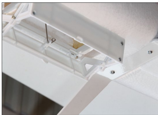
Eine Besonderheit der U can fly II ist der Abwurfschacht, der das Modell auch für später interessant macht
