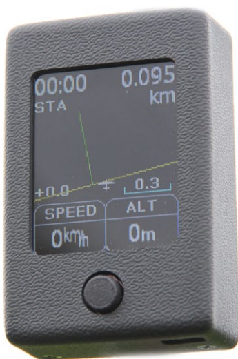
Das Empfangsgerät des T3000-Systems von RC Electronic ist relativ klein. Das scharfe Display ist auch bei Sonnenlicht gut ablesbar und zeigt alle relevanten Daten an
