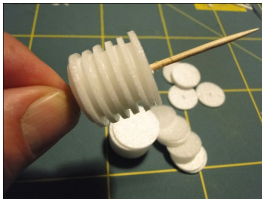
Mit einem Kreisschneider werden die Scheiben für die Zylinderattrappen ausgeschnitten (links). Zwei verschieden große Kreisscheiben ergeben die Zylinderoptik (rechts)
