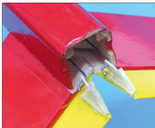
Die Anlenkungen des V-Leitwerks sind gut geschützt hinter dem Rumpf
