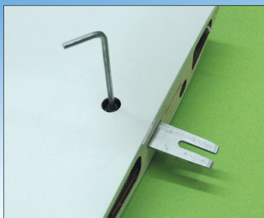
Die Flächenbefestigung am Rumpf erfolgt über ein geschlitztes Aluteil, das mit den Tragflächen fix verschraubt und im Rumpf per Schraube geklemmt ist
