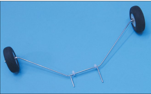
Fertig gebogener Fahrwerksdraht aus 2-Millimeter-Federstahl und Räder mit 55 Millimeter Durchmesser
