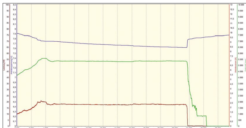
Beispiel-Diagramm: Graupner HPD 2707 (AT 2206) im Messzyklus Leistungsbedarf Hover. Zunächst langsamer ramp up auf konstant 170 Gramm Standschub. Die Spannung des LiPo (blau) beträgt im Mittel 7,68 Volt – fast 1 Volt mehr als bei der Vollgasmessung. Die Leistungskurve (braun) mit 18,4 Watt und Stromkurve (rot) 2,4 Ampere liegen fast deckungsgleich übereinander. Die Drehzahl (grün) beträgt 5.350 Umdrehungen in der Minute
