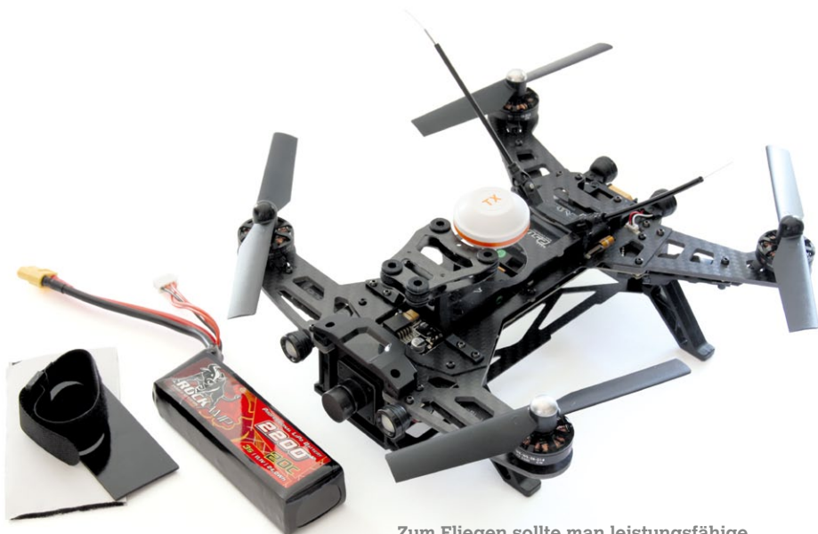
Zum Fliegen sollte man leistungsfähige 3s-LiPos wie den Rockamp einsetzen, die lange Zeit eine hohe Spannung unter Last garantieren
