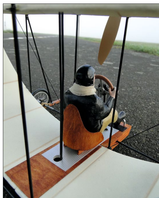
Der Strom wird über isolierte Messingstangen – statt Kabel – geführt, die wie Steuergestänge aussehen
