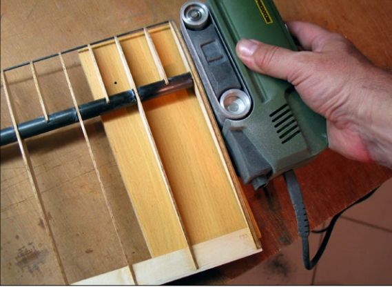
Nach Fertigstellung der Mittelfläche sind Kohlefaserrohr und Wurzelrippe bündig zu schleifen
