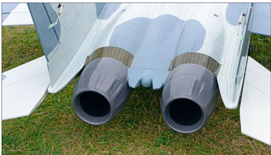
Der Düsenabschluss kann verklebt werden, lässt aber auch eine Verschraubung zu
