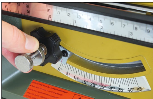
Für Gehrungsschnitte lässt sich das Sägeblatt stufenlos bis 45 Grad neigen
