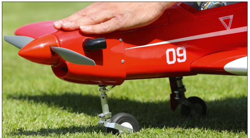
Das sehenswerte Einziehfahrwerk aus gefrästen Aluminiumteilen besitzt gedämpfte Schwingen mit einem Federweg von 20 Millimeter
