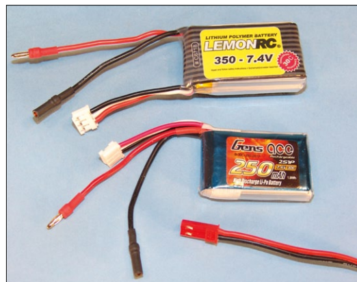
2-Millimeter-Lamellenkontakte sind besser geeignet als das oft zu sehende BEC-Steckersystem. Der kleine 250er-LiPo von GensAce wurde in Eigenregie mit einem Balancer-Anschluss versehen
