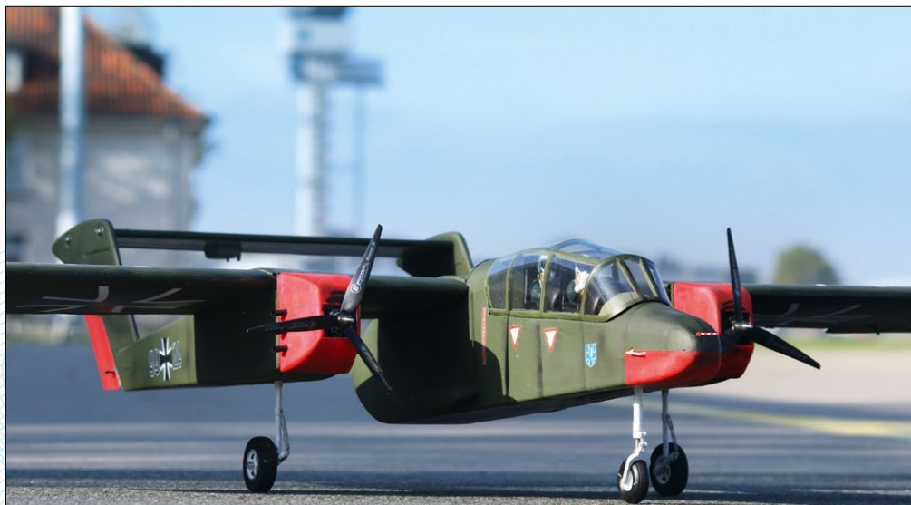
Abbildung 3: Eine parallel liegende Anordnung der Motor gondeln ist die heute übliche Lösung, wie bei dieser Bronco OV-10
