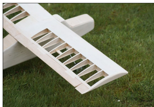
Wie man eine Rechtecktragfläche mit Querruder baut, wird im Workshop in Modell AVIATOR 12/2015 ausführlich beschrieben
