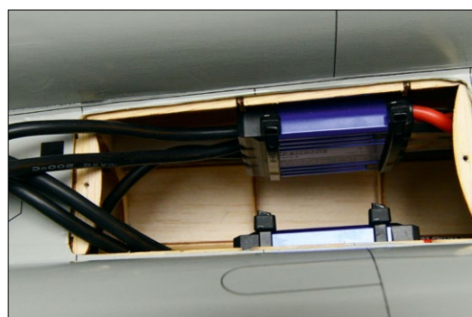
Die Regler lassen sich entweder in den Schacht zwischen den beiden Lufterläufen montieren oder auch direkt im Innenbereich des Rumpfs. Auch hier ist genügend Platz
