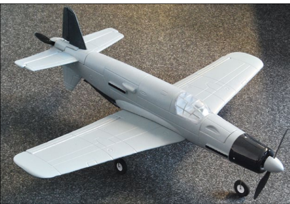
Abbildung 2: Eine Do 335 ist ein typisches Beispiel für ein Muster mit Tandemantrieb
