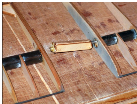
Die Steckung zwischen innerer und mittlerer Tragfläche besteht aus Holz, Messing sowie Stahldrahtteilen und werden nach Fertigstellung montiert
