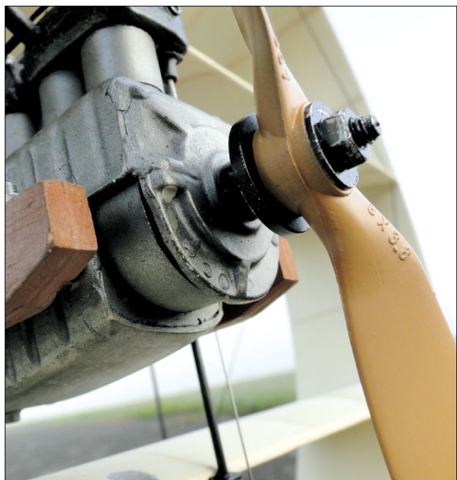
Die Glocke des Außenläufers schaut unten aus der Motoratrappe heraus
