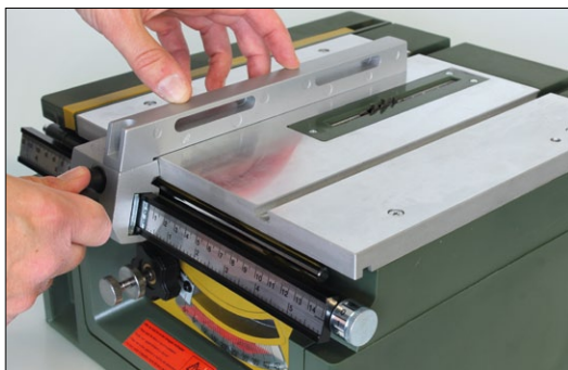
Anhand der längs angebrachten Skala kann der Anschlag auf den Zehntelmillimeter exakt eingestellt werden
