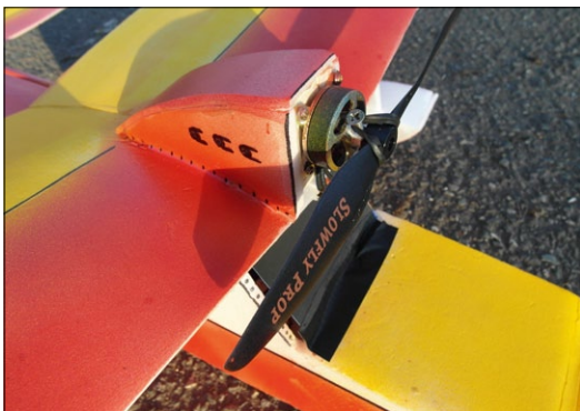
Ein 20-Gramm-Außenläufer sorgt für genug Leistung in jeder Lage
