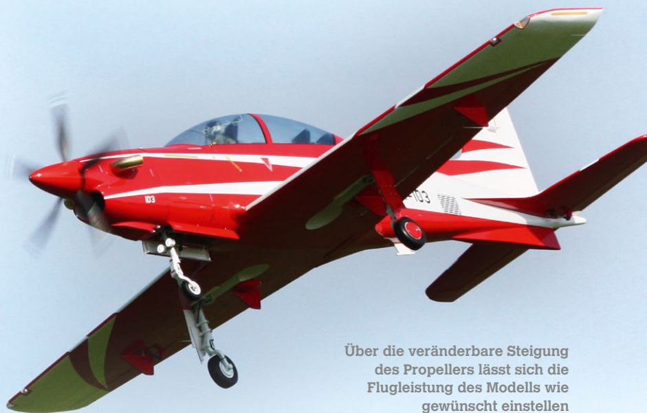
Der Motor Q 80 6L V2 von Hacker passt perfekt unter die Haube – die PC-21 ist für diesen Antrieb vorbereitet
