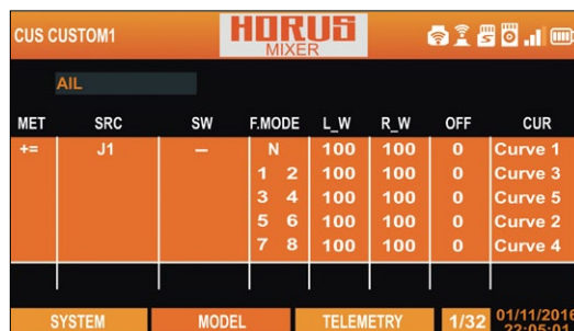
Es stehen bis zu 32 frei konfigurierbare Mischer zu Verfügung
