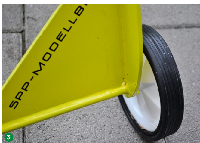
Als Vorderachse dient ein durchgehendes Stahlrohr (3). Mit der Tragfläche nimmt das Modell den Startwagen bis zum Aufstieg mit (4)
