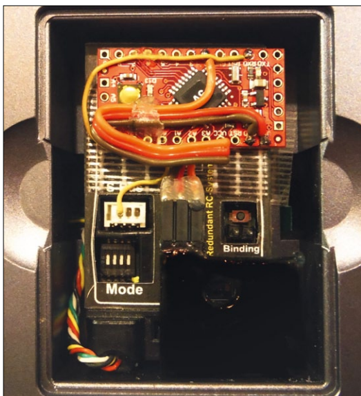
Im rückseitigen Schacht wurde ein ACT-Telemetrie-HF-Teil mit Telemetrie-Adapter von MLink auf FrSky S.Port (rote Platine) eingebaut
