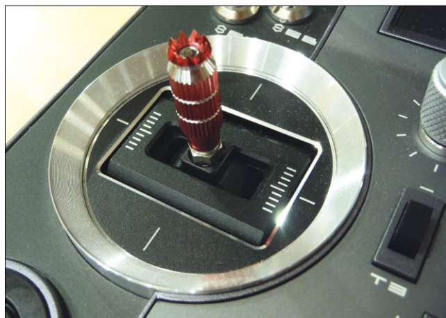
Die Steueraggregate sind äußerst präzise aus Aluminium gefertigt und kugellagert
