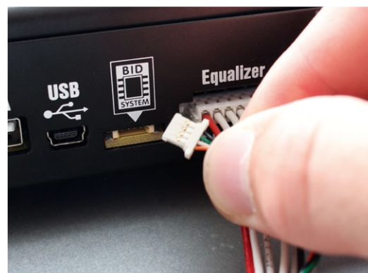
Über ein Verbindungskabel werden der LiPo-BID-Chip mit dem BID-Anschluss des Laders verbunden
