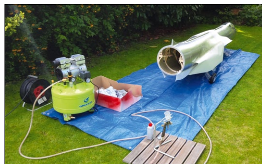
Der schnelltrocknende Lack kann durchaus auch im Garten aufgespritzt werden. Die Metalloberfläche wird durch abschnittsweise Lackierung mit Speziallack initiiert
