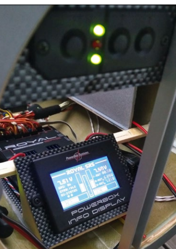
Schalter und Display sind bei abgenommener Rumpfnase gut zugänglich
