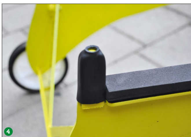
Als Vorderachse dient ein durchgehendes Stahlrohr (3). Mit der Tragfläche nimmt das Modell den Startwagen bis zum Aufstieg mit (4)
