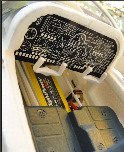
Die Sitze verdecken die Kabel und bringen etwas Leben ins Cockpit. Schwerpunkt-optimal ist die Akkuposition
