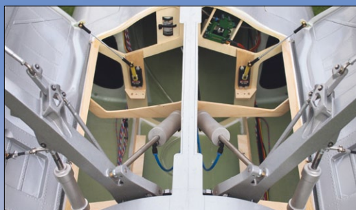
Der Fahrwerkschacht von unten. Am vorderen Spant sind die Kerosinpumpe und das Ventil erkennbar
