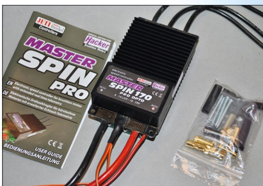
Der Master Spin Pro 170-Regler von Hacker lässt sich sehr gut einstellen und passt optimal zum Q 80-Motor
