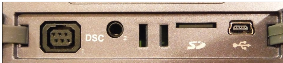
Auf der Rückseite finden sich verschiedene Schnittstellen, wie beide Lehrer-Schüler-Buchsen, SD-Karten-Slot und USB-Anschluss
