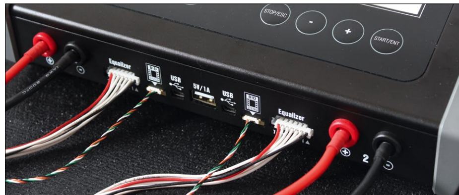
Beim Power Peak D7 gibt es zwei Ladekanäle mit jeweils einem BID-Anschluss
