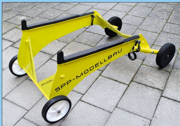
Der fertige Startwagen mit Moosgummiauflage und hinteren Schwingen
