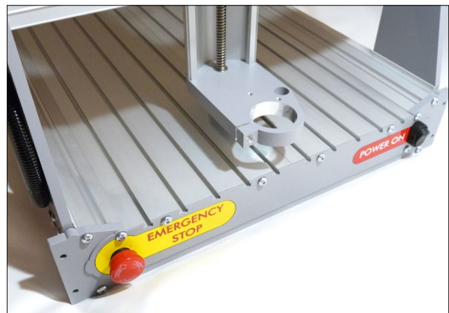
Die 43-Millimeter-Aufnahme an einer sehr dicken Halteplatte. Jegliche Verkabelung ist auf die Rückseite verbannt und somit vor Spänen sowie Dreck sicher
