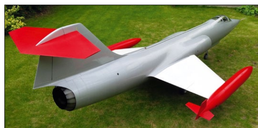
Erste Lackierarbeiten mit Rot und Weiß an Flächen, Tip-Tanks und Höhenleitwerk sind bereits erledigt
