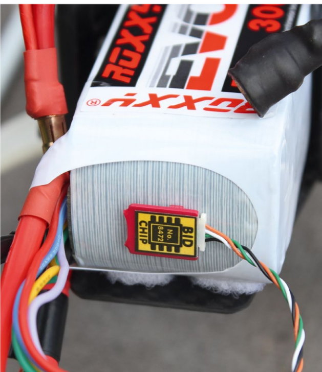
Bei roxy-Akkus ist ab Werk ein BID-Chip installiert, der eine Kapazität von mindestens 1.800 Milliamperestunden Kapazität hat
