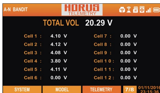
Es werden bis zu 12 einzelne Zellenspannungen eines Flugakkus angezeigt – die schwächste Zelle (hier Zelle 4) kann so identifiziert werden
