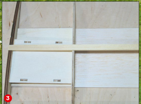
Die Sperrholzspanten sind zur Verstärkung teilweise aufgedoppelt (1). Der Rumpf besteht aus mehreren Segmenten, die miteinander verzapft werden (2). Zwei Sperrholzteile bilden eine Tasche für die Flächensteckung (3)
