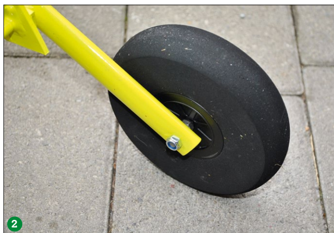
An den drehbar gelagerten Schwingen wird der Wagen hinten mittels O-Ringen auf Höhe gehalten und gedämpft (1). Die hinteren Räder sind verschraubt (2)
