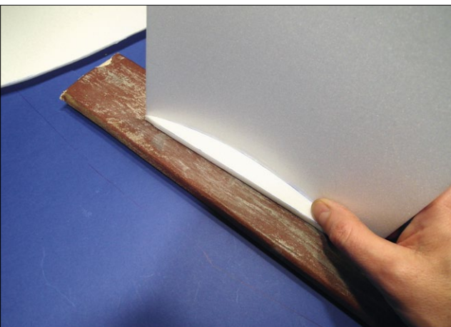
Nach dem Verkleben der Wurzelrippen im vorgesehenen Winkel müssen die Flügelwurzeln plan geschliffen werden
