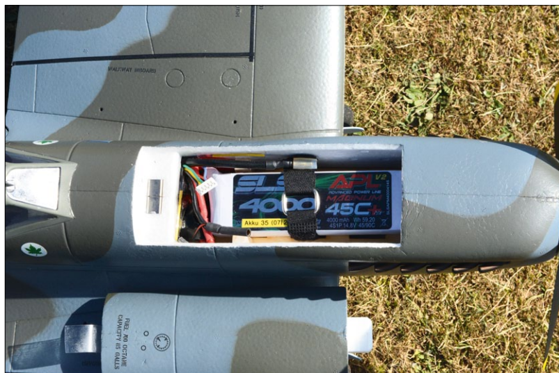
Die Akkuposition passt mit dem 4.000er-Akku perfekt
