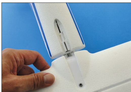
Das Höhenleitwerk wird auf das Rumpfbende aufgeschoben und mit einer Schraube gesichert
