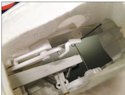
Kleines Problem: Der Kunststoff-Halteclip der Anlenkung war gebrochen, wir haben ihn ausgetauscht
