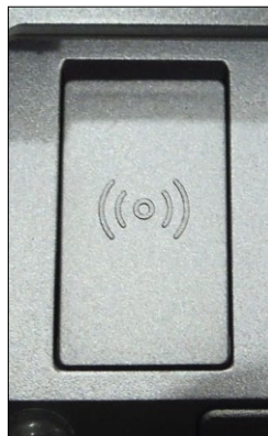
Unter einer Abdeckung findet sich eine Buchse für eine externe Antenne
