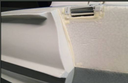
Der Rumpfboden wird durch eine Wanne aus Hartplastik zusätzlich geschützt. Am Kleber hat der Hersteller offensichtlich nicht gespart, aber so ist wenigstens alles wasserdicht
