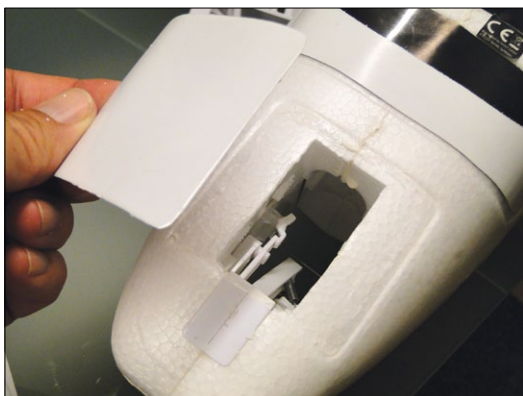
Durch die Wartungsöffnung am Bug kann man bei Bedarf das Bugfahrwerk inspizieren
