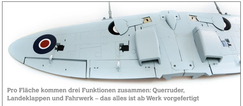
Die Tragfläche von oben mit Anschlüssen der Servos
