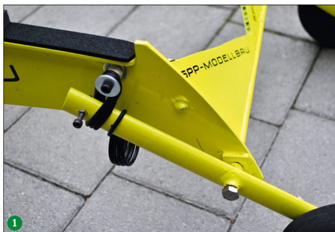
An den drehbar gelagerten Schwingen wird der Wagen hinten mittels O-Ringen auf Höhe gehalten und gedämpft (1). Die hinteren Räder sind verschraubt (2)
