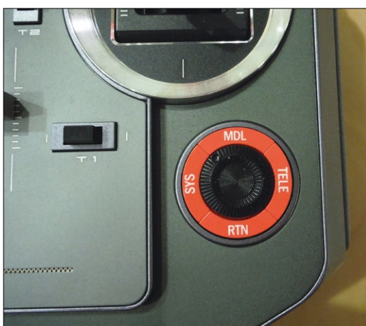
Auf der rechten Frontseite befindet sich eine Vierwege-Taster-Scrollrad-Kombination zur Menü-Bedienung
