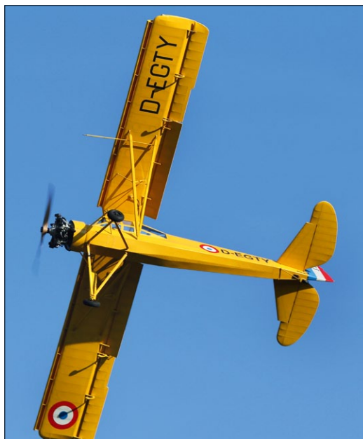
Besonderes Merkmal der MS-505 sind die hier gut zu erkennenden, feststehenden Vorflügel
