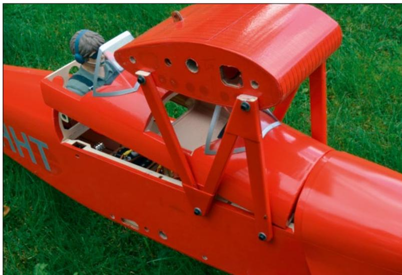
Das große abnehmbare Doppelcockpit sorgt für einen sehr guten Rumpfungang
