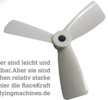
Die mitgelieferten Propeller sind leicht und verhältnismäßig belastbar. Aber sie sind zu weich und verursachen relativ starke Vibrationen. Abhilfe schaffen hier die RaceKraft 3045 BN Tri-Propeller von flyingmachines.de
