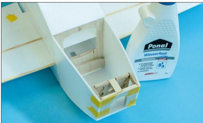
Der eingesetzte Flügel beweist, dass alles sauber und winklig gebaut wurde – prima. Vorn kommt noch ein Motorhalter aus Balsa und dünnem Sperrholz in die Rumpfschnauze, welcher Sturz und Zug fertig definiert
