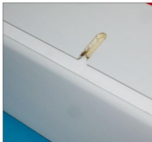
Durch die unten angeschlagenen Klappen lassen sich sehr große Wölbklappenausschläge für die Butterfly-Stellung realisieren.
