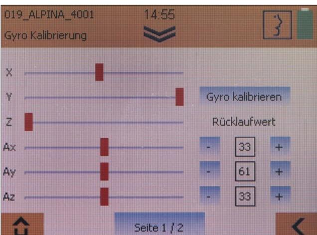
Zuerst hält man den Sender in seiner gewohnten Position, dann wird der Gyro kalibriert und diese Lage wird im Modellspeicher abgelegt. Die Balken zeigen in Echtzeit die vom Lagesensor erfassten Lage- und Beschleunigungswerte, über den Rücklaufwert lässt sich einstellen, wie schnell der Balken sich wieder in die Ausgangsstellung bewegt
