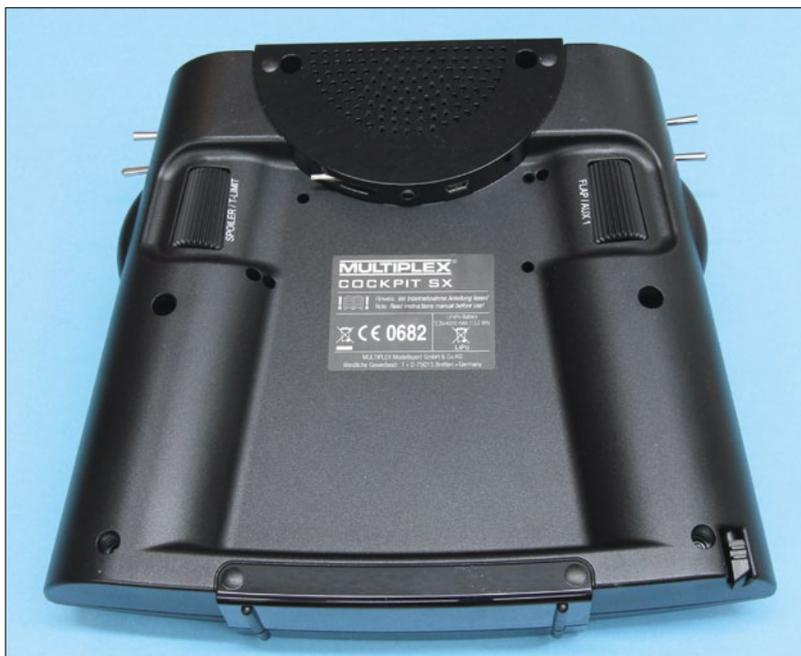
Mit Hilfe der beiden Drehwalzen auf der Rückseite des Senders lassen sich beispielsweise die Landeklappen, das Einziehfahrwerk, die Beleuchtung oder andere Funktionen steuern
