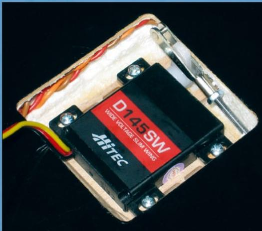
Das Einkleben der Servos erfolgt am besten nachdem das Ruderhorn eingeklebt und das Anlenkungsgestänge probenhalber montiert wurde. So fluchten später Servohebel und Anlenkungsgestänge perfekt
