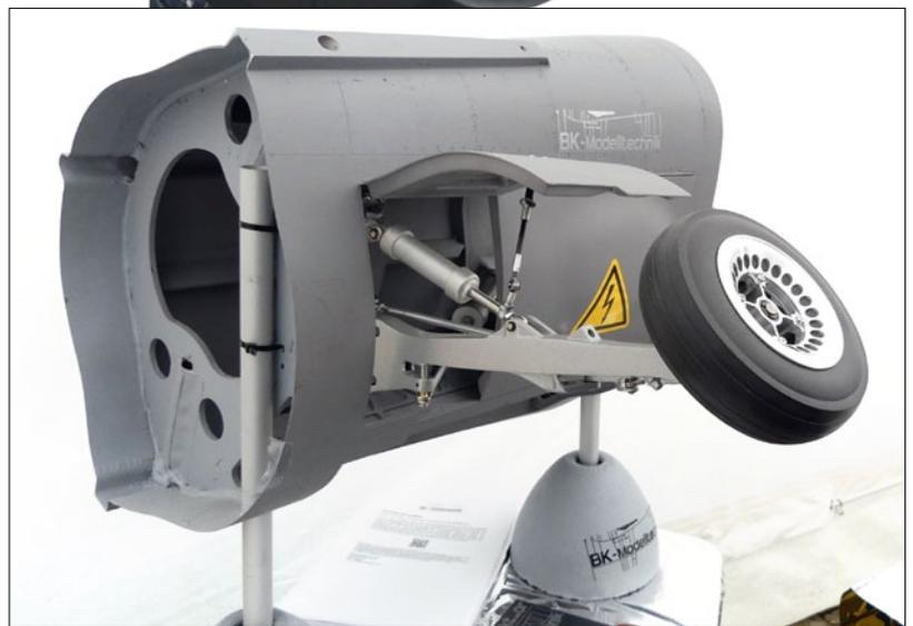
Gleiches gilt für das Fahrwerk des Starfighters. Anhand eines Schnittmodells am Stand demonstrierte er eindrucksvoll die sequenzielle Steuerung der Schachtklappen und das Aus- beziehungsweise Einfahren des Hauptfahrwerks. Selbstverständlich alles elektrisch
