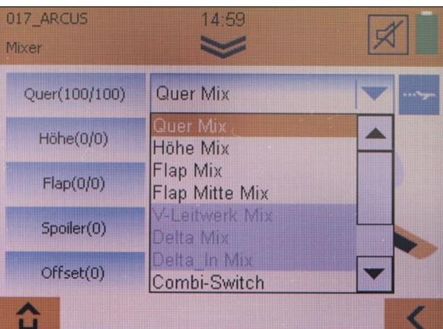
Mit Quer Mix werden die äußeren Ruder bezeichnet, die mittleren heißen Flap Mitte Mix und die inneren Flap Mix. Zu jedem Klappenpaar gibt es jeweils die Mischanteile Quer, Höhe, Flap, Spoiler und Offset
