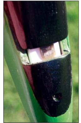
Die von uns nachgerüstete GFK-Zunge greift unter die vordere Rumpferkleidung und hält somit den Deckel
