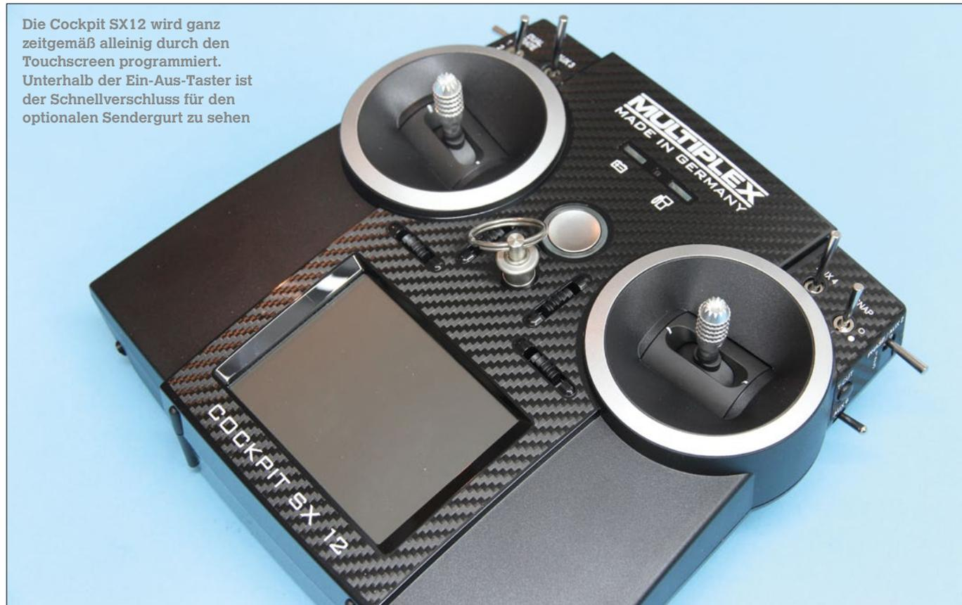
Die Cockpit SX12 wird ganz zeitgemäß alleinig durch den Touchscreen programmiert. Unterhalb der Ein-Aus-Taster ist der Schnellverschluss für den optionalen Sendergurt zu sehen
