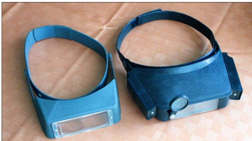
Abbildung 7: Der Klettverschluss rechts ist sehr praktisch. Eine Kopfband-Lupe muss vor allem leicht sein
