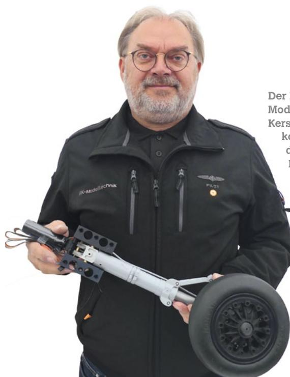
Der Inhaber von BK-Modelltechnik, Matthias Kerstan, präsentiert hier ein komplettes Fahrwerksbein der Me-262, für das er die Elektronik-Komponenten für die Steuerung des Ein-/Ausfahrvorgangs und der Bremsenbetätigung liefert
