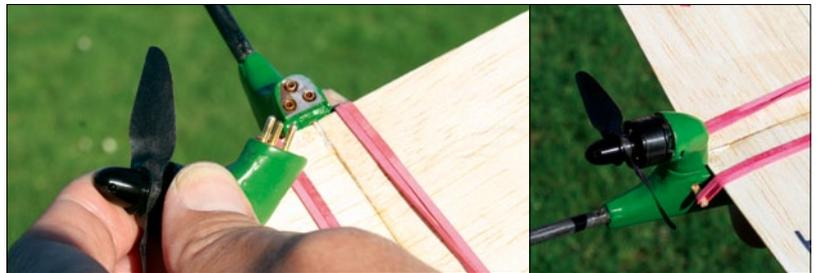
Geniale Idee: Die 2-Millimeter-Goldstecker stellen gleichzeitig die elektrische und mechanische Kopplung des Motoraufsatzes dar. Mit einem Griff lässt er sich aufstecken oder entfernen
