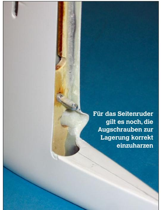
Für das Seitenruder gilt es noch, die Augschrauben zur Lagerung korrekt einzuharzen
