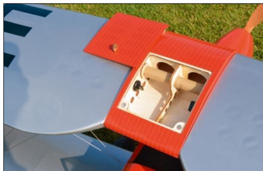
Unter dem kleinen Deckel befinden sich die Befestigungsschrauben der oberen Tragflächenhälften. Die Wellblechimitation besteht aus aufgemalten Linien
