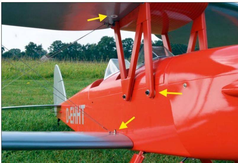
An den Tragflächenwurzeln enden die Verspannungsseile in kleinen Adaptern. Damit das Doppelcockpit beim Einschieben nicht klemmt, erhalten die Baldachinstreben unten dünne Unterlegscheiben. Weiße Lochverstärkungsringe markieren die Lage des Schwerpunkts
