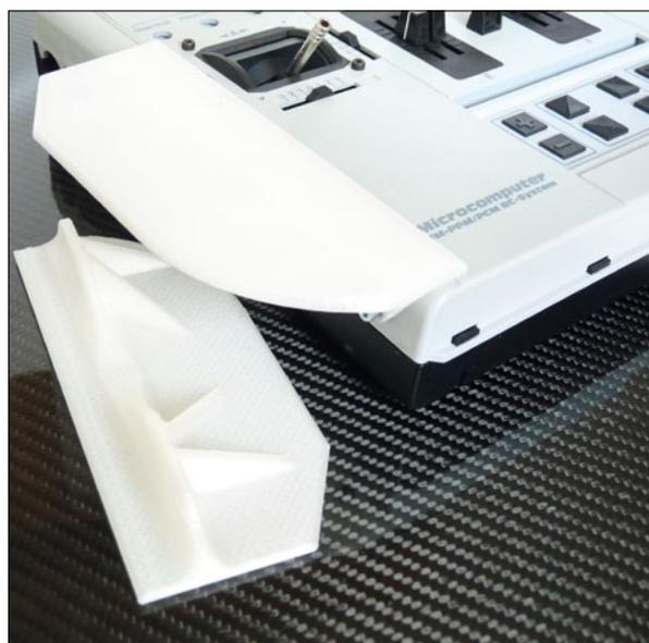
Diese seitlichen Handauflagen für einen RC-Sender wurden kurzerhand per CAD entworfen, am Dreamer ausgedruckt und passten auf Anhieb ohne weitere Nacharbeiten
