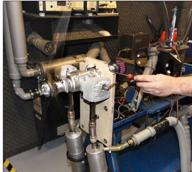
Der 170er konnte auf dem Motoren-Teststand bei allen Drehzahlen überzeugen. Bei einer Maximalleistung, die locker die des 200er King toppt, bietet sich der (bis auf den Walbro-Vergaser) zu 100 Prozent aus deutscher Produktion stammende Zweizylinder geradezu als Standardtriebwerk für den Großseglerschlepp an
