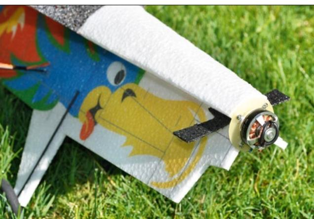
Den Propeller befestigt man mit klassischen O-Ringen. Der empfohlene Motor ist für 2s- und 3s-Betrieb geeignet
