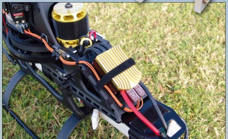
Die Kabel des vor dem Motor befestigten Scorpion Drehzahl Controllers Tribunus 200A laufen zum direkt darunter liegenden 12s-LiPo
