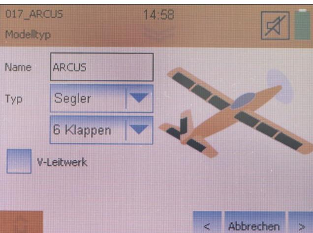
Die Cockpit SX12 mit der Software V1.3 verfügt über einen vollwertigen Sechsklappenmischer
