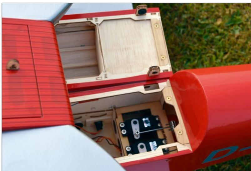
Zwei Rundmagnete in nachträglich angefertigten Sperrholzträgern ersetzen die hintere Verschraubung des Doppelcockpits
