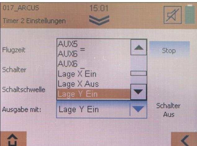
Die Flugzeit-Timer-Ansage lässt sich über den Lagesensor auslösen, indem der Sender in die Y-Richtung gekippt wird
