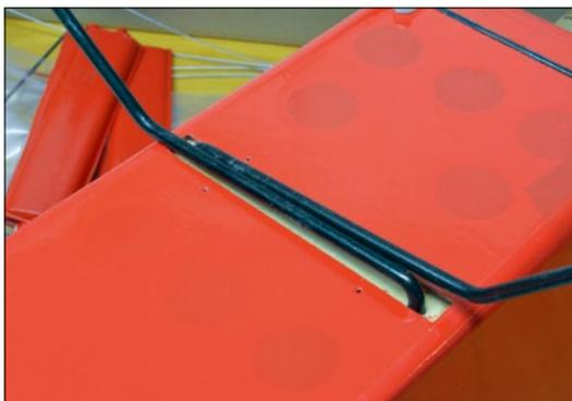
Will man die Fahrwerksstähle nicht neu biegen, muss die Auflage etwas nachgearbeitet werden
