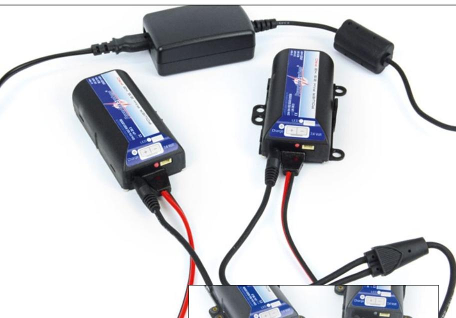
Mit dem 230-Volt-Netzteil werden beide Akkus parallel geladen, wie die roten LED zeigen. Ebenso ist das mit dem 12-Volt-Adapter möglich
