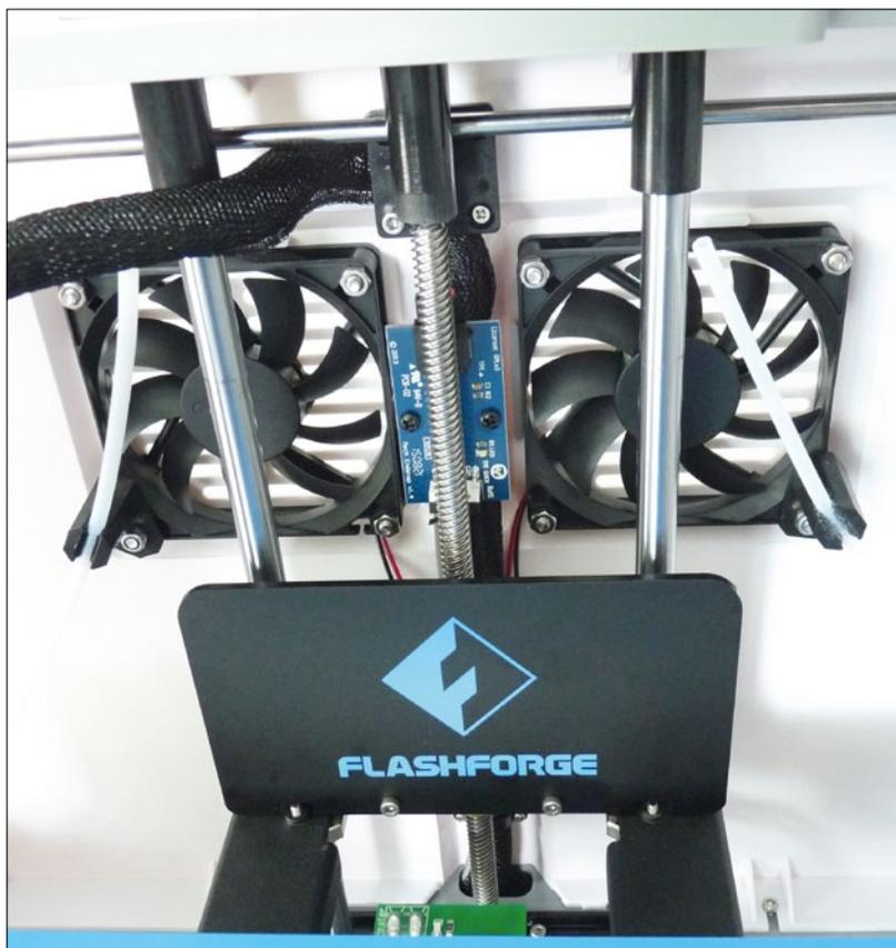
Die Z-Achse verfügt wie die anderen Achsen auch über eine doppelte Linearführung. Lediglich der Antrieb erfolgt hier über eine Trapezgewindespindel mit starker Steigung – dies ermöglicht ein Verstellen des Tisches von Hand
