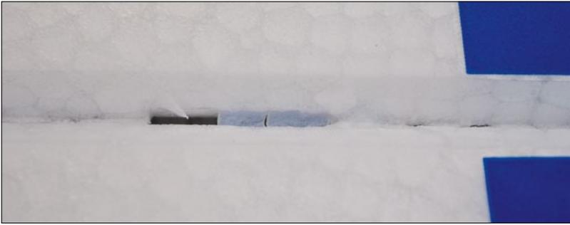
Die Ruder sind mit Scharnieren angeschlagen, was Leichtgängigkeit und Präzision garantiert
