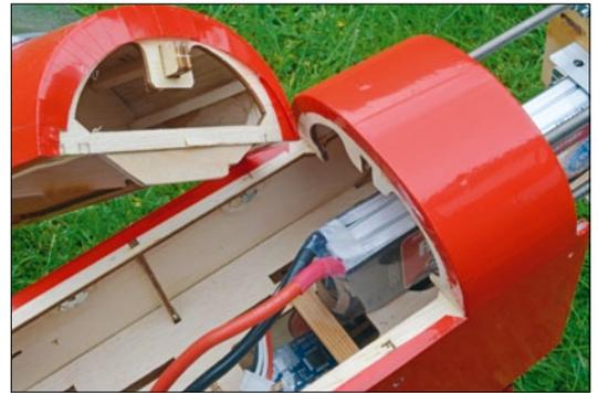
Die Montage des Motors am Kopfspant ist rasch erledigt und die schön geformte Motorhaube wird aufgeschoben. Hierbei ist die hintere Begrenzung durch die Rumpfform und die konische Bauweise der Cowling festgelegt. In dieser Stellung liegt jedoch der Luftschraubenmitnehmer des Motors, der gemäß Plan mit einem Abstand von 130 mm zum Kopfspant montiert ist, 6 mm zu weit hinten. Da wir die
