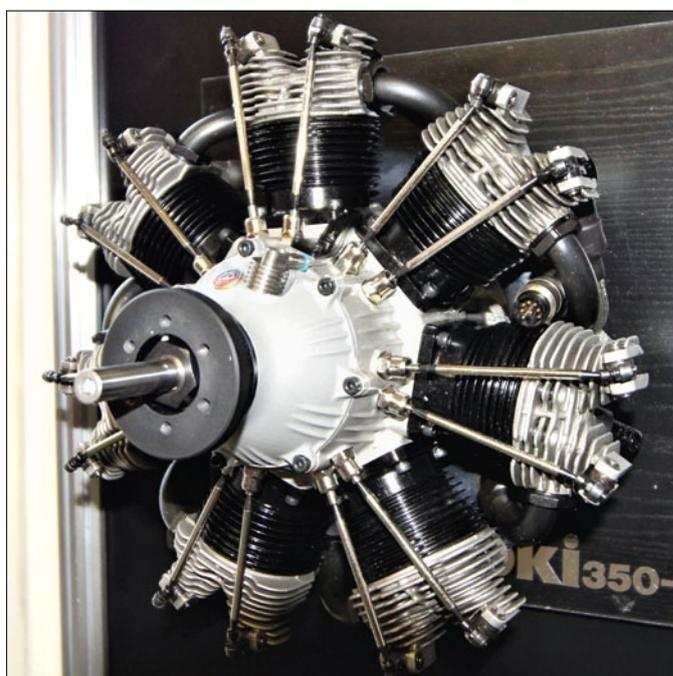
Eine weitere Neuheit für 2018: Siebenzylinder-Sternmotor Moki S 7/350. Technische Daten: Hubraum 350 cm<sup>3</sup>, Leistung etwa 19,5 PS, Gewicht 7.200 g, Ø 310 mm, Länge 235 mm. Empfohlene Propeller: Zweiblatt 34 × 18 Zoll SEP oder Dreiblatt 32 × 20 Zoll SEP. Der Preis inklusive Ringschalldämpfer: 3.998,- Euro
