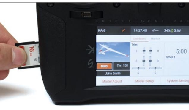
Gut zugänglich ist der SD-Karten-Slot. Bedient wird die iX12 über ein farbiges Touchdisplay
