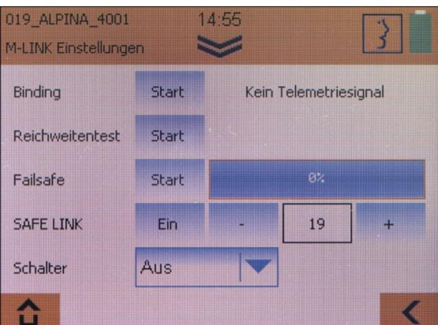
In den M-Link-Einstellungen ist die Funktion SAFE-LINK untergebracht. Mit ihr werden nicht nur Sender und Empfänger gebunden, sondern letzterer wird zusätzlich auf einen bestimmten Modellspeicher verriegelt. Das Starten des Modells mit dem falschen Modellspeicher gehört damit der Vergangenheit an
