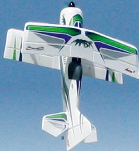
beim nächsten Flug mit Unterstützung des Kreisels in Stufe eins in die Luft geht. Allerdings sind die Ruderausschläge jetzt so gering und das Modell benimmt sich so zahm, dass es nicht wirklich Spaß macht. Etwas mehr Dampf ist in Stufe zwei drin, doch erst auf Stufe drei geht der Spaß richtig los – was zu erwarten war. Hier zeigen Modell und Pilot, was sie können.
