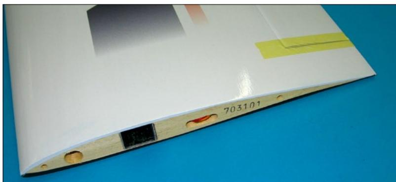
Die Wurzelrippe im Auslieferungszustand. Die Ruder sind betriebsfertig angeschlagen, die Flächensteckung ist fertig, das Servokabel im Flügel eingezogen
