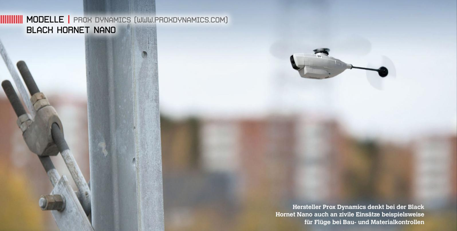
Hersteller Prox Dynamics denkt bei der Black Hornet Nano auch an zivile Einsätze beispielsweise für Flüge bei Bau- und Materialkontrollen
