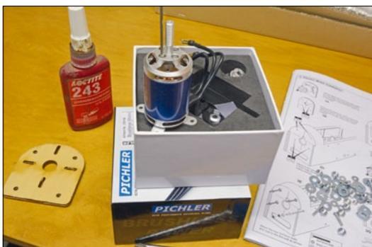
Auch bei Elektromotoren sollten die Verschraubungen mit Loctite gesichert werden
