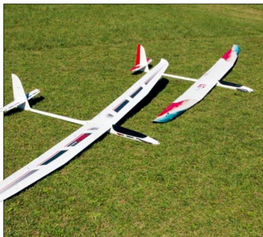
Der neue Kult Elektro (vorne) im direkten Vergleich zum Kult Champ. Deutlich sichtbar sind die vergrößerte V-Form und die größere Kabinenhaube
