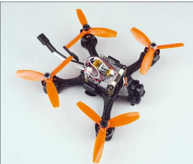
Die Drohne mit dem DSMX-Empfänger des RTF-Sets. Wer sich für das Rundumsorglospaket entscheidet, muss keine Einstellungen mehr vornehmen
