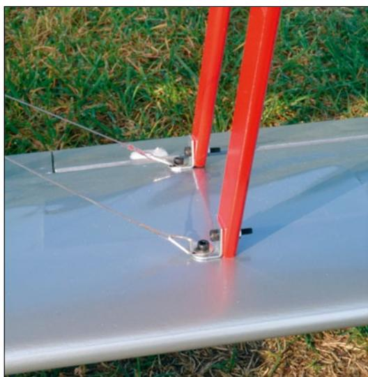
Einfach und robust sind die Halterungen für die Stiele und die Verspannung
