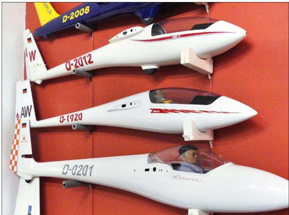
Auch bei den Voll-GFK-Seglern gibt es attraktiven Zuwachs. Ab sofort lieferbar sind die Typen ASW-19 beziehungsweise ASW-20 (mittlerer Segler im Bild), jeweils in zwei Größen. Im Maßstab 1:3 mit 5.000 mm Spannweite und in 1:2,2 mit 6.800 mm. Während die Flügel der ASW-19 nur mit Querrudern ausgerüstet sind, verfügt die ASW-20 zusätzlich über Wölbklappen
