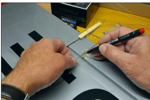
Die Querrudersteuerstangen werden abgelängt. Die Wäscheklammer hält das Ruder in Neutralposition
