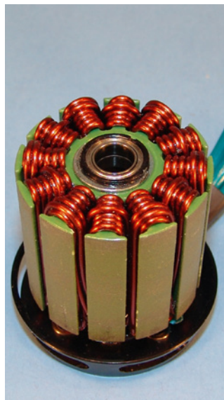
Eine Motorwicklung in Vollendung: Drahtdurchmesser 1,32 Millimeter und 22 Milli-Ohm Innenwiderstand in Dreieckschaltung für einen „langsamen“ 400-kv-Motor. Deutlich erkennbar ist die grüne Pulverbeschichtung zur stirnseitigen Isolation des Blechpakets
