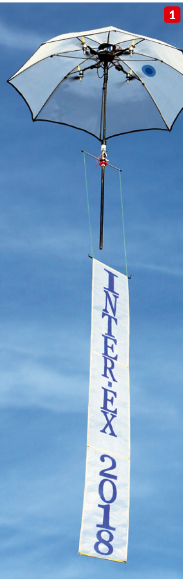
1) Den Bau des Sonnenschirms übernahm Patrick Blanc. Er leistet zu jeder Inter-Ex ausgefallene Kreationen als Beitrag. 2) Der Schirm klappt ferngesteuert auf, um dann aus seinem originalgetreuen Standfuß heraus in den Himmel zu steigen. 3) Zur Stabilisierung des Schirms wurden Komponenten der Firma DJI verwendet. 4) Die Konstruktion besteht zum größten Teil aus Aluminium und Carbon
