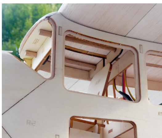
Die außen liegenden Flächendübel sind eine nicht häufig anzutreffende Variante zur Tragflächenarretierung
