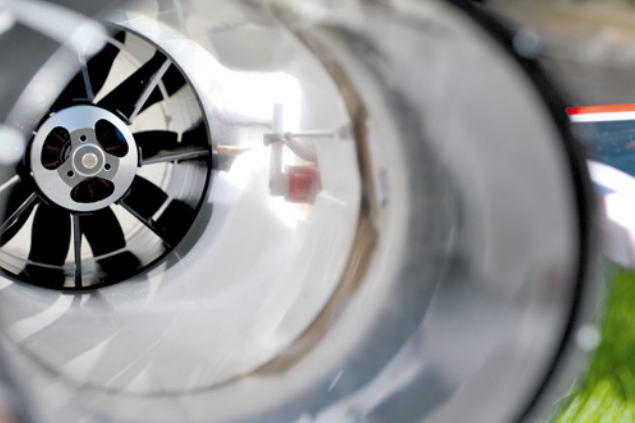
Der Impellerkanal ist sauber verlegt und wegen der durchsichtigen Folie sind auch die Taileron-Servos für eine Funktionskontrolle gut sichtbar
