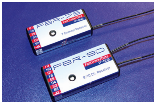
Für die Funktionskontrolle hatten wir die beiden abgebildeten PowerBox-Empfänger im Einsatz, die bei Bedarf sieben/neun PWM-Kanäle über die Steckerleiste direkt an die Servos ausgeben und alternativ alle 26 Kanäle über ein serielles Patchkabel beispielsweise zur PowerBox Mercury SRS übertragen können
