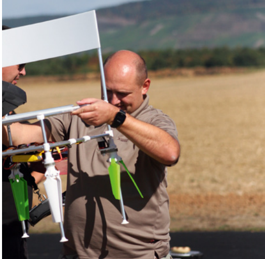
Heinrich Gelver konstruierte den Stuhl am PC und druckte in 3D-Druck-Technik vier komplette Zahnriemengetriebe inklusive Dreiblatt-Klapp-Propellern mit 15 x 6 Zoll, die in die Beine des Stuhls integriert sind
