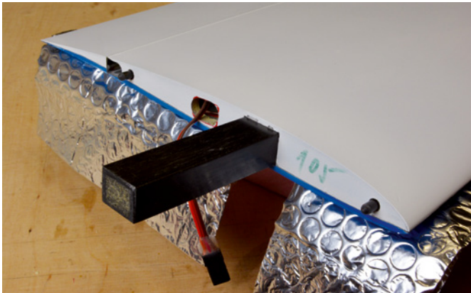
Der Anschluss der Außenflügel an das Flügelmittelteil erfolgt über einen CFK-Vierkant mit vorgebender V-Form
