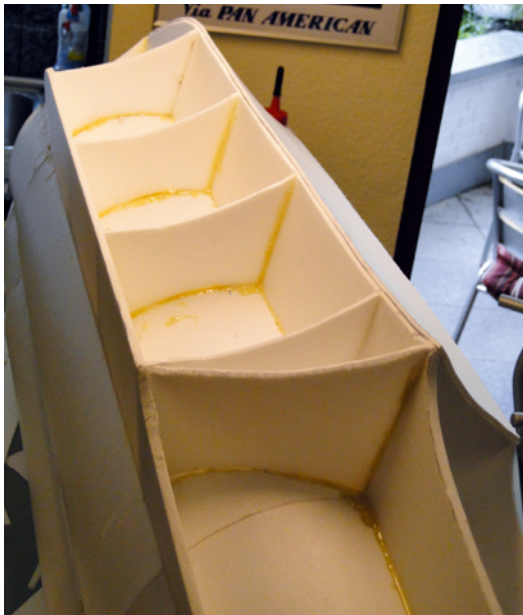
Das Unterwasserschiff ist im Gegensatz zum Rest des Rumpfs aus 6-mm-Depron gebaut, PU-Leim sorgt für festen Halt der Spanten
