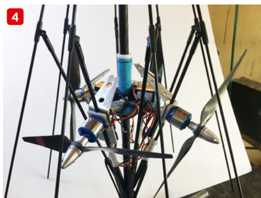
1) Den Bau des Sonnenschirms übernahm Patrick Blanc. Er leistet zu jeder Inter-Ex ausgefallene Kreationen als Beitrag. 2) Der Schirm klappt ferngesteuert auf, um dann aus seinem originalgetreuen Standfuß heraus in den Himmel zu steigen. 3) Zur Stabilisierung des Schirms wurden Komponenten der Firma DJI verwendet. 4) Die Konstruktion besteht zum größten Teil aus Aluminium und Carbon
