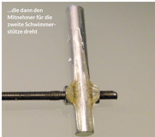
In die Achse der Einziehfahrwerk-Mechanik habe ich eine M3-Gewindstange eingeschraubt...
