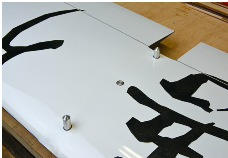
Diese zwei Stifte dienen dazu, die komplette Tragfläche kopfüber auszuspindeln – es waren 8 Gramm Blei in der linken Tragfläche notwendig
