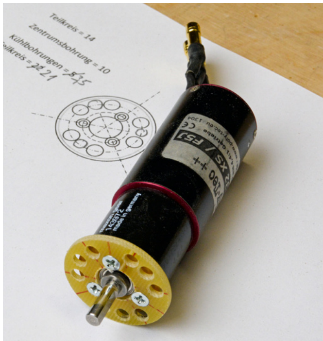
Der Motorspant ist fertiggestellt und mit dem Antrieb verschraubt
