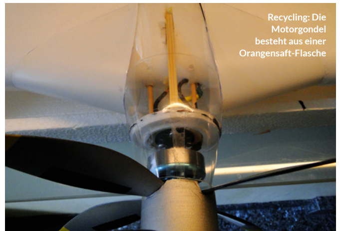
Fein gemacht: Lackiert und mit zweiteiligem Spinner versehen macht der Koax-Fake-Antrieb schon was her
