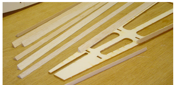
Aus Balsaholz bestehen im Rumpf nur die aus Dreikantleisen gebildeten Rumpfgurte. Ansonsten dominiert leichtes Pappelsperrholz.
