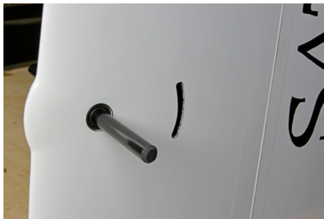
Die CFK-Höhenrudersteckung läuft spielfrei in einem Kugellager
