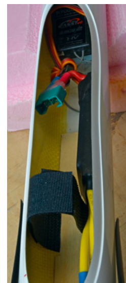
Der Empfänger liegt gut zugänglich unmittelbar hinter der Kabinenhaube. Der 3s-LiPo wird mittels Klettband auf dem einlamierten, dünnen Sperrholzbrett befestigt
