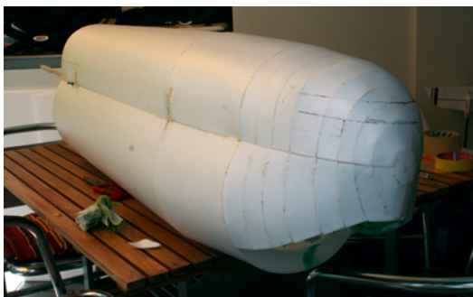
Nach Vorlage: Analog zum Kartonmodell wird der Rumpf aus Depron-Segmenten aufgebaut
