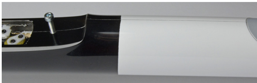
Der Übergang vom 2,4-Gigahertz-freundlichen Rumpfvorderteil zum „schwarzen“ Leitwerksträger erfolgt vor der Flächenaufnahme
