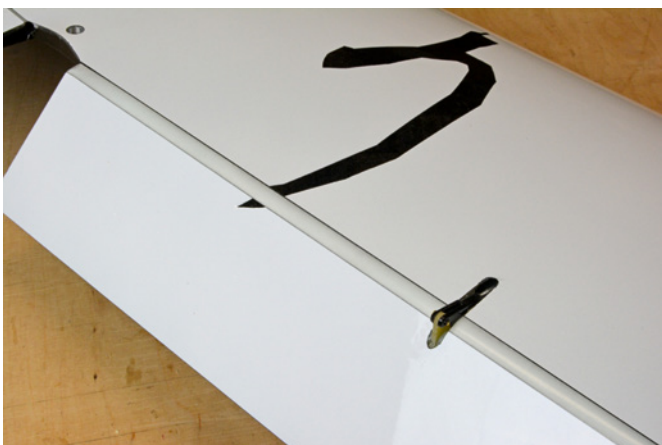
Die sauber angepasste Dichtlippe sorgt für einen strömungsgünstigen Übergang
