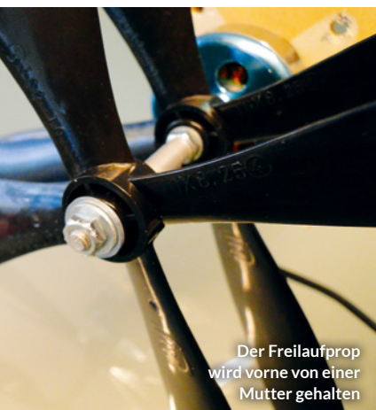
Fein gemacht: Lackiert und mit zweiteiligem Spinner versehen macht der Koax-Fake-Antrieb schon was her
