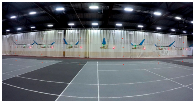
Der 60 Meter lange Flugversuch des 5-Meter-Modells mit Ionen-Wind-Antrieb erfolgte im störungsfreien Umfeld einer Sporthalle (Quelle: MIT)
