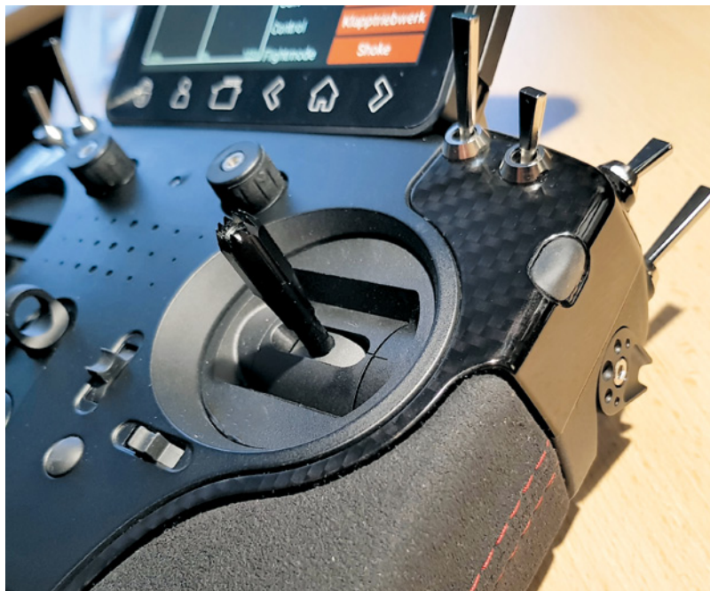
Serienmäßig ist der CORE mit 20 Gebern ausgestattet. Die vier Drehgeber rasten in der Mittelstellung deutlich ein. Dadurch kann der halbe Stellweg blind angefahren werden. Auf Wunsch sind zusätzlich dreistufige Knüppelschalter lieferbar, die aber nur bei der Pultanlage Sinn machen
