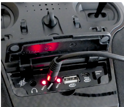
Unter der Klappe befinden sich alle Zu- und Abgänge für die externe Peripherie. Von links: 3,5-Millimeter-Klinkenbuchse für Kopfhörer, 12-Volt-Ladekabel-Anschluss mit zwei Kontroll-LED, USB-Buchse, Micro-USB und daneben ein PPM-Servoanschluss
