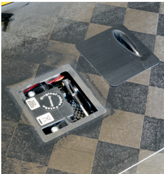
Die Wölblappenservos sind in Aufnahmen mit Gegenlagern verschraubt
