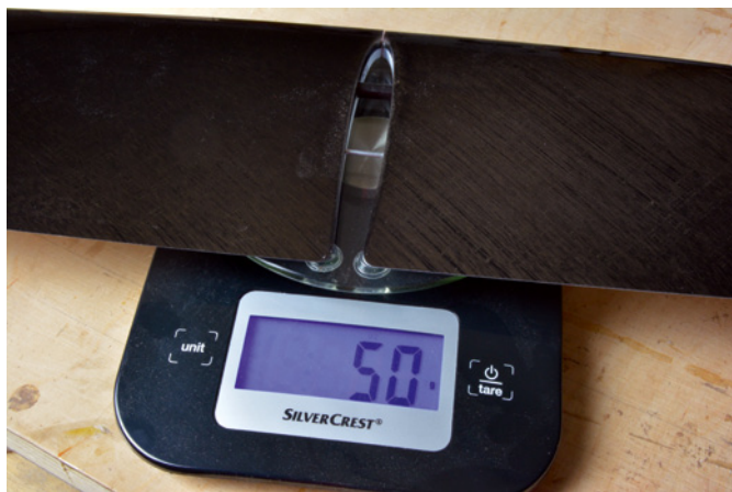
Stabil und trotzdem leicht – das komplette Höhenleitwerk bringt es auf genau 50 Gramm
