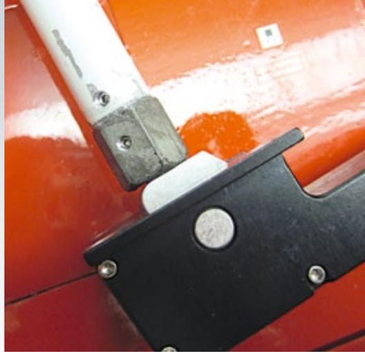
So sieht das Bein mit der aufgeklebten Verstärkungsmutter aus. Nur noch die Kanten verschleifen, dann kann es eingebaut werden
