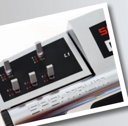
Oben links und rechts sind zwei von derzeit sechs möglichen Funktionsmodulen angebracht, die sich kippen und austauschen lassen
