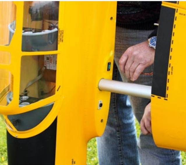
**Ein 40-mm-Alurohr verbindet Flächen mit Rumpf**
