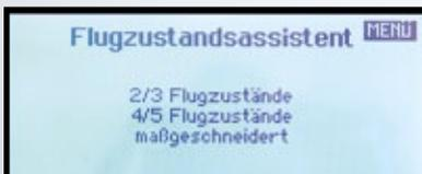
Bei Motorflugzeugen sind bis fünf und bei Seglern noch mehr Flugphasen möglich
