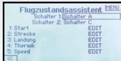
Die Schalterwahl bei den Flugphasen ist frei. Eine Umbenennung des Flugzustands zwecks Orientierung ist ebenfalls möglich
