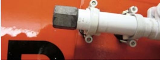
Die aufgeklebte Mutter ist zu verschleifen. So ist sichergestellt, dass sie nicht an der Mechanik klemmt
