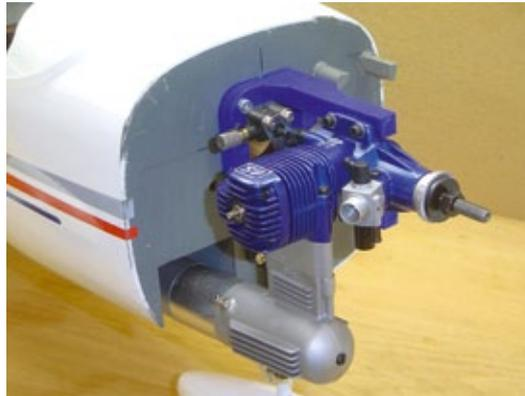
**Mit montiertem Distanzstück passt der Schalldämpfer genau in die vorbereitete Öffnung, ragt aber sehr weit aus der Haubenkontur heraus**
