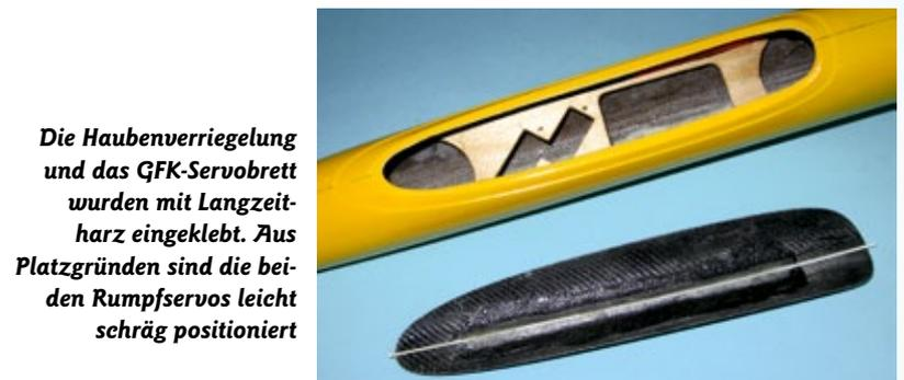
**Die Haubenverriegelung und das GFK-Servobrett wurden mit Langzeit-harz eingeklebt. Aus Platzgründen sind die beiden Rumpfservos leicht schräg positioniert**
