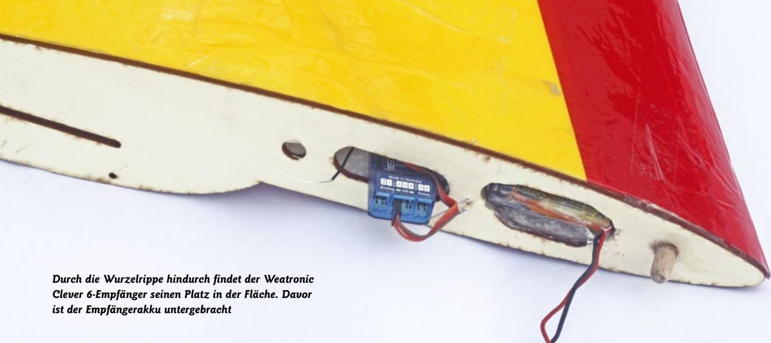
**Durch die Wurzelrippe hindurch findet der Weatronix Clever 6-Empfänger seinen Platz in der Fläche. Davor ist der Empfängerakku untergebracht**
