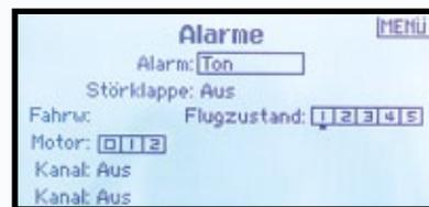
Mehrere Alarme – zwei davon freien Kanälen zuordnungsfähig – sind optisch, akustisch und/oder als Vibrationsalarm einstellbar
