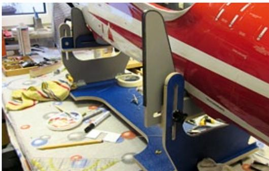
Der neue Modellständer von Finsinger Modellbau hat beim Umbau gute Dienste geleistet. Hier kann das Modell in allen Lagen und Höhen fixiert werden
