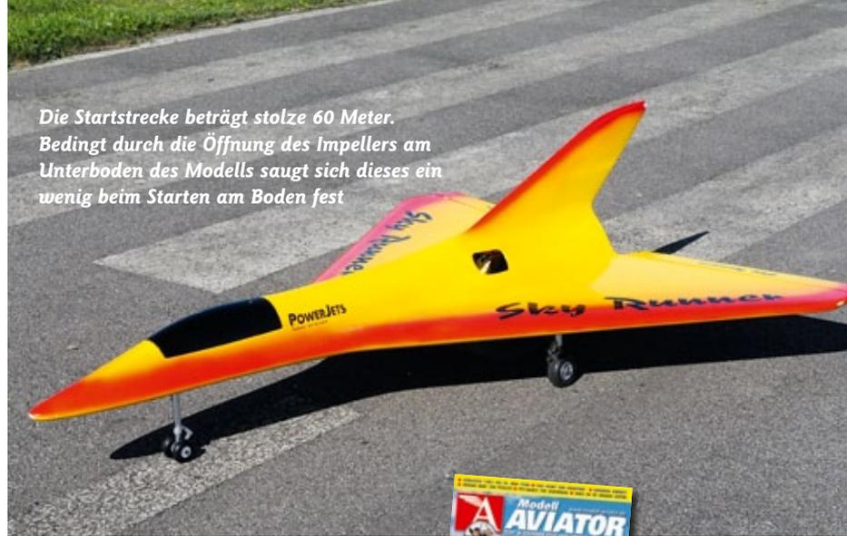
*Die Startstrecke beträgt stolze 60 Meter. Bedingt durch die Öffnung des Impellers am Unterboden des Modells saugt sich dieses ein wenig beim Starten am Boden fest*
