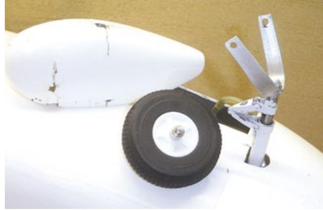
**Der viel zu weiche Bügel des Bugrads überstand den ersten Startversuch leider nicht. Dadurch wurde auch der Radschuh schwer beschädigt**
