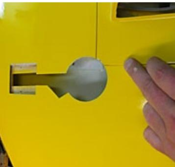
Es ist hilfreich, vor dem Heraustrennen der Fahrwerksschächte Schablonen anzufertigen. Außerdem sollten die Schnittkanten mit Kreppband abgeklebt werden, damit keine Lackabplatzungen entstehen
