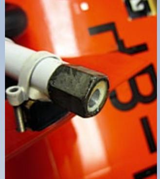
Ein Blick von oben auf die neue Verstärkung mittels der Mutter
