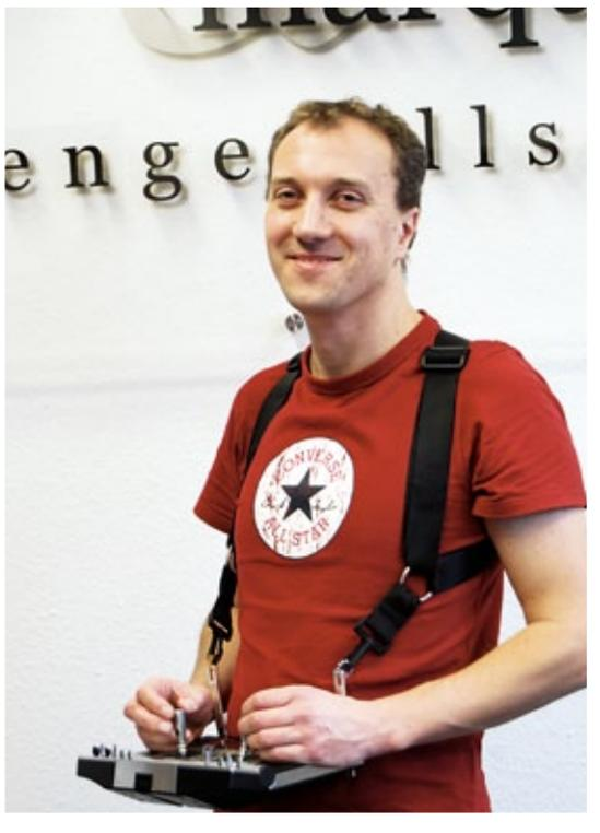
**Eingehängt in Staufenbiels Kreuzgurt, liegt der Pulsender gut an. Handauflage und Griffigkeit der Steuerknüppel sind sehr gut**
