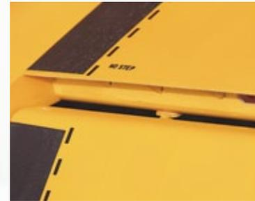
**Entsprechend dem Original sind die Landeklappen als Spaltklappen ausgeführt**
