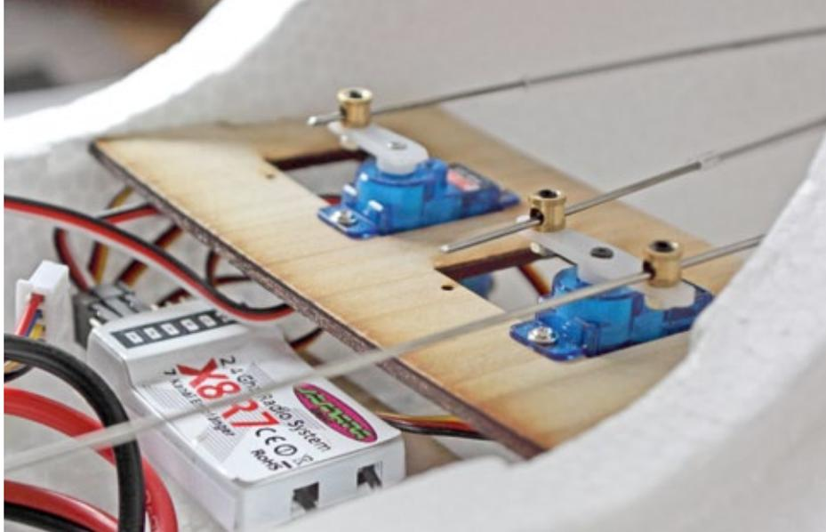
**Das Servo für das Seitenruder ist auch für das Bugfahrwerk zuständig und darf auch gerne ein Metallgetriebe haben**
