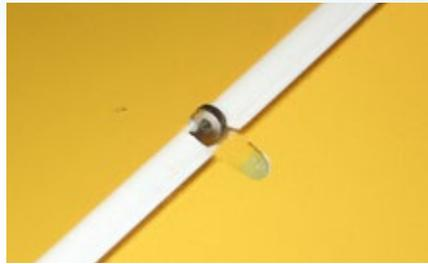
**In die Ruderklappen sind lasergeschnittene Metallruderhörner eingearzt. Hier noch mit zu wenig Abstand zum Drehpunkt, aber bei aktuellen Modellen ist das behoben**
