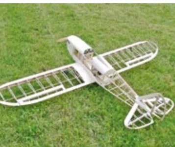
**Aus Balsagaruten und -spanten, Sperrholzspanten und -rippen entsteht das Fly Baby**
