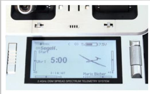
Links neben dem sehr gut ablesbaren, großen Display ist der nicht hervorsteckende Ein-Aus-Schalter und rechts der Rolldrucktaster zum Programmieren platziert
