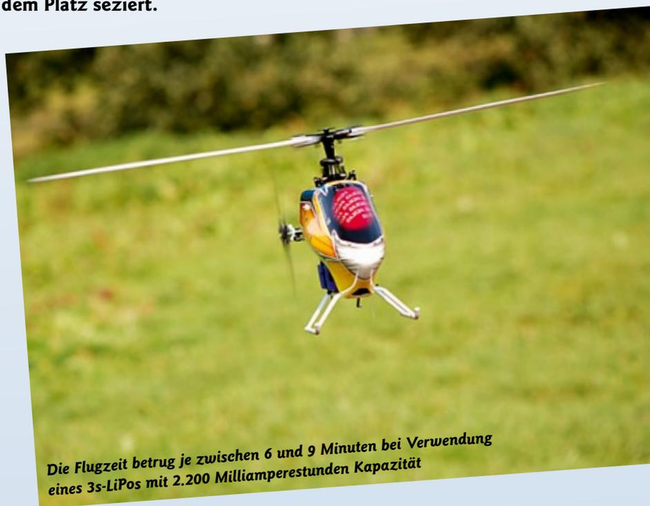
Die Flugzeit betrug je zwischen 6 und 9 Minuten bei Verwendung eines 3s-LiPos mit 2.200 Milliamperestunden Kapazität
