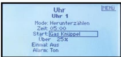
**Zwei Timer, die die Zeit stoppen, mit- oder runterzählen lassen sich einstellen – verknüpft mit einem frei wählbaren Kanal oder Schalter**
