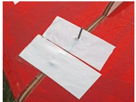
*130 Millimeter von der Nase entfernt wird schräg ein Schlitz in die beiden Wurzelrippen gefeilt, um den 3-Millimeter-Federstahl für den Hochstartring der Flitsche aufzunehmen*
