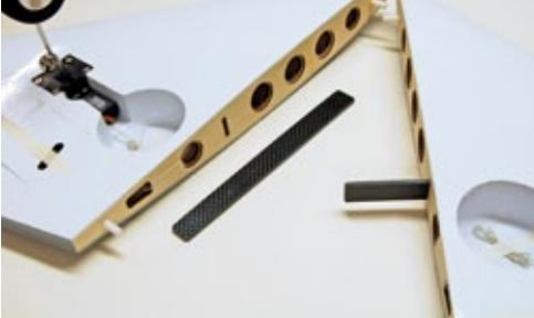
**Zwei CFK-Stangen übertragen die Kräfte in den Rumpf**
