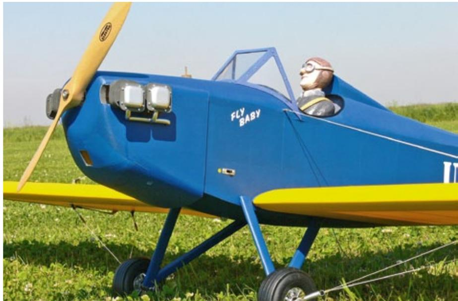
**Elektrisch mit Zylinderköpfen? Die Attrappen sind für das vorbildgetreue Aussehen wichtig. Das Stahldrahtfahrwerk ist mit Balsa beplankt und lackiert**
