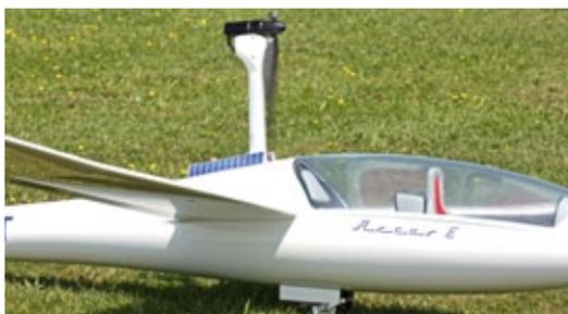
**Das Triebwerk ist hochgelaufen und gleich rollt das Modell an um nach zirka 30 Meter sicher abzuheben**
