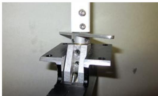
**Das Bugfahrwerk ist fertig zum Einbau. Gut zu sehen die leichte Abschrägung an der Halterung, damit die Anlenkung beim Einfahren nicht hängen bleiben kann**
