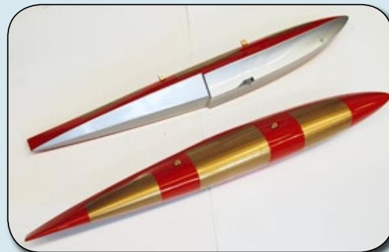
*Exakt lackiert, mit Nieten sowie Stoßkanten versehen und robust präsentieren sich die Schwimmer*
