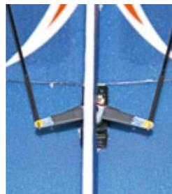
**Die V-Form des Querruderhebels hebt die mechanische Differenzierung durch die asymmetrische Anlenkung auf. Die Z-Stahldrähte erlauben vor dem Verkleben das genaue Einstellen der Anlenkungen**
