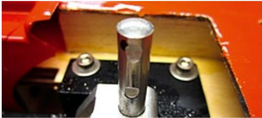
Gehärteter Bugfahrwerkszapfen fürs Fahrwerksbein
