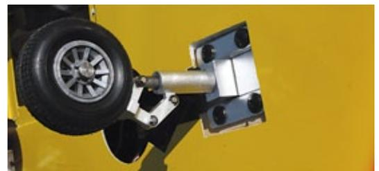
Die mögliche Länge der Federbeine ist aufgrund der Konstruktion begrenzt. Die gelieferten RCLander Fahrwerksbeine haben von der Länge gerade so gepasst. Es musste nur ein wenig von der Triebwerksverkleidung entfernt werden
