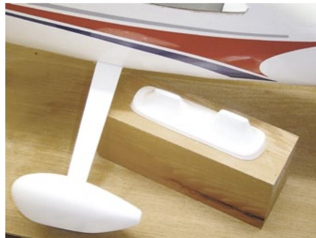
**Für einen sauberen Übergang vom Rumpf zum Fahrwerk liegen Verkleidungen bei. Sie müssen aus dem Kunststoffblock herausgetrennt und angepasst werden**
