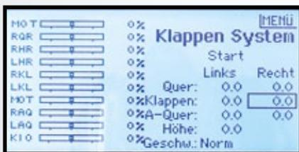
Die Klappenstellungen – hier für Sechsklappenmodell – lassen sich abhängig von der Flugphase bestimmen
