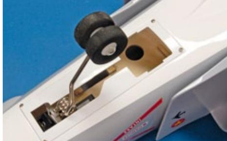
**Das lenkbare Bugrad mit 2 x 33 Millimeter Reifendurchmesser ist montiert und die Rumpfabdeckung aufgeschraubt**
