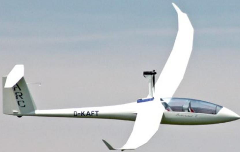
Das KTW ist wieder ausgefahren und sofort nach dem Hochlaufen auf Maximaldrehzahl steigt das Modell in einem Winkel von über 30 Grad in den Himmel auf der Suche nach neuen Thermikfeldern
