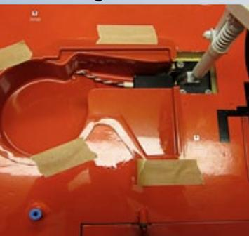
**Die Schachtabdeckung konnte nach erfolgreicher Funktionskontrolle wieder eingesetzt werden. Zum Trocknen wird sie mit Klebeband in Position gehalten**
