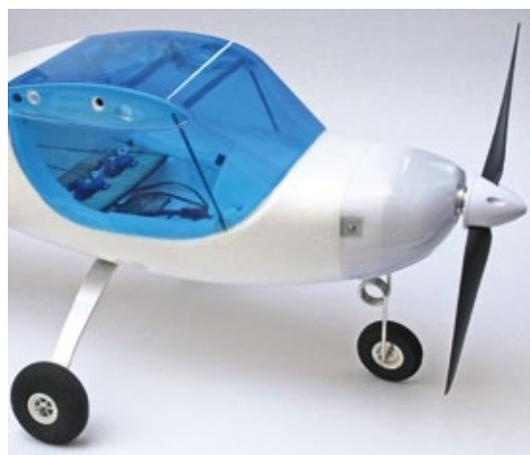
**Das Cockpit ist mit einem Fensterelement abgedeckt, was den Akkuwechsel aufgrund einer fehlenden Akkuklappe sehr erschwert**
