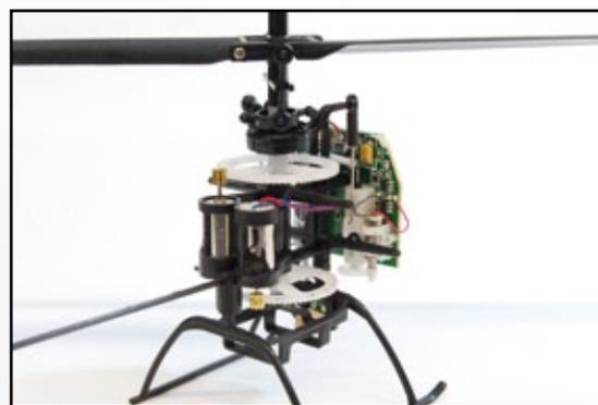
*Auf der Platine des Scout CX ist die komplette RC-Steuerung integriert*
