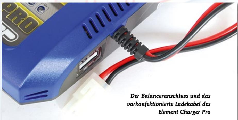
Der Balanceranschluss und das vorkonfektionierte Ladekabel des Element Charger Pro
