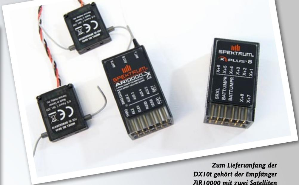
**Zum Lieferumfang der DX10t gehört der Empfänger AR10000 mit zwei Satelliten (links). Mit dem X-Plus-Empfänger sind acht weitere Kanäle nutzbar**
