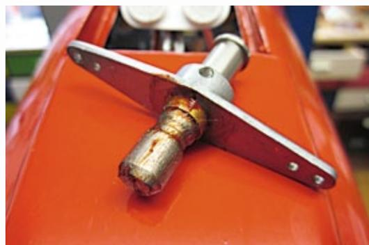
**Die Anlenkung des Bugfahrwerks mit dem Messingrohr zum Anpassen des Durchmessers**
