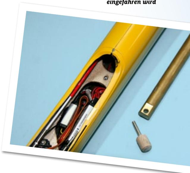
Das Servobrett wurde im hinteren Bereich aufgedoppelt und mit einer Einschlagmutter versehen. Die Ballaststange besitzt eine Bohrung und der vordere Bereich wurde auf zwei Seiten flach gefeilt. Mittig im Bild die modifizierte Schraube zur Befestigung
