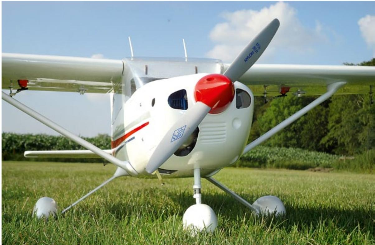
dass dies auch gar nicht nötig ist, da sich der in der Anleitung angegebene Maximalwert von 0,5 Grad bei einem Abstand der Flügelhinterkante zur Flächenauflage von 9 mm ergibt. Mit Material aus dem eigenen Fundus entsteht ein entsprechender Unterbau.
