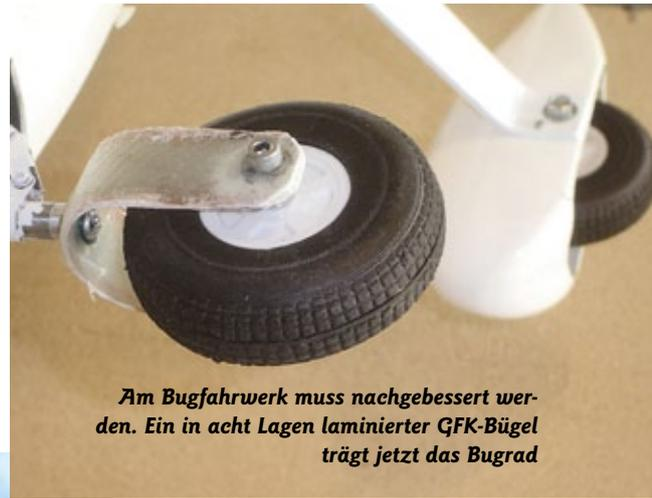
**Am Bugfahrwerk muss nachgebessert werden. Ein in acht Lagen laminiertes GFK-Bügel trägt jetzt das Bugrad**
