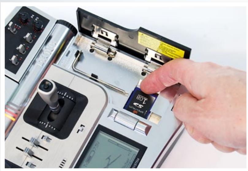
**Im rechten Fach ist der SD-Kartenslot. Speicherkarten bis zu 32 Gigabyte ermöglichen Software-Updates, umfangreiche Flugdatenlogs und Modellkopien**
