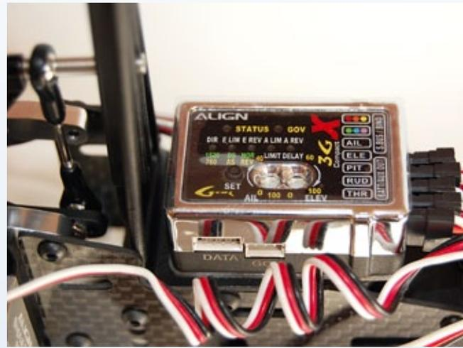
**Dreh- und Angelpunkt der Super Combo ist das 3GX-Flybarlessystem von Align**
