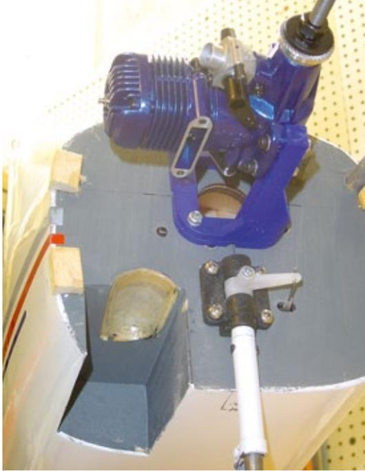
**Bei Montage des Schalldämpfers ohne Distanzstück muss der Boden des Dämpferschachts vertieft werden**
