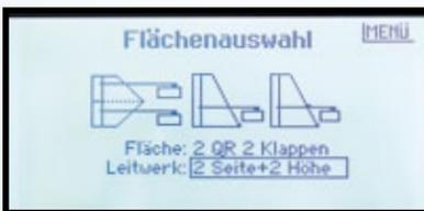
Das Programmieren von je zwei Servos pro Leitwerksruder wird bei Motormodellen automatisch unterstützt
