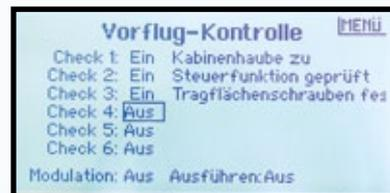
Für mehr Sicherheit sorgt die Funktion Vorflug-Kontrolle. Sechs Positionen können als Check abgefragt werden
