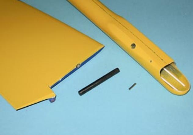
Das V-Leitwerk wird über einen CFK-Stab gehalten, als Verdrehsicherung dient ein kurzer Stahlstift. Die Aufnahmen in Rumpf und Leitwerk sind bereits erstellt und passen ohne Nacharbeit
