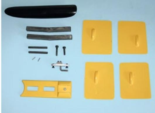
Der Kleinteilesatz besteht aus den Servoabdeckungen, der Haube, den zwei Flächenverbindern, dem Servobrett, dem verstellbaren Hochstarthaken und dessen Schrauben zur Befestigung
