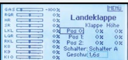
Die Landeklappenstellung für Motormodelle ist in Bezug auf die Flugphase oder einen Schalter sowie mit Verzögerung festzulegen
