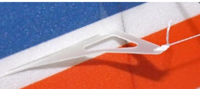
**Die GFK-Ruderhörner sind mit Sekundenkleber befestigt. Der Faden der Seilanlenkung ist daran verknotet und mit dem Servohorn verbunden. So ergibt sich eine spielfreie und vor allem leichte Anlenkung**
