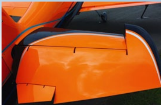
Das rechte Höhenruder ist mit einer elektrisch trimmbaren Flettner - Ruderfläche versehen
