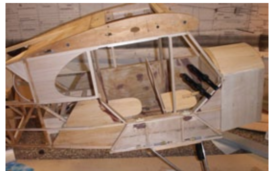
Die für eine Piper typischen Klapptüren wurden wieder aktiviert
