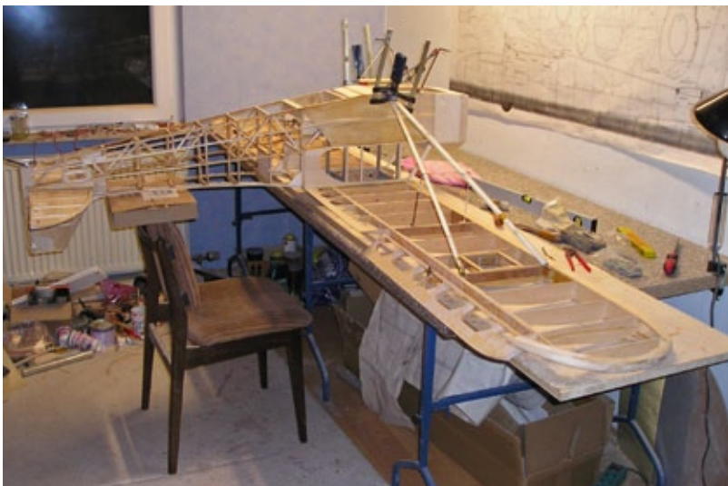
Die für eine Piper typischen Klapptüren wurden wieder aktiviert
