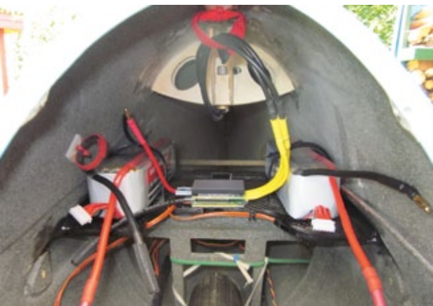
Zwei 5s-LiPos versorgen den Antrieb mit Energie. Sie sind Schwerpunkt-neutral im Modell platziert
