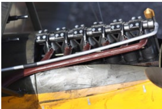
Mit etwas Mühe und Fotos von Originalen lässt sich die Scale-Optik der Motorattrappe erheblich steigern
