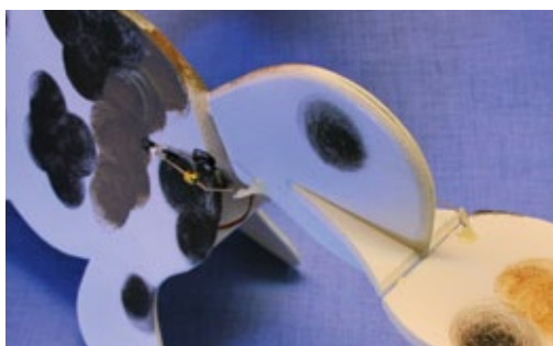
Anlenkung des Seitenruders. Zu beachten ist die Dämpfungsflosse des Höhenruders
