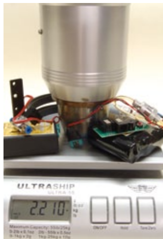
Turbine samt Ausrüstung schlagen mit rund 2.200 Gramm im Modell zu Buche
