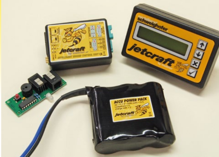
I/O-Platine (links), Elektronikbausteine ECU und EDT zum Programmieren sowie Einstellen (oben) und unten der Akku- Powerpack der J 130+
