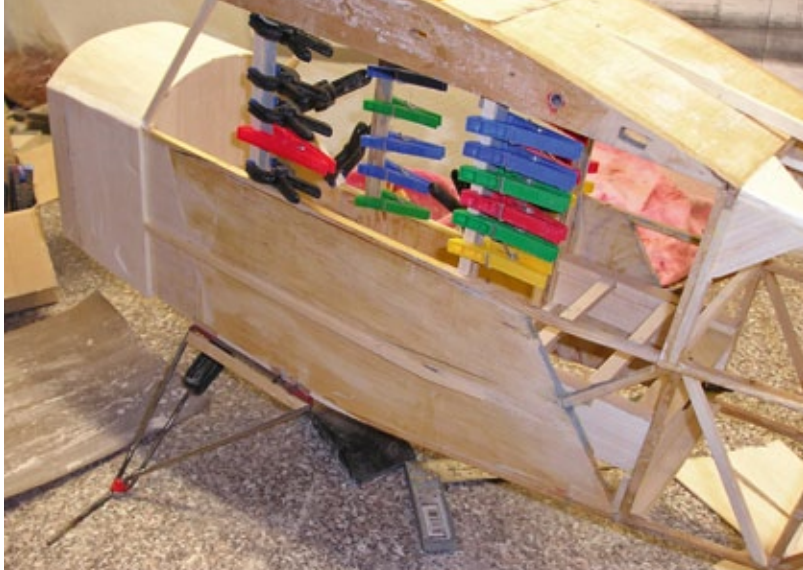
Neue Streben werden im Kabinenbereich verklebt
