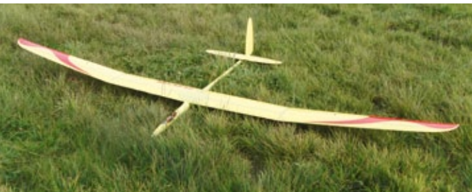
Das speziell für F5J entworfene Modell Electra von Mibo Modeli aus Slowenien ist mit Kreuz- oder V-Leitwerk erhältlich
