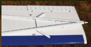
Klappbare Flächenstreben für einfachen Transport
