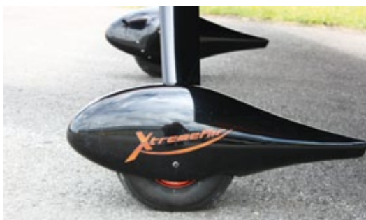
Das feste Zweibein-fahrwerk ist als Federstahlschwinge ausgelegt. Die Räder werden durch Rad-schuhe sehr schön und aerodynamisch vorteilhaft abgedeckt
