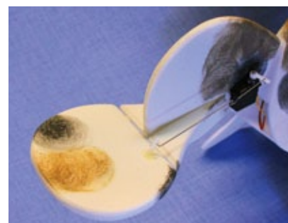
Anlenkung des Höhenruders. Das Servo sitzt auf dem Seitenruder
