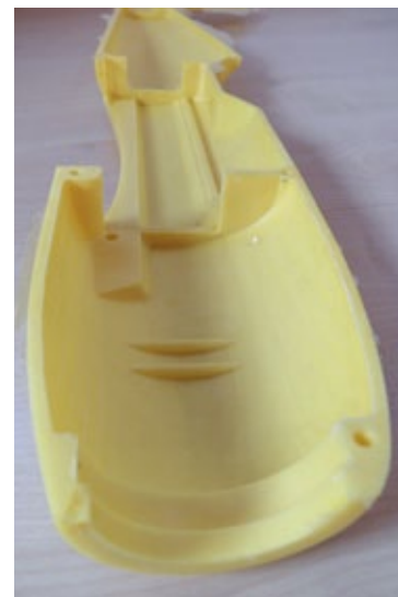
Eine fertige Rumpfhälfte von innen. Gut zu sehen sind die Montagezapfen
