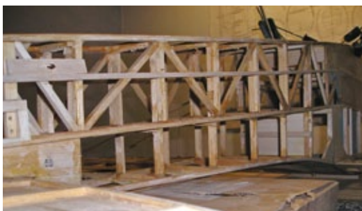
Klassische Gitterkonstruktion im Rumpheck
