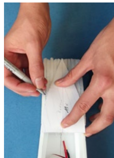
Die Kontur der Rumpfspitze wird angezeichnet. Im zweiten Schritt wird das überschüssige Material mit dem Cuttermesser grob weggeschnitten und mit Schleifpapier verrundet
