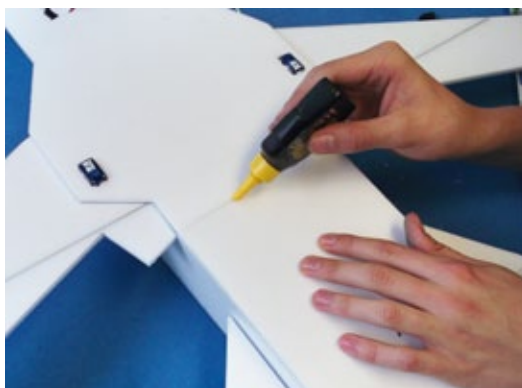
Für das großflächige Verkleben der Rumpfdeckel eignet sich der transparent aushärtende Klebstoff Pattex 100
