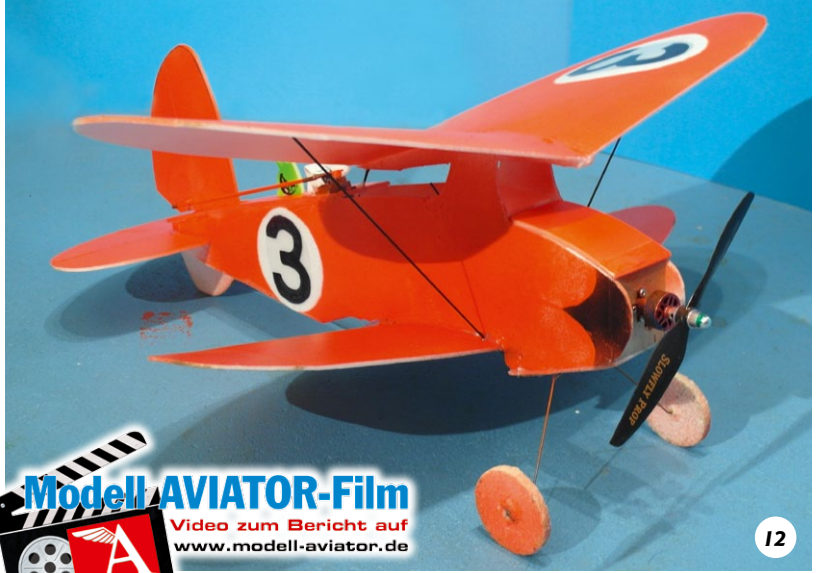
Selbstgemachte EPP-Räder reichen. Rote Farbe steigert die Antik-Optik
