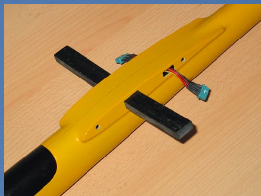
Hier sind die losen Steckverbindungen zu den Tragflächenservos zu sehen. Sie werden nach der Montage des Servobretts aus dem Rumpf geführt
