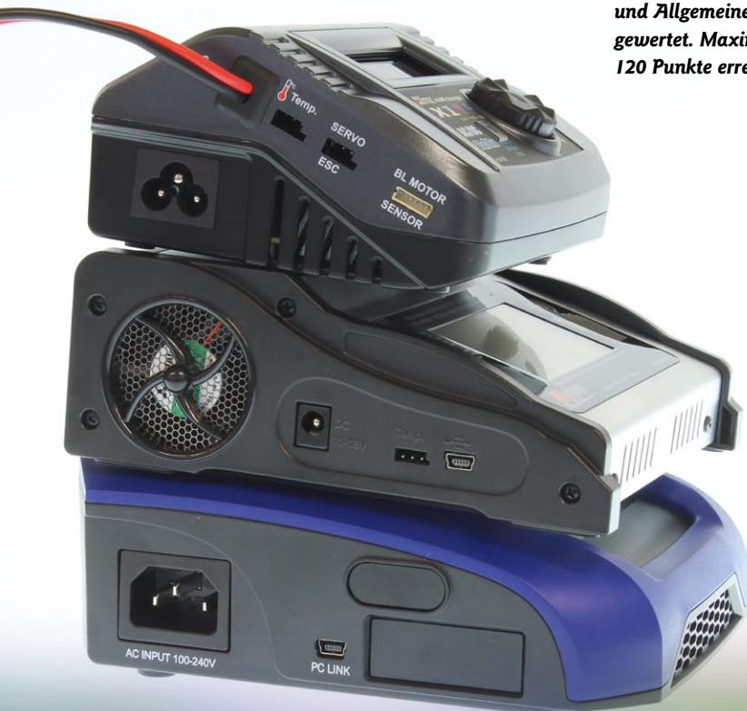
Das XI MF eignet sich als Servo-Tester und Brushlessmotor-Drehzahlmesser, das V1 bietet einen USB-Ladeausgang und das X80 ist als Netzteil verwendbar
