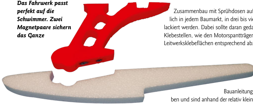
Aus diesen drei Teilen besteht jeweils ein Schwimmer. Gut zu erkennen: Die Magnete zur Befestigung
