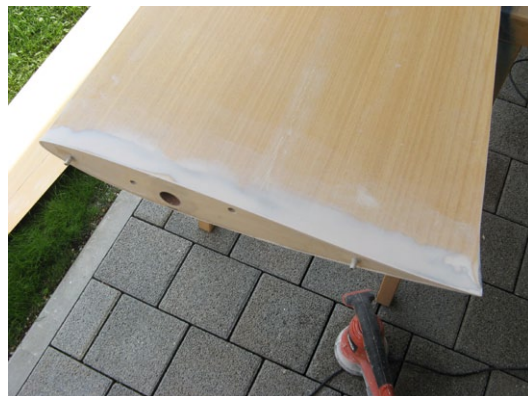
Nicht erforderlich, aber für eine 150-prozentig gute Optik wurde der Flächen-Rumpf-Übergang exakt angepasst. Dabei half eine Gegenplatte
