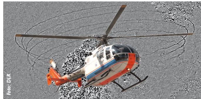
Sichtbar gemachte Blattspitzenwirbel. Diese sind Lärm verursachend
