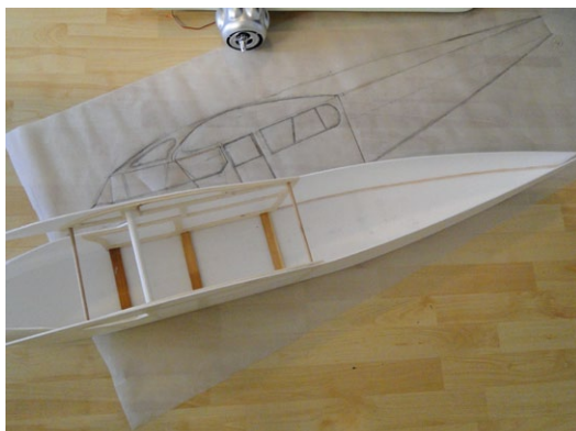
Aus 3er-Depron entsteht ein Kastenrumpf. Im Hintergrund die Handzeichnung
