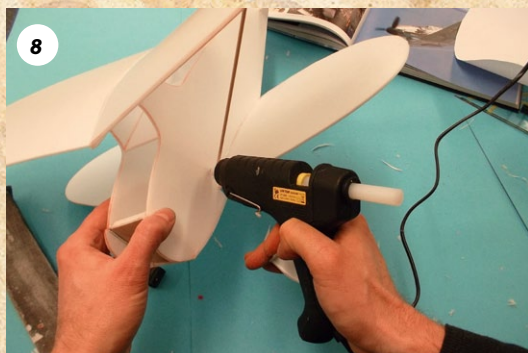
Diagonalstreben werden aus Schaschlikspießen oder 1,5-Millimeter-CFK hergestellt und stabilisieren den Oberflügel
