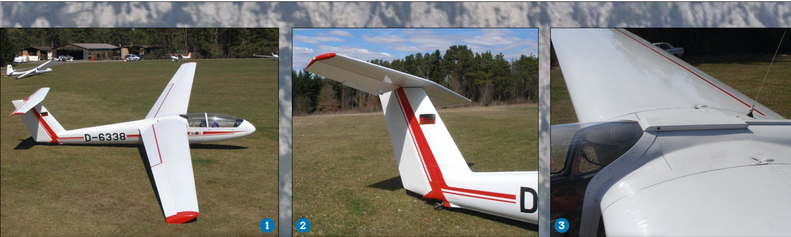
Der Super Blanik wirkt durch die gefeilte Fläche sehr schnittig (1). Das gedämpfte T-Leitwerk des L-23 Super Blanik (2). Der rechteckige Kasten hinter der Kabine dient als Gelenk für die nach hinten oben öffnende hintere Kabinenverglasung (3)
