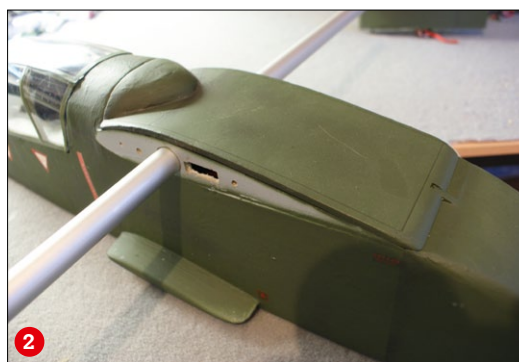
Eine Sperrholz-Wurzelrippe stabilisiert die Flügelkonstruktion (1). Auf dem langen Steckungsrohr sitzen die Flächen samt Gondeln und Leitwerken (2)
