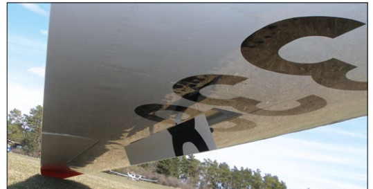
Die Bremsklappen-Sturzflugbremsen nach System DFS – Deutsche Forschungsanstalt Segelflug
