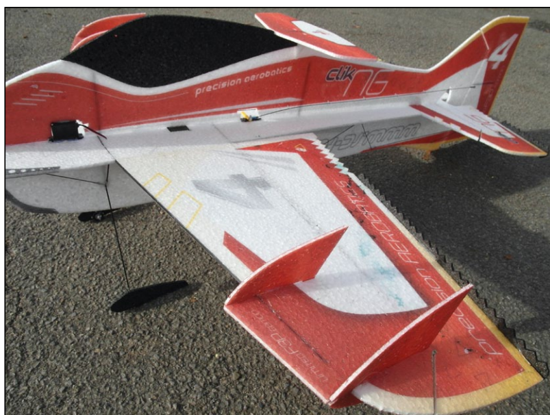
Aerodynamische Hilfen auf der Fläche unterstützen die Messerflugeigenschaften
