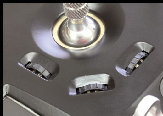
Die beiden übereinander angeordneten Kippschalter sind ungewohnt, lassen sich aber sehr gut bedienen. Der Drehschieber ist von oben oder unten bedienbar
