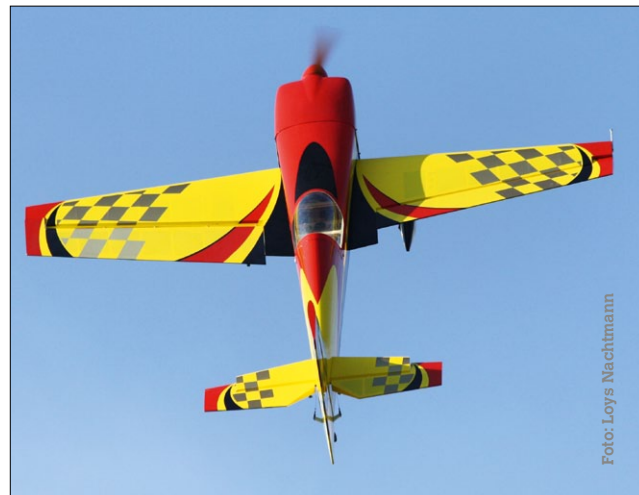
Abbildung 9: Kunstflugmodell wie die Edge 540 profitieren wesentlich von symmetrischen Profilen
