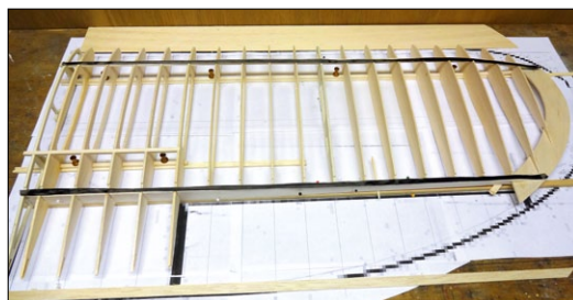
Die Tragfläche entsteht auf einem ebenfalls vergrößerten Ausdruck. Die Position von Rippen und Holmen sind von Hand eingezeichnet
