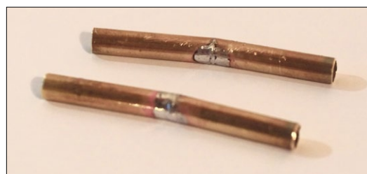
Die Flächenrohre werden erst mit dem Dremel eingesägt, dann an der Schnittstelle gebogen und wieder verlötet. So ist die V-Form des Flügels fest vorgegeben
