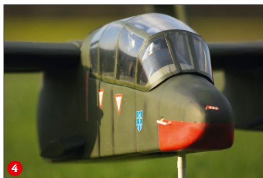
Angelschnur ist ideal zum verzugsfreien Ansteuern der Seitenrudder geeignet (3). Die Cockpitverglasung entstand aus mehreren Einzelteilen (4)
