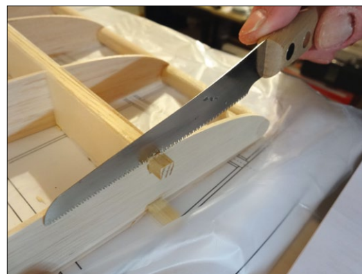
Da die Zähne der Japansäge nicht nach außen geschränkt sind, lassen sich Teile wie der Kiefernholm sauber bündig absägen
