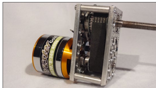
Ein Torcster-Brushlessmotor und ein selbst gebautes Zahnriemengetriebe in 1:1,7 bilden die Antriebseinheit
