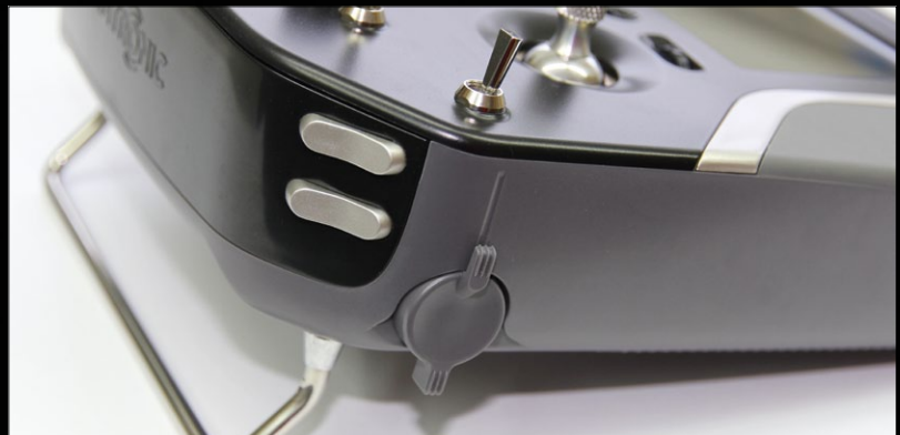
Die beiden übereinander angeordneten Kippschalter sind ungewohnt, lassen sich aber sehr gut bedienen. Der Drehschieber ist von oben oder unten bedienbar
