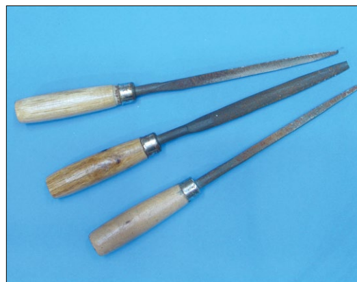
Rund-, Halbrund, Flach- und Vierkantfeilen helfen beim gezielten Bearbeiten von Holzteilen
