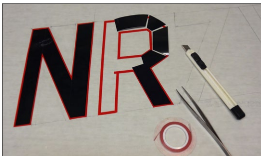
Auf Silikonpapier entstehen die großen Aufkleber aus Klebefolie und Zierstreifen
