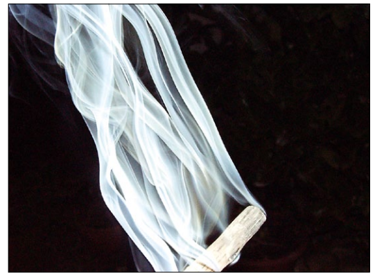
Abbildung 7: Am Bild einer Rauchströmung lässt sich die Entwicklung von laminarer Strömung (rechts) bis zur turbulenten Strömung gut erkennen
