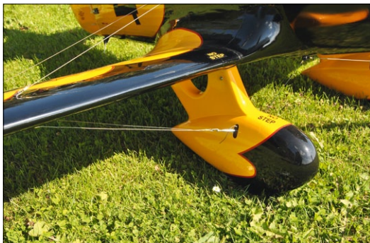
Am Radschuh sind Details der Abspannung mit Spannschloss gut nachzuvollziehen
