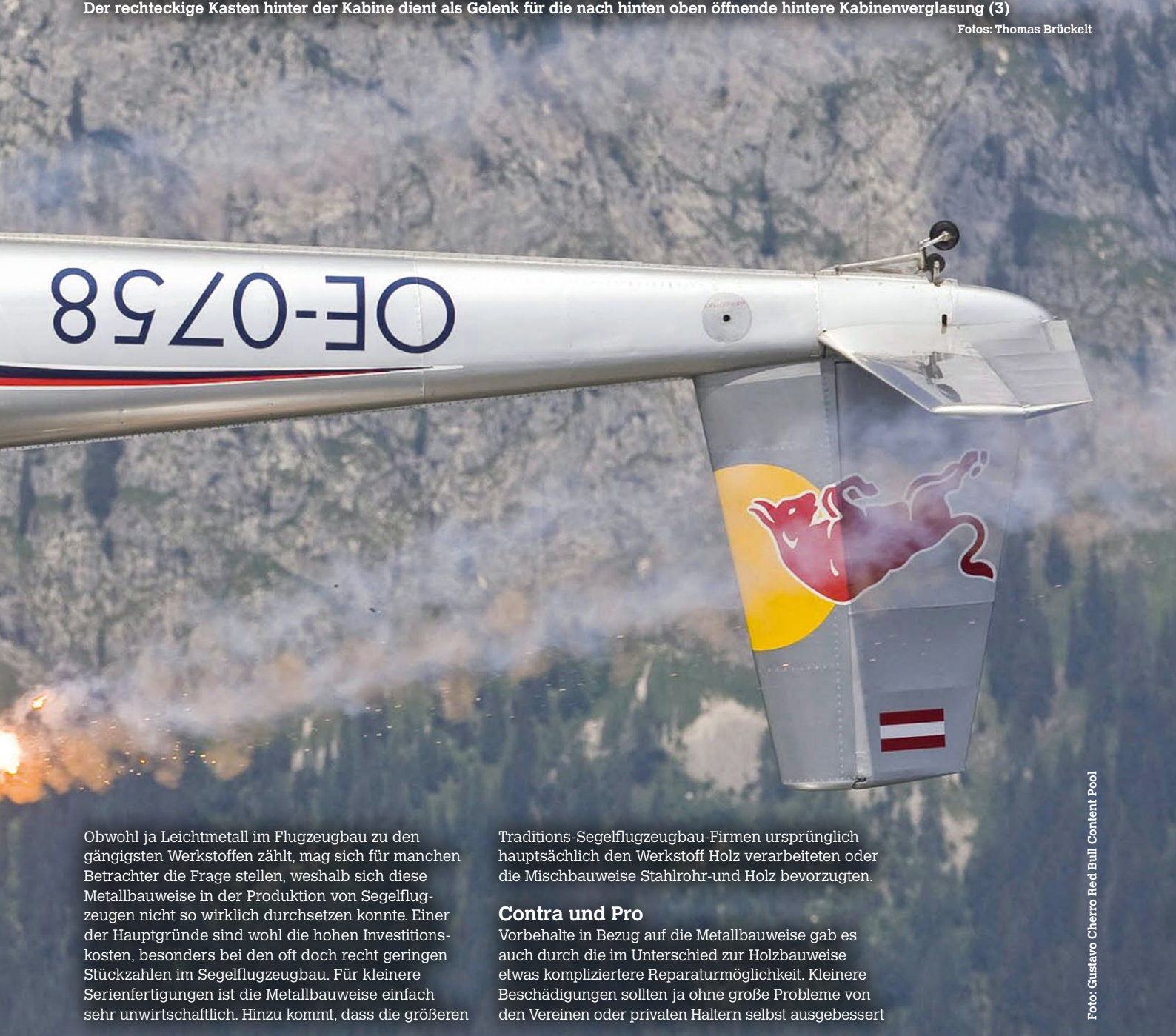
Der Super Blanik wirkt durch die gefeilte Fläche sehr schnittig (1). Das gedämpfte T-Leitwerk des L-23 Super Blanik (2). Der rechteckige Kasten hinter der Kabine dient als Gelenk für die nach hinten oben öffnende hintere Kabinenverglasung (3)
