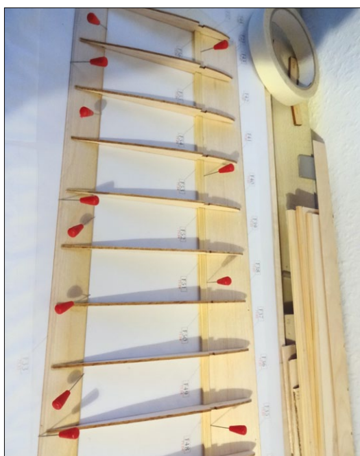
Zum Befestigen der Rippen auf der Sperrholz-Endleiste der Libelle ist Sekundenkleber das Mittel der Wahl
