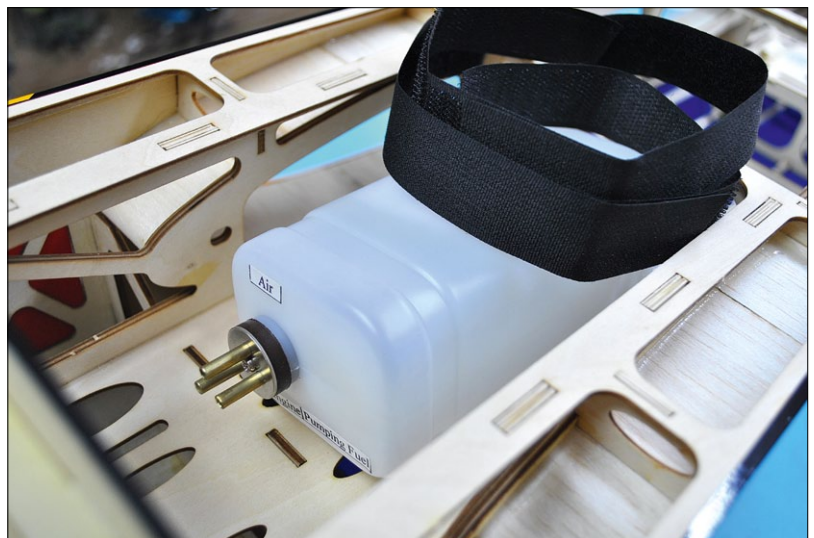
Der Tank mit Anschlüssen zum Einbau eines DLE 30 liegt dem Bausatz bei
