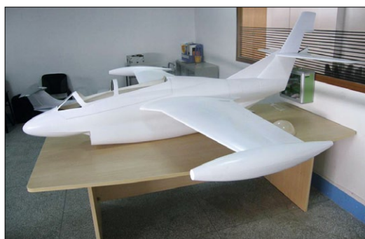
Der GFK-Rumpf ist zweiteilig ausgeführt und bei der Montage zusammensetzen
