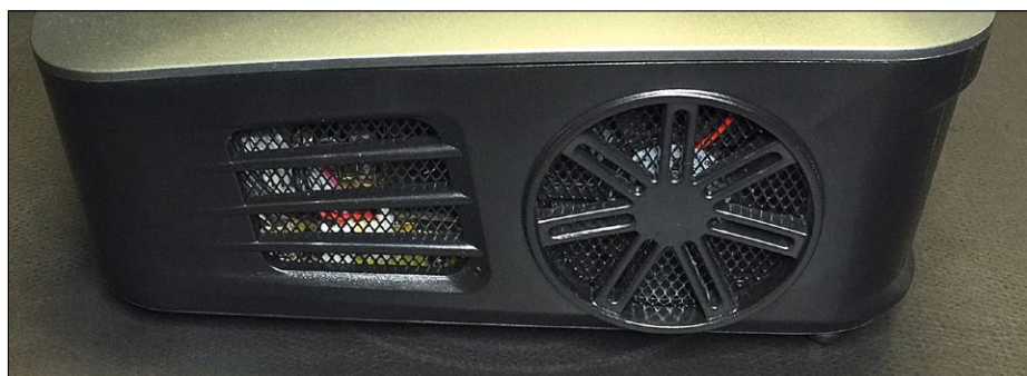
An den Seiten des Gehäuses befinden sich temperaturgeregelter Lüfter
