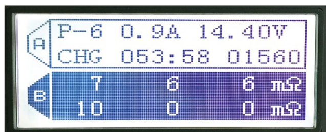
Messung des Innenwiderstands auf Kanal B
