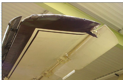
Abbildung 1: Mit den charakteristischen Vorflügeln und Fowler-Klappen war die Fi-156 das erste wirklich erfolgreiche STOL-Muster – ein Senkrechtstarter war er allerdings nicht
