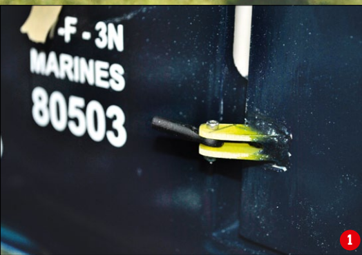
Die neue doppelte Lagerung der Seitenrudernanlenkung (1). Die kugelgelagerte Wippe für die Seitenrudernanlenkung. So gehen die auftretenden Kräfte nicht auf das Servo (2). Die Servohalterungen wurden noch mit M3-Schrauben und einem GFK-Bügel verstärkt, um sich nicht allein auf die angeklebten Hölzer zu verlassen (3)
