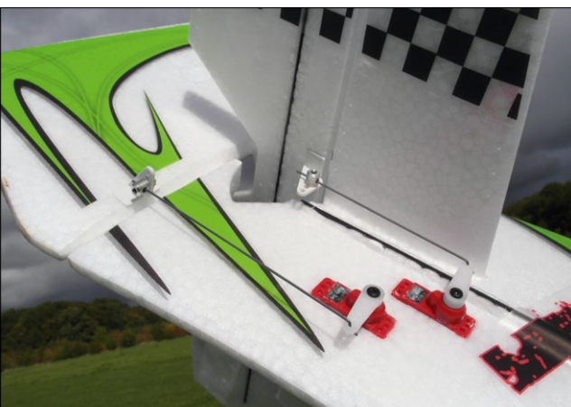
Die Nano-Karbonite-Servos überzeugen durch Stellgenauigkeit und Geschwindigkeit
