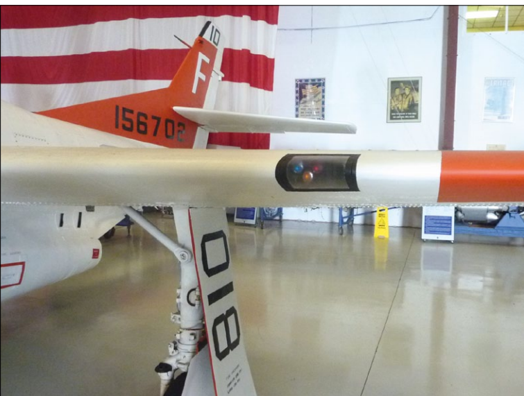
Der Landescheinwerfer ist in der Nasenleiste der linken Tragfläche angeordnet
