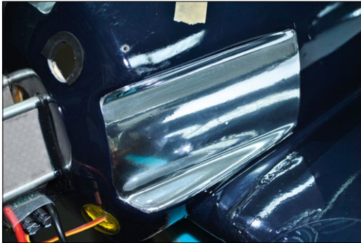
Die Hitzeschutzbleche sind beim Original verchromt. Hier wurde das mit eingepasster Chromfolie imitiert
