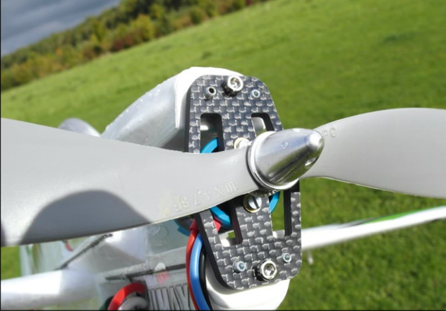
Der hier verbaute CFK- Motorspant ist sehr stabil, muss aber zugekauft werden
