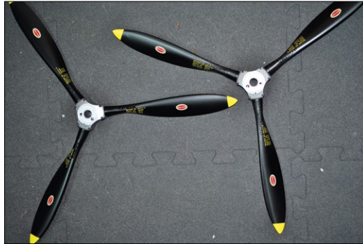
Zwei Ramoser Propeller für Rechts- und Linkslauf. Diese erhöhen um ein vielfaches den Scale-Charakter des Modells
