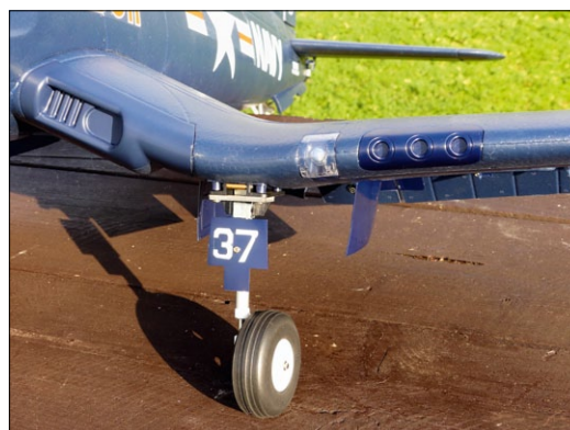
Die Fahrwerksbeine drehen sich beim Einfahren um 90 Grad und legen sich flach in den Schacht. Der eingebaute Door-Sequencer sorgt dafür, dass danach die Fahrwerkstüren zeitversetzt schließen
