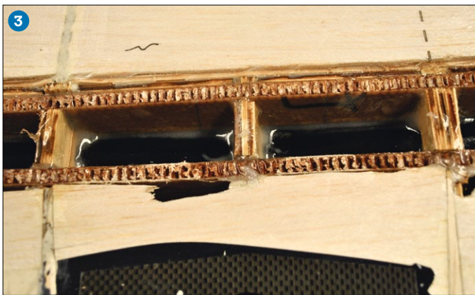
Das eine Flächenstück ist fast sauber vom Mittelteil abgebrochen. Aber das lässt sich reparieren (1). Stabile sowie leichte Honeycomb-Platten und kleine Stege sind dem Profilverlauf anzupassen (2). PU-Leim sorgt für eine kraftschlüssige Verbindung der Flächenteile und schäumt mit dem Aushärten auf (3). Im unteren Bereich ist die Beplankung zu entfernen und neues Stützmaterial wie GFK-Streifen sowie Honeycomb-Platte einzupassen (4)
