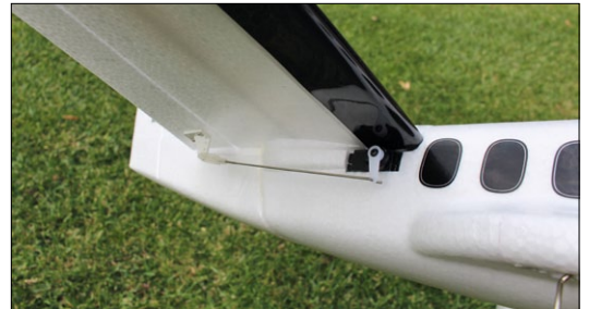
Die Anlenkung der Querruder (Delta-Mix) an der hinteren Tragfläche erfolgt jeweils über ein Digital-Servo. Quer und Höhe wird so über die beiden Querruder gesteuert
