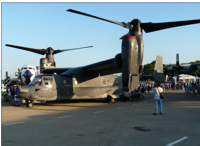
Abbildungen 6 und 7: Eine V-22 Osprey verwendet einen schwenkbaren Antrieb und stark verwölbbare, aber starre Flächen
