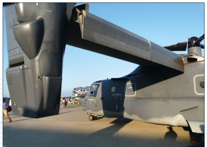
Abbildungen 6 und 7: Eine V-22 Osprey verwendet einen schwenkbaren Antrieb und stark verwölbbare, aber starre Flächen
