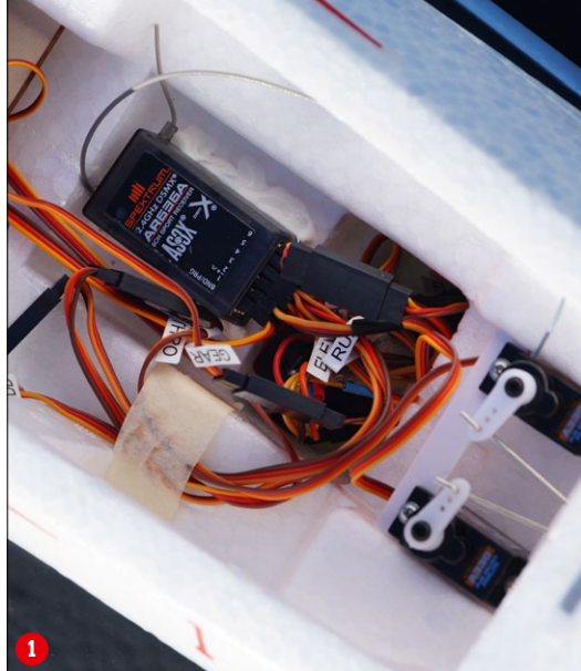
Das Kabelgewirr lässt sich kaum ändern, denn es sind immerhin sieben Servos und drei Einziehfahrwerke verbaut (1). Der fertig lackierte Propeller, die Detaillierung im Bereich der Cowling und das Bugfahrwerk sind für ein Fertigmodell kleine Highlights (2)
