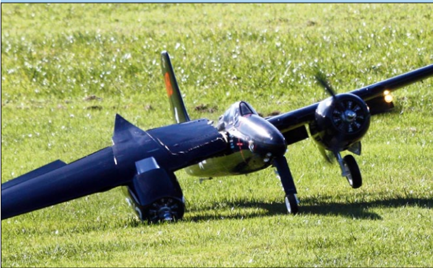
Beim erstmaligen Landen brach einfach eine Fläche an der Wurzelrippe ab. Die Landung war nicht hart, aber das ließ sich reparieren
