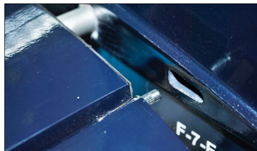
Das innere Lager eines Höhenruders vor dem Einharzen im Rumpf. Die Alu-Mutter verbleibt nach dem Trocknen im Rumpf und ein CFK-Stab schiebt sich beim Anstecken hinein
