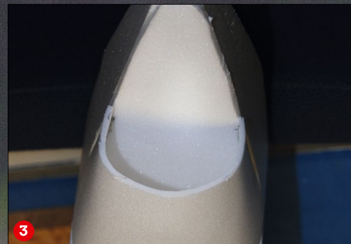
Ausgeschnittene Spanten und Rumpfsseiten mit aufgeklebten Aufleimern (1). Die Rumpfspanten werden ausgerichtet, mit Nadeln fixiert und mit PU-Leim verklebt (2). Der Lufteinlauf aus 3-Millimeter-Depron wird später mittels Heißluftföhn in Form gebracht (3)
