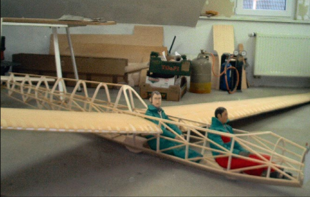
Das Modell entstand in klassischer Holzbauweise auf Spanten. Die Flächen sind beplankte Styrokerne
