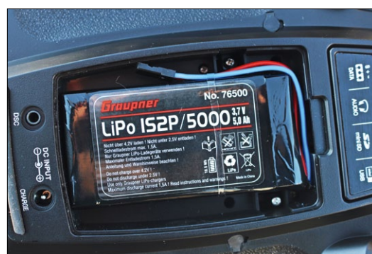
Der neue LiPo-Senderakku 1s2p hat mit 5.000 Milliamperestunden mehr Kapazität
