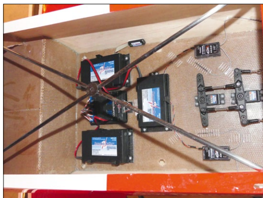
21: Die Pitts Beast von Delro hat ein Rohbaugewicht von nur 11,5 Kilogramm. Dies wurde durch die konsequente Verwendung leichter Materialien für den Bausatz erreicht, beispielsweise Waben-Platten (Honeycomb) für die Rumpfeinbauten
