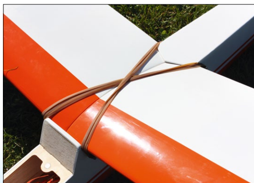
Flächenbefestigung mittels Gummis, simpel und seit einer Ewigkeit das Beste für Anfängermodelle
