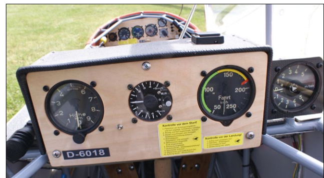
Nur die allerwichtigsten Instrumente finden sich vor dem hinteren Sitz: Höhenmesser, zweimal Variometer und Fahrtmesser
