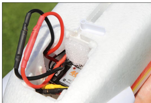
Die Servos für das Höhen- und das Seitenruder sind ohne montierte Tragfläche sehr gut erreichbar (3). Der Akku kommt weit vorne im Modell unter und ist zum Austausch gut erreichbar (4)
