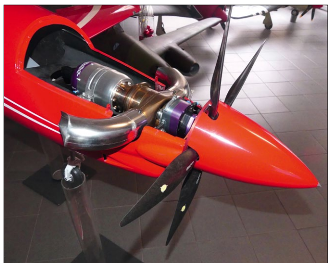
2: Im Ausstellungsmodell der PC-21 eingebaut ist die JetCat SPT-10, die SPT-5 soll aber völlig ausreichend sein!
