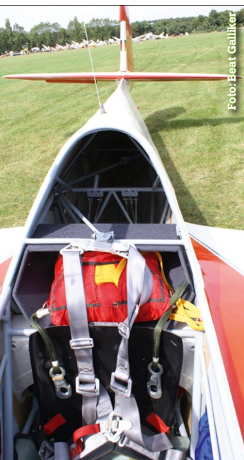
Ein Blick auf den teilweise mit Sperrholz beplanktem Rumpfrücken
