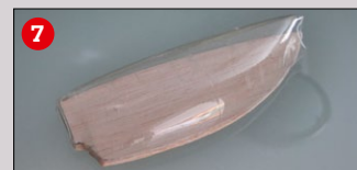
Die Kunststoffteile werden beschnitten und dann Balsaspanten eingeklebt (7)
