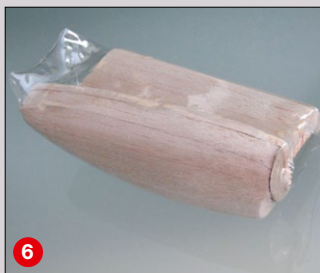
Mit dem Heißluft-Föhn wird die PET-Flasche erhitzt, bis sie schrumpft und sich um die Form schmiegt (6)
