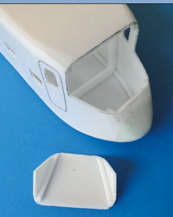
Der Cockpit-Bereich ist nach dem Zusammenbau wieder herausgetrennt worden
