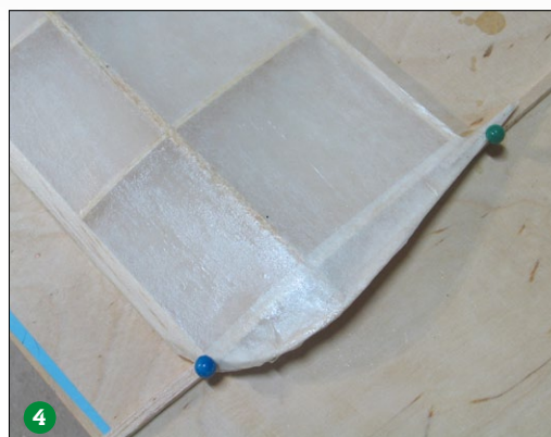
Der Überstand am Randbogen wird alle 5 bis 8 Millimeter eingeschnitten und erst dann umgelegt. So vermeidet man Falten (3). Achtung Verzug droht! Beim Trocknen, egal ob Kleister, Wasser oder Lack, muss der Flügel auf dem geraden Baubrett aufgespannt werden (4)
