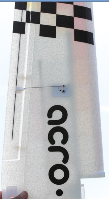
Die Verstärkungen im Tragflügel werden im Gegenlicht gut sichtbar
