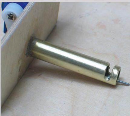
Das Messingrohr ist eingeschlizt, damit das Schleppseil nicht nach oben ausweichen kann. Damit der obere Teil nicht zu schwach wird, sitzen zwei handelsübliche Messingrohre ineinander
