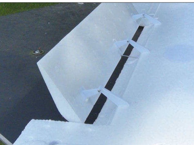
Diese Scharniere mit dem versetzten Drehpunkt sorgen dafür, dass die Landeklappen als Spaltklappen so wirksam sind
