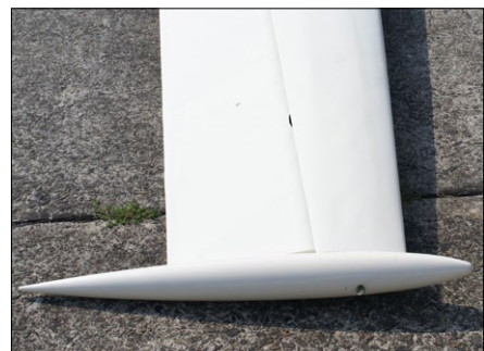
Stromlinienförmige Randkeulen verringern den aerodynamischen Widerstand
