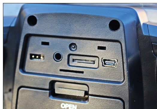
Auf der Sender-Rückseite hinter der Klappe neben dem Batteriefach befinden sich der USB-Anschluss, der SD-Karten-Slot, der Kopfhörer-Anschluss sowie die Daten-Buchse zum Anschluss einer Smartbox
