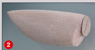
Dann ist alles in Form zu schleifen – allzu glatt muss das bei dieser Methode gar nicht werden (2)
