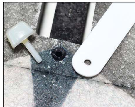
Der Verschluss des Akkufachs besteht aus einem eingeklebten Gewinde-Insert und einer Flügelschraube, beides aus Kunststoff
