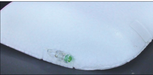
An den Randbögen befinden sich Lichteinheiten mit den Positionslichtern und den Blitzern
