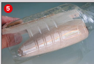
Dann steckt man je eine Form-Hälfte in die Flasche. Mit Holzklötzchen und Keilen wird die Flasche vorgespannt (5)
