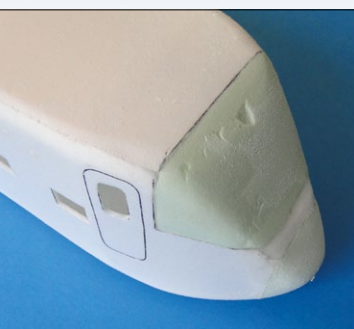
Ein Styrodur-Klotz wurde der Rumpfkontur entsprechend angepasst und verschliffen
