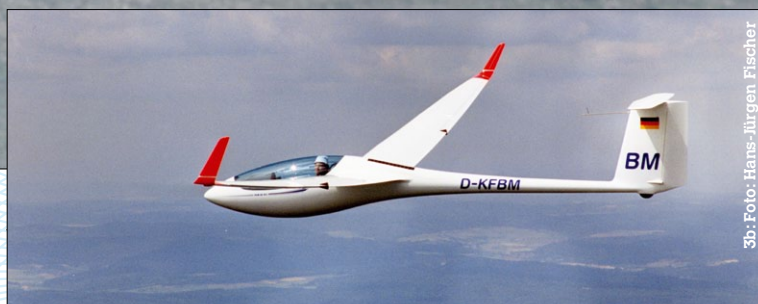
Abbildungen 3a/b: Eine Foka (a) hat trotz des deutlich schmalen Rumpfs eine schlechtere Gleitleistung als eine großvolumige ASW28 (b)
