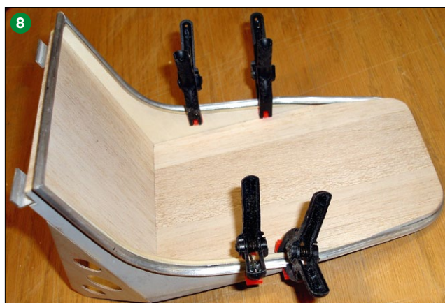
Die Holzteile für den Pilotensitz sind ebenfalls im Cockpit-Bausatz der Storchschmiede enthalten. Wer die Umrandung haben möchte, muss sie selbst aus 3-mm-Alurohr biegen. Wie das geht, ist auf der Firmen-Homepage ( www.storchschmiede.de ) zu sehen
