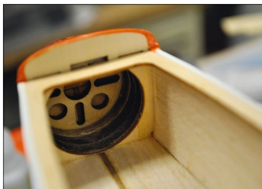
Das Modell ist für einen E-Antrieb vorbereitet und der Motorträger daher bereits eingesetzt
