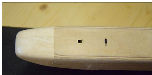
Das Flitschenröhrchen und der Schlitz für die F-Schleppkupplung sind im Rumpf eingebaut
