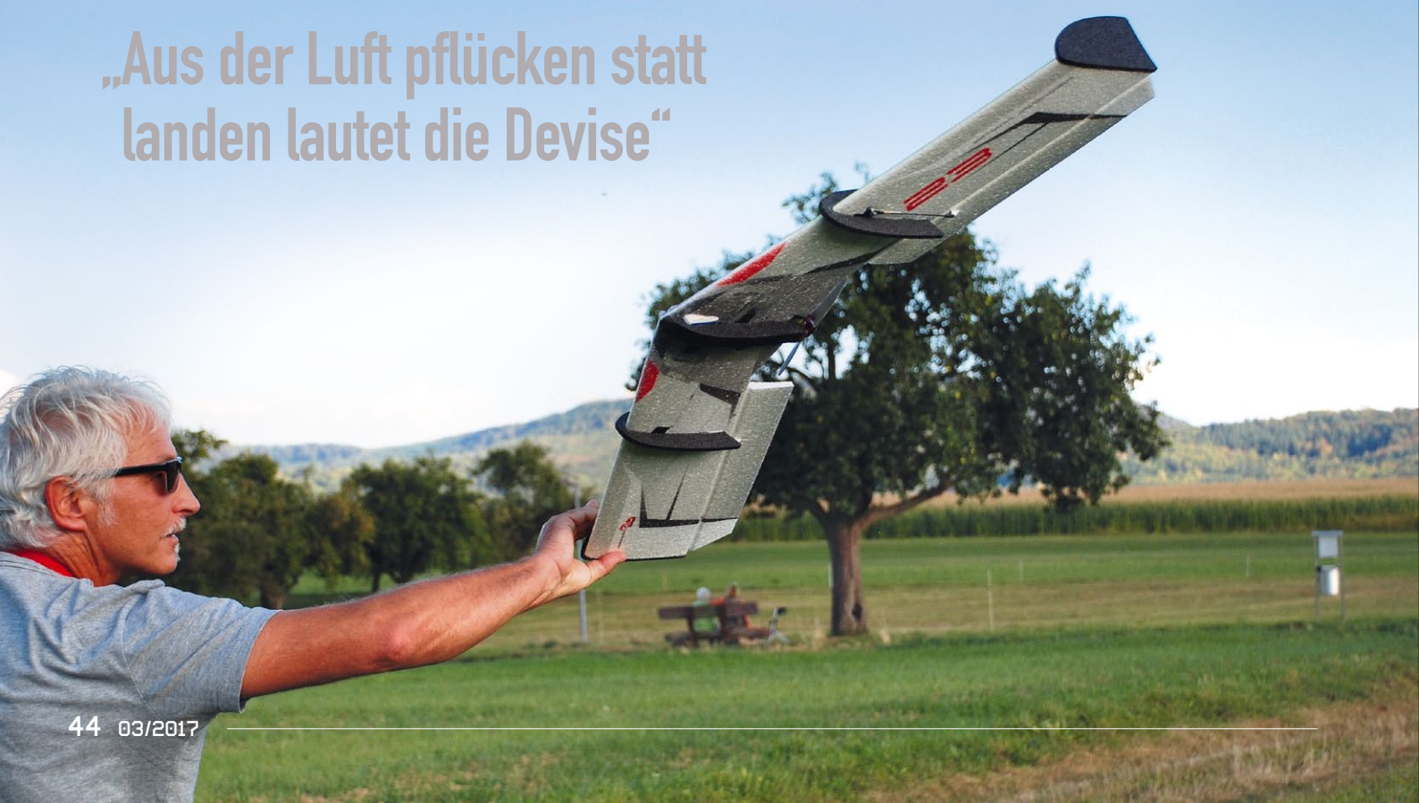
Die Grenzschichtzäune bieten einen optimalen Schutz für die Querrudergestänge und das Servo
