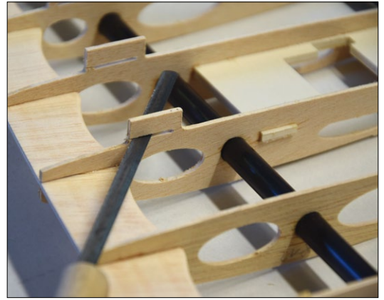
Mit einem feinen Puk-Metallsägeblatt lassen sich die Füßchen einfach und sauber abtrennen
