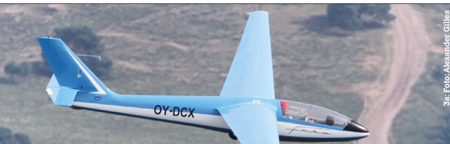
Abbildungen 3a/b: Eine Foka (a) hat trotz des deutlich schmalen Rumpfs eine schlechtere Gleitleistung als eine großvolumige ASW28 (b)
