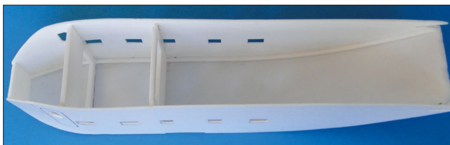
Der Rumpfboden hat Verstärkungen aus Depron-Leisten, ebenso der Rumpfdeckel. Durch die drei Spanten erhält der Rumpf seine Form
