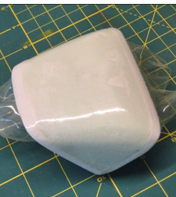
Der verschliffene Klotz bekommt dann noch Aufdopplungen aus Depron angeklebt. Er dient als Form für die Fertigung der Cockpitverglasung, die aus transparenten Schrumpfschlauch besteht
