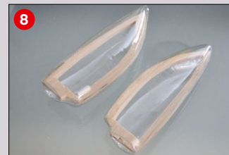
Die beiden Hälften können so einfach zusammengeklebt werden (8)
