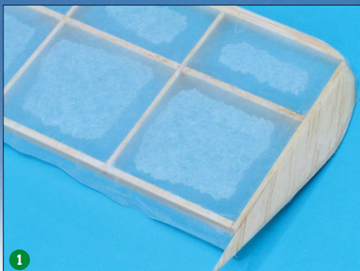
Zum Anfang wird das Rippengerüst mit Kleister eingestrichen und das Papier möglichst faltenfrei aufgelegt. Dann wird von oben noch einmal mit Kleister nachgestrichen (1). Apropos Randbögen. Die untere Bespannung wird bis über den Rand gelegt, bevor die Oberseite bespannt wird (2)
