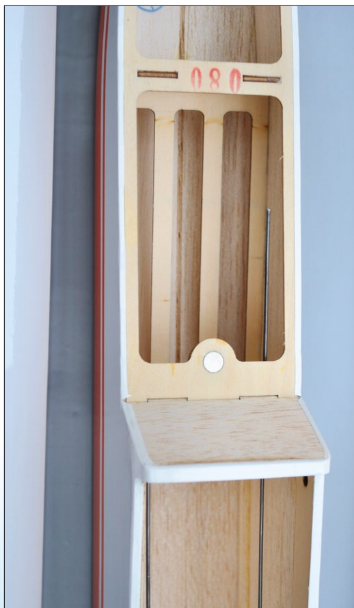
Der offene, leere Rumpf. Die Kabinenhaube wird mittels Magneten gehalten
