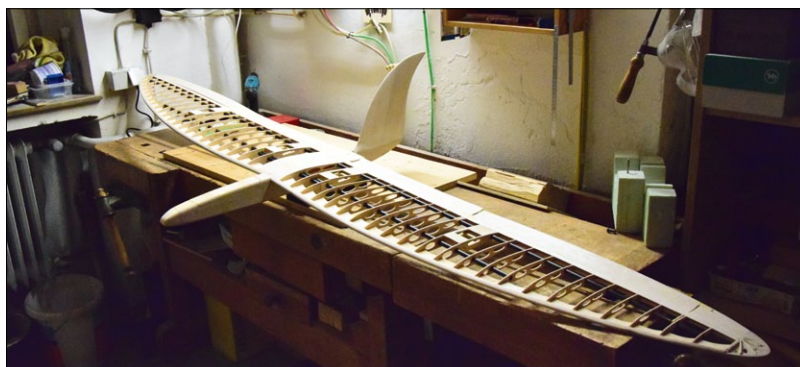
Die fertig beplankte Finne ist mit dem Rumpf verklebt und der Übergang mit Balsa aufgefüllt sowie verschliffen
