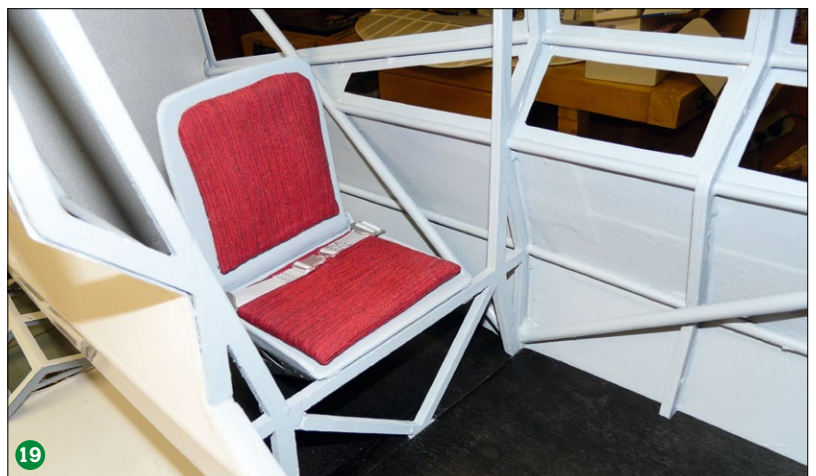
Der Begleitersitz hält vorne über die eingehakten U-Profile und hinten über die im Stuhlgestell eingeklebten Magneten. Gegenlager der Magneten ist ein dünnes, innerhalb des U-Brettchens verklebtes Eisenplättchen. So kann sich der Sitz weder nach hinten, noch nach oben bewegen und bleibt fest in der Position. Will man an die Elektronik unter dem hinteren Bodenbrett gelangen, kann der Begleitersitz relativ leicht aus der Magnetwirkung gehoben und herausgenommen werden
