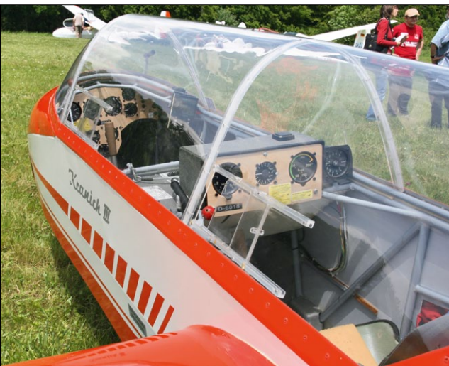
Die Kabinenverglasung ist überwiegend aus abwickelbaren Plexiglasplatten gestaltet
