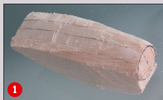
Für die Formen der Motorgondeln werden zwei Balsa-Klötze zusammengeklebt und die Form grob vorgeschnitzt (1)
