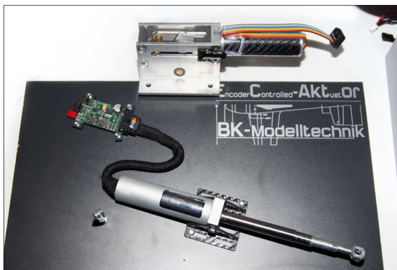
6: Über dem EC-Aktor ist eine von BK-Modelltechnik auf Elektro-Antrieb umgerüstete WABO-Fahrwerksmechanik abgebildet. Mit dem E-Antrieb können nicht nur neue Fahrwerke bestückt, sondern auch bestehende nachgerüstet werden
