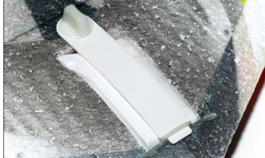
Der Abdeckstreifen fürs Akkufach greift vorne in den Schlitz einer GFK-Platte und wird hinten verschraubt. Der Akku schließt oben bündig ab, wenn man an der auf der Unterseite befindlichen Kufe etwas Material abträgt
