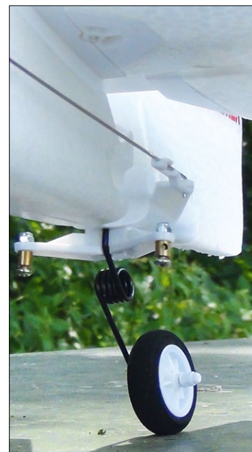
Das Spornrad ist dem Hauptfahrwerk absolut angemessen und natürlich anlenkbar
