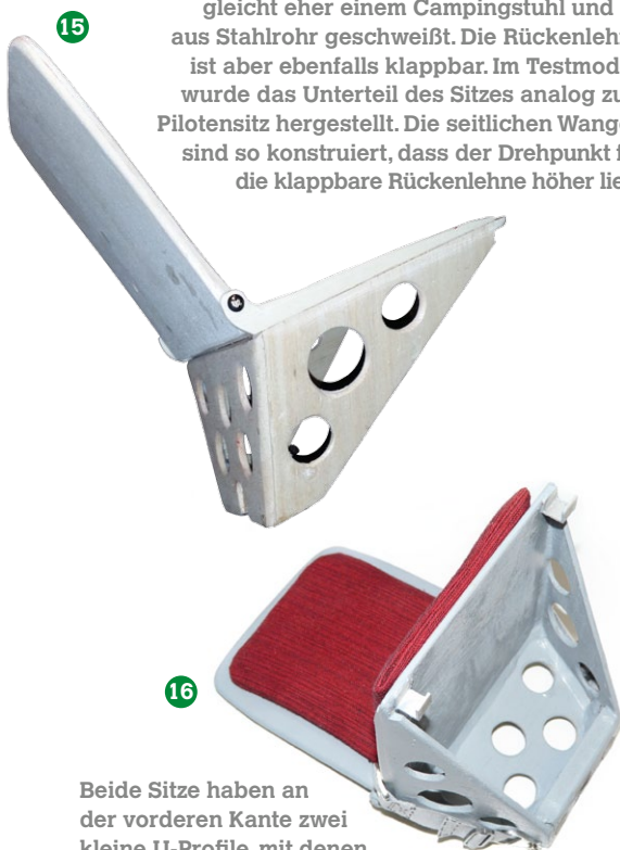
Der Begleitersitz hält vorne über die eingehakten U-Profile und hinten über die im Stuhlgestell eingeklebten Magneten. Gegenlager der Magneten ist ein dünnes, innerhalb des U-Brettchens verklebtes Eisenplättchen. So kann sich der Sitz weder nach hinten, noch nach oben bewegen und bleibt fest in der Position. Will man an die Elektronik unter dem hinteren Bodenbrett gelangen, kann der Begleitersitz relativ leicht aus der Magnetwirkung gehoben und herausgenommen werden
