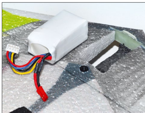
Wer einen Akku mit größeren Abmessungen benutzen möchte, muss dies rechtzeitig beim Anlegen des Akkuschachts berücksichtigen
