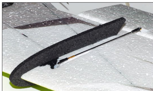
Die Grenzschichtzäune bieten einen optimalen Schutz für die Querrudergestänge und das Servo
