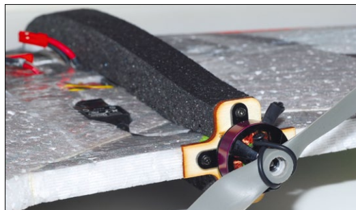
Der Motorspant besteht aus einem 3-Millimeter-Sperrholzkreuz. Ein A-20-Motor von Hacker ist die ideale Antriebswahl
