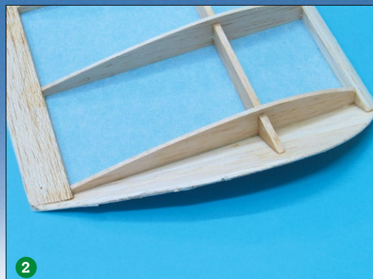
Zum Anfang wird das Rippengerüst mit Kleister eingestrichen und das Papier möglichst faltenfrei aufgelegt. Dann wird von oben noch einmal mit Kleister nachgestrichen (1). Apropos Randbögen. Die untere Bespannung wird bis über den Rand gelegt, bevor die Oberseite bespannt wird (2)
