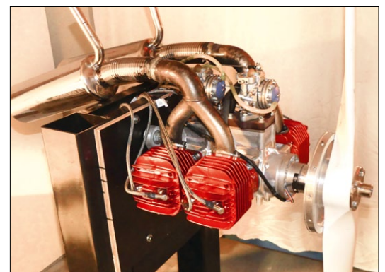
17: 3W-684i B4 TS CS mit zwei Zündkerzen pro Zylinder
