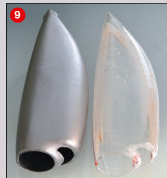
Aus den fertigen Gondeln kann man die Spanten weitgehend wieder entfernen. Nach dem Verspachteln, Schleifen und Lackieren können die Gondeln an den Flügel angebaut werden (9)
