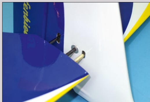
Im Rumpf ist natürlich eine zusätzliche Aussparung in der Seitenrudernflosse notwendig, um die Beweglichkeit der Ruder zu gewährleisten
