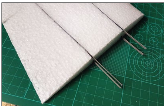
Die überstehenden CFK-Flachprofile sind im kurzen Mittelteil mit CFK-Profilen zu verkleben, auch um die 5 Grad V-Form zu sichern
