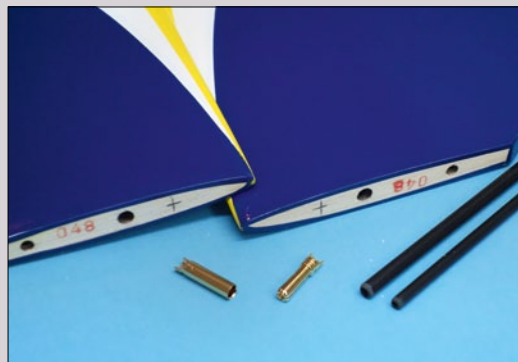
Zur Fixierung der beiden Höhenleitwerkshälften kann zum Beispiel ein 4-Millimeter-Goldkontakt-Stecksystem verwendet werden
