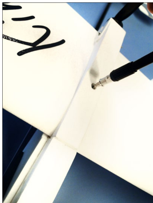
Der Flügel wird von einer zentralen Schraube auf dem Rumpf gehalten
