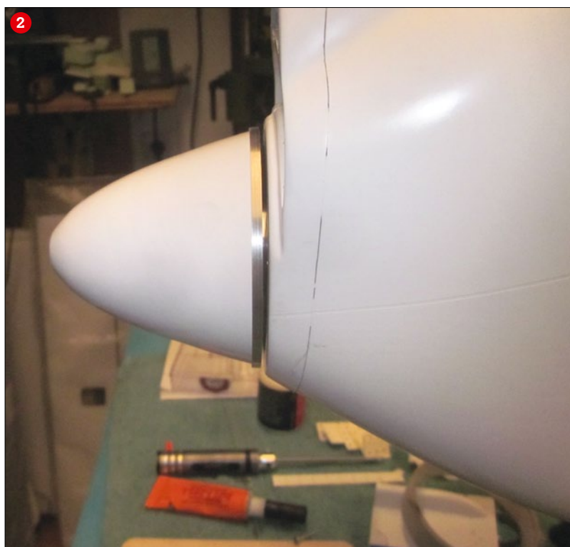
Ideal für die Bronco sind in der Steigung verstellbare Propeller von Ramoser, wie diese mit 19,9 Zoll Durchmesser und 16D-Nabe (1). Mit einem nur geringen Spaltmaß schmiegt sich der Spinner optimal der Haube an (2). Schon im Rohbauzustand ist die Kanzel ein Hingucker (3)
