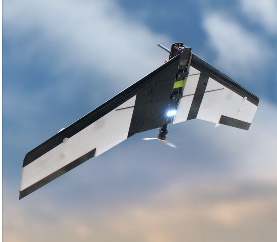
Die Fluglageerkennung ist bei differenter Unterseite sehr gut
