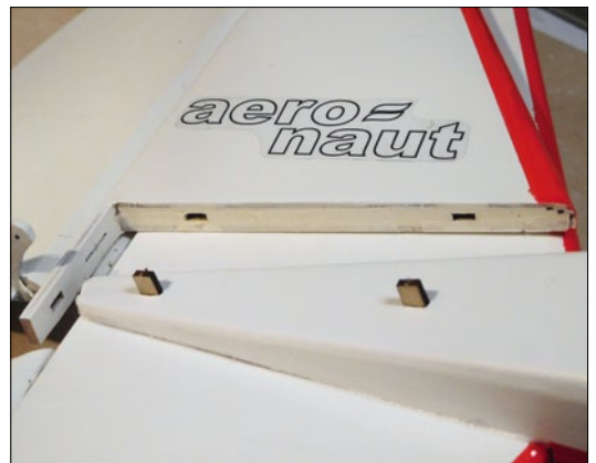
Diese kleinen Sperrholzlaschen sorgen für eine perfekte Zentrierung des Seitenleitwerks
