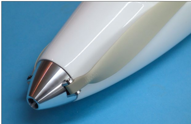
Die Passung des Spinners zum Rumpf ist recht gut, die weiß eingefärbten Luftschrauben machen den eingebauten Antrieb unauffällig
