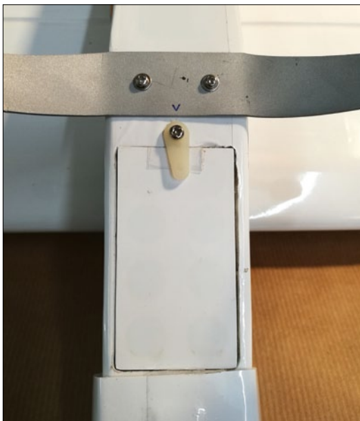
Eine Klappe gewährt Zugang zum Akkuschacht, was den Batteriewechsel erleichtert
