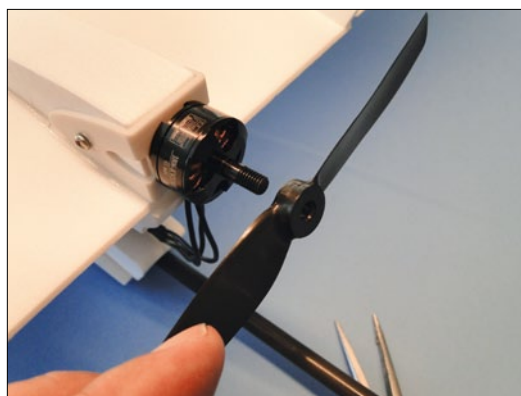
Die Luftschaube wird direkt auf den Motor aufgesetzt
