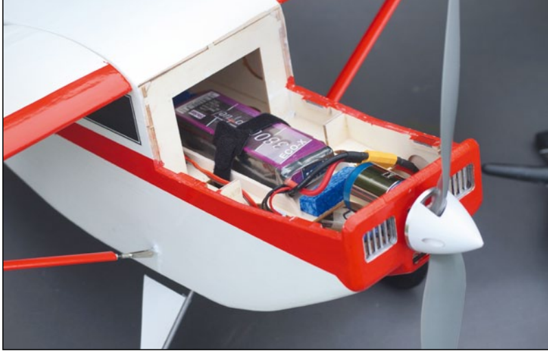
Für den Akku ist reichlich Platz unter der Haube. Praktisch ist seine Position so weit vorne
