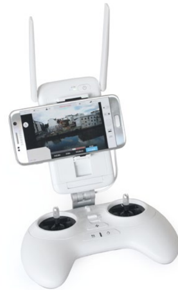
Der Sender und die Base-Station samt verbundenem Smartphone: Beide Geräte werden miteinander gekoppelt. Das ergibt eine recht schwere, kopflastige Sendeanlage
