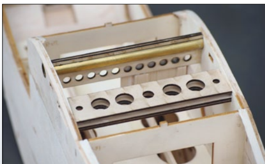
Das Messingrohr dient der Aufnahme der Flächensteckung und die Sperrholzbrettchen sind für die Sicherung der Befestigungslaschen
