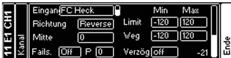
Einstellen von Gas Aus für den Heckmotor in Makrozelle 11
