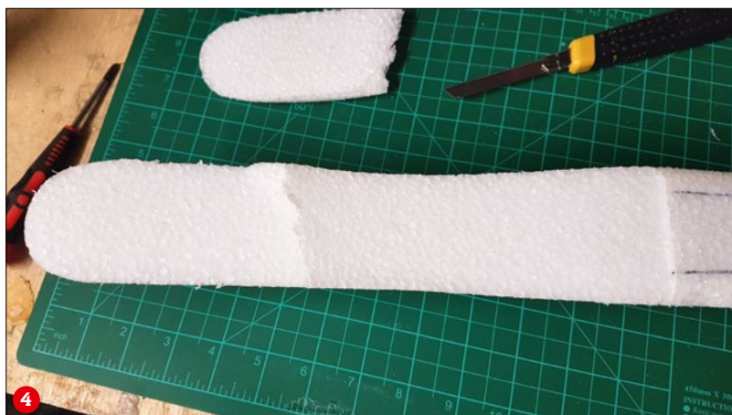
Einbringen der Rumpferstärkungen. Immer nur dosiert Sekundenkleber einbringen (1). Verstärkungen im Heckbereich des Rumpfs verhindern auch ein Verwinden und garantieren guten Geradeausflug (2) Abtrennen des Zugangs zum Rumpfinnenen – das EPP-Teil wird später wieder festgeklebt (3). Freischneiden des Innenbereichs für Akku und Empfänger (4)
