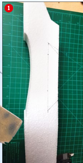
Zugang zum Akku im Rumpffinneren ist über einen Deckel möglich, der zunächst nur angezeichnet wird (1). Verstärken des Seitenleitwerks mit CFK-Flachprofilen (2). Ein Profil versteift die Dämpfungsflosse, das andere das Ruder – dort hilft es auch beim Steuern (3)
