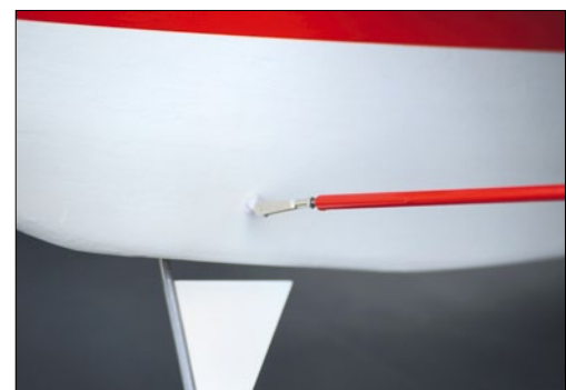
Der Anschluss der Streben am Rumpf erfolgt mit Gabelköpfen
