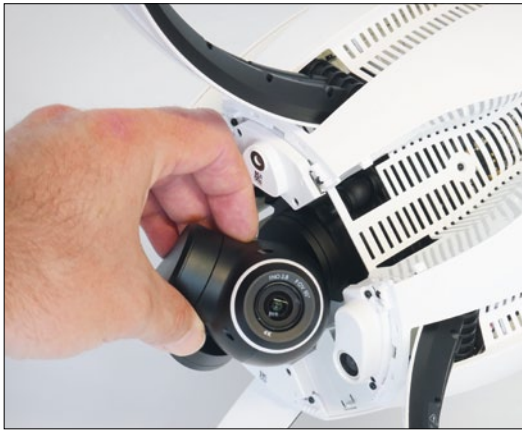
Die verbaute Gimbal-Kamera ist in der Lage mit ihrem 1/2,3-Zoll-CMOS-Sensor Videos in 4K aufzunehmen
