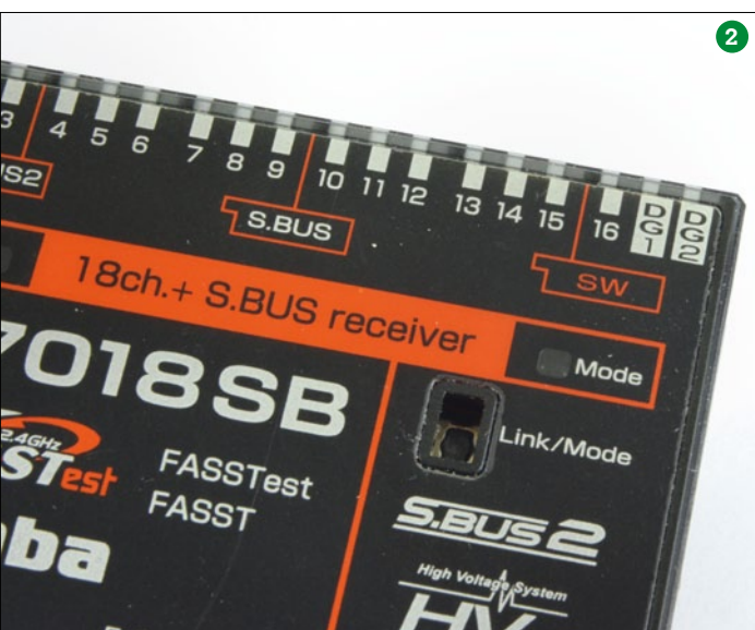
Der 12-CH-Modus, nur für Digitalservos, funktioniert auch mit der T14SG bestens, wie mehrere Flüge mit einer großen Piper Pawnee zeigten (1). Die Schaltkanäle DG1 und DG2 sind extra bezeichnet (2). Funktioniert auch einwandfrei: Sender T14SG im FASSTest 14CH-Modus. Jetzt stehen 12 Prop- und 2 Schaltkanäle zur Verfügung (3)
