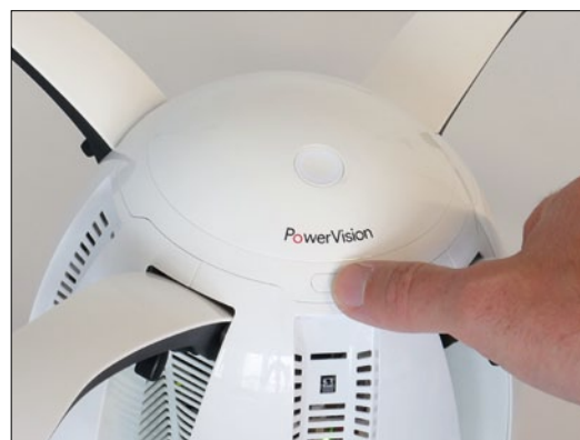
Der Knopf an der Stirnseite der Drohne öffnet die Haube und gewährt Zugang zum Akkuschlacht
