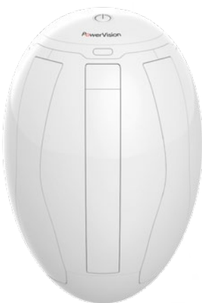
Sind die Ausleger sowie das Landegestell eingeklappt, ist das PowerEgg tatsächlich eiförmig und macht seinem Namen alle Ehre
