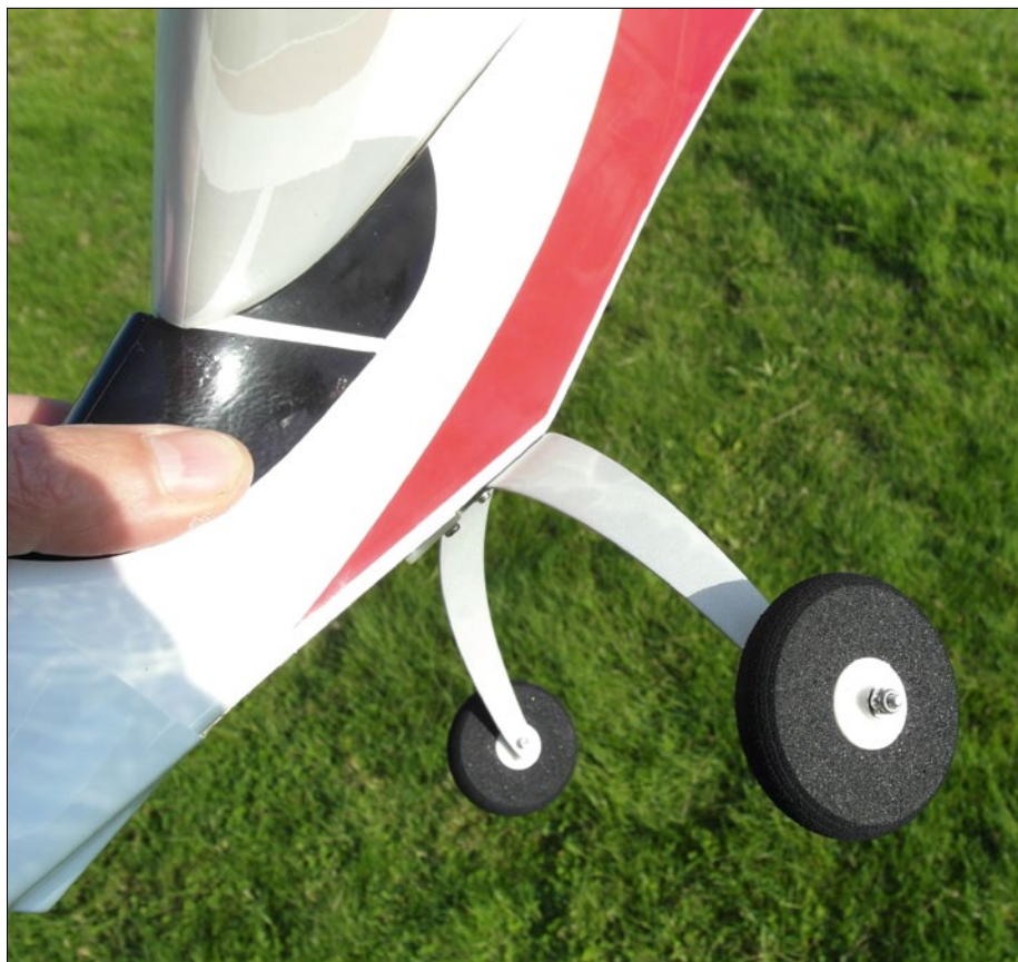
Für Rasenpisten ist das kleine Fahrwerk ungeeignet und überfordert
