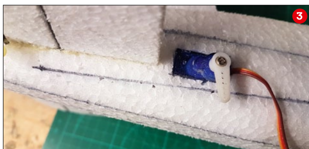
Die Nase ist vorne verstärkt, was vor allem den Akku bei feindlichen Propellerberührungen schützen soll (1). Heraustrennen des Zugangsdeckels. Gezackt bewirkt einen strammen Sitz (2). Die Laschen des Servos sind abgetrennt, um es tief im EPP zu versenken (3). Zunächst erst wieder die Markierungen anbringen, danach schneiden (4). Flächenholm und Verstärkung aus CFK sind eingelassen (5)
