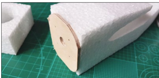
Vor dem Verkleben der Holz-Motorplatte einmal die glasige EPP-Struktur anrauen, damit der Kleber hält
