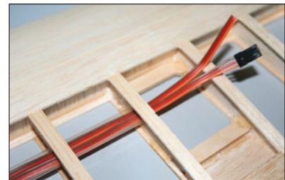
Kabelschacht von Simprop
