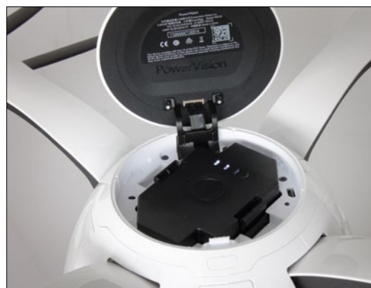
Der Flugakku wird senkrecht in den Schlacht gesteckt und verfügt über eine Füllstandsanzeige mittels LED
