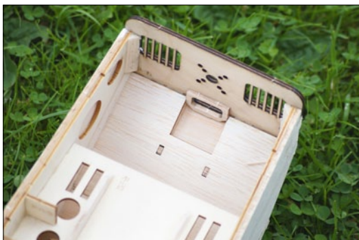
Der Motorspant von innen gesehen. Der zu befestigende Brushless-Motor muss also eine Frontmontage zulassen
