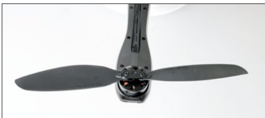
Die Propeller sind ab Werk montiert, klappbar ausgeführt, verfügen allerdings über keinen Schnellverschluss
