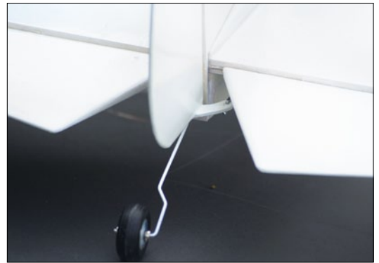
Das Spornrad wird vom Seitenruder mitgenommen. Allerdings ist der Draht relativ weich
