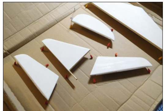
Die Leitwerksteile werden zum Lackieren auf Nadeln gestellt
