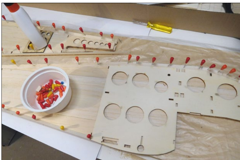
Die Rumpfsseiten werden sowohl vorne als auch hinten von innen verstärkt
