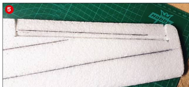
Die Nase ist vorne verstärkt, was vor allem den Akku bei feindlichen Propellerberührungen schützen soll (1). Heraustrennen des Zugangsdeckels. Gezackt bewirkt einen strammen Sitz (2). Die Laschen des Servos sind abgetrennt, um es tief im EPP zu versenken (3). Zunächst erst wieder die Markierungen anbringen, danach schneiden (4). Flächenholm und Verstärkung aus CFK sind eingelassen (5)
