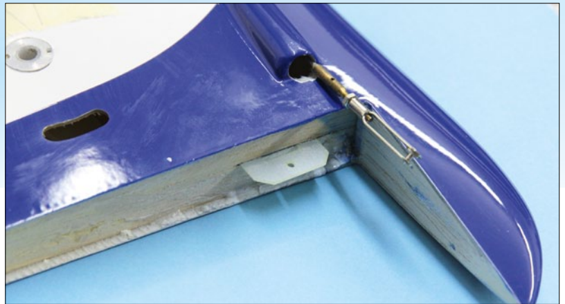
Zur Lagerung des Seitenruders sind Vliesscharniere vorgesehen. Diese werden in die vorbereiteten Schlitze eingesetzt und mit einem Tropfen dünnflüssigem Sekundenkleber fixiert
