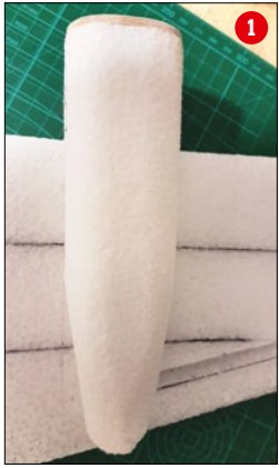
Die Gondel lässt sich durch Schleifen schön anpassen (1). Gut gekühlt sitzen die Regler außerhalb der Gondel (2)
