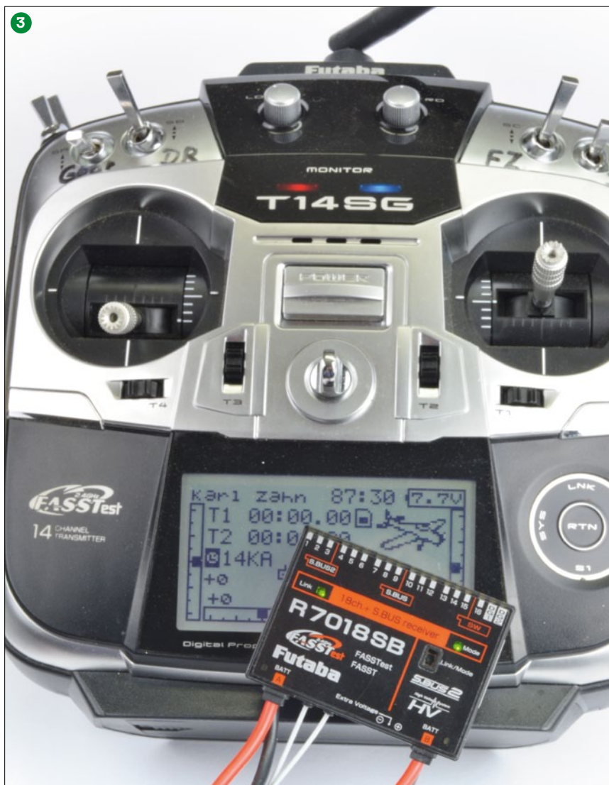
Der 12-CH-Modus, nur für Digitalservos, funktioniert auch mit der T14SG bestens, wie mehrere Flüge mit einer großen Piper Pawnee zeigten (1). Die Schaltkanäle DG1 und DG2 sind extra bezeichnet (2). Funktioniert auch einwandfrei: Sender T14SG im FASSTest 14CH-Modus. Jetzt stehen 12 Prop- und 2 Schaltkanäle zur Verfügung (3)
