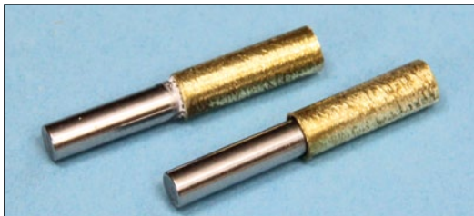
Die Torsionsstifte bekamen einen Überzug aus Messingrohr, da die Bohrungen in den Anschlussrippen zu groß geraten waren
