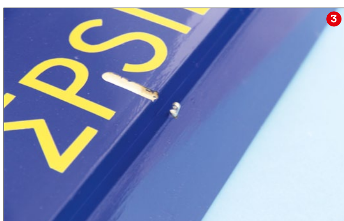
Die Wölbklappen sind unten an der Tragfläche angeschlagen. Konsequenterweise erfolgt dann deren Ansteuerung auf der Oberseite. Die Augschraube und Durchbrüche sind dafür bereits vorbereitet (3). Wölbklappenanlenkung mittels M2,5-Gabelkopf und -Gewindestange aus dem eigenen Fundus. Das hält besser als die beiliegenden Komponenten (4)
