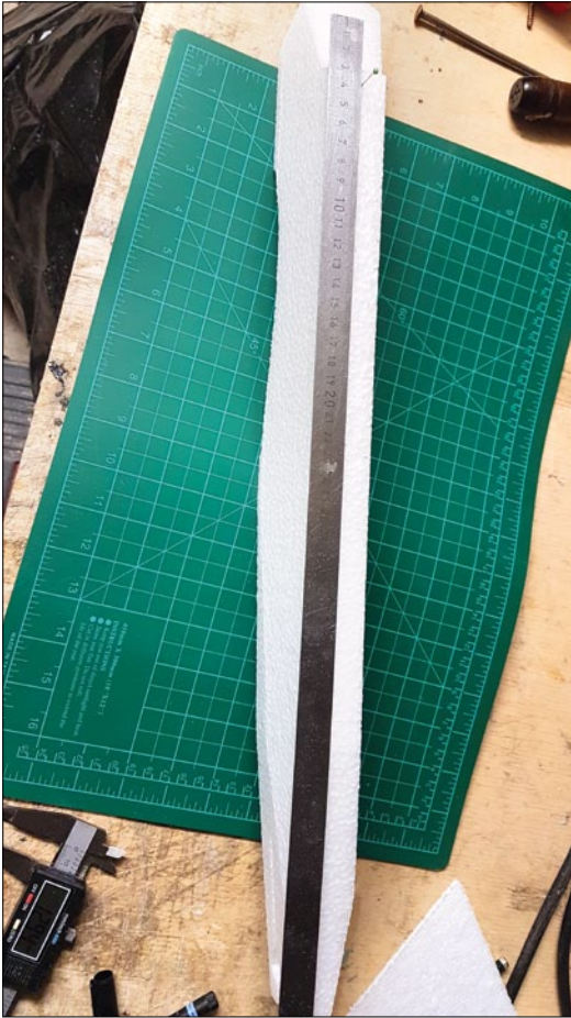
Markieren der Linien für die CFK-Streben zum Versteifen des Rumpfs
