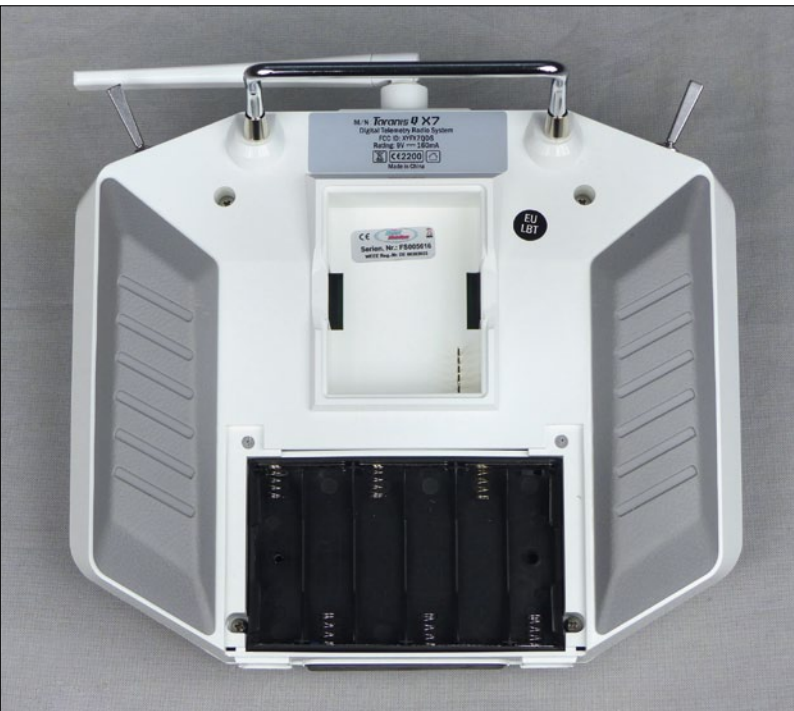
Ab Werk kommt die Q X7 mit einem Halter für Mignon-Batterien. Das hätte man besser lösen können
