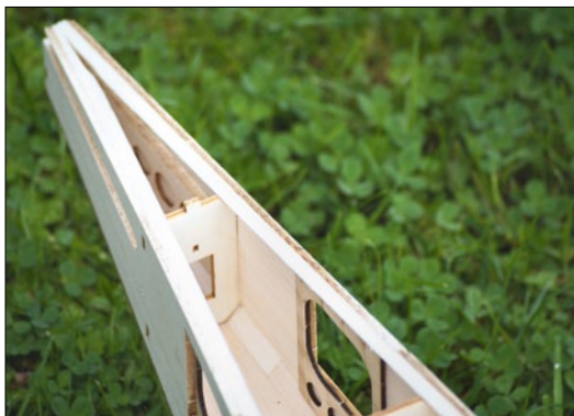
Das Heck von innen zeigt die Verstärkung für die Aufnahme des Servos
