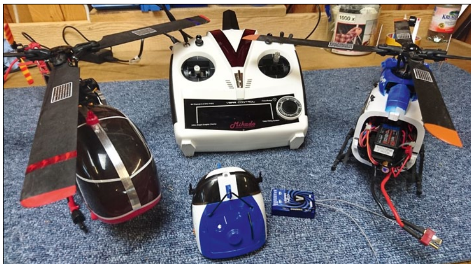
Platzmäßig sind die Verhältnisse in beiden Helis bescheiden. Eingestellt wird der NEO über die VBar Control
