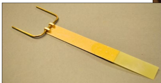
Um die Klappen des Bugfahrwerks ohne weitere Servos zu öffnen und schließen, wurde eine spezielle Mimik verbaut, die die Klappen über Federn und ein Drahtgestell aufschiebt und zuzieht. Das erfordert zwar einiges an Anpassungsarbeiten, funktioniert aber ressourcenschonend
