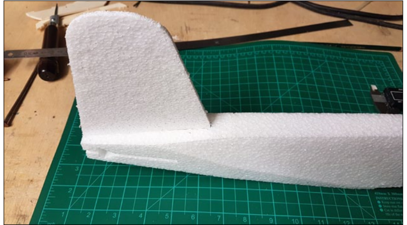
Einpassen des Seitenleitwerks – anschließend ist das Höhenleitwerk zu positionieren
