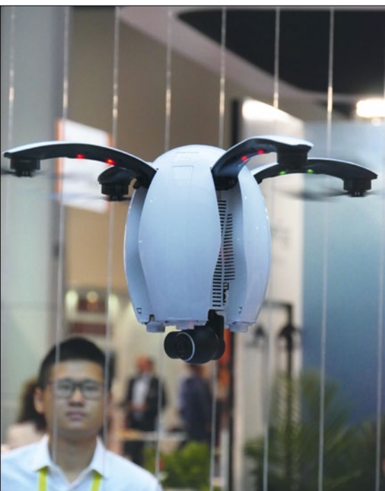
Bei deaktivierter GPS-Funktion eignet sich das PowerEgg auch dazu, in Innenräumen geflogen zu werden
