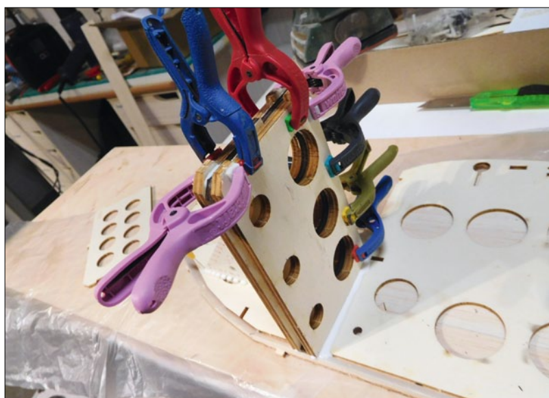
Der Fahrwerksspannt wird aus mehreren Lagen Sperrholz verklebt
