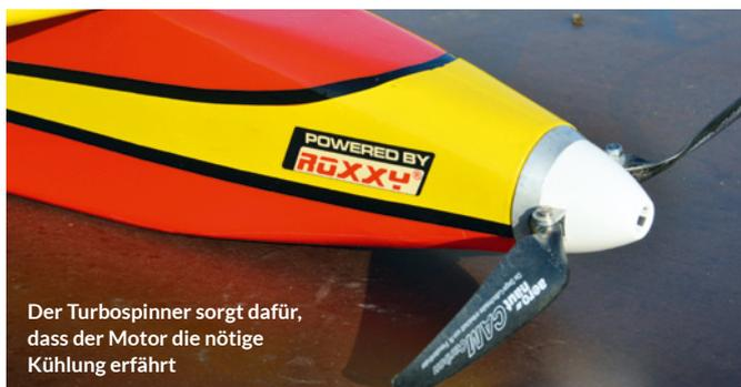
Der Turbospinner sorgt dafür, dass der Motor die nötige Kühlung erfährt
