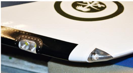
Exakt zum Konturverlauf passende Glasabdeckungen entstanden durch selbst hergestellte Tiefziehteile
