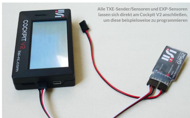
Alle TXE-Sender/Sensoren und EXP-Sensoren lassen sich direkt am Cockpit V2 anschließen, um diese beispielsweise zu programmieren
