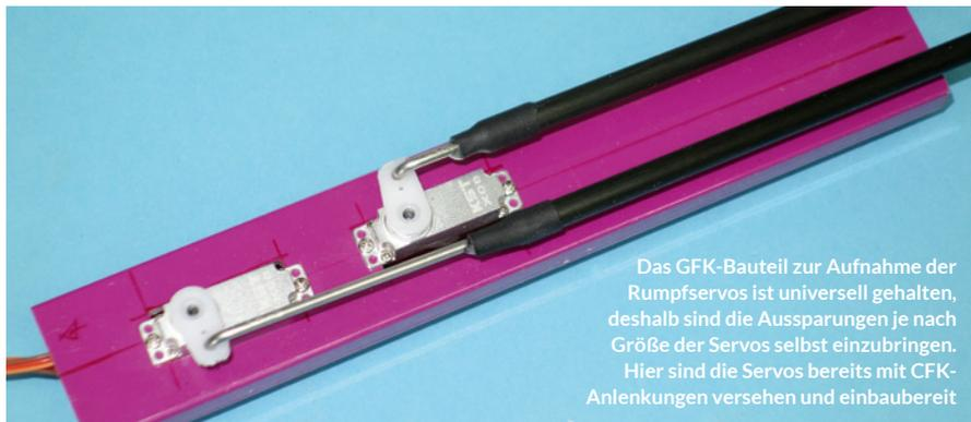
Das GFK-Bauteil zur Aufnahme der Rumpfservos ist universell gehalten, deshalb sind die Aussparungen je nach Größe der Servos selbst einzubringen. Hier sind die Servos bereits mit CFK-Anlenkungen versehen und einbaubereit
