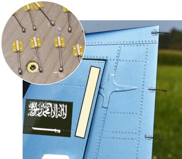
Die Anti-Statik-Ableiter an den Rudern prägen die Optik des Modells. Sie entstanden aus dünnen GFK-Plättchen, Nietenaufklebern, Litzendraht und Bowdenzugseelen
