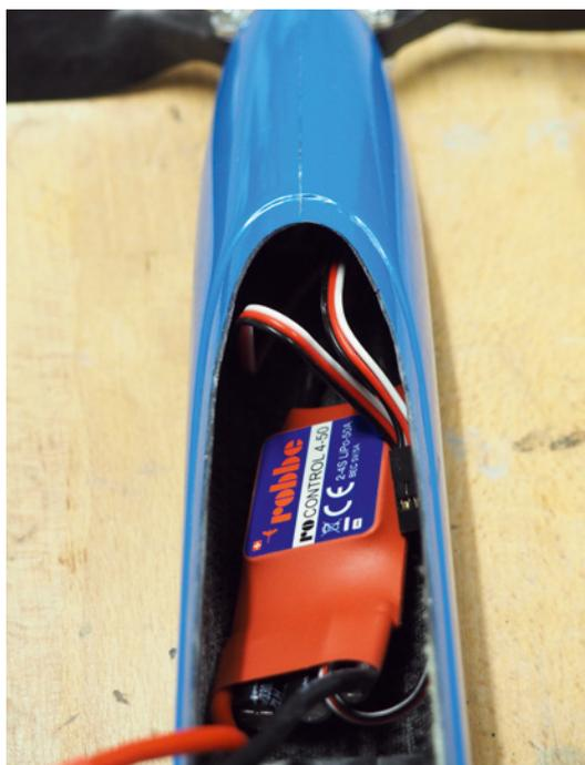
Ein gängiger Brushless-Regler mit 5-Ampere-BEC und einer maximalen Belastbarkeit von 50 Ampere bei 2s- bis 4s-LiPos reicht völlig aus
