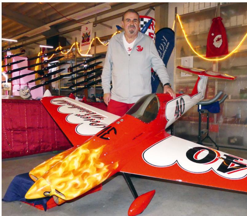
Dass 3W auch Flugmodelle im Programm hat, ist bekannt. Der hier gezeigte Modellnachbau des US-Air Racers T-Rivets ist Peter Weinholds private Maschine. Bei entsprechendem Interesse würde er auch das Modell als Bausatz produzieren. Daten: Spannweite 2.640 mm, ideal für den Einbau eines 3W-140i B4 (Vierzylinder), Gewicht zwischen 15 und 16 kg
