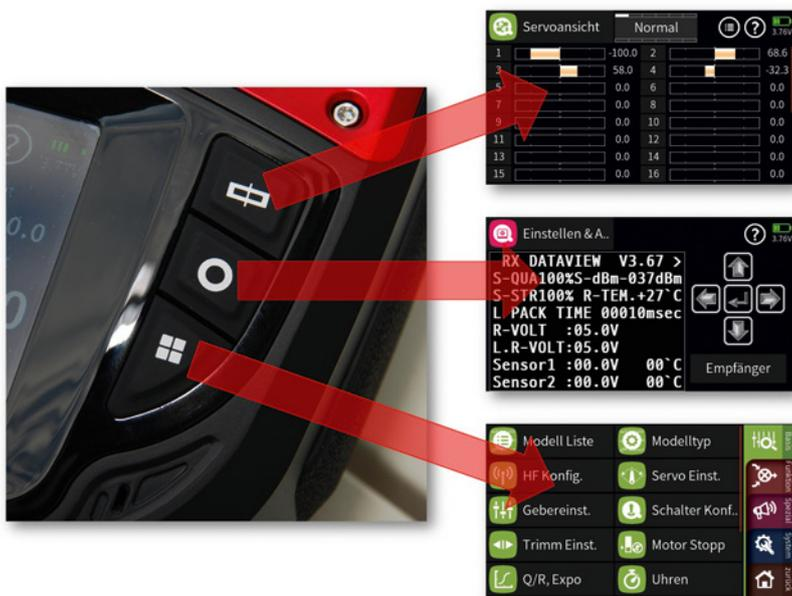
Die Tasten rechts vom Display bieten eine wertvolle Hilfe bei der Bedienung, indem sie direkten Zugriff auf die wichtigen Funktionen Servomonitor, Telemetriedaten anzeigen und einstellen sowie Aufruf des Softwaremenüs ermöglichen
