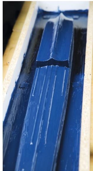
Das Urmodell ist mit Feinschicht bestrichen und für den Laminataufbau bereit
