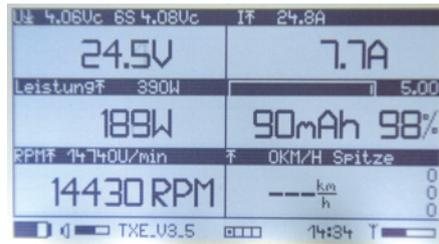
Im Betrieb lassen sich aktuelle Daten auf dem Display anzeigen. Unter anderem der reale Wert für die entnommene Kapazität und damit die voraussichtlich verbleibende Restkapazität in Prozent
