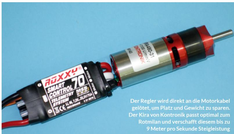
Der Regler wird direkt an die Motorkabel gelötet, um Platz und Gewicht zu sparen. Der Kira von Kontronik passt optimal zum Rotmilan und verschafft diesem bis zu 9 Meter pro Sekunde Steigleistung
