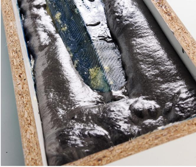
Mit zunehmender Quelldauer umschließt der Quikset Pro-Schaum die Negativform und macht sie zur stabilen Einheit bei extrem geringem Gewicht
