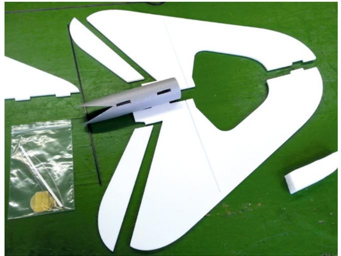
Die Anzahl der Einzelteile ist überschaubar. Alles lässt sich leicht selber herstellen. Hier abgebildet sind allerdings die Teile des Causemann-Bausatzes.
