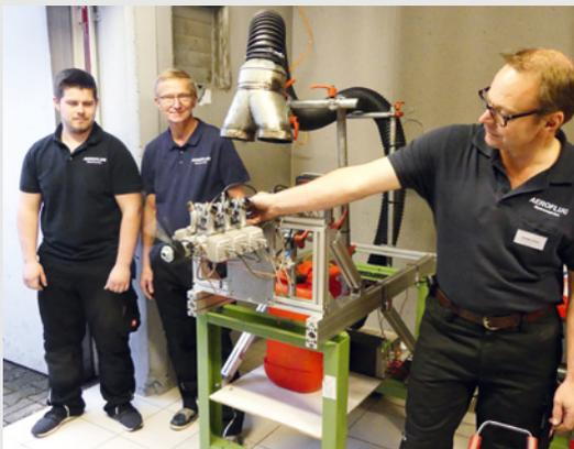
Ein wirkliches Sahnestück ist der brandneue und seidenweich laufende 3W-Sechszylinder-Zweitakter mit 168 cm<sup>3</sup>, den die Besucher mehrfach in Aktion erleben konnten. Das verantwortliche Vorfühpersonal an beiden Testständen stellte der Motoren-Instandsetzungsbetrieb Aeroflug in Hanau: Mike Zaun, Inhaber Thomas Schmidt und Steffen Zaun (von links). Zudem hatte Aeroflug auch einen Beratungsstand in der Ausstellung
