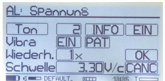
Die Programmierung von Sender-Modulen erfolgt direkt über das Cockpit V2. Hier wird die Sprachansage in Bezug auf erfasste Telemetriewerte des TXE200 eingestellt. Möglich ist die individuelle Vorgabe von Schwellenwerten für Alarme und wie diese signalisiert werden sollen
