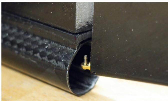
Das Seitenleitwerk ist auf am Rumpf befestigte Carbonstäbe aufgesteckt. Hier sind lediglich Anlenkungsdraht und Ruderhorn zu verbinden
