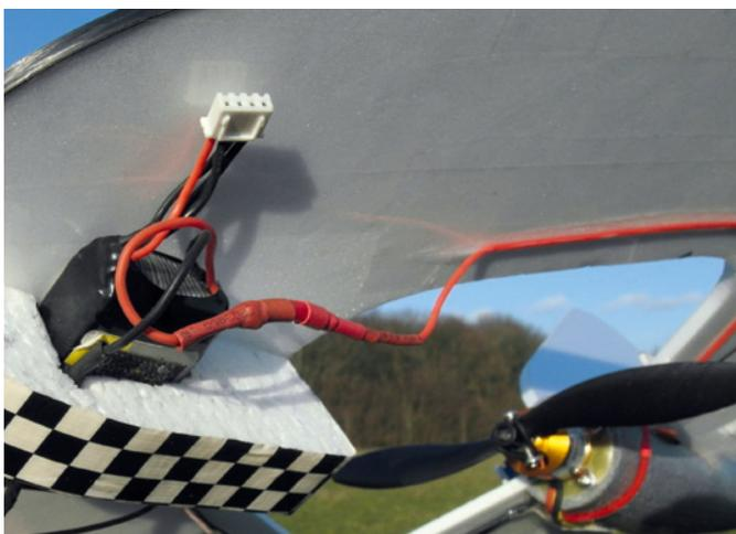
Die Kabel zwischen Regler und Akku müssen konstruktionsbedingt verlängert werden
