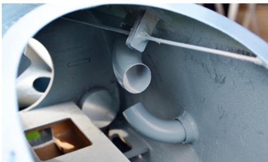
Kühlende Luft von außen zuführen, warme Luft aus dem Rumpfinneren ausleiten und natürlich Luft für die Turbine selbst zur Verfügung stellen, ist besonders beim Turboprop-Modell von Bedeutung. Hier kamen Krumscheid-Rohre zum Einsatz
