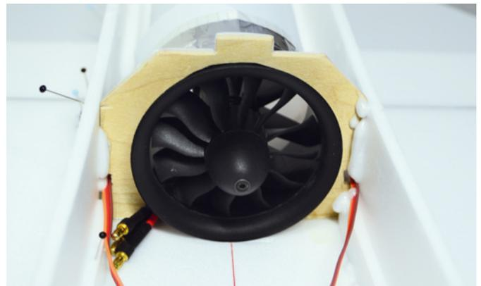
Der Chagesun-Impeller wird mit Sperrholzspanten im Rumpf befestigt. Die vorgeschlagene Depron-Variante erschien mir zu labil
