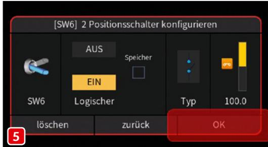
Um einem Bedienelement eine Ankündigung mittels Sprachausgabe zuzuordnen, wird zunächst über das Softwaremenü festgelegt, um welches Bedienelement es geht. In diesem Fall soll beim Umlegen des SW6 nach oben die Meldung Motor an ertönen, weil mit dieser Schalterbewegung die Motorstopp-Funktion deaktiviert und der Elektromotor somit scharf geschaltet wird
