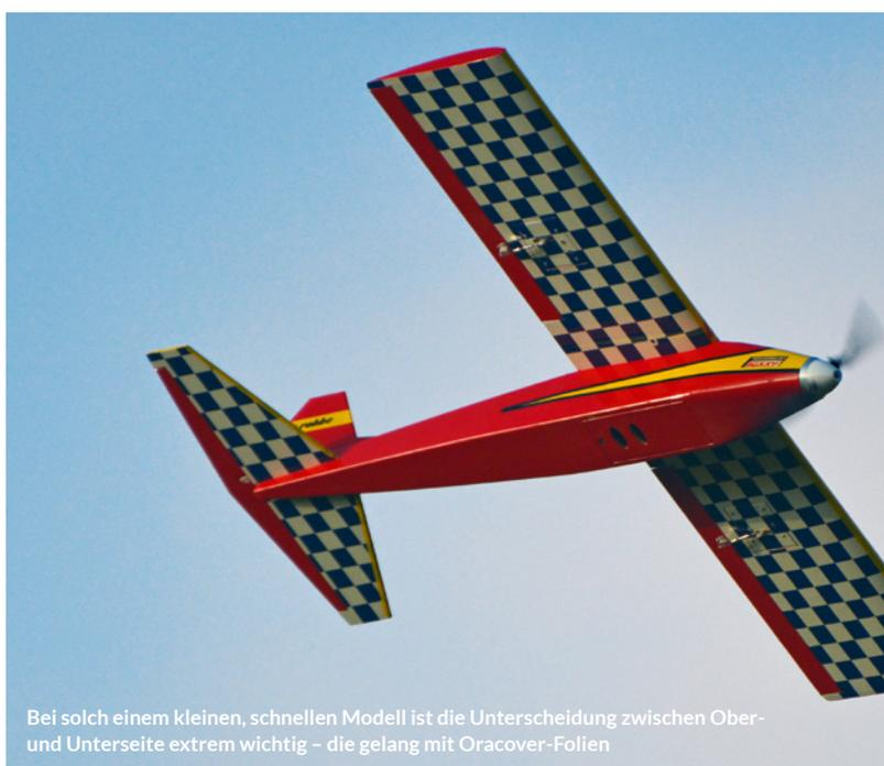
Bei solch einem kleinen, schnellen Modell ist die Unterscheidung zwischen Ober- und Unterseite extrem wichtig – die gelang mit Oracover-Folien
