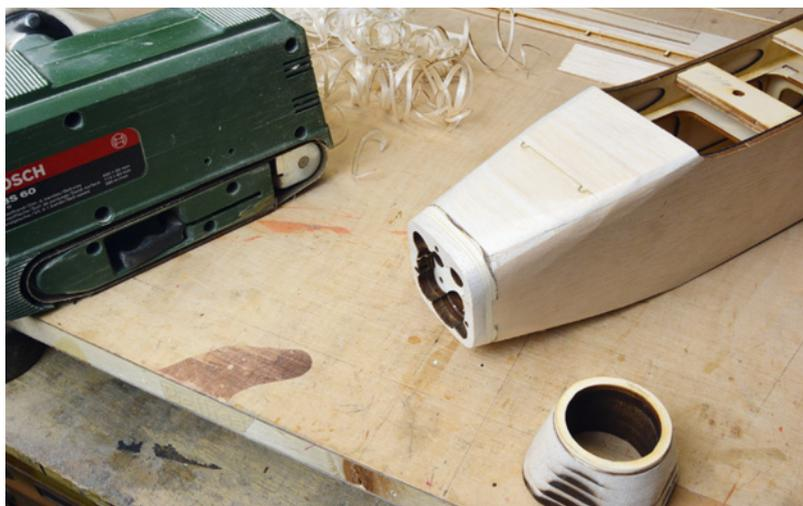
Das Rumpfvorderteil samt Motorhaube lässt sich am einfachsten mit einem Bandschleifer bearbeiten
