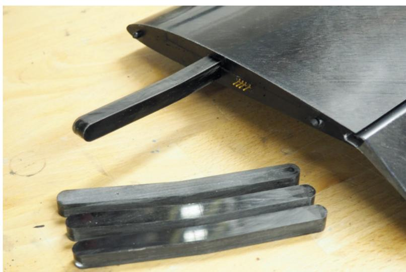
Je zwei CFK-Flächenverbinder im 5- oder 7-Grad-Winkel liegen bei. Die schwimmende Lagerung wird mit einem Streifen Tesa ergänzt. Ab Werk eingebaut ist die Kontaktsteckung für das jeweilige Querruderrervo
