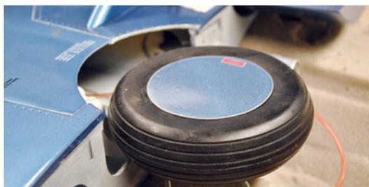
Die Räder sind wie das Original mit einer Abdeckkappe versehen – statt einer kompletten Fahrwerksschachtabdeckung
