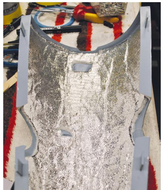
Unter der Cowling ist ein Hitzeschild zum Schutz des GFKs angeklebt
