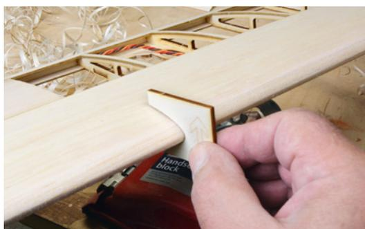
Mit Hobel und Schleifpapier wird die Nasenleiste so lange bearbeitet, bis die Schablone passt
