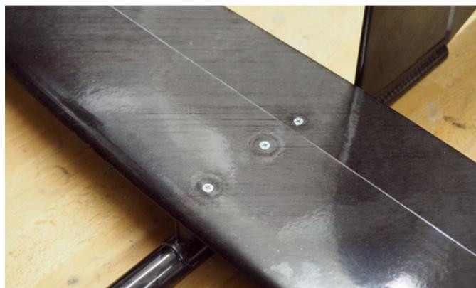
Auf einem Pylon liegend und mit M3-Schrauben fixiert das Höhenleitwerk. Das Ruder ist von unten über einen ebenfalls lösbaren Anlenkhebel angeschlossen
