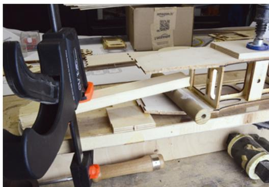
Die angefeuchteten vorderen Rumpfteile werden mit Hilfe einer „speziellen Biegevorrichtung“ in Form gebracht
