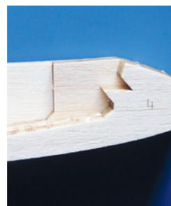
In die vorgesehene Aussparung in der Nase greift später eine Zunge unter der Kabinenhaube und arretiert diese dann sicher
