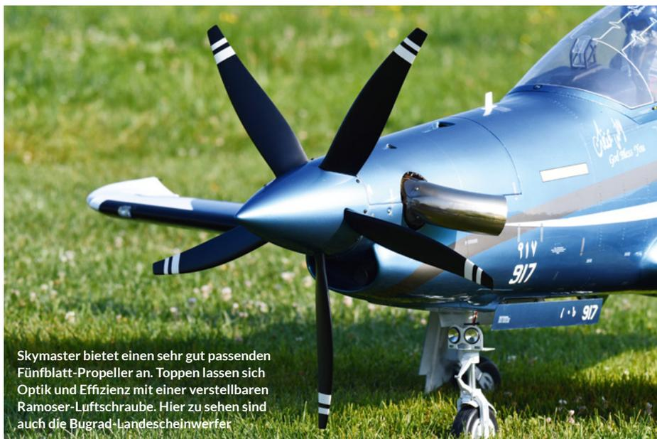
Skymaster bietet einen sehr gut passenden Fünfblatt-Propeller an. Toppen lassen sich Optik und Effizienz mit einer verstellbaren Ramoser-Luftschraube. Hier zu sehen sind auch die Bugrad-Landescheinwerfer
