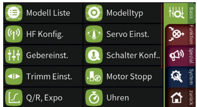
Wie an den Registern am rechten Rand zu erkennen ist, sind alle zur Verfügung stehenden Funktionen in die bekannten vier Hauptbereiche Basis (hier zu sehen), Funktion, Spezial und System unterteilt. Die etwas unscheinbare rote Linie zeigt an, dass beim Blättern beziehungsweise Wischen nach unten noch weitere Menüpunkte zur Verfügung stehen
