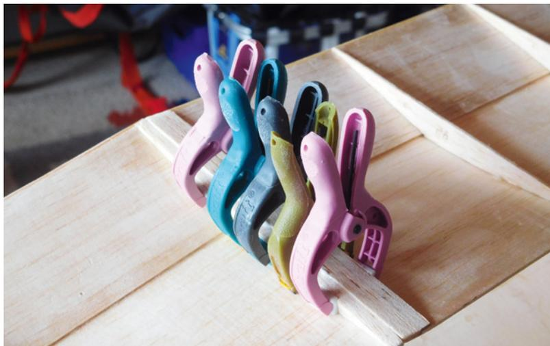
Die Verbindung von Mittelflügel und Außenflügel wird beim Verkleben mit Klammern gehalten
