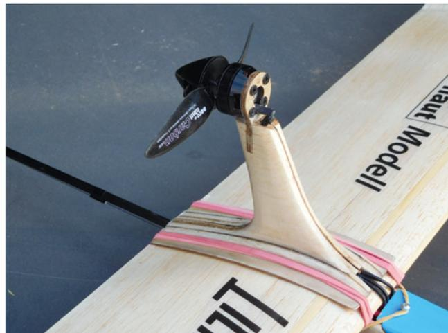
Der formschön geschliffene Motorpylon wird von den starken Gummibändern gehalten – das reicht hier völlig aus
