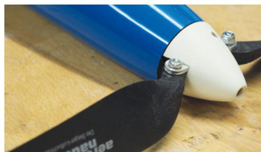
Beim Prototyp ist noch ein Plastikspinner verbaut, dem PNP-Modell liegt einer aus Alu bei. In der Rumpfnase ist ein F5J-optimierter Brushless-Motor von Axi eingebaut
