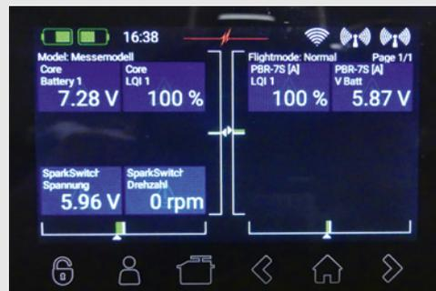
Das Display des CORE zeigt z. B. links unten die vom telemetrie-fähigen Zündschalter (SparkSwitch Pro) gemessenen Werte des Zündakkus und der Motordrehzahl an. Einen ersten Testbericht zum Sender veröffentlichten wir in Modell AVIATOR 02/2019
