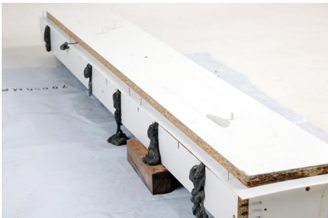
Schaum einfüllen, mit einer ABS-Platte abdecken und beschweren - so schäumt das Volumen sauber aus
