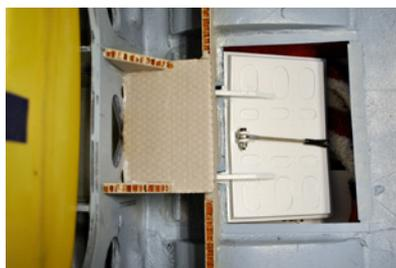
Wesentliches Merkmal der PC-21 ist die Bremsklappe, die auch beim Model realisiert werden sollte. Hier wurde das aus dem Rumpf geschnittene GFK-Teil mit Balsa und GFK aufgefüttert sowie lackiert, um es vorbildgetreuer zu machen
