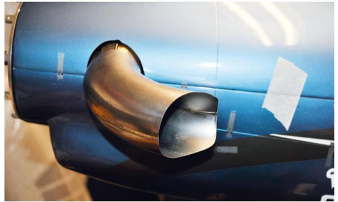
Typisch für eine Turboprop ist das vordere Auslassrohr für den heißen Abgasstrahl. Hier kamen weiche von Zimmermann zum Einsatz
