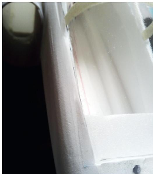
Die tiefgezogene Klarsichthaube ist dem Konturverlauf der Cockpiteinlage exakt anzupassen. Das bedeutet aber auch, Übergänge mit Deproneinlagen individuell anzufertigen
