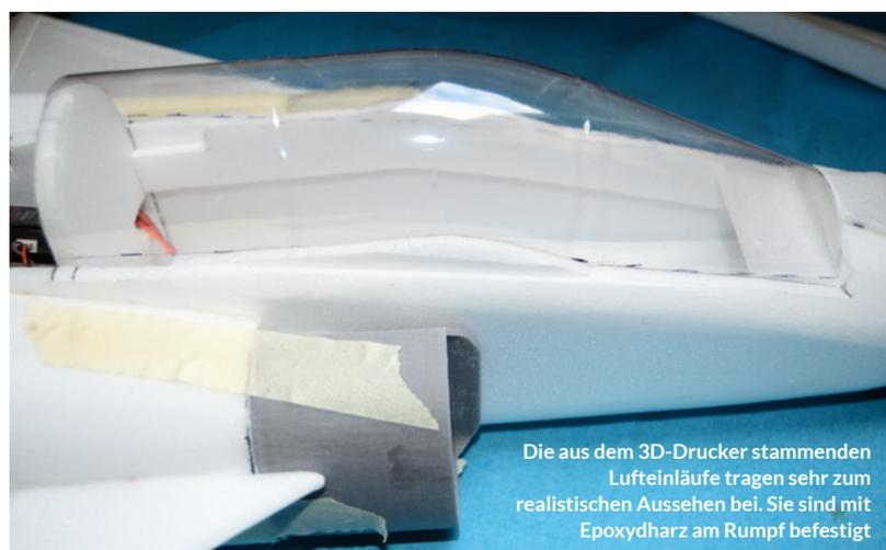
Die aus dem 3D-Drucker stammenden Lufteinläufe tragen sehr zum realistischen Aussehen bei. Sie sind mit Epoxydharz am Rumpf befestigt
