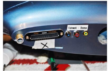
Klassische Multiplex-Stecker für Stromverbindungen sollte man ebenso wenig verwenden wie Sub-D-Stecker, sondern besser gleich modellbauspezifische Komponenten wie diese von Emcotec
