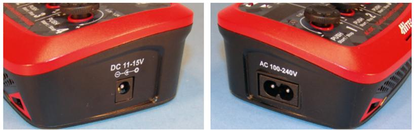
Sowohl der 100/240-Volt-Netzbetrieb als auch ein Gleichspannungsanschluss, zum Beispiel für einen 12-Volt-Bleiakku oder 3s-LiPo, sind möglich
