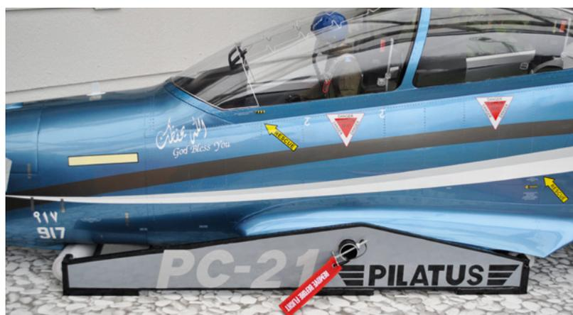
Sowohl zur sicheren Lagerung als auch zum Transport dient das selbst gebaute Rumpf-Tragegestell, das über die Steckung sicher arretiert ist
