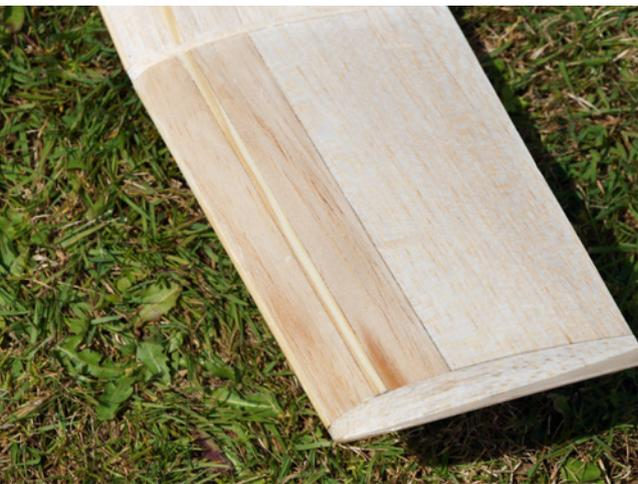
Auf der Flügeloberseite ist ein Kiefernholm eingelassen, der in einer ab Werk eingefrästen Nut Platz findet
