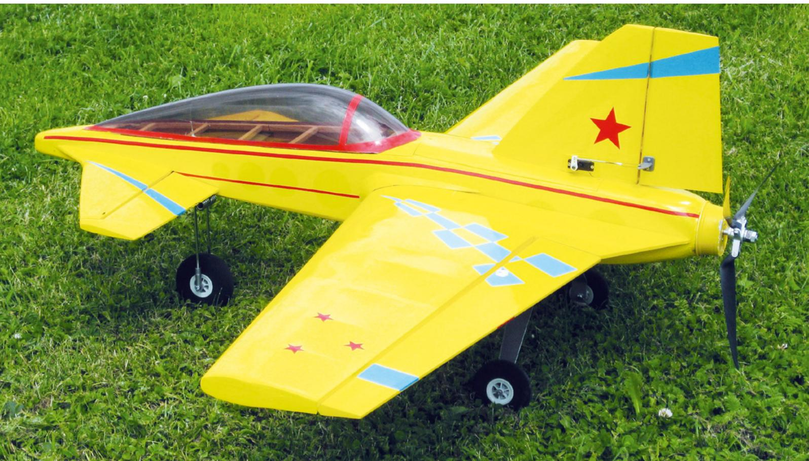
Im Grunde genügt zum aerodynamischen Fliegen eine Tragfläche und tatsächlich ist so die Anatomie der meisten modernen Vögel auch ausgeprägt. Doch die Erfahrung zeigt, dass ein Flügel alleine entweder ineffizient ist oder aber aerodynamisch instabil fliegt, das heißt, er hält sich nicht von alleine im optimalen Anstellwinkel. Um das Stabilitätsproblem zu lösen, ersann man das Höhenleitwerk. Zumeist ist es dem Strömungsverlauf folgend hinter der Tragfläche angeordnet, aber nicht immer.
