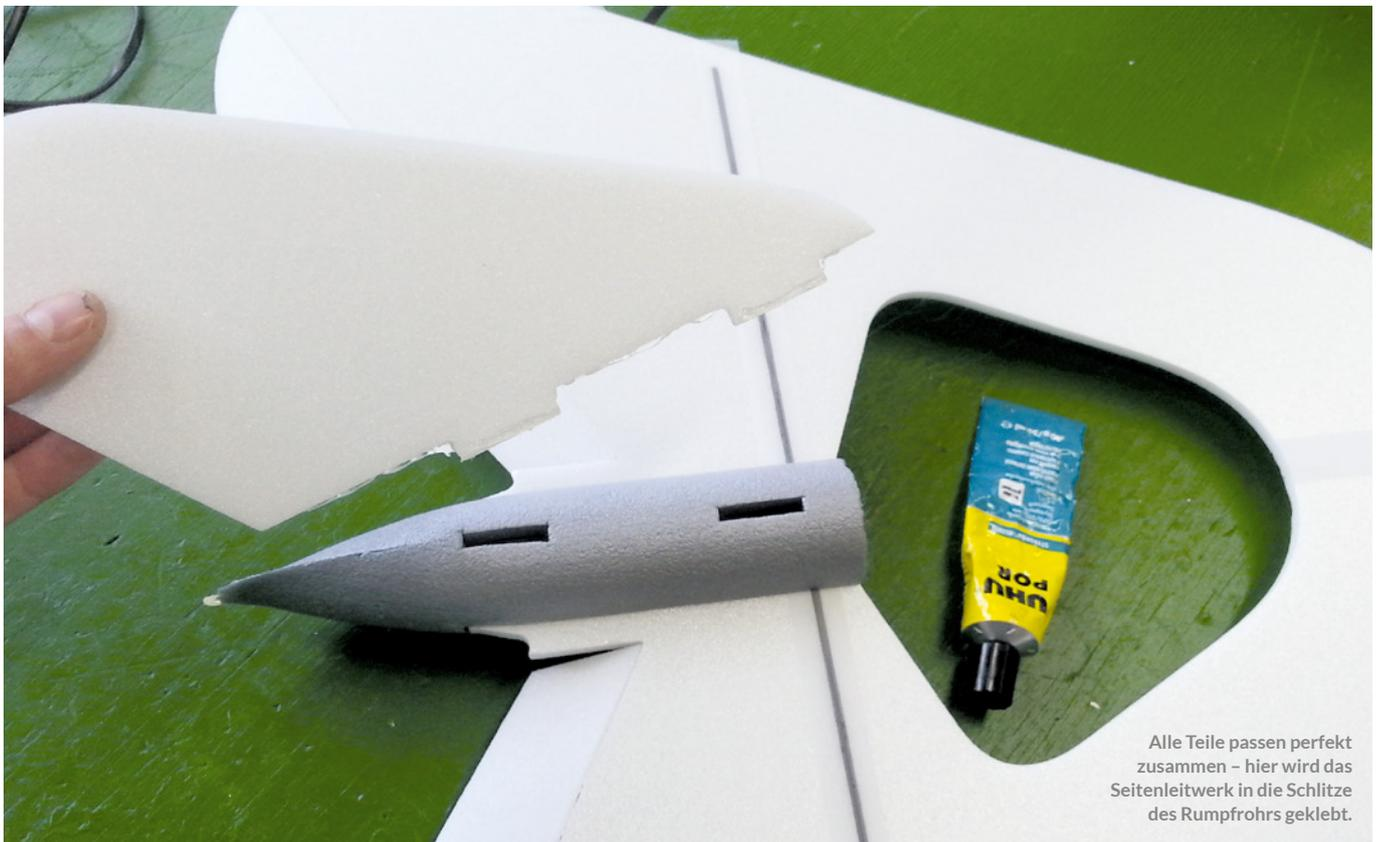
Alle Teile passen perfekt zusammen – hier wird das Seitenleitwerk in die Schlitz des Rumpfrohrs geklebt.
