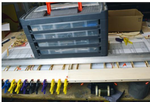
Vor dem Verkleben der vorderen Beplankung werden die Stützfüße der Rippen mit Hilfe einer Richtschiene und Gewichten, hier in Form des Werkzeugkastens, auf das Baubrett gedrückt
