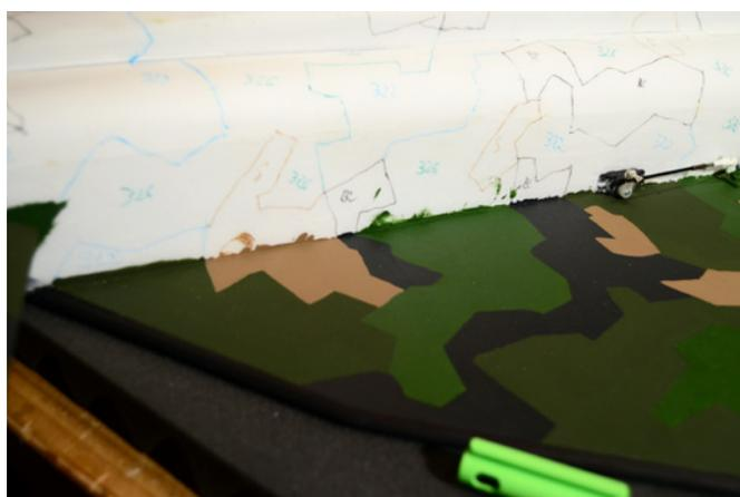
Erst im nächsten Schritt folgt die Lackierung des Rumpfs. Das garantiert passende Übergänge bei manueller Lackierung
