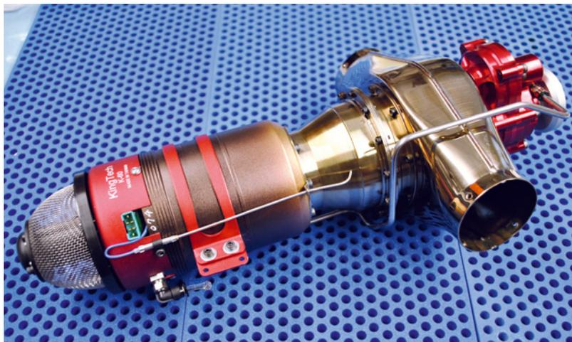
Erhältlich ist das KingTech K60-TP Turboprop-Triebwerk beispielsweise über den Importeur JMB ([www.kingtechturbine.lu](http://www.kingtechturbine.lu)). Sie leistet 7,3 Kilowatt und ist perfekt für die PC-21 geeignet
