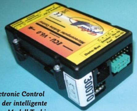
Die Electronic Control Unit ist der intelligente Teil einer Modell-Turbine
