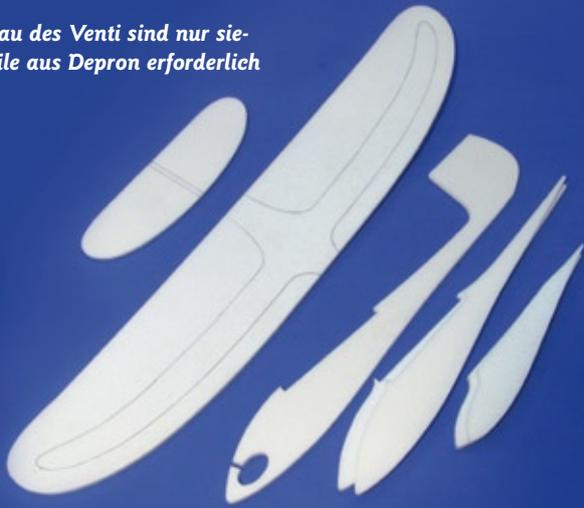
festes Papier – zirka 120 Gramm pro Quadratmeter – dann können Sie die Einzelteile mit der Schere oder dem Cuttermesser ausschneiden und so oft Sie wollen als Schablone verwenden. Das Depron hingegen schneidet man mit einem frischen, superscharfen Abbrechklingenmesser, wobei als Schneidunterlage 6-mm-Depron ein guter Rat ist. Damit bleibt die Klinge lange scharf und die Bauteile werden optimal und ohne hässliches Ausreißen durchtrennt.
