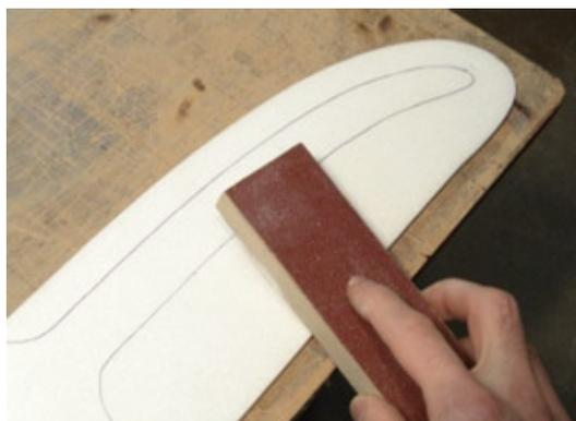
*Zum profilgebenden Schleifen im Nasenbereich eignet sich der Schleifschwamm besser als die Schleiflatte*
