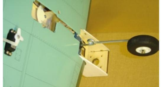
**Der Fahrwerksdraht darf sich bei Einziehfahrwerken nicht deformieren, sonst kann das Fahrwerk nicht korrekt einfahren**
