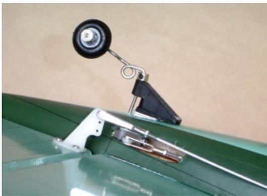
**Direkt angelenktes Spornrad ohne Dämpfungselement am Heck. Hier wird das Servo hoch belastet**
