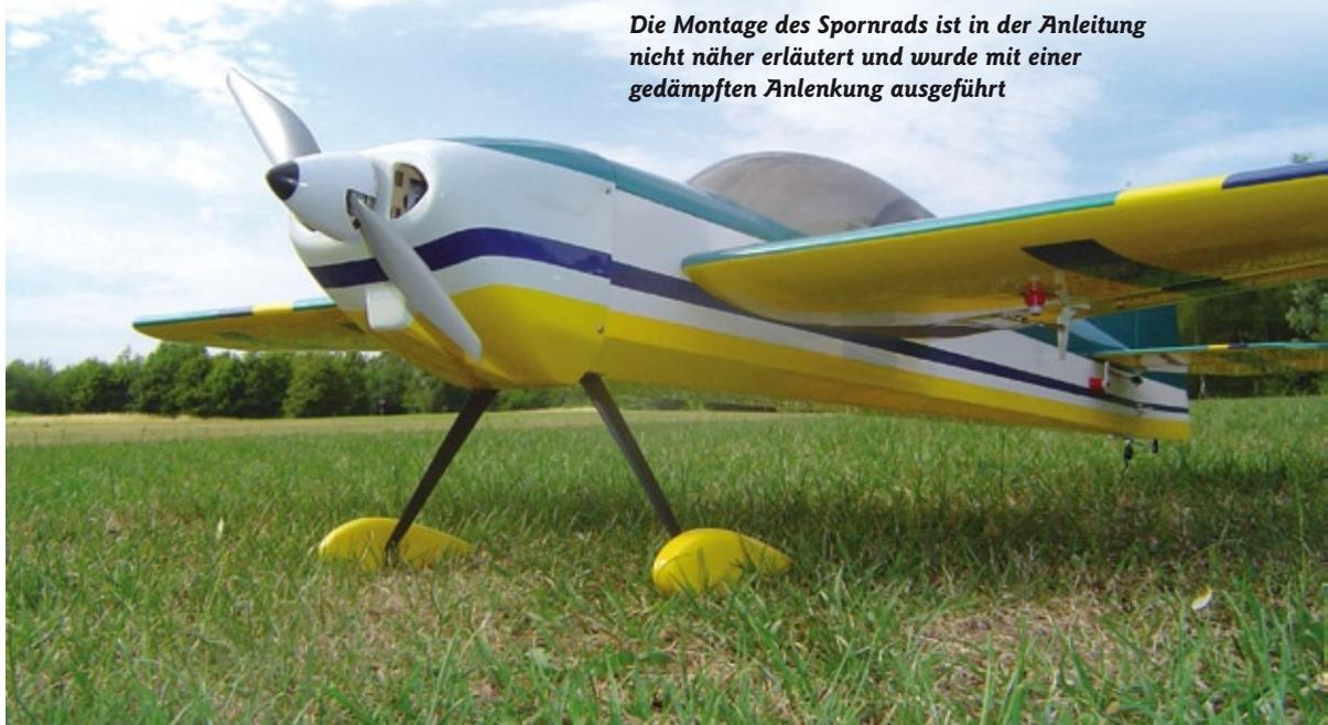
eine Möglichkeit zur Fixierung zu sein. Sie werden unterhalb der Radachsen eingesetzt und pressen die Puschen, von einer Schraube gesichert, gegen das Kohlefaser-Fahrwerksbein.
