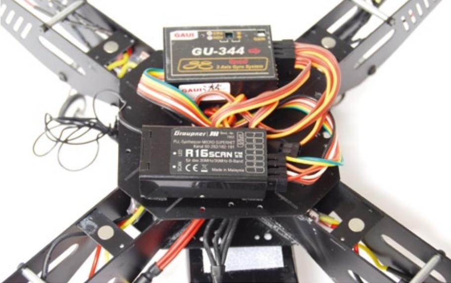
flusst. Der Quadrocopter wiegt ohne Akku etwa 400 Gramm, das maximale Fluggewicht ist in der Bedienungsanleitung mit 1.100 Gramm angegeben, wodurch man zu ganz ordentlichen 700 Gramm Zuladung kommt. Als Stromspender empfiehlt sich ein 3s-LiPo ab 2.000 Milliamperestunden Kapazität.
