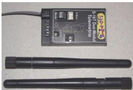
**Auch ACT bietet Telemetriesysteme an. Grundlegender Vorteil des S3D-Systems sind die zwei Antennen – sowohl beim Empfänger als auch im Sender**
