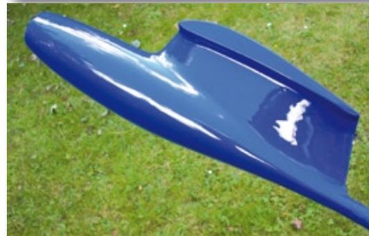
**Sägen, hobeln, kleben, spachteln – in mehreren Etappen entsteht das Urmodell für die Rumpfkeule. Diese wird abschließend Hochglanz-lackiert, mit Trennmittel bearbeitet und ist dann zum Abformen bereit**
