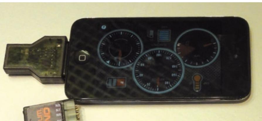
**Unabhängigkeit von Laptop und Senderdisplay bietet die Telemetrie-iPhone-Lösung von Spektrum**
