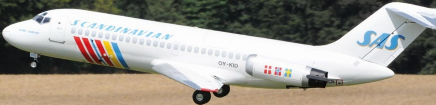
ren die Vorflügel in der Start- und Landephase nach vorne und die Landeklappen nach hinten aus. Die Verwölbung der Fläche ermöglicht einen langsameren An- und natürlich Vorbeiflug. Das sieht nicht nur vorbildgetreu aus, sondern ist modellbauerisch eine kaum angemessen zu würdige Leistung.
