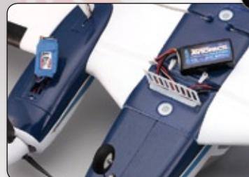
Die beiden Brushless-Motoren werden jeweils durch einen separaten BL-Regler angesteuert. Die beiden Regler sind über ein V-Kabel miteinander verbunden. In der Rumpfmittle wird der 7,4V / 800mAh Avionics Akku in das Modell eingesetzt.
