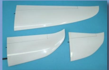
Die drei Flächenaußenohren für 3.390, 3.630 und 3.950 Millimeter Spannweite machen den Orca4x universell einsetzbar. Befestigt werden die Ohren mit einem Streifen Klebeband
