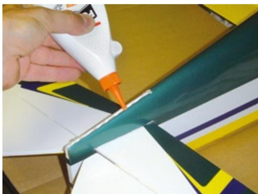
**Anstelle des Sekundenklebers wird für die Befestigung des Seitenleitwerks Weißbleim verwendet**
