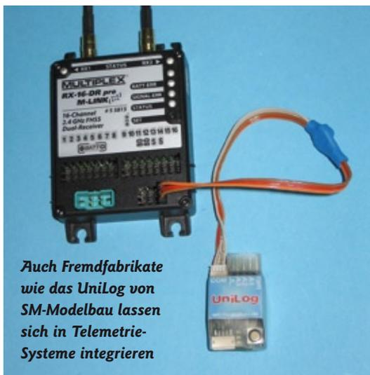
**Auch Fremdfabrikate wie das UniLog von SM-Modellbau lassen sich in Telemetrie-Systeme integrieren**
