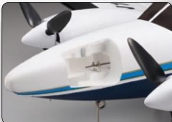
Die Rumpfnase verfügt über einen großzügig dimensionierten Ausschnitt, um das Bugfahrwerk und das Anlenkgestänge im Modell zu montieren.
