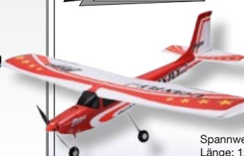
Das Modell wird komplett vormontiert in Schaumbauweise incl. Brushless-Motor + Regler + 5 Servos ausgeliefert.
