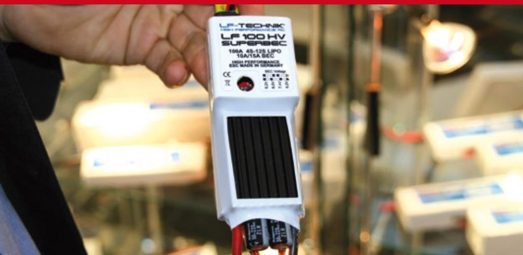
Die Besonderheit des neuen LF 100 HV Superbec ist der Governor-Store-Mode, bei dem die zuvor eingestellte Drehzahl abgespeichert wird und trotz halbvoll angestecktem Akku wieder abgerufen wird. So liegt immer die gleiche Drehzahl vor. Auch das BEC ist mit 10 Ampere Dauer belastbar und lässt sich im Hinblick auf die neuen Hochvolt-Servos auf 8,2 Volt einstellen. Der Preis: 359,99 Euro.
