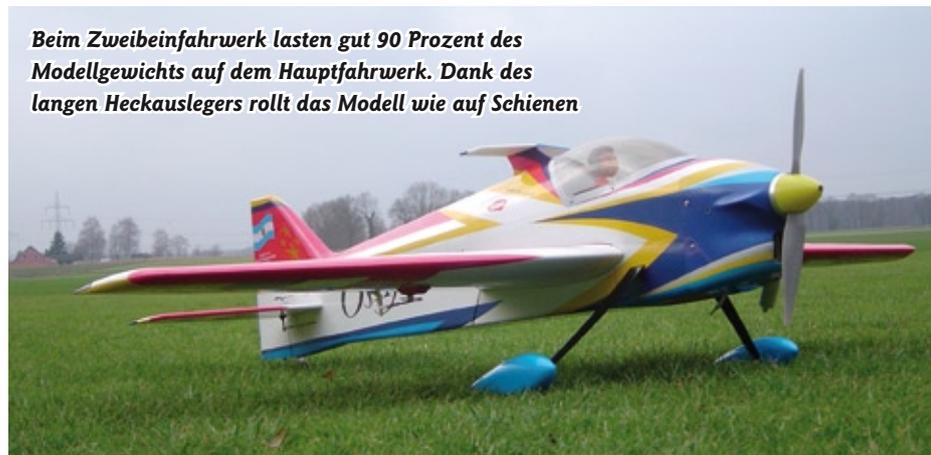
*Beim Zweibeinfahrwerk lasten gut 90 Prozent des Modellgewichts auf dem Hauptfahrwerk. Dank des langen Heckauslegers rollt das Modell wie auf Schienen*
