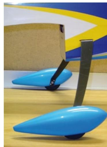
*Hauptfahrwerk eines modernen Kunstflugmodells mit kleinen Rädern und strömungsgünstigen Radschuhen*
