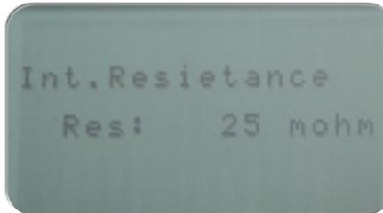
*Der Innenwiderstand einer Zelle lässt sich mit dem Multimeter einfach messen*
