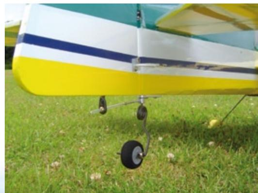
**Die Montage des Spornrads ist in der Anleitung nicht näher erläutert und wurde mit einer gedämpften Anlenkung ausgeführt**
