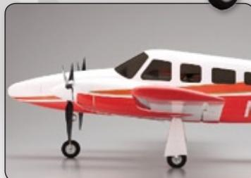
Die Tragfläche verfügt über eingebaute Aufnahmen, in die die beiden Hauptfahrwerke eingeschoben werden. Die Räder und Fahrwerksklappen sitzen bereits fertig an den Fahrwerksdrähten.
