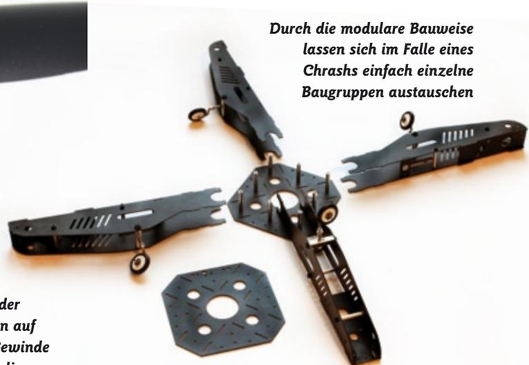
**Durch die modulare Bauweise lassen sich im Falle eines Crashes einfach einzelne Baugruppen austauschen**
