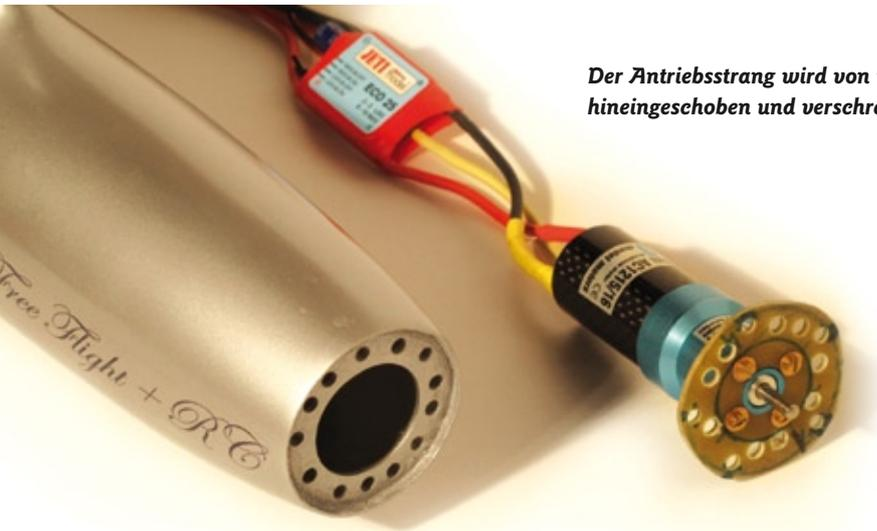
**Der Antriebsstrang wird von vorn hineingeschoben und verschraubt**
