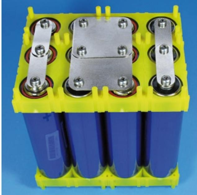
*Die schmalen Zellenverbinder bilden den Plus- und Minuspol. Die breiten Kontaktbleche in der Mitte stellen die serielle beziehungsweise parallele Verbindung der Einzelzellen her*
