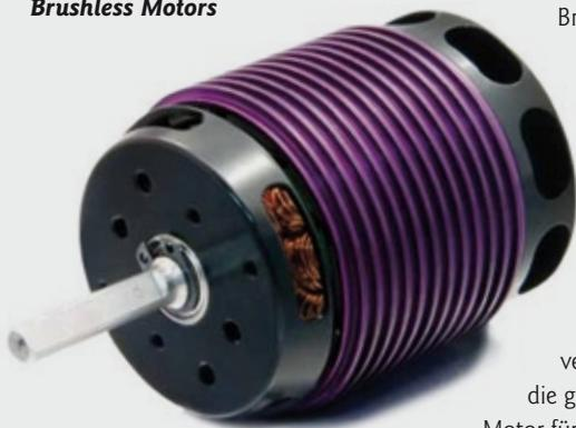
Auch der neue Turnado von Hacker Brushless Motors reiht sich in die High-End-Klasse der Heli-Antriebe ein. Den 455 Gramm schweren Motor gibt es mit 400, 470 und 580 Umdrehungen pro Minute und Volt. Das Besondere an ihm ist die 8 Millimeter starke Antriebswelle, deren Maß sich außen auf 6 Millimeter verringert. Der Ventilator und die gerippte Außenseite helfen, den Motor für eine längere Dauerbelastbarkeit aktiv zu kühlen.
