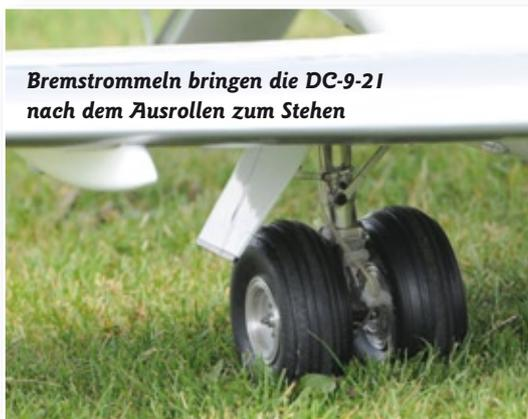
**Bremstrommeln bringen die DC-9-21 nach dem Ausrollen zum Stehen**
