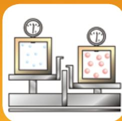
**Abbildung 2: Bei gleichem Druck und Volumen ist die Zahl der Teilchen in beiden Fällern gleich, die Masse kann aber differieren**
