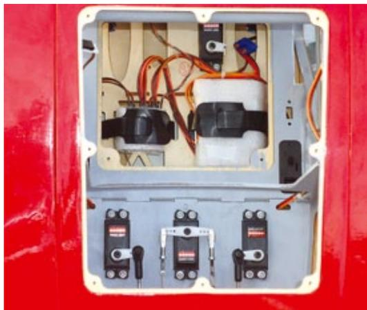
**Der Einbau der RC-Komponenten erfolgte vorbildlich. Kabelbinder sorgen für eine klare Führung der Kabelstränge**
