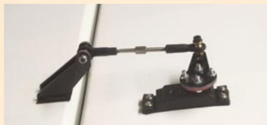
Anlenkung befindet sich unter dem Cockpit und bekommt noch einen recht großen Servoarm angeschraubt. Nachdem am Servoarm die Kugelköpfe verschraubt sind, lassen sich die Steuerseile montieren.
