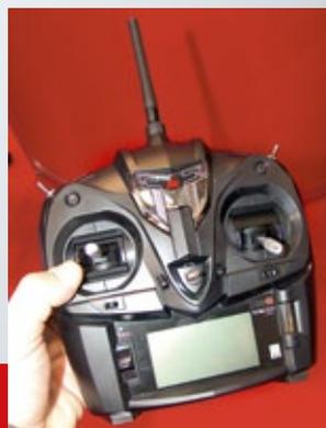
Handlich und praktisch präsentiert sich der Sechs-Kanal-Sender XG6 von JR Propo. Mit diesem sind gängige Flächen- und Heli-Modelle gut programmierbar. Die aktuelle DMSS-Telemetrie- und Übertragungstechnik ist voll integriert.
