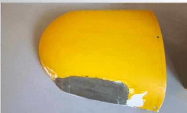
**Nach dem Entfernen der ABS-Platten mit Hilfe eines Föns kann die Stelle schon grob von außen verschliffen werden**
