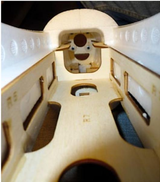
**Aus dem Sperrholz wird ein robuster Rumpfkasten geklebt, was sich dank der guten Bauanleitung als sehr einfach entpuppt**
