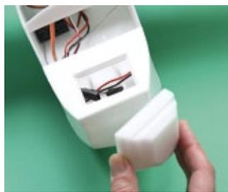
*Aus vier Schichten 6er-Depron, die passend zugeschnitten sind, besteht die Rumpfnase, die abschließend zu verschleifen ist*
