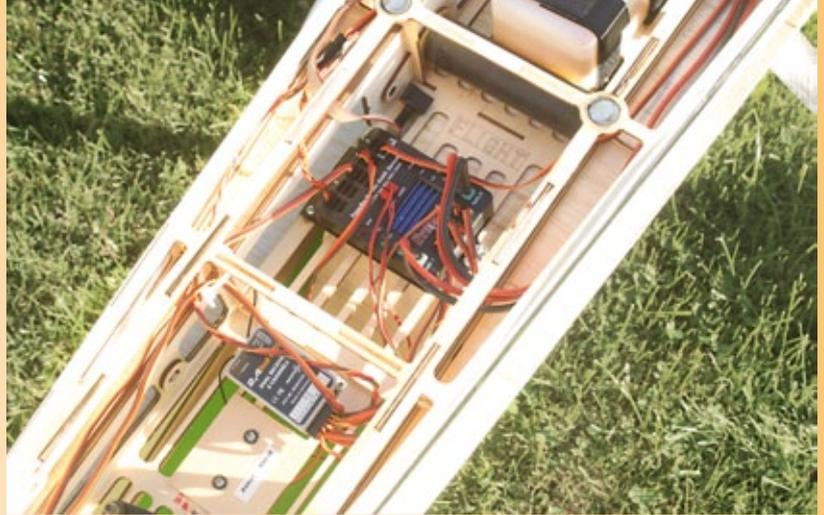
**Die PowerBox Evolution ist auf Schwinggummis gelagert und verschraubt. Daneben sind zwei Leuchtdioden zur Akkuüberwachung eingelassen. Die Steuerbefehle gibt ein Achtkanal-Weatronic-Empfänger weiter**
