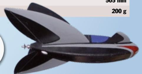
Ein Delta für den Spaß zwischendurch, das ist der Swatter Hase, der überwiegend aus 6er-Depron und mit einer einfachen, sehr festen KF-Fläche zu bauen ist.
