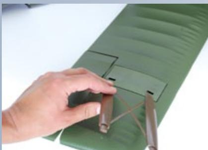
**In der unteren Tragfläche sind die Plastik-Fertigteile der Tragflächenstiele einzuhängen**
