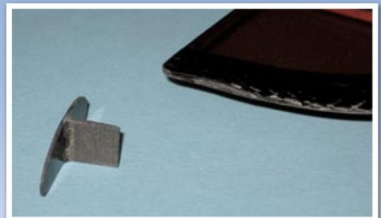
*Beide Randbögen besitzen bereits eine längliche Aufnahme für die Wurfblades. Die Wurfhilfe wurde etwas verrundet und dann mit dickflüssigem Sekundenkleber eingeklebt*
