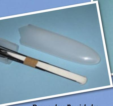
*Der vordere Bereich des Rumpfrohrs wurde schräg abgeschnitten und mit einem Harz-Microballon-Gemisch aufgefüllt. Die Formgebung übernimmt ein Kunststoffteil*
