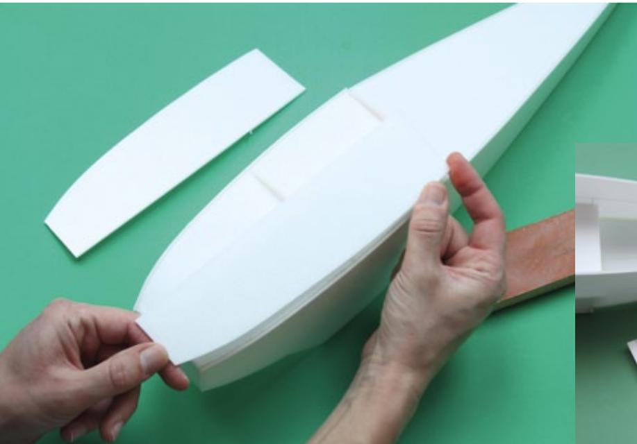
*Der mit etwas Übermaß erstellte zweite Rumpfboden ist exakt in der Mitte des 6-Millimeter-Depron-Streifens aufzukleben*
