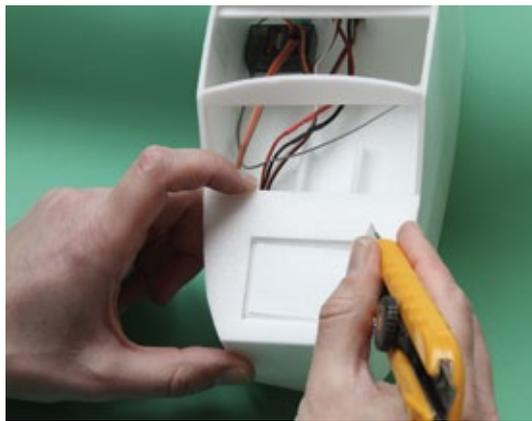
*Oben auf den ersten Akkudeckel kommt ein zweiter. Der untere Ausschnitt ist etwas enger zu schneiden, damit die Akkuklappe aufliegen kann*
