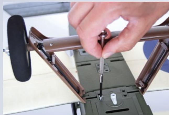
**Fixiert wird das starre Fahrwerk mit Schrauben und Halterungen in dafür vorgesehenen Aufnahmen**
