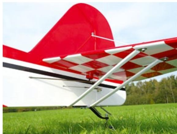
*Das große, nicht profilierte Leitwerk erhält durch beidseitige Streben zusätzliche Stabilität*
