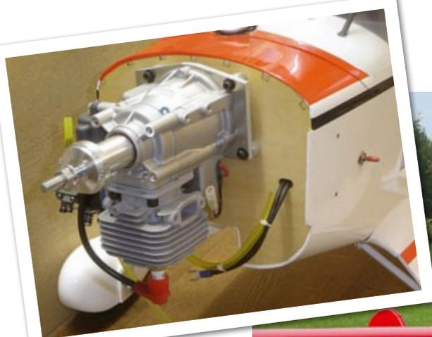
**Kurze Abstandsbolzen und vier Schrauben bringen den Zenoah-Benzinmotor mit 26 Kubikzentimeter Hubraum in Position**
