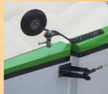
**Das Heckfahrwerk wird mit drei M3-Schrauben unter den Rumpf geschraubt, im Rumpf sind die Einschlagmuttern bereits montiert**
