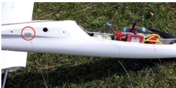
**Die Stromversorgung der Servos im Flügel erfolgt über grauen Multiplex-Stecker**
