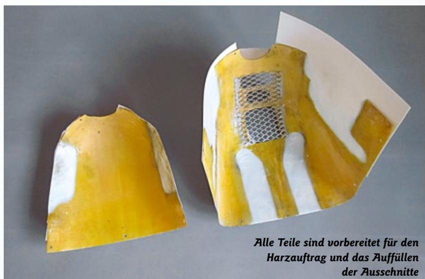
**Alle Teile sind vorbereitet für den Harzauftrag und das Auffüllen der Ausschnitte**
