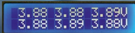
**Unterschiedliche Darstellung der Einzelzellenspannungen. Entweder übersichtlich alle sechs Zellen zusammen oder hoch präzise, dreistellig hinterm Komma**
