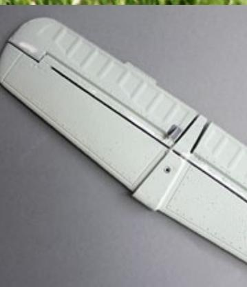
**Das Höhenleitwerk mit der Kohlefaser-Verstärkung. Laut Hersteller sind neue Modelle bereits serienmäßig damit ausgestattet**
