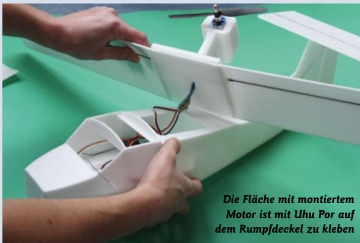
*Die Fläche mit montiertem Motor ist mit Uhu Por auf dem Rumpfdeckel zu kleben*
