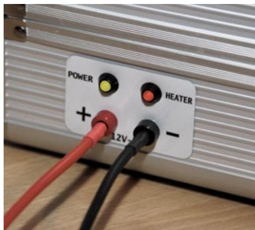
**Von außen wird die Box mit Strom versorgt, gleichzeitig wird dort auch der Betriebsmodus angezeigt**
