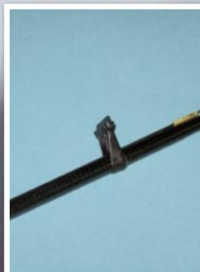
*Der Leitwerksträger ist bereits mit den Führungen für die Anlenkungsdrähte versehen und auch die filigrane Pendelhöhenruderwippe ist werksseitig verklebt*
