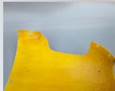
**Die ABS-Platten sind mit Sekundenkleber verklebt. Jetzt lassen sich die Lücken von innen auffüllen**
