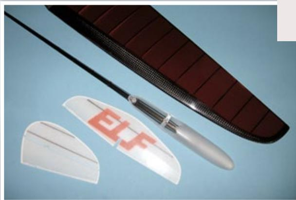
*Die Tragfläche besitzt unzählige CFK-Verstärkungen, das Rumpfrohr besteht ebenfalls aus CFK und die Leitwerke sind aus beschichteten Schaumkernen*
