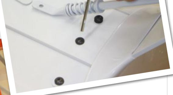
**Die Zoll-Schrauben zur Fahrwerksbefestigung erfordern das Vorhandensein eines nicht metrischen Inbusschlüssels. Das beiliegende Werkzeug passt überraschenderweise nicht**
