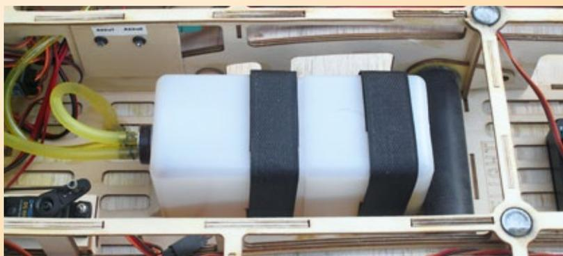
**Der Tank wurde bereits vom Hersteller an Ort und Stelle eingebaut und ist mit allen Anschlüssen ausgerüstet**
