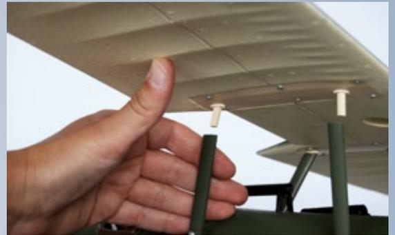
Oben greifen dann massive, exakt passende Stifte den Baldachin
