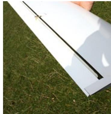
Herstellerseitig ist die Steckung bereits eingebaut und die Wurzelrippen bei der Flügelhälften sind präzise an den Rumpf angepasst. Die Wölbklappen sind mit Flexischarnieren angeschlagen und mit Dichtlippen ausgestattet
