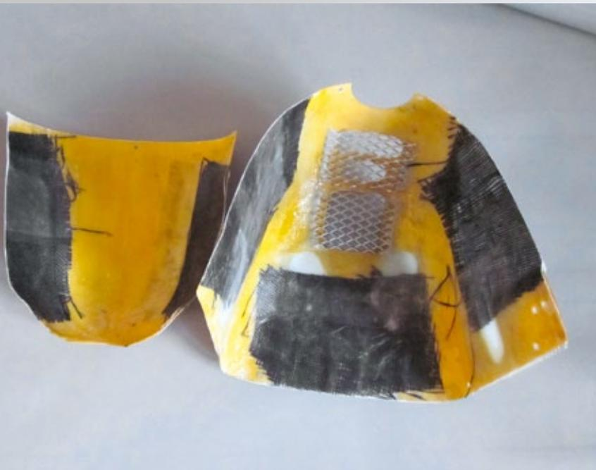
**Die Löcher sind verschlossen. Für Festigkeit sorgt eine CFK-Matte zwischen den GFK-Gewebeeinlagen**
