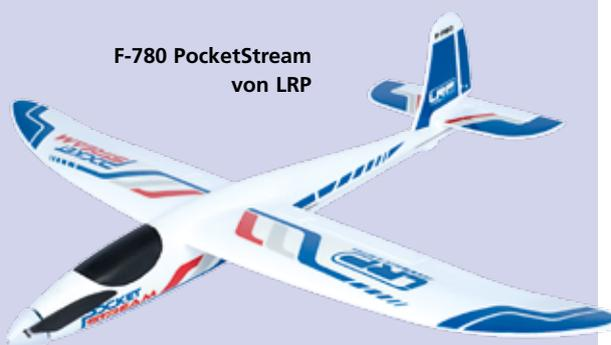
Der Pocket Stream ist ein EPO-Fun-Flieger mit einer Spannweite von 780 Millimeter, einer Länge von 600 Millimeter und einem Gewicht von 215 Gramm. LRP bietet den Elektrosegler als ARF-Variante inklusive eines Brushlessmotors mit 2.200 Umdrehungen pro Minute und Volt, einem 10-Ampere-Brushlessregler und vormontierten 4,3-Gramm-Servos an. Inklusive Klappflugschraube und separat anlenkbaren Querrudern. Der Preis für die F-780 PocketStream: 119,99 Euro
