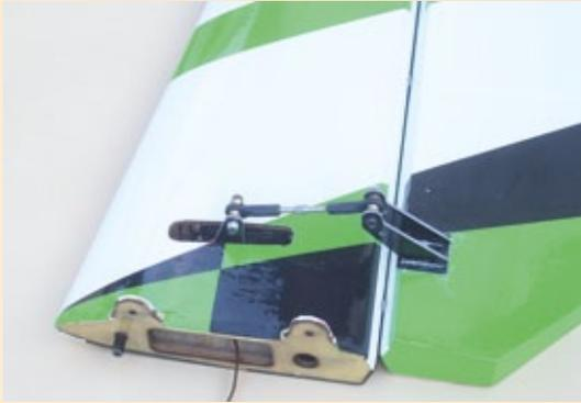
**Fertig angesteuertes Höhenruderblatt mit Befestigungslaschen. Das Servo ist versenkt eingebaut**
