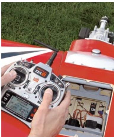
**Während der Aufbauphase lassen sich Einstellarbeiten bequem durch die obere Rumpfföffnung ausführen. Für das Binding mit dem Spektrum-Empfänger wird natürlich ein Spektrum-Sender benötigt**
