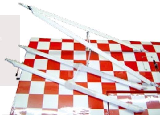
**Die Flächenstreben liegen vorgefertigt bei, verlaufen aber nicht im richtigen Winkel zueinander. Das führt bei der fertig montierten Verstrebung zu Spannungen**
