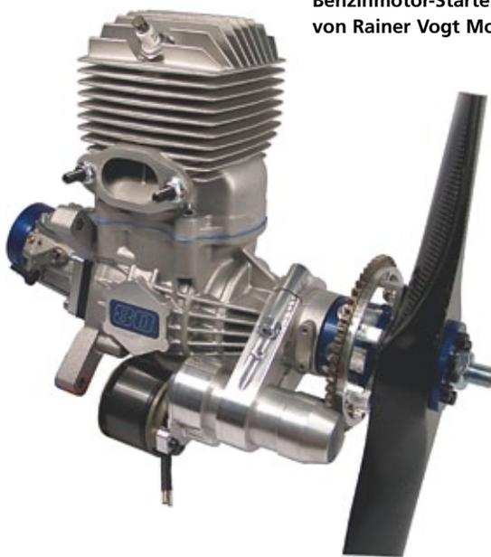
**Rainer Vogt Modellbau** Mit dem Starter-Set von Rainer Vogt Modellbau kann man einen Benzinmotor sicher und bequem über die Fernsteuerung starten. Die Zündanlage ICU-P regelt über einen Leistungsschalter die Starteinrichtung, ein an die Zündanlage angeschlossenes Servo steuert die Choke-Klappe vollautomatisch. Das Gewicht des Anbausatzes beträgt zirka 630 Gramm inklusive Schaltregler. Der Preis: 889,- Euro.
