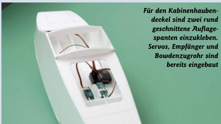
*Für den Kabinenhaubendeckel sind zwei rund geschnittene Auflage-spanten einzukleben. Servos, Empfänger und Bowdenzugrohr sind bereits eingebaut*
