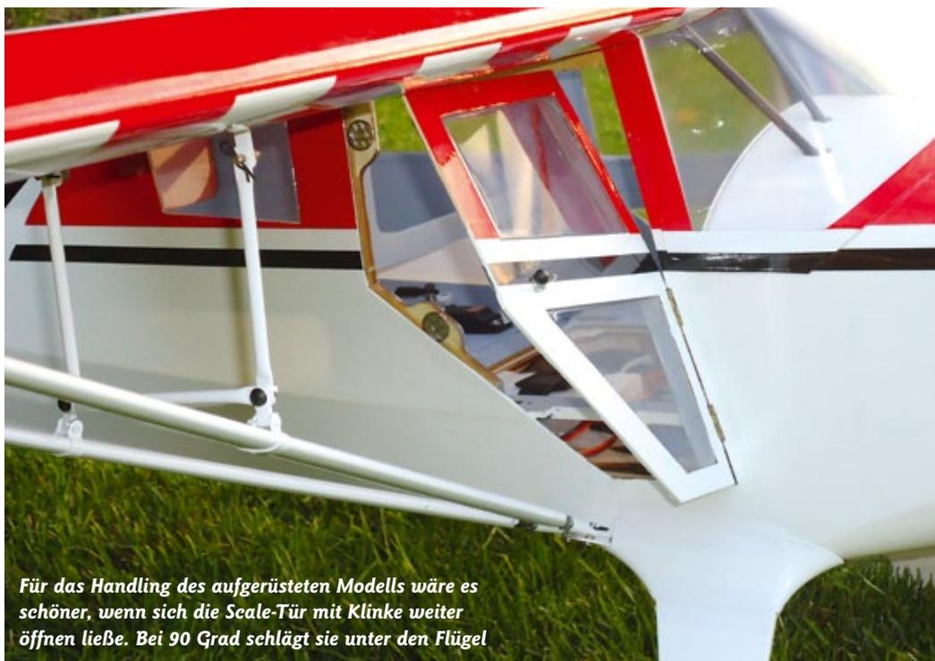
**Für das Handling des aufgerüsteten Modells wäre es schöner, wenn sich die Scale-Tür mit Klinke weiter öffnen ließe. Bei 90 Grad schlägt sie unter den Flügel**
