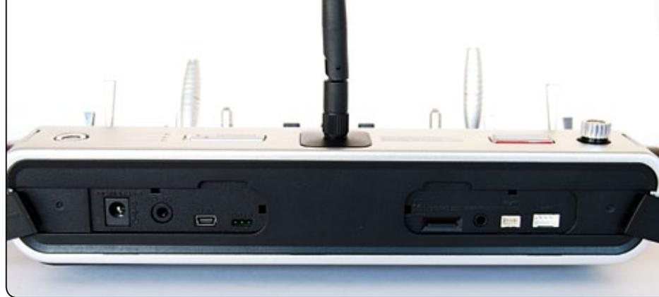
Unter zwei Klappen an der Stirnseite lassen sich folgendes von links nach rechts einstecken: Ladekabel, Lehrer-Schüler-Kabel, Mini-USB-Buchse, Smart-Box, micro-SD-Karte, Kopfhörer, ein externes HF-Modul und optionales für zukünftige Anwendungen
