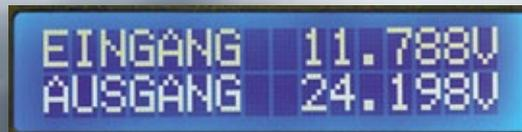
Die interne Spannung zeigt 11,8 Volt (extern 12,2 Volt), wenn am Eingang der volle Strom von 33 Ampere fließt. Die Akkuspannung beträgt 24,198 Volt
