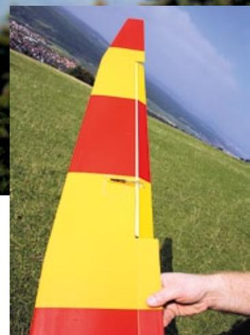
**Die Querruder sind mit Flexischarnieren angeschlagen und mit einer Dichtlippe ausgestattet. Die Ansteuerung erfolgt auf der Flügelunterseite, eine Augenschraube dient als Ruderhorn**
