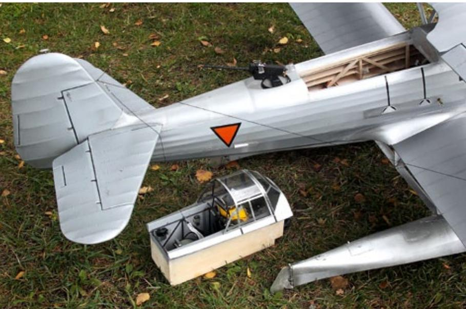
**Um an RC-Komponenten und Akku zu gelangen, ist der Cockpiteinsatz entnehmbar**
