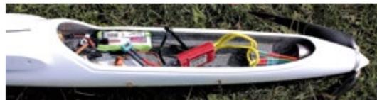
**Das Rumpfschiff bietet genügend Platz für Fernsteuerkomponenten und Elektroantrieb. Ein CNC-gefrästes Servobrett für den Rumpfinnenausbau gehört zur Bausatzausstattung**
