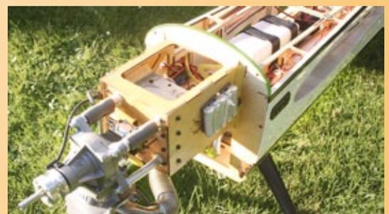
**Im und am Motordom sind die beiden LiPos der Doppelstromversorgung, der Spark Switch-Zündschalter, die Zündung und dessen fünfzellige EneLoop-Akku platziert**
