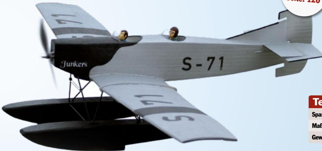
Wie beim Vorbild auch, lässt sich bei der Junkers eine vorbildgetreue Wellblechstruktur ins Depronmodell einarbeiten. Mit 1.280 Millimeter Spannweite ist dieses Wasserflugzeug bereits der Kategorie Parkflyer zugehörig. Die Schwimmer sind Bestandteil des Bauplans. So lässt es sich vorbildgetreu umsetzen.
