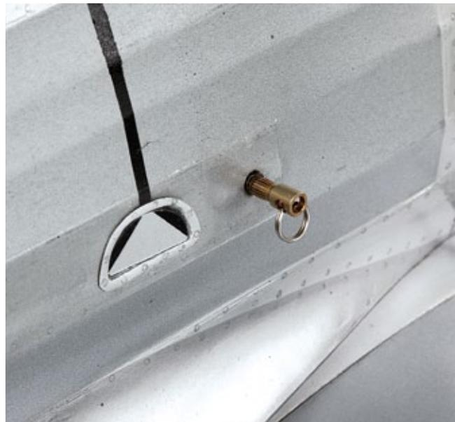
**Der Sicherheitsstecker zum Schalten der Stromversorgung ist unauffällig und gut erreichbar eingebaut**
