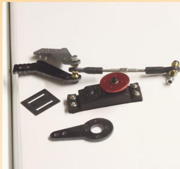
**Die Servoverlängerungsarme werden auf die Servoscheiben geschraubt. In den Rudern sind Schlitz für die CFK-Ruderhörner vorhanden, müssen jedoch noch freigelegt werden**
