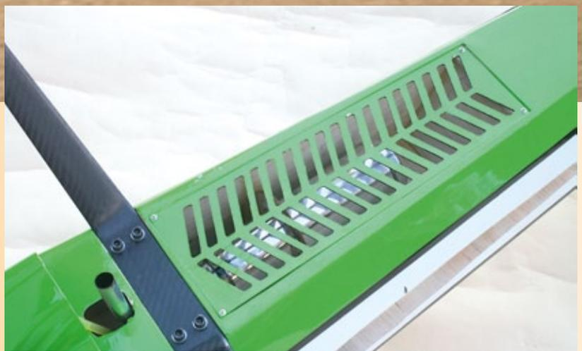
**Der Schalldämpferschacht wird mit einem Sperrholzgitter verschlossen. So kann die warme Abluft entweichen**
