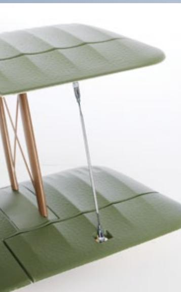
Ein fertig konfektioniertes CFK-Gestänge verbindet das obere und untere Querruder
