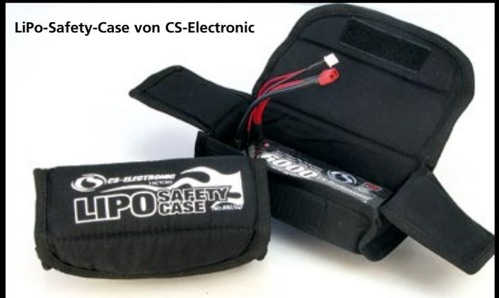
**CS-Electronic** Neu im Angebot von CS-Electronic ist eine Akkutaste. Die Tasche besteht aus nicht entflammendem Glasfasergewebe und hat seitliche Öffnungen für Ladekabel. Das LiPo-Safety-Case ist 190 Millimeter lang, 80 Millimeter breit und hat eine Höhe von 50 Millimeter. Passend für 1s- bis 3s-LiPo-Packs. Gewicht ohne Akku: 62 Gramm. Der Preis: 17,90 Euro.
