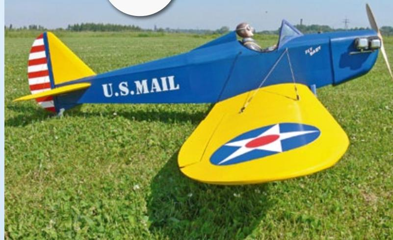
Für Holzwürmer ist die Fly Baby ein gefundenes Fressen. Gebaut wird sie komplett aus Balsa und Sperrholz. Bei der Bespannung steigert Textilfolie das Aussehen wesentlich.
