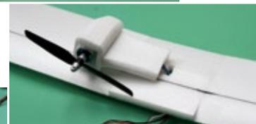
Im hinteren Bereich des Trägers war das Anbringen eines Keils erforderlich, um dem Konturverlauf der Fläche exakt zu folgen und die 5 Grad Motorsturz beizubehalten
