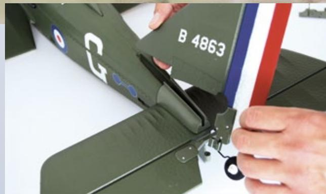
Leitwerke montieren, mit Schrauben sichern, Spornrad verschrauben, Anlenkgestänge an den Ruderhörner anbringen, fertig
