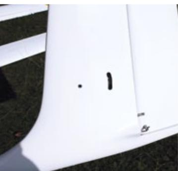
**Auch die Mechanik fürs Pendelhöhenleitwerk ist bereits vom Hersteller gebrauchsfertig montiert. Nur die Scharniere fürs Seitenruder müssen noch selber eingeharzt und ausgerichtet werden**
