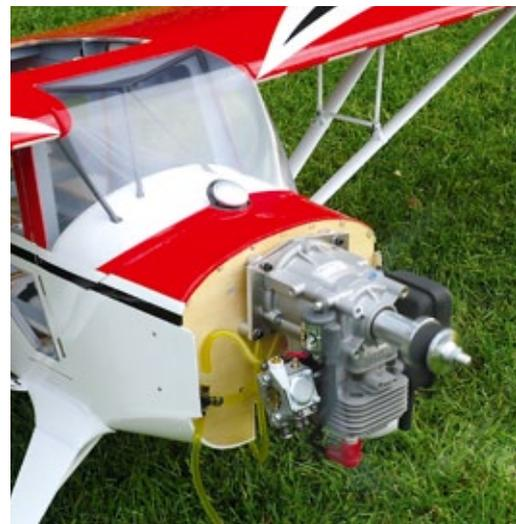
**Der erste Testlauf des Zenoah 260 erfolgt ohne Cowling und Spinner. Die Vergasereinstellung bedarf aber keiner Veränderung.**
