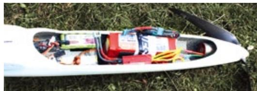
**Der Blue Adventure kann mit einem 5s- bis 10s-Antriebs-Setup geflogen werden. Der hier gezeigte 10s-LiPo passt locker unter die Kabinenhaube**
