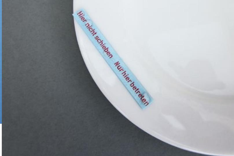
**Das Decal wird nach dem kurzen Wässern zum Einweichen der Trägerschicht an den Tellerrand gelegt. So kann es nicht wegschwimmen. Dann wäre es unbrauchbar, da der Kleber nicht mehr hält**
