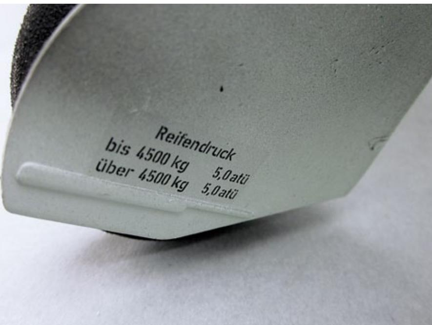
**So kann dann eine Fahrwerksverkleidung mit passender Beschriftung aussehen**
