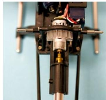
Der Heckantriebsmotor mit seinen Kühlrippen und dem Starrwellenantrieb
