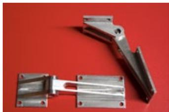
**Landeklappenscharniere für Großmodelle von Rainer Vogt Modellbau**
