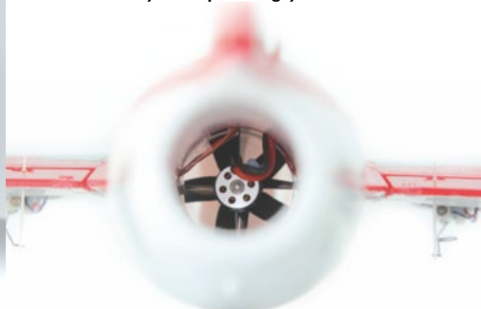
Die Kabelführung hätte sorgfältiger ausfallen können. Der Fünfblatt-Impeller sorgt für viel Schub
