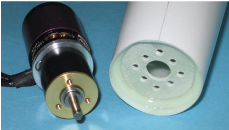
Der Rumpf wurde vom Hersteller bereits mit einem GFK-Motorspant versehen. Direkt daneben der verwendete Hacker-Antrieb
