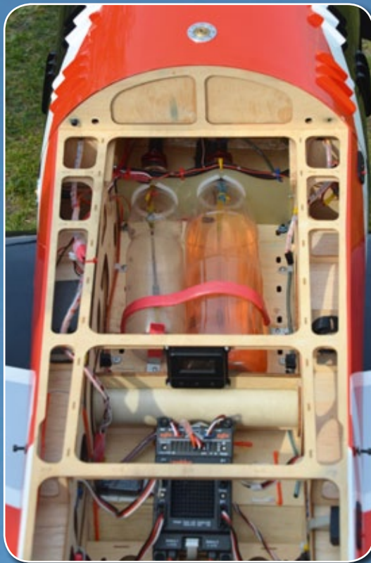
Die Tanks entstanden in gewohnter Manier aus PET-Flaschen mit Richter-Tanksystemen
