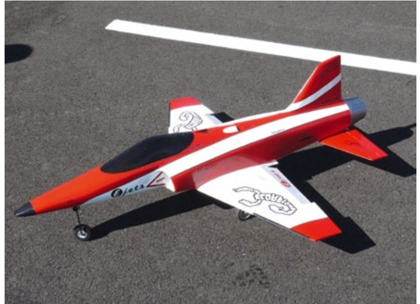
Der fliegende Prüfstand Sharky. Gleich mit einer kleinen Flotte dieser Modelle wurde der Jetfan-90 auf Herz und Nieren geprüft
