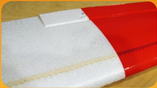
Turbulatoren an der extrem schmalen Fläche der LS8 von Yuki verleihen dem Modell deutlich optimierte Gleitleistungen
