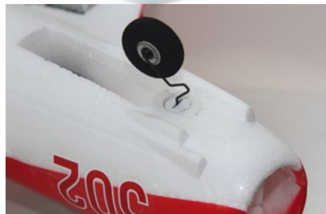
Im Schacht hinter dem Bugfahrwerk hat der Antriebsakku seinen Platz
