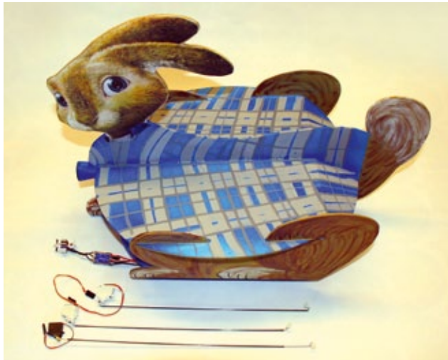
Nach dem Finish werden Servos und Anlenkstangen montiert
