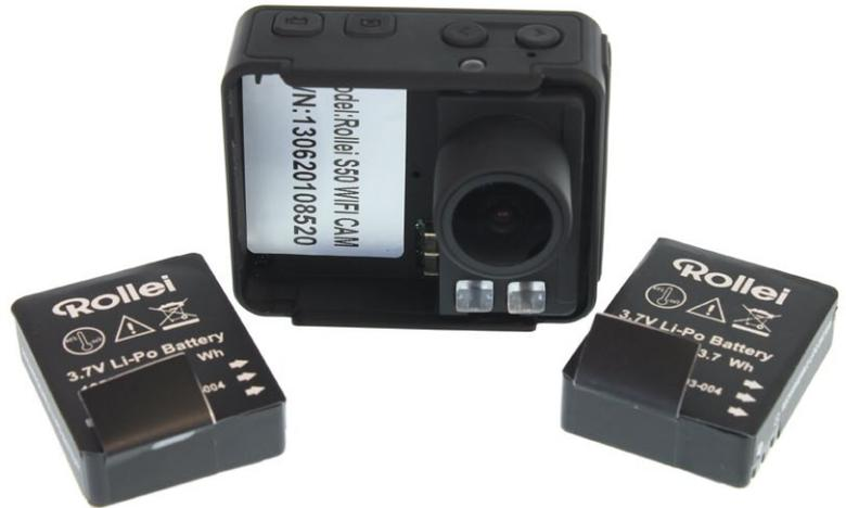
Speicherkarte. Aufgrund der hohen Schreibgeschwindigkeit der Karte kommt es während der Aufzeichnung zu keinen Aussetzern, die bei langsamen Speicherkarten und gleicher Datenmenge häufig zu beobachten sind. Der Langzeittest zeigt, dass die WiFi-Funktion deutlichen Einfluss auf die Akkulaufzeit der Kamera nimmt. Deaktiviert man die Funktion, hält der 1s-Li-Po rund 65 Minuten durch. Bei aktiviertem WiFi sind es 45 Minuten.
