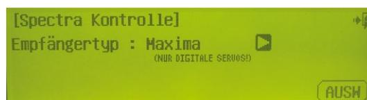
**Unter Spectra in den Systemeinstellungen lässt sich die Modulation wählen, hier Maxima. Mit Modulationstyp S.L.T. können auch einige Fremd-Empfänger bedient werden**
