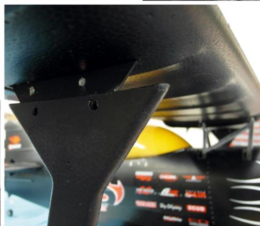
Bei der Montage des Fahrwerks und der Flächenstreben musste nachgebessert werden, Bohrungen und Muttern passten nicht richtig
