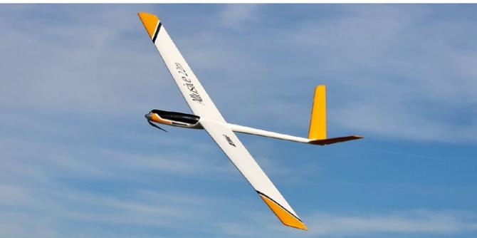
Allusive 2.2m heißt der neueste ARF-Elektrosegler von Horizon Hobby. Das Modell hat eine Spannweite von 2.200 Millimeter, ist 1.100 Millimeter lang und wiegt 1.400 Gramm. Angetrieben wird der Segler, dessen Tragflächen in Styro-Abachi-Bauweise ausgeführt sind, von einem Power 15-Brushlessmotor. Der Rumpf besteht aus GFK, das V-Leitwerk ist abnehmbar. [www.horizonhobby.de](http://www.horizonhobby.de)
