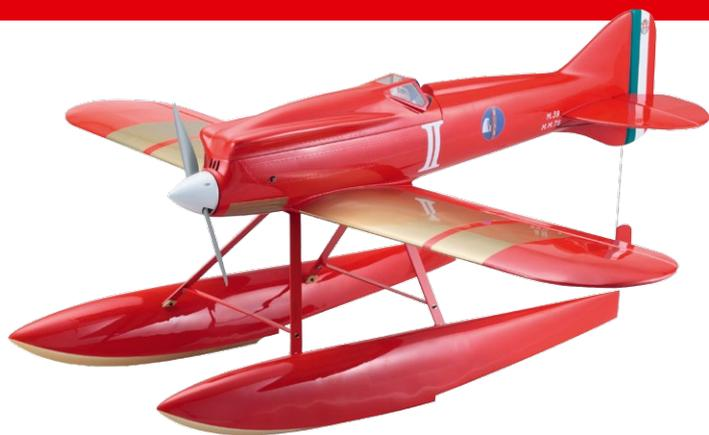
Die Macchi M-39 von Kyosho wird als ARF-Set ausgeliefert. Rumpf, Motorgondel und Schwimmer bestehen aus GFK, die Tragfläche und das Leitwerk sind in Balsa-Sperrholzbauweise erstellt. Das Modell mit einer Spannweite von 1.600 Millimeter, einer Länge von 1.300 Millimeter und einem Gewicht ab 3.300 Gramm kann sowohl mit einem Elektro- als auch einem Verbrennungsmotor betrieben werden. Preis: 559,- Euro. [www.kyosho.de](http://www.kyosho.de)
