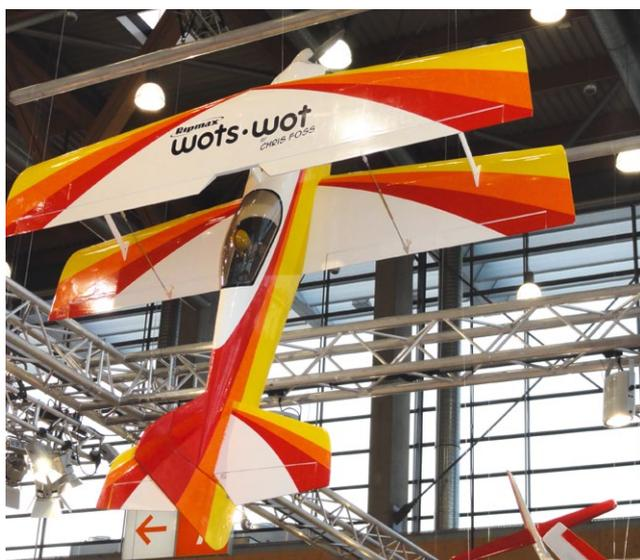
Ripmax zeigte auf der Spielwarenmesse ein neues Modell des erfolgreichen Konstrukteurs und Entwicklers Chris Foss. Der Doppeldecker Wots-Wot hat eine Spannweite von 1.280 Millimeter und wird je nach Ausstattung um die 3.200 Gramm wiegen. Möglich ist der Einbau eines 11-Kubikzentimeter-Viertakters oder eines Außenläufers mit 5s-LiPos. Das ARF-Modell ist weitgehend aus Holz gebaut, die Motorhaube aus GFK. [www.ripmax.com](http://www.ripmax.com)
