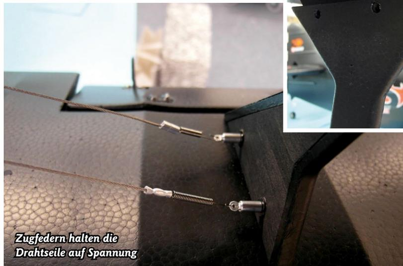
Zugfedern halten die Drahtseile auf Spannung
