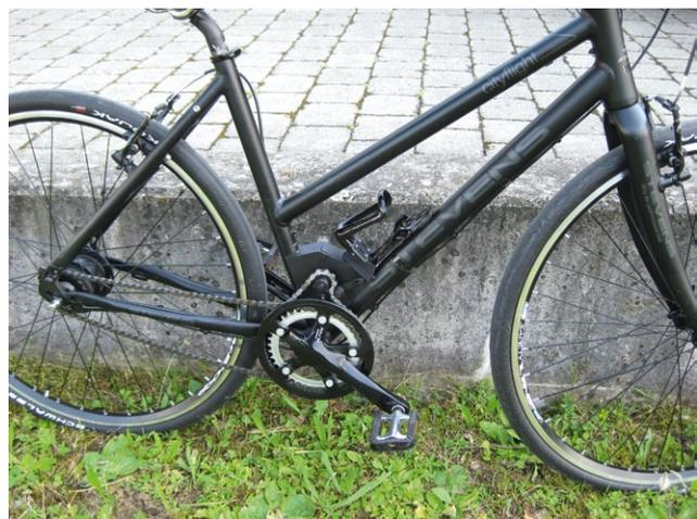
**Abb. 11: Stevens-Cross-Damenrad mit einstufigem Henseleit-Zahnradatz. Erkennbar auch der Flaschenhalter-Boden, an dem der Akku angedockt wird**
