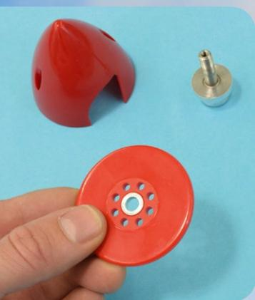
**In die Spinner-Grundplatte aus rotem Kunststoff muss ein beiliegender Alu-Ring eingepresst werden, damit alles sauber auf den Mitnehmer passt**
