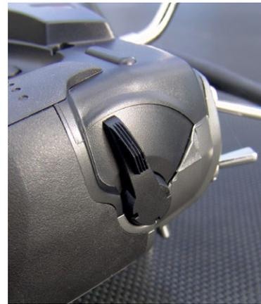
Auf beiden Flanken befinden sich sehr gut erreichbare Slider (Mittelstellung hat Rastung) zum Bedienen von Kanälen oder Sonderfunktionen
