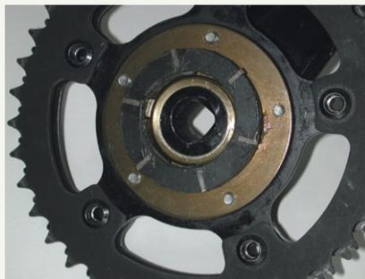
**Pedalfreilauf mit Kettenblatt und Magnetscheibe. So wird mittels Hall-Sensor die Pedalbewegung erkannt**
