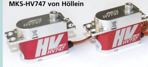
**Der Himmlische Höllein** Die Hochvolt-Servos MKS-HV737 und MKS-HV747 von Höllein verfügen über ein Aluminium-Gehäuse und können direkt an 2s-LiPos betrieben werden. Sie sind darüber hinaus mit einem verschleißarmen Glockenankermotor sowie Metallgetriebe ausgerüstet. Das HV747 hat eine Stellkraft von 13,8 Kilogramm, das HV737 stellt (an 7.4 V) in 0,1 Sekunden auf 9,1 Kilogramm. Beide Rudermaschinen wiegen 38, 6 Gramm und schlagen jeweils mit 69,50 Euro zu Buche.
