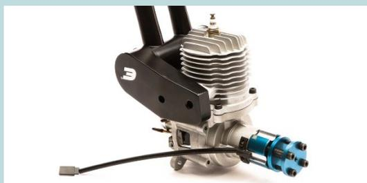
Der Evolution 62GXi rühmt sich, erster Benziner mit elektronischer Kraftstoffeinspritzung zu sein. Er bietet 62 Kubikzentimeter Hubraum, wiegt 1.880 Gramm und erreicht bis 8.000 Umdrehungen in der Minute. Das SureFire EFI genannte System ermittelt über Sensoren die nötige Kraftstoffmenge. Zur Stromversorgung dient ein 2s-LiPo. Preis: 599,99 Euro.
