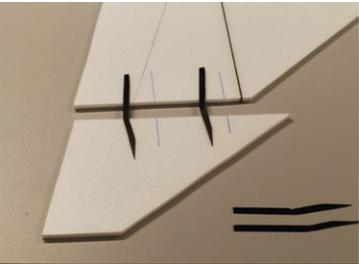
Um zusätzlich Stabilität in die Knick-Verbindung der Tragflächen zu bekommen, werden dünne CFK-Stege in das Depron eingeklebt
