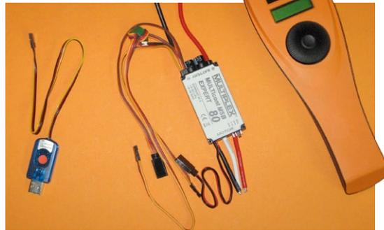
**Wahlweise lassen sich die MSB Expert-Regler per Gasknüppel, per USB-Adapterkabel oder mittels Multiplex-Multimate programmieren**
