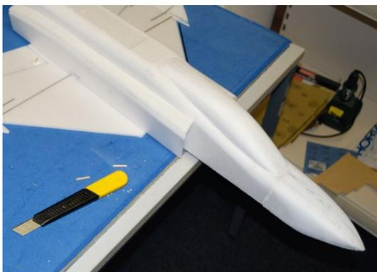
**Die Rumpfspitze (Radom) und Kabinenhaube bestehen aus einem Depronblock und werden abschließend auf Kontur geschliffen**
