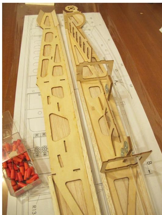
**Spanten und Seitenteile sorgen für Steifigkeit. Balsaplaten verkleiden den Rumpf und Balsaleisten geben Futter fürs spätere Rundschleifen**
