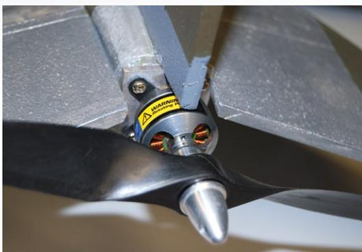
**Rückwandmontage des Pushers. Die Motorkabel verlaufen unterhalb des Hecks in den Haupttrumpf**
