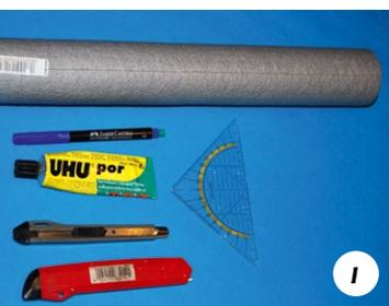
**Diese Werkzeuge benötigt man zur Herstellung von Schaumstoff-Triebwerksdüsen**
