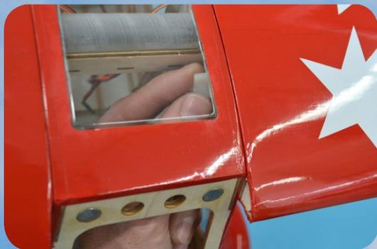
**Um die Flügelschrauben festzuziehen oder zu lösen, muss man mit der Hand durch die Kabinenhaubenöffnung**
