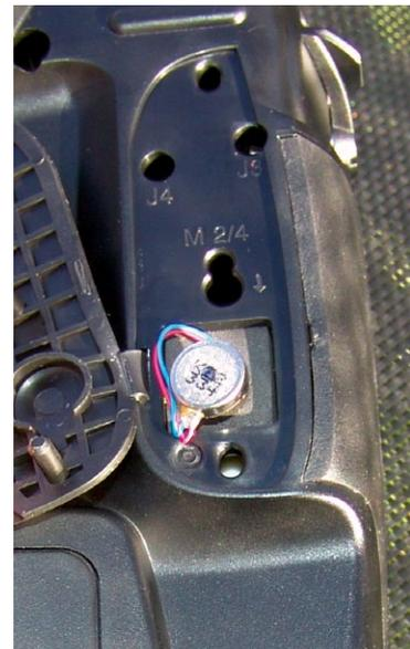
Unter dem linken Gummiwulst ist der Vibrationsmotor platziert
