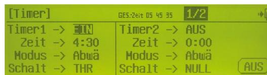
Zwei Timer stehen zur Verfügung und können beliebigen Schaltern zugeordnet werden
