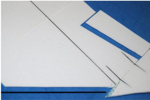
**Zur Versteifung erhält das Tragflächeninnenstück ein Karbonprofil. Dazu die Tragfläche einfach auseinander-schneiden, Profil dazwischensetzen und alles wieder zusammenkleben**
