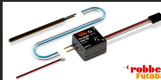
Die exakte Geschwindigkeit messen. Der robbe-Futaba True Airspeed Sensor 450 für das S-BUS-System ermittelt präzise die Geschwindigkeit des Modells gegenüber der Luft - durch exakte Messung des Staudrucks und des Umgebungsluftdrucks.
