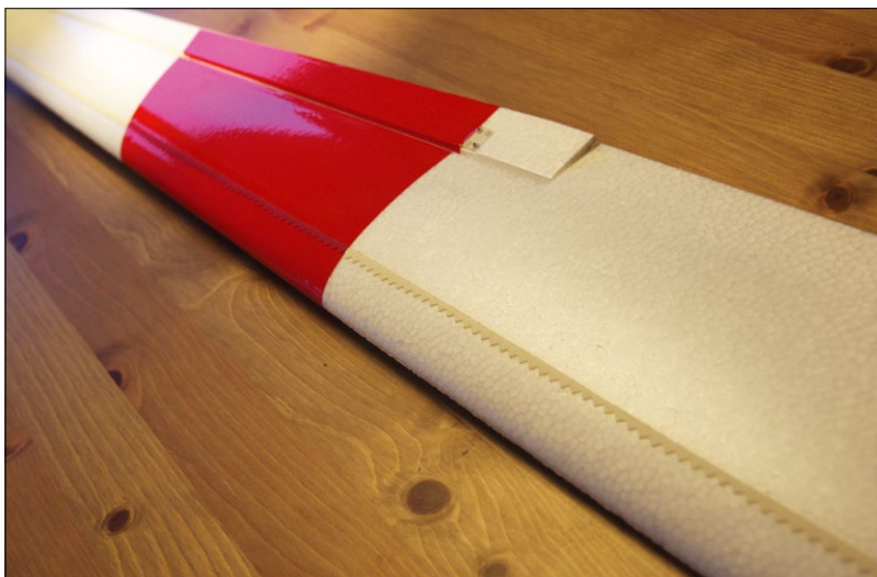
Abbildung 3: Flügel eines Schaummodells mit der typischen, leicht rauen Oberfläche
