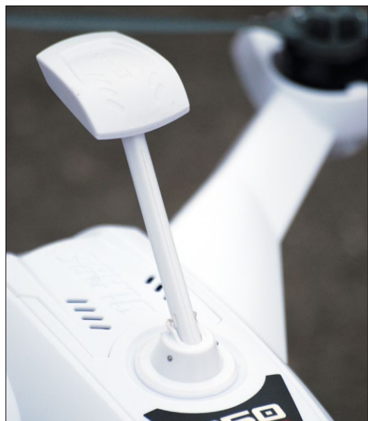
Der ausklappbare GPS-Mast verbessert die GPS-Empfangsqualität gegenüber der Vorgängerversion
