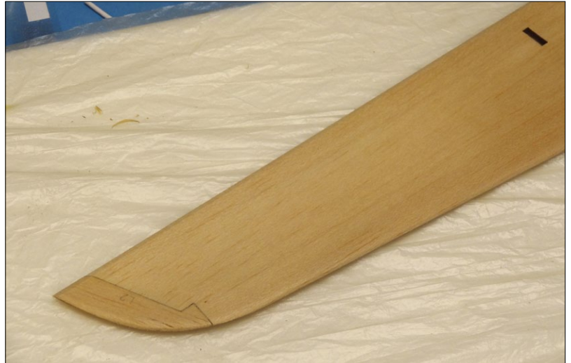
Durch die ausgeprägte Maserung des Balsaholzes würden sich die Leitwerke der Libelle Evo II beim Bügeln verziehen. Daher werden die Randbögen mit quer gemaserten Teilen abgesperrt
