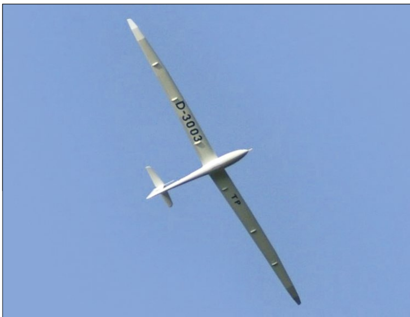
Abbildung 2: Die Ventus 2c von Wildflug besitzt einen Voll-GFK-Flügel mit perfekt glatter Oberfläche
