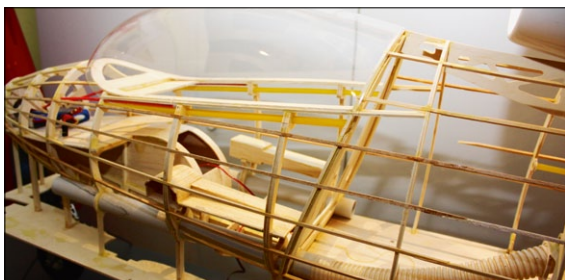
Innenleben der He-162-Rumpfspitze. Über die Öffnung der Bordkanone wird Kühlluft zum Drehzahlsteller geleitet
