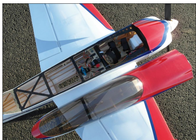
Etwas Styro presst den Flugakku in die passende Position, Klettband hält ihn sicher
