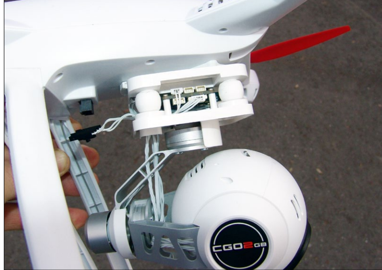
Die im kugelförmigen Korpus untergebrachte CGO2-Kamera verfügt serienmäßig über eine integrierte Tilt-Funktion, das heißt sie lässt sich via Fernsteuerung neigen. Mit Hilfe eines Schienensystems wird das Gimbal am Kopter befestigt
