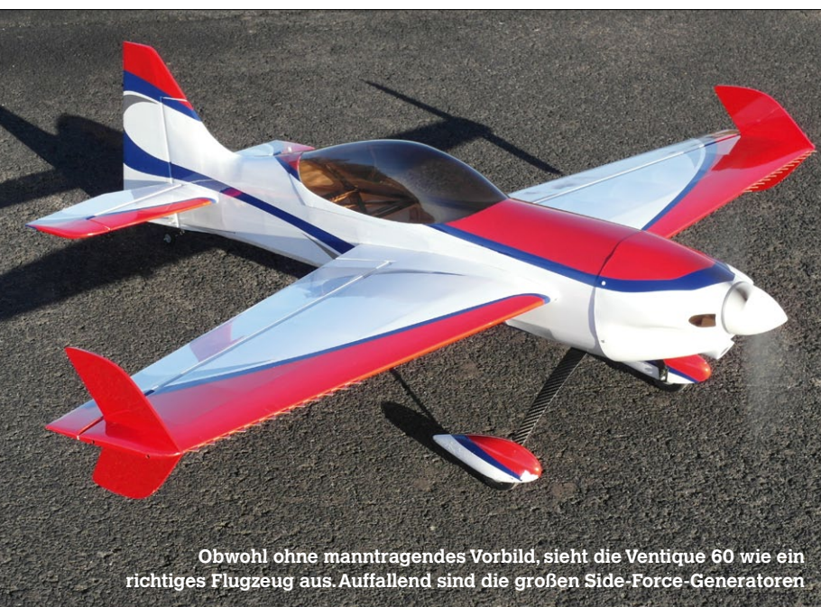
Riesige Ruderflächen verraten den Einsatzbereich dieses Modells: Extreme Flugzustände
