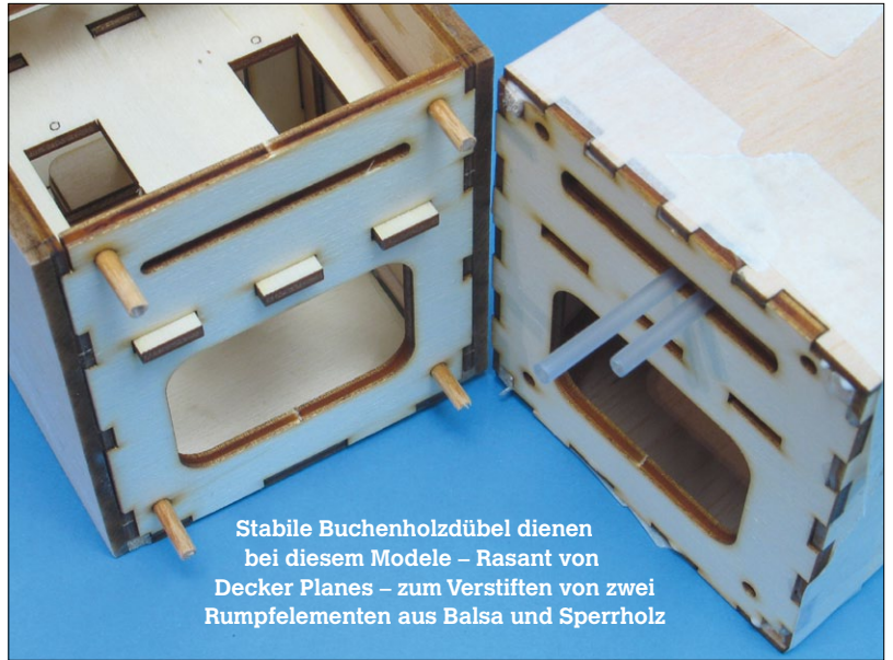
Gelungener Materialmix: In Form gefräste Balsa- und Sperrholzplatten erleichtern beim Decker Planes-Modell Rasant das Schleifen der Rumpfnase
