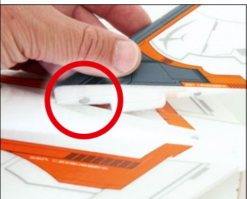
Das Seitenleitwerk ist durch starke Magnete gesichert
