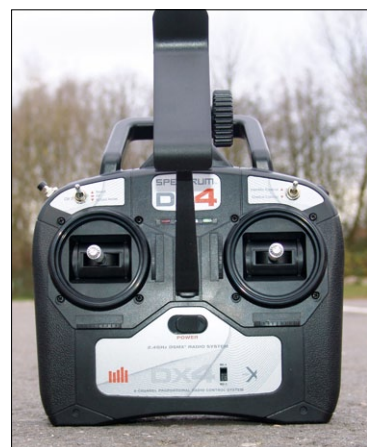
Der linke Dreiweg-Schalter der DX4 dient zum Aktivieren der Modi Smart, AP (Aerial Photo) und Return-Home. Auf der Stirnseite ist der Tastschalter zum Stoppen der Motoren. Der rechte Zweiweg-Schalter dient zum Umschalten auf Tilt-Funktion
