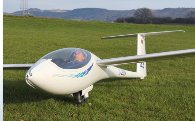
Nasenantriebe sind bei Großseglern voll im Trend. Hier hilft eine feinfühlige Steuerung der Motorleistung über den Drosselknüppel beim Start
