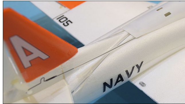
Draußen nur Kännchen: die Anlenkungen verlaufen in passenden Vertiefungen an der Rumpfwand ins Freie
