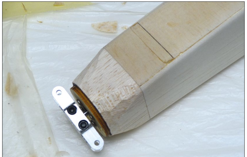
Die Nase der Libelle ist ein Musterbeispiel für einen intelligenten Materialmix bei den Holzteilen. Der Motorspant ganz vorn ist aus Sperrholz, dahinter ein noch grob geschnittener, ausgehöhlter Balsaklotz, dann folgen Balsabrettchen
