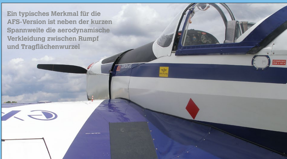
Unter der Cowling verbirgt sich der Walter Minor Sechszylinder mit einer Leistung von 180 PS
