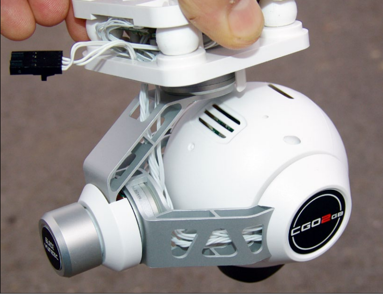
Herzstück des Film-Equipments ist das Blade-Dreiachs-Gimbal mit Full-HD-Kamera CGO2
