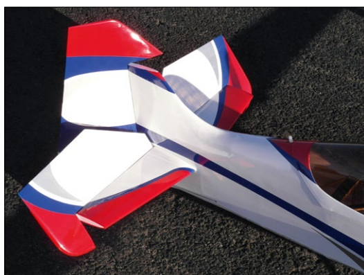
Riesige Ruderflächen verraten den Einsatzbereich dieses Modells: Extreme Flugzustände
