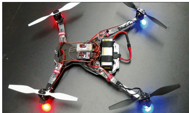
Optional wurde der Ninja noch zusätzlich mit Beleuchtung in Form von LED ausgestattet, um die Erkennbarkeit nochmals zu steigern
