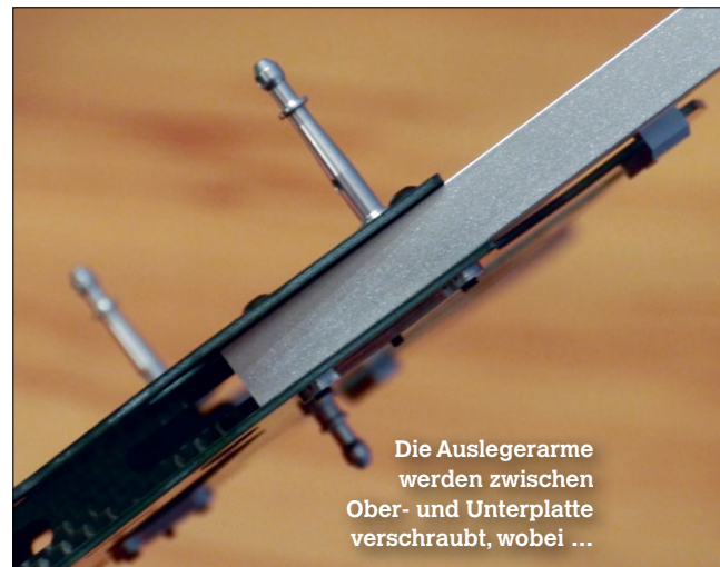
... die zuvor verschraubten Alu-Verstärkungen für kraftschlüssige Verbindung mit den CFK-Platten sorgen
