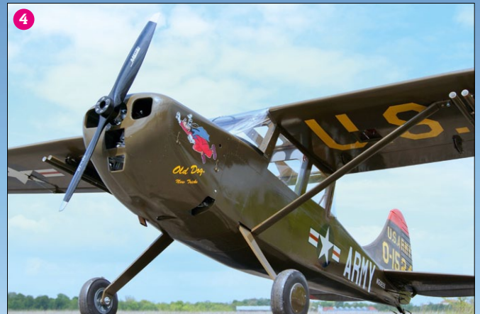
Fototermin auf historischem Gelände. In Oberschleißheim waren in den 1950er-Jahren Bird Dog der US-Army stationiert (1). Motorisiert ist das Semi-Scale-Flugmodell mit einem RCGF 45 cm 3 (2). Beim Start verlangt das Modell etwas Aufmerksamkeit, bietet ansonsten aber sehr überzeugende Flugeigenschaften (3). Die Comic Figur auf der Motorhaube hat Franz Ebermayr nach einem Foto gezeichnet, ein Foliendesigner erledigte den Rest (4)
