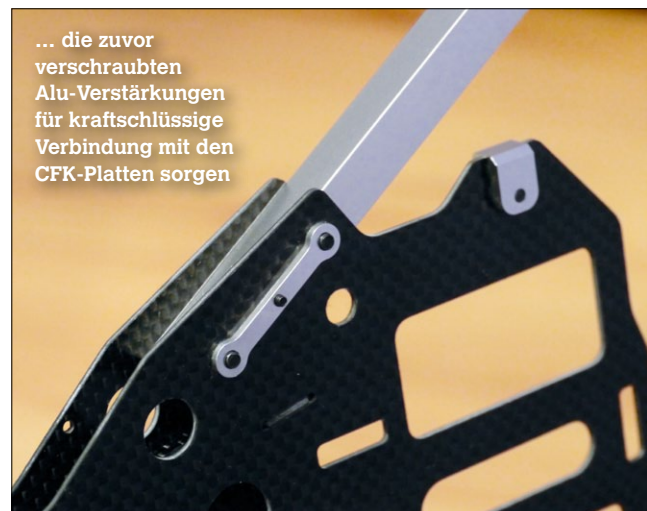
Die Auslegerarme werden zwischen Ober- und Unterplatte verschraubt, wobei ...
