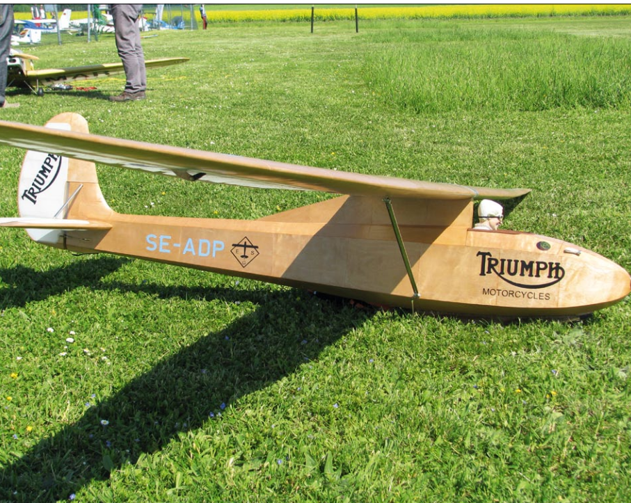
Die klassische Holzbauweise wird beim Rumpf dieser Grunau Baby offensichtlich
