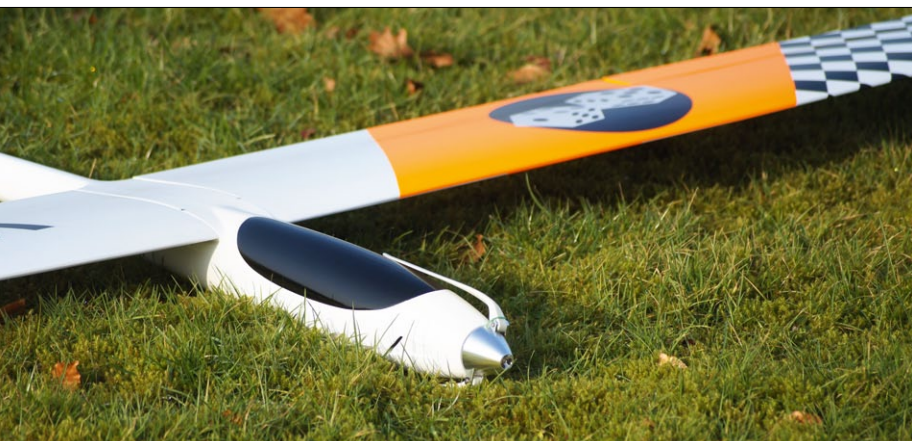
Der Aluspinner mit integrierter Lüftungsöffnung und installierte Carbon-Kabinenhaube
