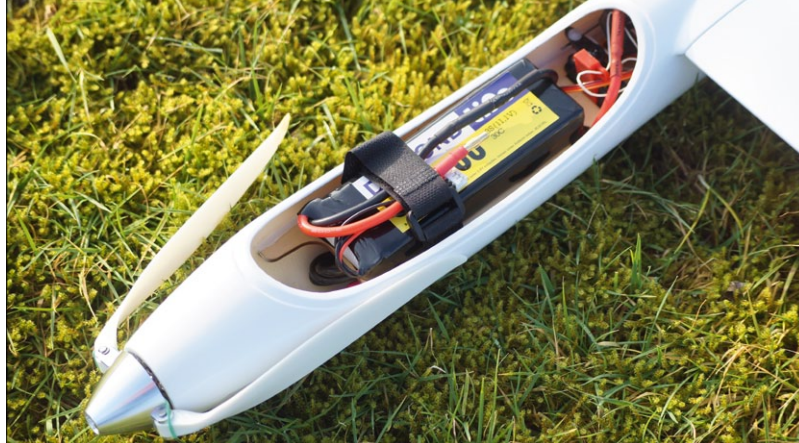
Unter der Kabinenhaube ist gerade Platz für den Akku vor dem Seitenruderservo. Das Klettband sichert den Akku effektiv
