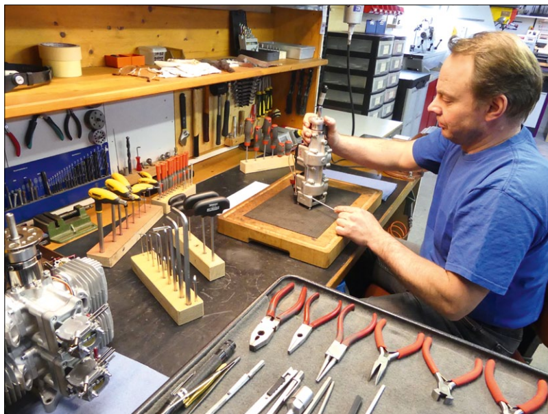
Steffen Zaun an seinem Montageplatz. Gerade unterzieht er einen 150er-Reihenmotor einer Jahres-Inspektion
