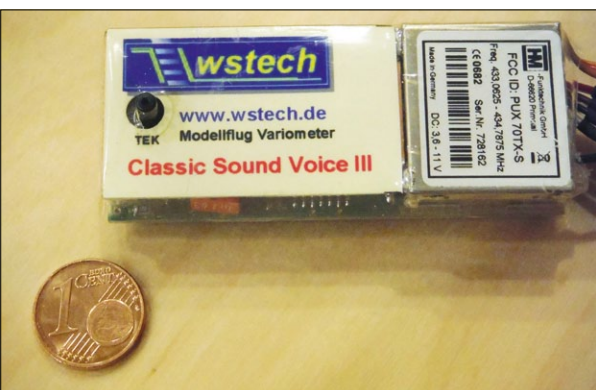
Abbildung 4: Ein einfaches Vario von WS-Tech – die Anfänge der Telemetrie
