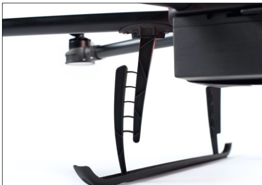
Das Landegestell des Kopters ist gefedert und garantiert ein sanftes Aufsetzen
