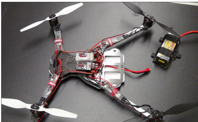
Der weitgehend fertig aufgerüstete Ninja. Die Motor-Controller sind direkt an den Armen angeflanscht, Empfänger und Flight-Controller sitzen auf der unteren Platine
