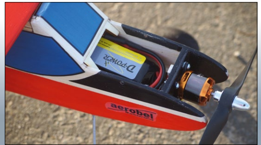
Eine Klappe in der Nase ist perfekt für einen schnellen Akkuwechsel im geräumigen Rumpf
