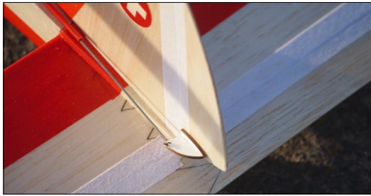
Ein Scharnier zwischen Leitwerk und Ruder haben wir in der Praxis durch ein funktionelles Klebefilm-Scharnier ausgetauscht
