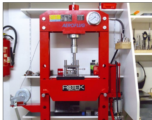
Die brandneue 30-Tonnen-Presse für weiterführende Arbeiten an Kurbelwellen. Gerade ist die Kurbelwelle eines 210-Kubik-Boxers in der Bearbeitung
