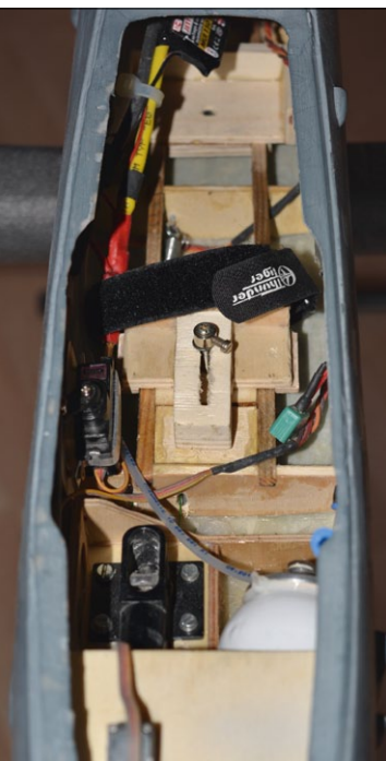
Innenraum des Rumpfs nach der Reparatur. Alles wieder wie vorher
