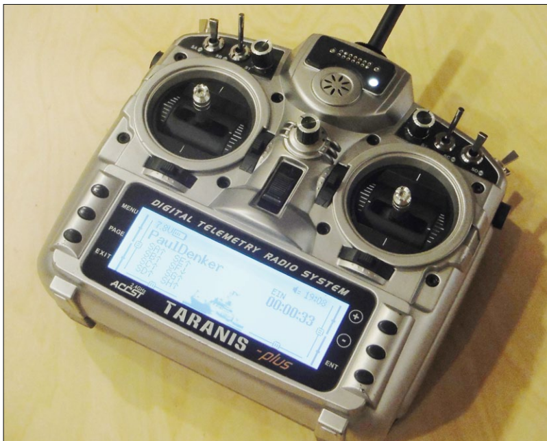
Abbildung 5: die „Taranis plus“ von FrSky ist ein Telemetrie-fähiger Sender, der die Messwertansage auf einfache Weise mittels OpenTX sehr praxistauglich ermöglicht
