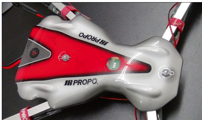
Mitgedacht: Die drei LED des Power-Board lassen sich durch ein klares Sichtfenster in der Karosserie einsehen. Die Befestigung der Haube erfolgt mittels Karosserie-Klammern
