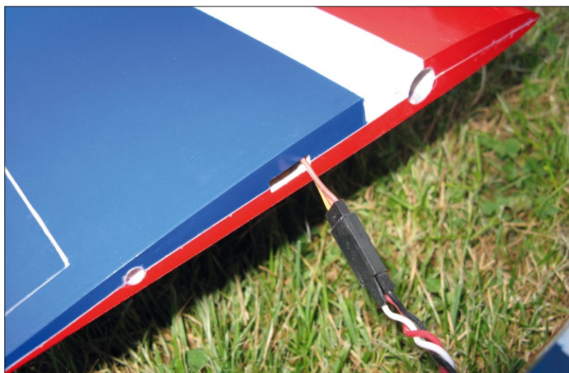
Die losen Stecker verschwinden gerne mal in der Fläche. Wen's stört, der sollte verklebte Steckverbinder in Eigenregie nachrüsten
