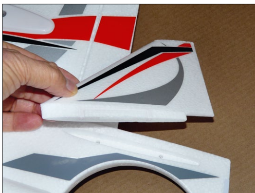
Für die Aufnahme (Verschraubung) der beiden starren Seitenleitwerke sind passgenaue Vertiefungen im Rumpfheck vorhanden
