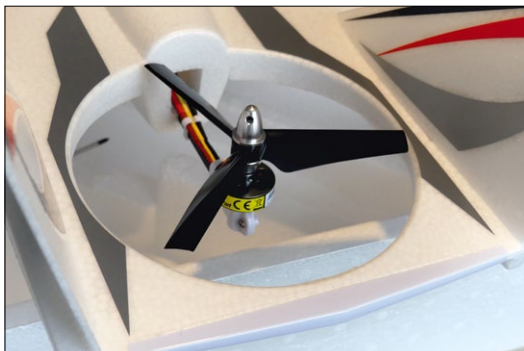
Der Heckpropeller ist bereits werkseitig montiert. Gut zu erkennen ist hier der Hartplastik-Kantenschutz am Rumpfende
