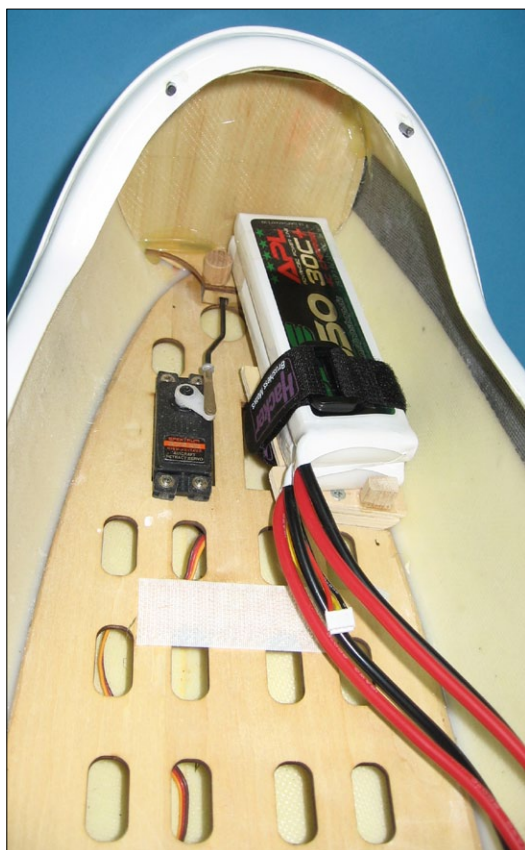
Blick in den ursprünglichen Seglerrumpf. Hinter dem Holzspant befanden sich über 1.000 Gramm Blei in der Nase, die jetzt gegen Motor und Akku ausgetauscht sind
