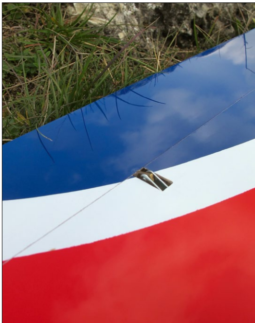
Die Wölbklappenanlenkung ist strömungsgünstig ausgelegt und weitgehend verdeckt
