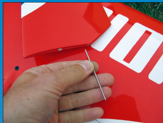
Vorsicht, der Leitwerksverbinder kann ganz in das Höhenruder eingeschoben werden
