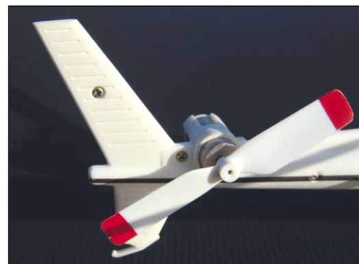
Die Heckausleger sind zwar an beiden Modellen unterschiedlich im Outfit, aber Antriebsmotor und Prop sind gleich
