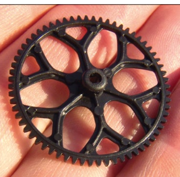
Das Hauptzahnrad der Einbau-Mechanik ist zwar filigran, aber durch die Versteifungsäste sehr robust konstruiert
