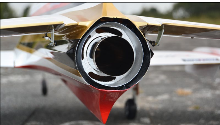
Äußerlich ändert sich am Avanti S auch nach Umbau auf Turbine so gut wie nichts – außer dem Ausgang. Hier kommt jetzt (sehr) heiße Luft heraus
