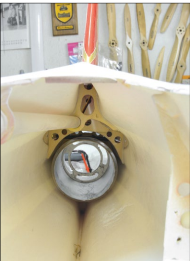
Das Schutzrohr mit Schubrohrhalterung wird angepasst
