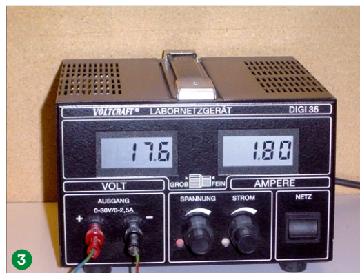
Ein regelbares Labornetzgerät stellt die Energie für die Aufheizung des Schneidedrahts bereit. Preisfrage: Wie lang ist der angeschlossene Schneidedraht? Richtig: 978 Millimeter
