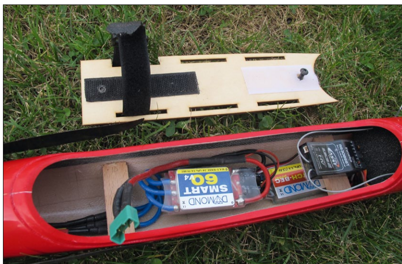
Sauber aufgeräumt lassen sich Regler und BEC unter dem Akkubrettchen platzieren
