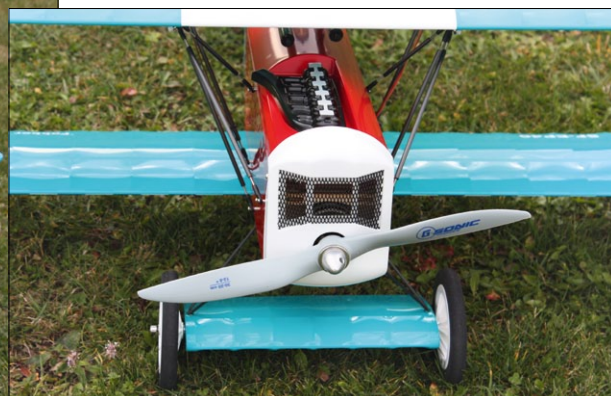
Nicht weniger typisch für Fokker-Flugzeuge ist die kleine Fahrwerksfläche
