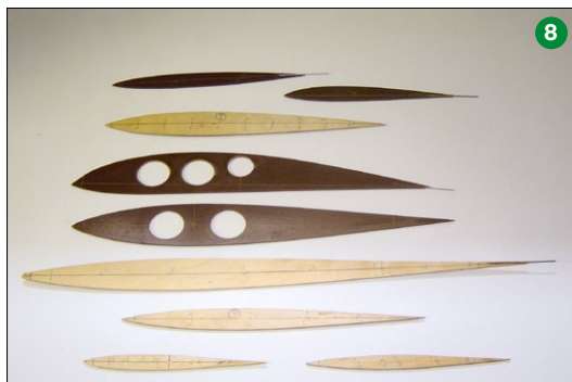
Aus verschiedenen Projekten sammelt sich eine Menge unterschiedlicher Musterrippen aus nicht wärmeleitenden Materialien an
