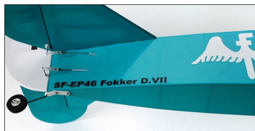
Und so ist die Flächenhalterung mit dem Rumpf verbunden
