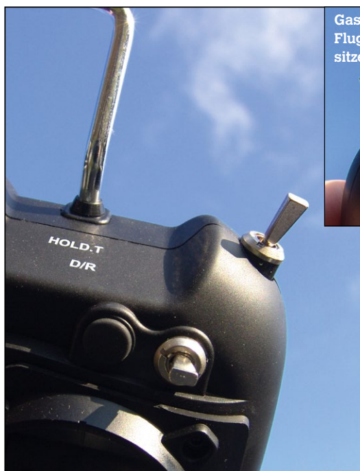
Rechts oben ist der Motor-Aus- (Hold.T) und darunter der Dual-Rate-Schalter
