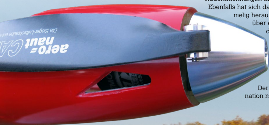
Hier lässt der Hyperion nichts anbrennen: Die Kühllöffnungen sind bestens dimensioniert
