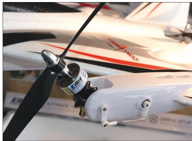
Beim Umschalten in den Flugzeug-Modus schwenken die beiden Hauptmotoren zuerst auf etwa 45° nach vorne, um dann nach kurzem Verweilen automatisch in die Horizontale zu gehen. Gleichzeitig wird die Steuerung der Höhen-/Querruder-Klappen aktiv geschaltet. Der Heckmotor ist in dieser Phase abgestellt. Umgekehrt sind im Multirotor-Flug die beiden Ruder außer Funktion und der Heckmotor in Betrieb
