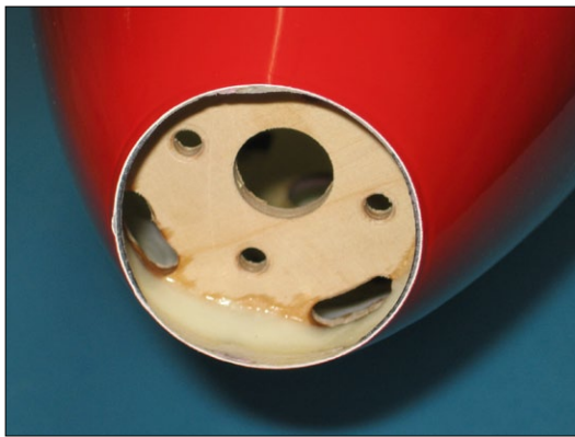
Der Motorspant wird mit eingedicktem Harz großflächig mit dem Rumpf verbunden, um eine optimale Kräfteinleitung sicherzustellen
