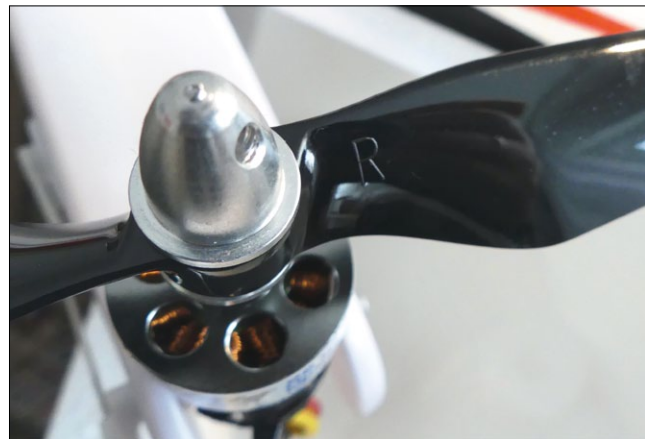
Die Propellerblätter der Hauptantriebe sind mit R und L gekennzeichnet. Sie dürfen nicht vertauscht werden, sonst fliegt das Modell nicht korrekt
