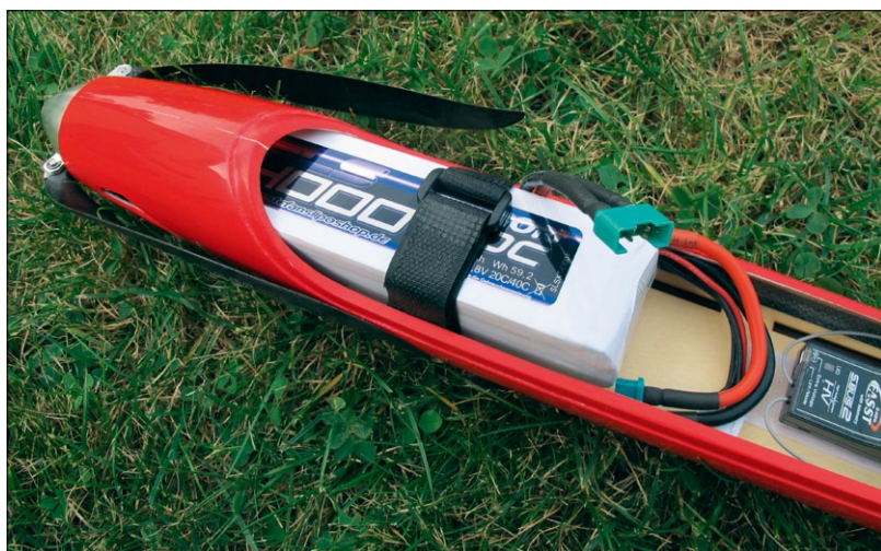
Der 4s-LiPo mit 4.000 Milliamperestunden Kapazität reicht für gut 5 Minuten Motorlaufzeit. Weiter hinten platziert ließe sich ein 5.000er-Akku nutzen
