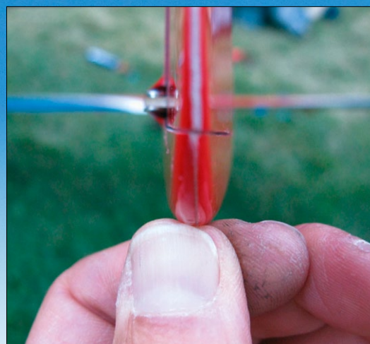
Vorsicht, der Leitwerksverbinder kann ganz in das Höhenruder eingeschoben werden
