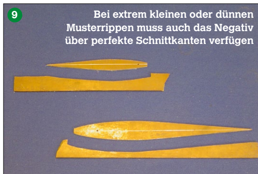
Die Auslaufzone für den Schneidedraht bildet ein stabiler Federstahldraht, der entweder auf die Musterrippe aufgeklebt oder eingelassen wird
