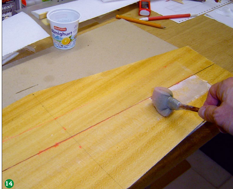
Auf der Innenseite der Beplankung sorgen Glasfaserinlays an den beanspruchten Stellen für die nötige Stabilität
