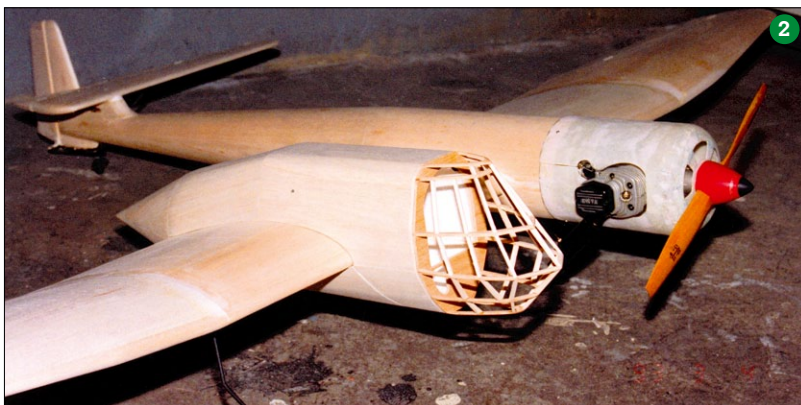
Die Zelle dieser Blohm & Voß 141 B mit einer Spannweite von 1.800 Millimeter besteht komplett aus balsabeplankten Styroporsteinen
