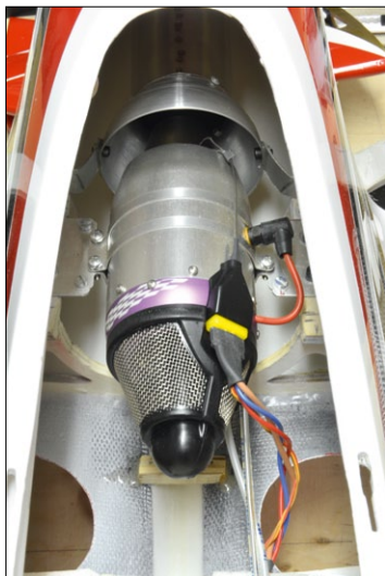
Der Turbinenauslass ragt etwa 17 Millimeter in den Trichter
