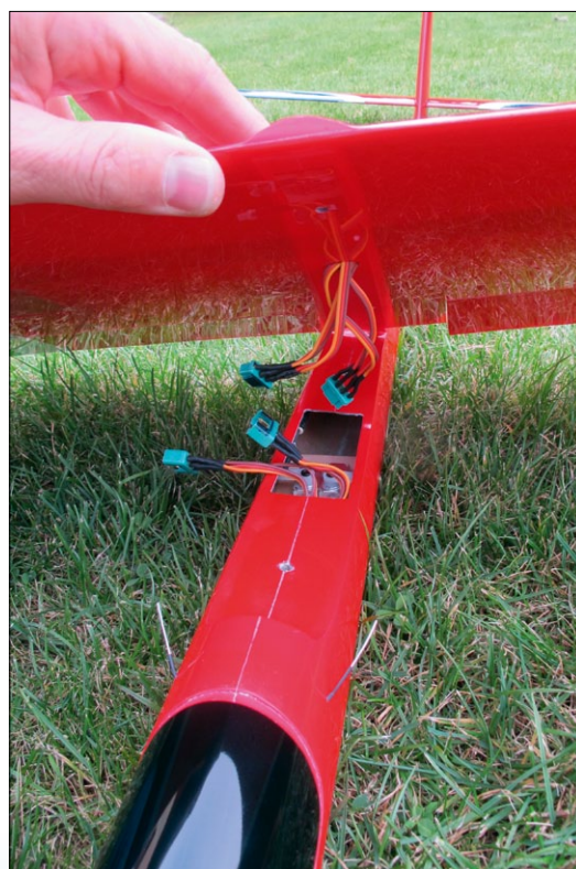
Beim Zusammenbau ist auf die korrekte Kontaktierung zu achten. Farbliche Markierungen helfen, Fehler zu vermeiden
