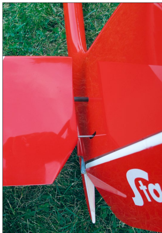
Die Leitwerkssteckung ist passgenau und spielfrei
