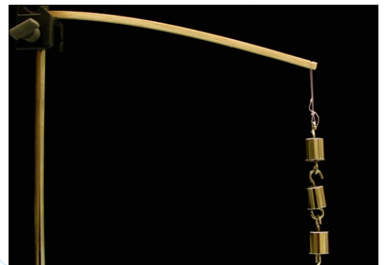
Abbildung 8: Die Durchbiegung einer dicken Fläche (a) fällt bei ansonsten gleicher Konstruktion und Belastung deutlich geringer aus als bei einer dünnen (b) – hier am vereinfachten Modell zweier nahezu massengleicher Holme dargestellt
