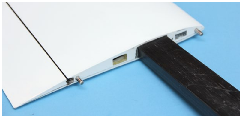
Der Außenflügel verfügt über einen sehr kräftig dimensionierten Flächenverbinder. Die Torsionsstifte sind ab Werk passgenau eingebaut
