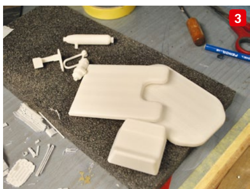
1) Zahlreiche Elemente für den Cockpitausbau sind von einem 3D-Drucker gefertigt worden und stammen von Iflytailies. 2) Farbabbildungen helfen bei der realistischen Gestaltung von Instrumentierung und anderem. 3) Die 3D-Druck-Teile sind zunächst zu entgraten. 4) Fertig verklebt ist der Detailgrad sehr überzeugend. 5) Nach dem Lackieren steigert sich der Gesamteindruck nochmals
