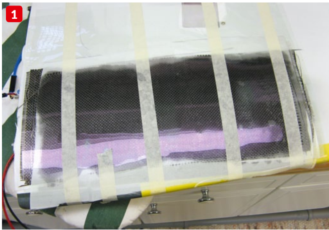
1) Zum sphärischen Abformen der Fahrwerksschachtdeckel dient die Fläche als Positiv. Feste, dünne Klarsichtfolien verhindern ein Verkleben der CFK-Gewebelagen mit dem Flügel. 2) Die Kontur wird mit Stift und Papier abgepaust, auf den Deckel übertragen und dieser dann mit etwas Übermaß zugeschnitten – das Anpassen erfolgt anschließend
