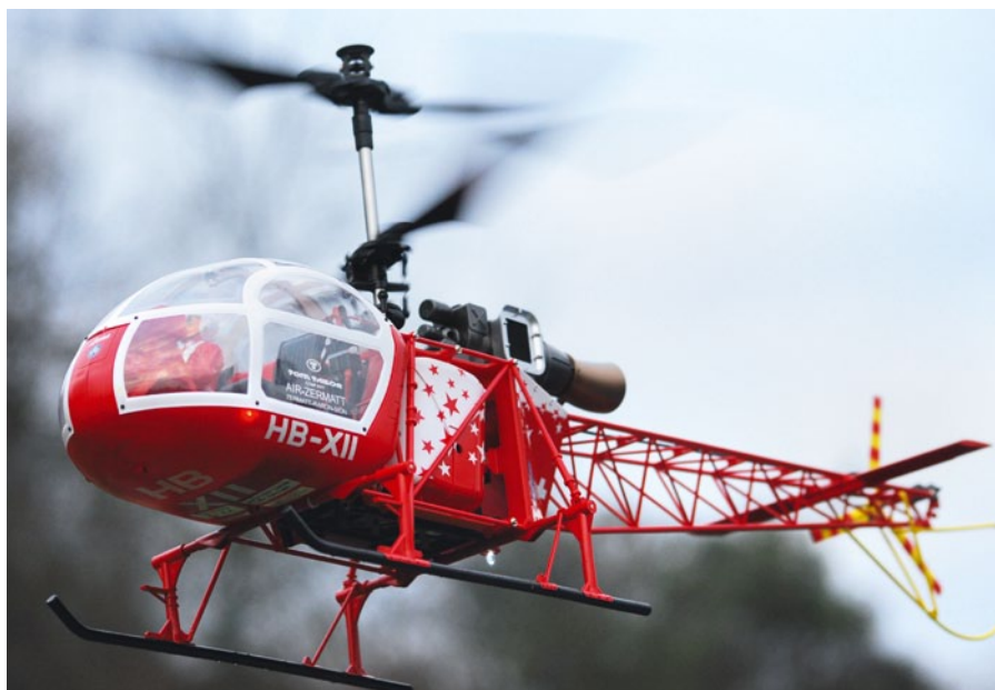
4) Bei einem Koaxial-Hubschrauber liegen beide Rotoren übereinander, wie bei diesem Modell einer Lama SA-315, dessen Vorbild jedoch mit Heckrotor ausgerüstet war
