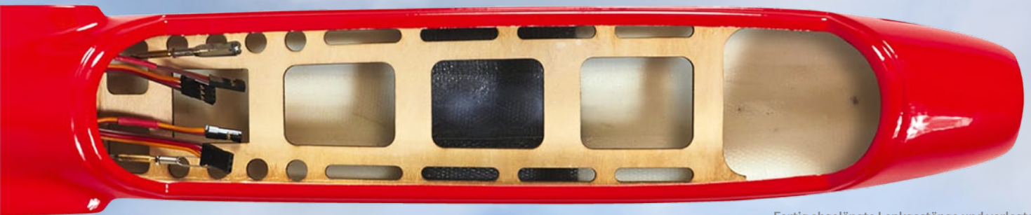
Fertig abgelängte Lenkgestänge und verlegte Servokabel verkürzen die Montagezeit
