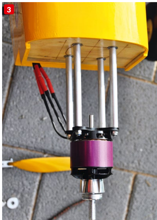
1) Der Motorträger diente als Schablone für die GFK-Verstärkung der Befestigung am Brandschott
