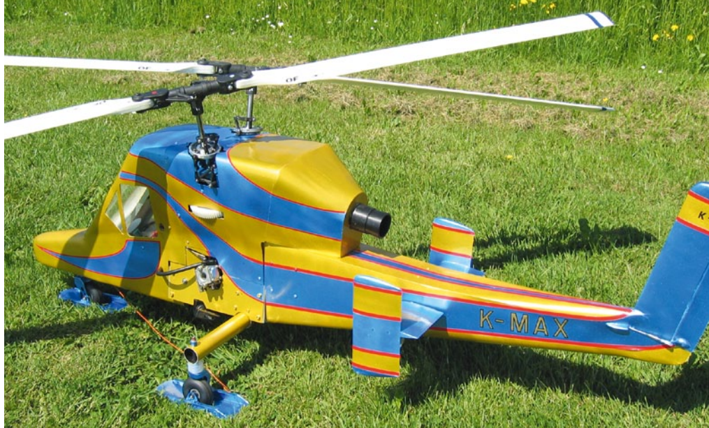
3) Ein nach dem Flettner-Prinzip gebauter Heli, hier der Eigenbau K-Max von Ernst Wieland, hat einen Doppelrotor um den Drehimpuls auszugleichen (Foto: Ernst Wieland)
