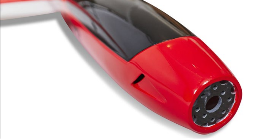
In der Rumpfnase können 35er- und 42er-Motoren eingebaut werden
