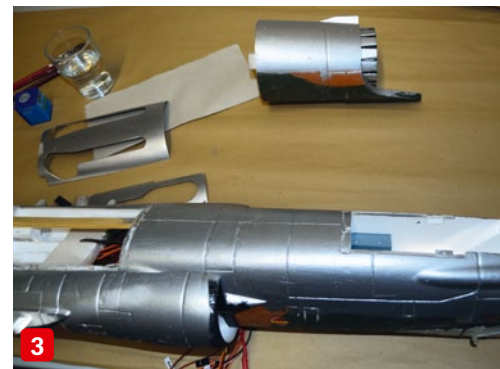
1) Die teilweise sehr grobporige Oberfläche des EPS-Schaums wird zunächst mit einer Schicht Leichtspachtel abgezogen. 2) Der Leichtspachtel wird hierzu mit etwas Wasser verdünnt und komplett aufgetragen. 3) Nach dem Verschleifen kann der erste Lackauftrag erfolgen. Der Aluminium-Farbtönen macht aber auch die eine oder andere Delle sichtbar. Das lässt sich trotz Vorsichtsmaßnahmen nicht ganz vermeiden
