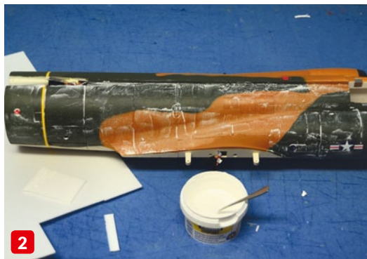
1) Die teilweise sehr grobporige Oberfläche des EPS-Schaums wird zunächst mit einer Schicht Leichtspachtel abgezogen. 2) Der Leichtspachtel wird hierzu mit etwas Wasser verdünnt und komplett aufgetragen. 3) Nach dem Verschleifen kann der erste Lackauftrag erfolgen. Der Aluminium-Farbtönen macht aber auch die eine oder andere Delle sichtbar. Das lässt sich trotz Vorsichtsmaßnahmen nicht ganz vermeiden
