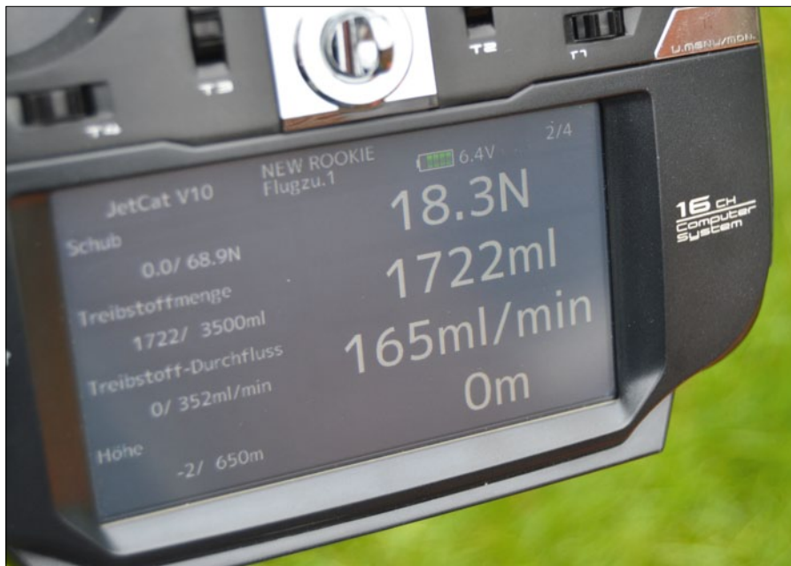
Neben den „normalen“ Turbinendaten, wie Drehzahl und Temperatur, lassen sich unter anderem auch Schub und Treibstoffverbrauch anzeigen. Schön, dass das Display so gut ablesbar ist
