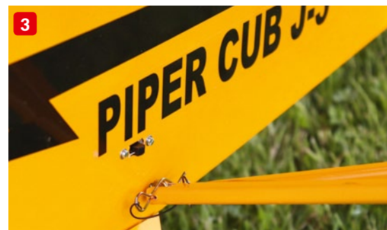
1) Aus rot lackierten Joghurtbecherdeckeln entstanden die für die Piper-Räder typischen Felgen. 2) CFK-Ruderhebel aus dem eigenen Fundus sorgen für einen einwandfreien Ruderbetrieb. 3) Die Streben haben eine rein optische Funktion und können daher für eine schnelle Montage mit Splinten gesichert werden
