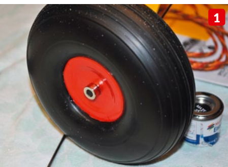
1) Aus rot lackierten Joghurtbecherdeckeln entstanden die für die Piper-Räder typischen Felgen. 2) CFK-Ruderhebel aus dem eigenen Fundus sorgen für einen einwandfreien Ruderbetrieb. 3) Die Streben haben eine rein optische Funktion und können daher für eine schnelle Montage mit Splinten gesichert werden
