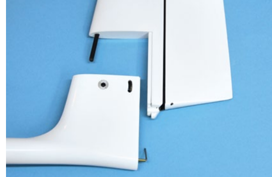
Das Seitenruder ist gesteckt und kann zum Transport abgenommen werden. Oben wird es mit einem Stift gehalten, unten wird es in einer Nut geführt. Das Seitenruder wird beim Zusammenbau automatisch mit angelenkt
