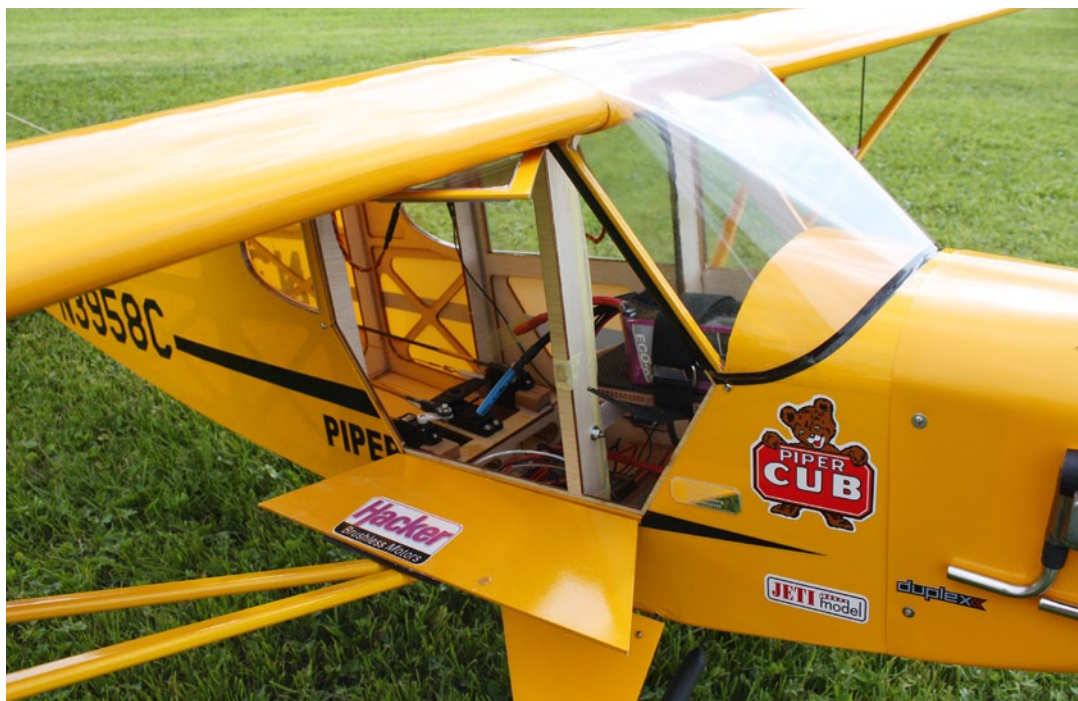
Dank der beiden Türenklappen ist die Zugangsöffnung üppig geraten, was den Akkuwechsel erleichtert
