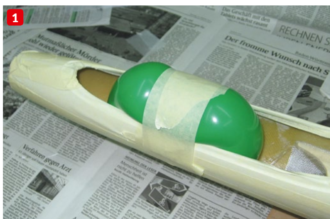
1) Um den Klettverbinder für den Antriebsakku mit Glasfasergewebe im Rumpfboden zu befestigen, haben wir uns der Ballon-Methode bedient. Durch den Druck des Ballons wird das Gewebe schön gleichmäßig an den Rumpfboden gedrückt und sorgt so für eine optimale Verklebung. 2) Die Anlenkung der großen Wölbklappen erfolgt über stabile 2-Millimeter-Fahrradspeichen statt klassischem Draht
