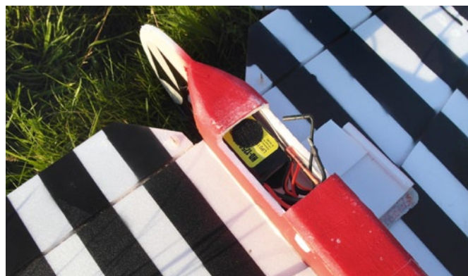
Mit dem Akku wird der Schwerpunkt eingestellt
