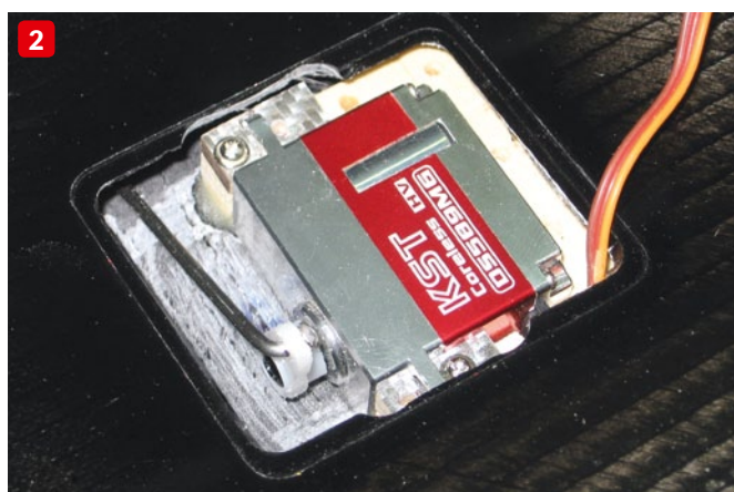
1) Um den Klettverbinder für den Antriebsakku mit Glasfasergewebe im Rumpfboden zu befestigen, haben wir uns der Ballon-Methode bedient. Durch den Druck des Ballons wird das Gewebe schön gleichmäßig an den Rumpfboden gedrückt und sorgt so für eine optimale Verklebung. 2) Die Anlenkung der großen Wölbklappen erfolgt über stabile 2-Millimeter-Fahrradspeichen statt klassischem Draht
