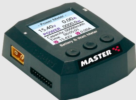
Das Master Akku Power Meter dient mit seinem hochauflösendem TFT Farbdisplay zur Kontrolle von 1s- bis 8s-LiPo-Akkus. Es misst die Leistung eines Antrieb und testet sowie balanciert Akkus. Auf der rechten Seite des 78 x 67 x 27 Millimeter messenden und 73 Gramm schweren Power Meter befindet sich ein USB-Ausgang, an dem USB-Geräte geladen werden können. Der Preis: 37,95 Euro. [www.pichler-modellbau.de](http://www.pichler-modellbau.de)
