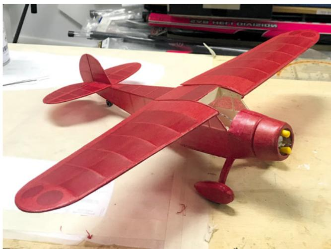
Es entstanden zwei Modelle. Hier der zweite Nachbau mit rotem Bespannpapier und veränderter Einstellwinkeldifferenz
