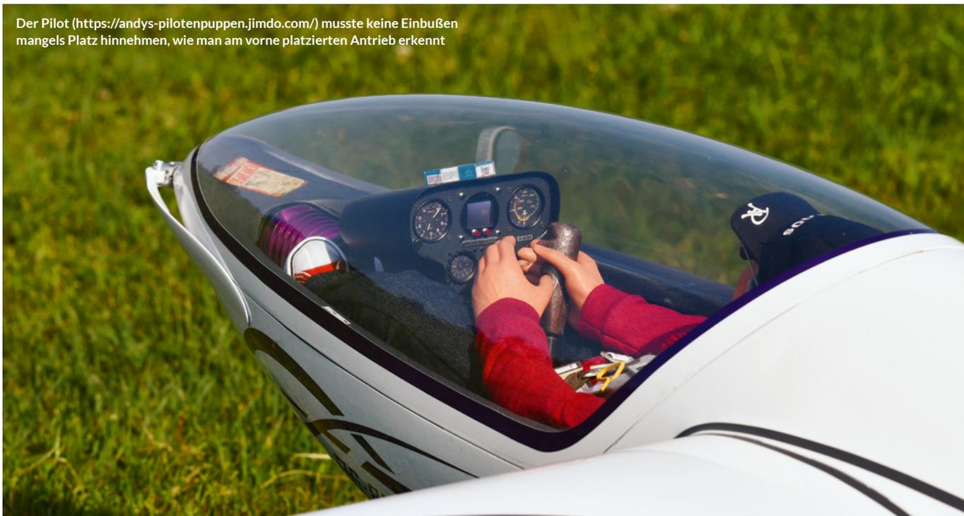
Antrieb ausgeschaltet und als Erstes die Schwerpunktage überprüft. Beim Anstechen bleibt sie im angesteuerten Bahnneigungswinkel, also muss der Akku noch ein wenig nach vorne, was aber kein Problem ist. Zudem will sie leicht getrimmt werden, aber sonst läuft alles perfekt. Thermik ist an diesem Tag keine vorhanden, somit wird abgeglitten und das Flugbild genossen.
