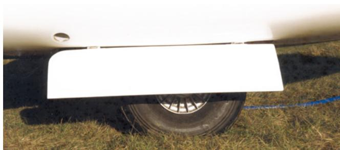
Das ungefederte Fahrwerk wurde als Einziehfahrwerk konstruiert
