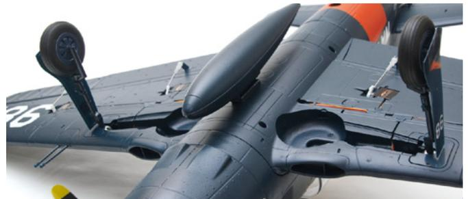
In allen Arrows-Modellen, so wie hier bei der F8F Bearcat, sind elektrische Einziehfahrwerke verbaut
