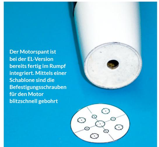
Der Motorspant ist bei der EL-Version bereits fertig im Rumpf integriert. Mittels einer Schablone sind die Befestigungsschrauben für den Motor blitzschnell gebohrt
