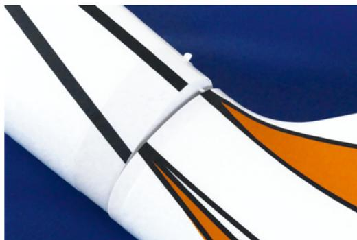
Zur sicheren Verbindung der Rumpfteile ist ein Bajonett-Verschluss eingearbeitet. Darum muss das Leitwerksteil mit etwa 5 Grad um die Rumpf-Mittelachse verdreht in die Bajonett-Gegenseite eingeführt und dann nach links bis zum automatischen Einrasten des Sicherungsstifts gedreht werden
