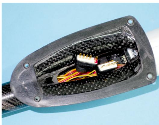
Das hintere CFK-Rohr ist vom Hersteller mit dem vorderen Rumpfteile verklebt. Darum war ein Teil vom oberen Rohr nachträglich auszufräsen, um Platz für Stecker und Kabel der Flächenservos zu schaffen. Die Kabel sollten aufgrund der Platzverhältnisse nicht zu lang sein
