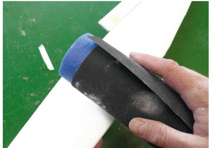
Die Nasenleiste ist zuerst mit dem Cutter in Form zu bringen und abschließend mit einem Schleifklotz zu verschleifen
