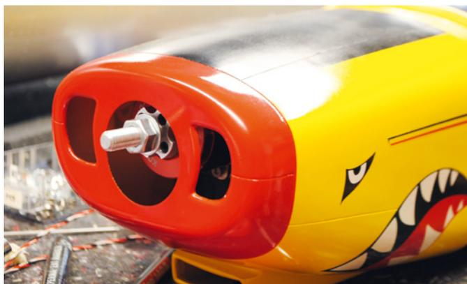
Leider muss an der Lage des Motors etwas verändert werden, sonst kommt die Achse nicht mittig aus der Cowling
