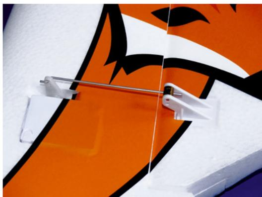
Der Servo-Deckel fluchtet nicht hundertprozentig mit der Oberfläche der Finne. Das betrifft aber alle sechs Servo-Deckel rundum. Quasi der einzig erwähnenswerte optische Makel des Modells, der aber nur hier am Seitenleitwerk sichtbar ist
