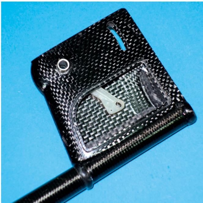
Der Leitwerksträger beinhaltet ab Werk die Aufnahme für das Seitenruder und den Pendelruderhebel
