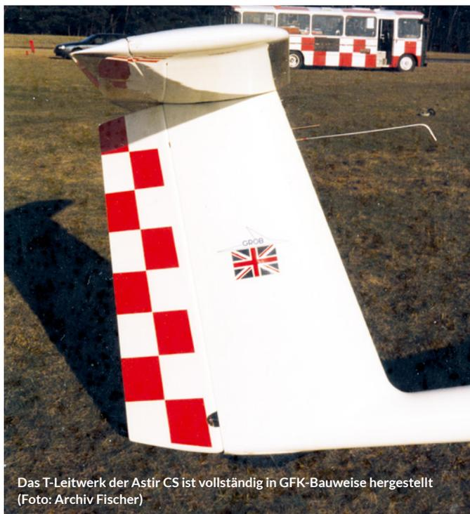
Das T-Leitwerk der Astir CS ist vollständig in GFK-Bauweise hergestellt
