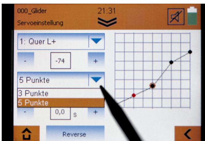
Durch Antippen der Wegekurve im Servomenü öffnet sich ein erweitertes Menü, welches dann die Fünfpunkt-Kurve und die Slow-Funktion zur Verfügung stellt
