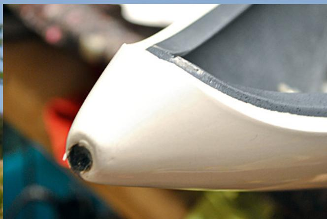
In der Nasenspitze ist einzig ein 12 Millimeter großes Loch einzubringen, aus der später die Propellerwelle ragt
