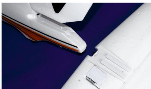
In der Nase der Finne und in der Aufnahme am Rumpf ist die Servo-Steckverbindung fertig eingebaut. Ergebnis: Leitwerk in den Rumpfausschnitt einschieben bis der Sicherungsstift einrastet, fertig
