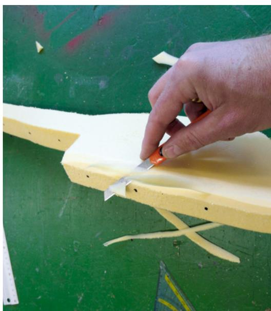
Nach dem Aussägen der Kontur wird der Rumpf erst grob in Form geschnitzt und die Kanten dann verschliffen
