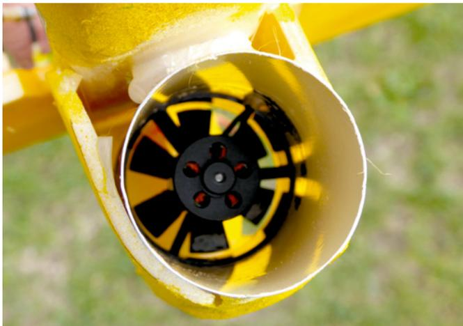
Schon mit einem 30-Millimeter-Impeller fliegt die Pinto sehr gut
