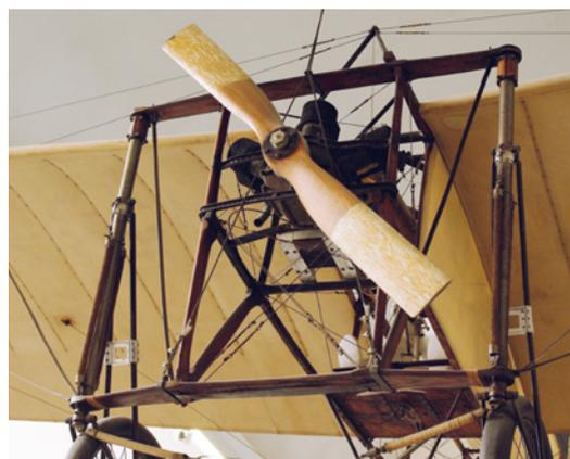
Abbildung 4: Der Motor der Bleriot XI war kaum stark genug, um den Widerstand der Verspannung zu kompensieren
