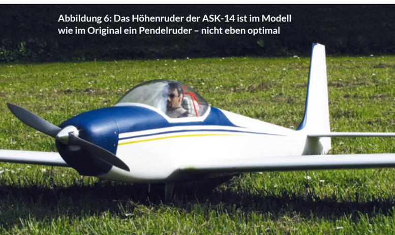
Abbildung 6: Das Höhenruder der ASK-14 ist im Modell wie im Original ein Pendelruder – nicht eben optimal
