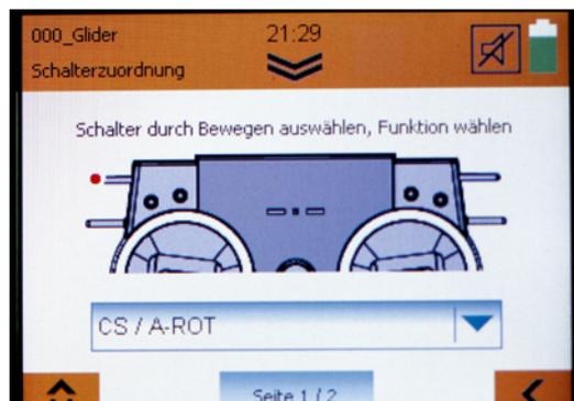
Um die Schalterbelegung zu ändern, wird dieser bewegt und im Drop-Down Menü angezeigt
