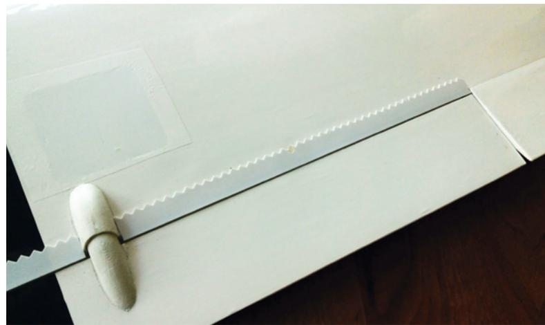
Abbildung 9: Eine Spaltabdeckung, die gleichzeitig als Turbulator dient
