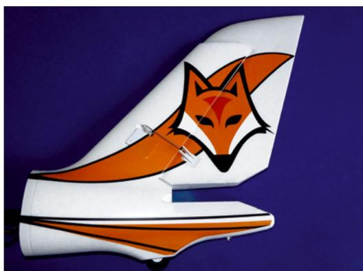
Das hintere Rumpfsegment ist ebenfalls voll bestückt und montagefertig. Durch die Platzierung des Servos in der Seitenfinne kann die Anlenkung des Ruders auf kürzestem Weg erfolgen
