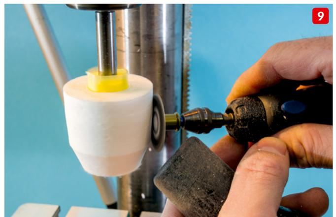
Insbesondere bei der Bearbeitung des weichen Styropors ist ein grober Minifräse-Schleifteller der entscheidende Hinweis. Mit einem Staubsauger hält sich der angekündigte Schneesturm in Grenzen, und wir arbeiten uns mit wenig Druck und viel Feingefühl an die Wunschkontur heran. Mit einem groben Schleifklotz oder einer Feile muss dabei auch die spätere Auflagefläche plan bearbeitet werden (9).
