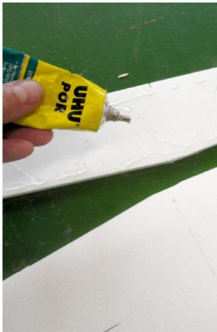
Grundplatte und Profilstufe des Flügels werden mit Uhu Por verklebt
