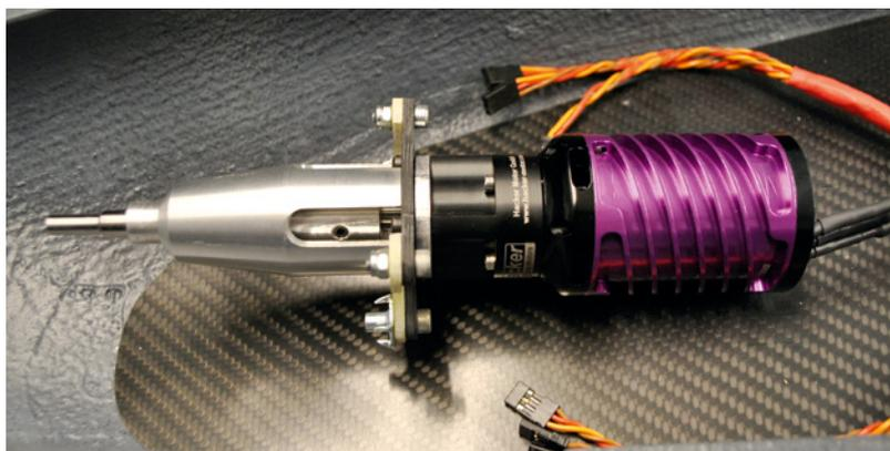
Mit dem Hacker Getriebe-Antrieb ist eine große Luftschraube möglich, die für genügend Zug sorgt
