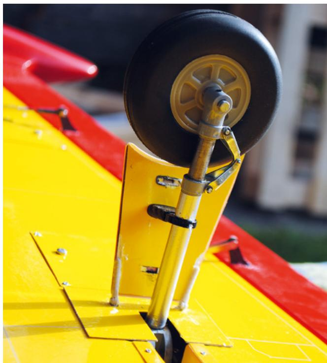
So sieht dann das fertige Einziehfahrwerk mit den Verkleidungen aus
