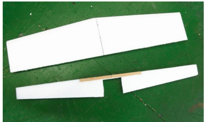
Eine 5 x 5-Millimeter-Hartholzleiste verbindet die Höhenruderrhälften
