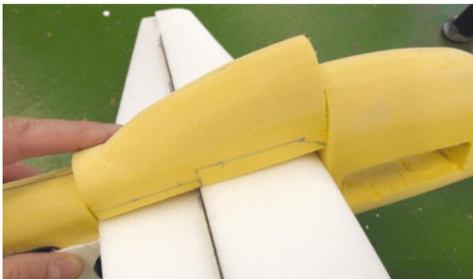
Das vorübergehend entfernte Rumpfteil wird zur Flügelmontage angepasst
