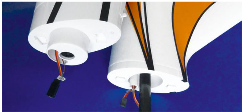
Vor dem Zusammenstecken der beiden Rumpfteile muss erst das mitgelieferte, kurze CFK-Rohr in eine der Aufnahmen gesteckt werden. Mit dieser Zwangsführung lassen sich die Bauteile bestens zusammenfügen
