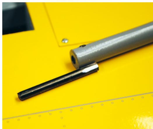
Die Mechaniken der Hauptfahrwerke müssen mit Gewinden versehen werden. Das sollte der Hersteller in Zukunft ändern
