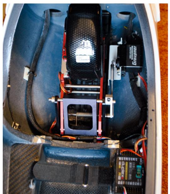
Der Magnet wird an der Motorwelle befestigt, in unserem Fall an der Alu-verlängerung der Motorverlängerung. Dafür bohrte ich hier ein 2,5 mm großes Loch, um den Magneten darin zu versenken. Uhu Endfest gemischt mit ein wenig Aluminiumpulver sorgt für Halt. Der gegenüberliegende Sensor, der später nach dem Magneten tastet, wird auf ein Stück GFK geklebt und dieses dann zirka 1 mm über der Magnetposition in einer Öffnung in der Wellenverlängerung befestigt.
