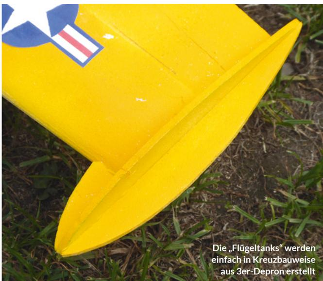
Die „Flügel tanks“ werden einfach in Kreuzbauweise aus 3er-Depron erstellt
