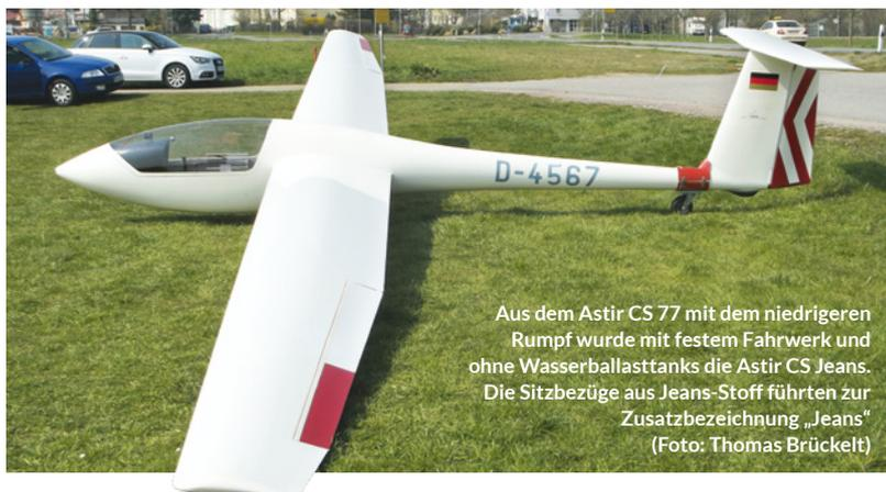
Aus dem Astir CS 77 mit dem niedrigeren Rumpf wurde mit festem Fahrwerk und ohne Wasserballasttanks die Astir CS Jeans. Die Sitzbezüge aus Jeans-Stoff führten zur Zusatzbezeichnung „Jeans“ (Foto: Thomas Brückelt)
