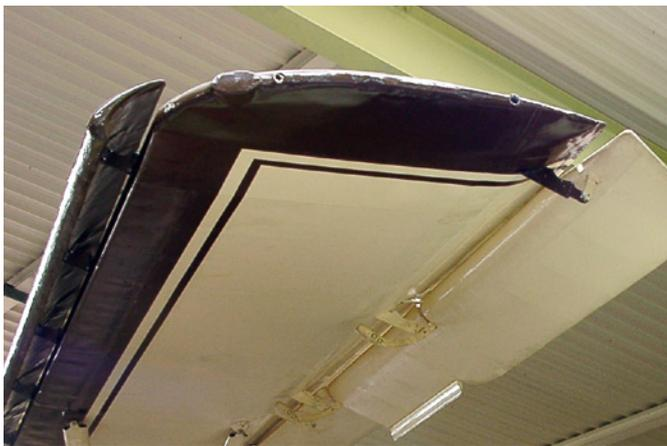
Abbildung 13: Der Fieseler Storch hatte Spaltklappen mit einer sehr hohen Ruder- beziehungsweise Wölbklappenwirkung
