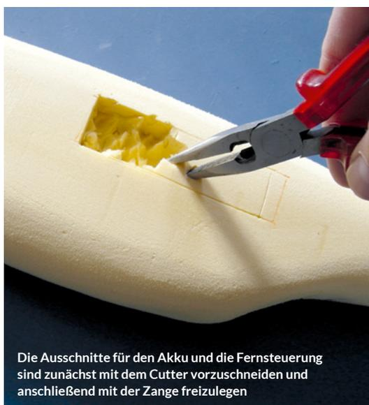
Die Ausschnitte für den Akku und die Fernsteuerung sind zunächst mit dem Cutter vorzuschneiden und anschließend mit der Zange freizulegen
