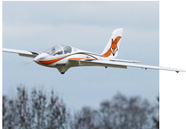
Mit voll ausgefahrenen Wölbklappen kann relativ hoch zum Landen angefliegen werden, denn die Bremswirkung ist enorm. Reicht es nicht bis zum Platz, wird mal kurz mit Motorkraft nachgeholfen
