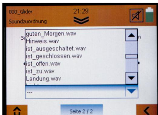
Nachdem eine neu zugeordnete Funktion ausgewählt wurde, kann auf Seite 2 der Schalterzuordnung eine Sprachausgabe zugeschrieben werden
