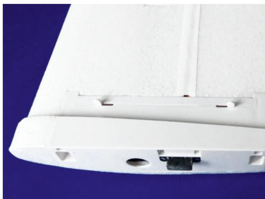
Die Tragflügel sind ebenfalls komplett vorgerüstet. Auf der Unterseite sind die beiden Riegel zu sehen, die für die Demontage des Flügels nur in Richtung Profilmittle geschoben werden müssen
