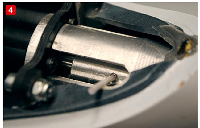
3) Der Sensor sitzt unmittelbar über dem Magneten und tastet dessen Position ab. Stimmt diese überein, hört der Motor auf zu drehen und arretiert damit den Propeller in gewünschter Position. 4) Mit dem Hilfstoß ließ sich der Magnet optimal einkleben
