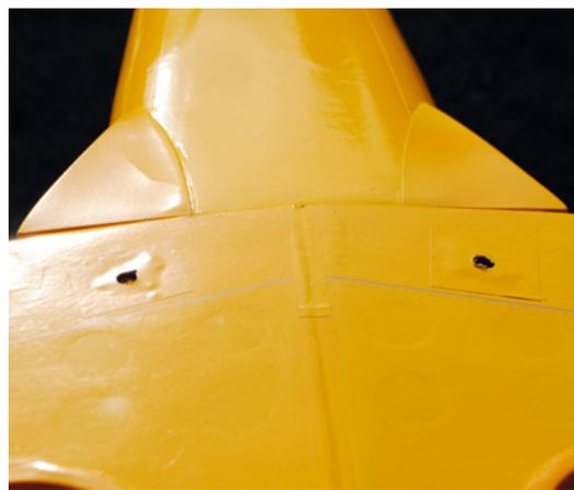
Die sehr großen Löcher für die Flächenverschraubung konnten mit Folie verkleidet werden
