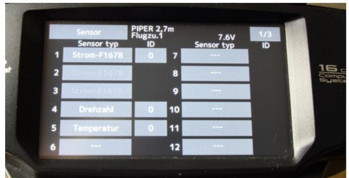
Fünf Zeitschlitze werden für den SparkSwitch-Pro benötigt, wenn dieser in einer Futaba-Telemetrie-Umgebung arbeiten soll
