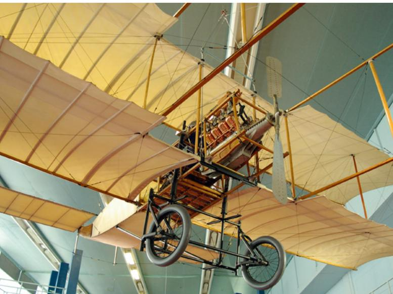
Abbildung 5: Eine filigran gebaute Rippenfläche eines Doppeldeckers
