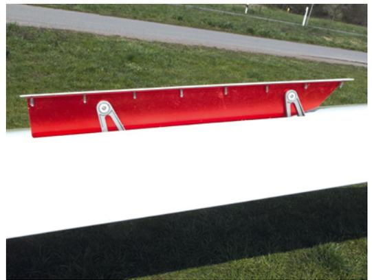
Die Bremsklappen nach dem System Schempp-Hirth fahren nur nach oben aus der Tragfläche aus (Foto: Thomas Brückelt)
