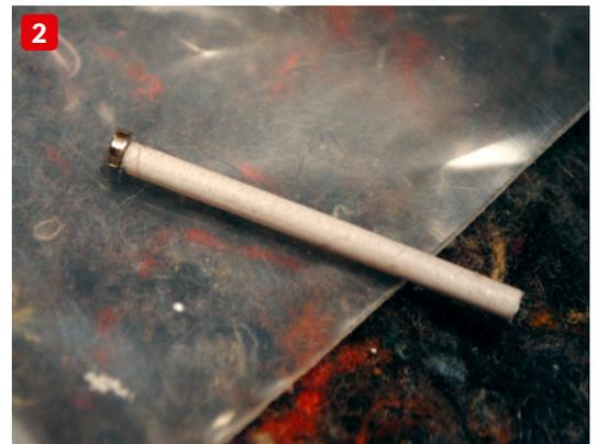
1) In den Adapter beziehungsweise dem Wellenaufsatz ist ein Loch zur Aufnahme eines Sensor-Magneten zu bohren
