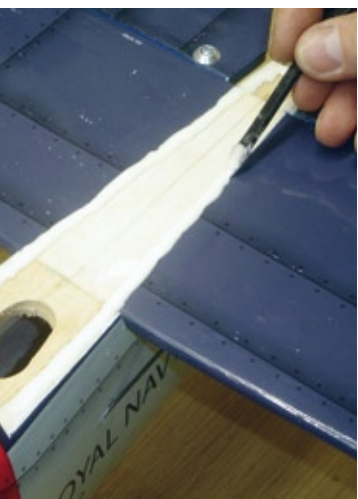
Das Seitenleitwerk wird mit andicktem Epoxyd-Kleber auf den Rumpf gesetzt
