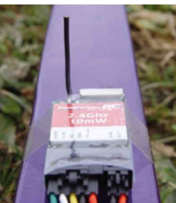
Um das Gewicht der Kamera auszugleichen, ist der Videosender im hinteren Bereich der Rumpfs angebracht
