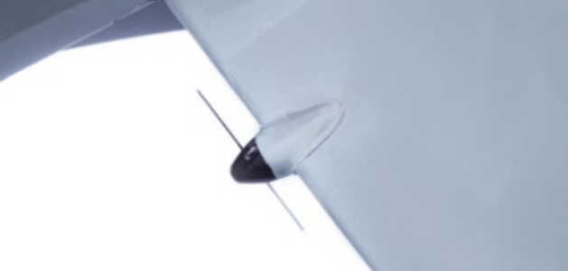
An der Nasenleiste des Höhenruders werden aus Kunststoffteilen und 1-mm-Stahldraht die Antennen nachgebaut. Das Material dazu gehört zum Bausatz
