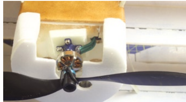
Der Motor mit Trägerplatte ist zudem auf eine Depronplatte angeklebt
