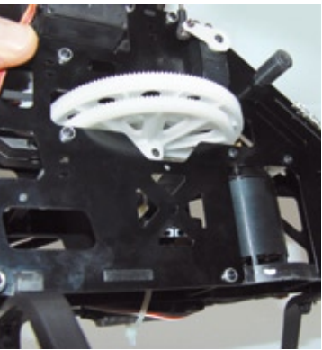
Frontseitig sind im Alu-Chassis der Motor und das einstufige Hauptgetriebe mit dem getrennten Heckrotor-Antriebszahnrad eingelassen
