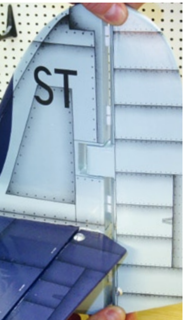
Das große Seitenruderblatt wird mit vier Vliesscharnieren angeschlagen
