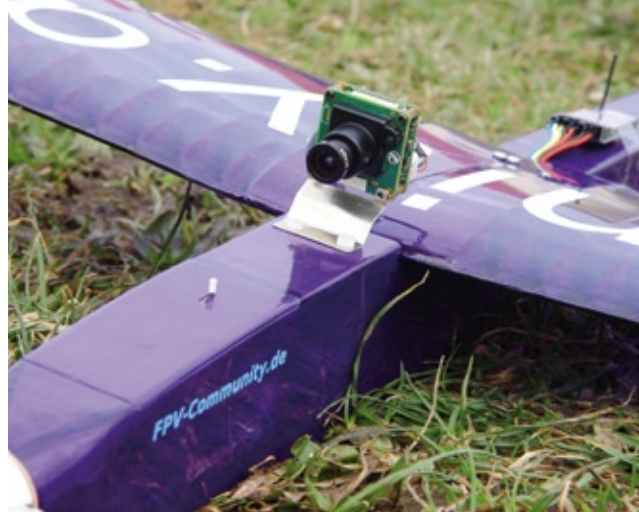
Der Umbau: Die Kamera wird dem Halter mittels zweier Nyloenschrauben auf das Modell geschraubt
