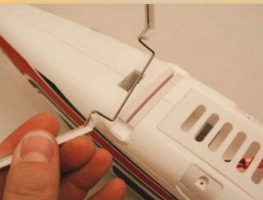
Die Montage des Tragflächenfahrwerks gestaltet sich problemlos
