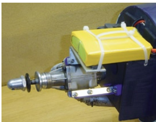
Doppelte Empfängerstromversorgung erfolgt durch zwei LiPos, die gegen Öl geschützt unter der Cowling liegen
