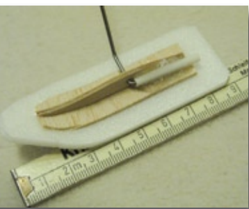
Das Kufengestell gleicht von der Geometrie dem Originalfahrwerk
