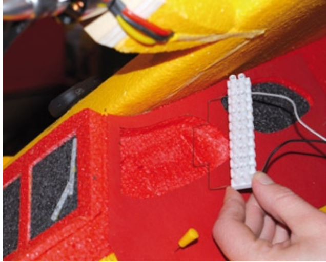
Mit einem heißen, in Form gebogenen Draht werden die Vertiefungen für die Scheiben ausgeschnitten. Die schwarze EPP-Scheibe wird einfach in die Öffnung geklemmt
