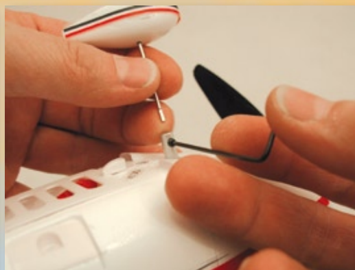
Die Madenschraube greift nur wenig und ist abzuflachen
