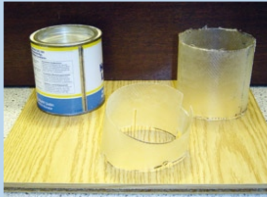
Für die Versiegelung der Fahrwerksschächte werden Inlays aus GFK gefertigt. Als Form dient eine Lackdose
