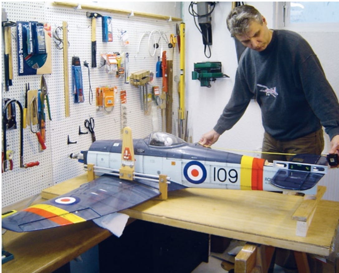
Vor dem Verkleben der Leitwerksflächen wird die Sea Fury ausführlich vermessen
