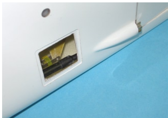
Durch den vorgegebenen Schwerpunkt ist es eng im Rumpf. Der Regler sitzt direkt auf dem Antriebsakku
