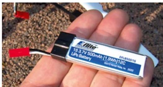
Zur Bordstromversorgung dient ein einzelliger LiPo-Akku mit einer Kapazität von 500 Milliamperestunden
