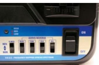
**Mit den Schaltern am Sender kann die Drehrichtung der Servos umgekehrt werden**
