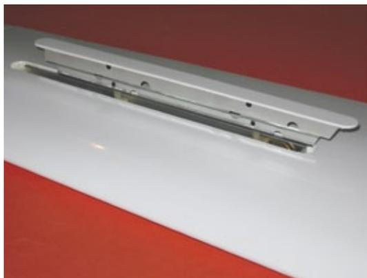
Die Störklappen sind flugfertig eingebaut und mit Abdeckungen versehen
