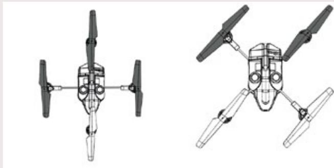
Prinzip der möglich Konfigurationen für „Vorne“: links der „+-Modus“, rechts der „X-Modus“
