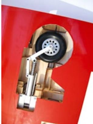
**Nach wenigen Modifikationen passt das optionale Einziehfahrwerk in den Schacht**
