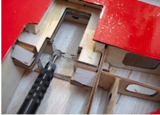
**Ein Dremel mit flexibler Welle hilft, die Engstelle an den Fahrwerksaufnahmen zu beseitigen**
