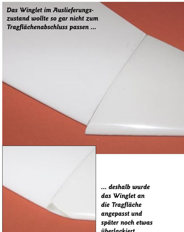
... deshalb wurde das Winglet an die Tragfläche angepasst und später noch etwas überlackiert
