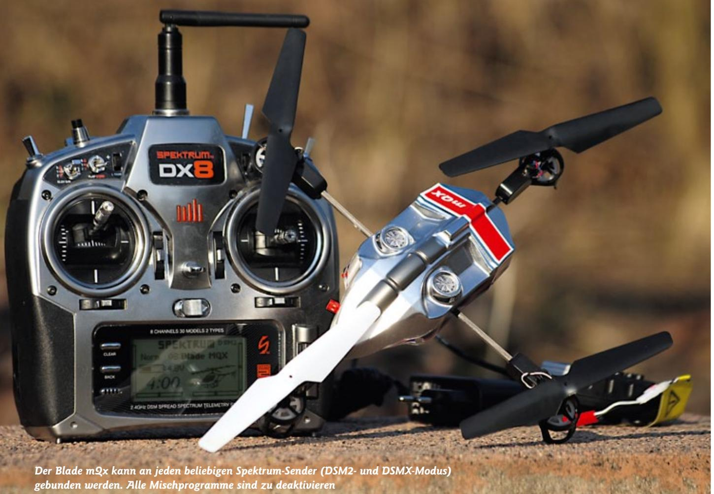
*Der Blade mQx kann an jeden beliebigen Spektrum-Sender (DSM2- und DSMX-Modus) gebunden werden. Alle Mischprogramme sind zu deaktivieren*
