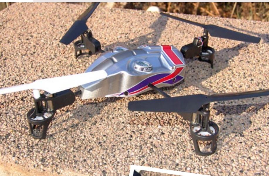
Blade mQx in der so genannten +-Konfiguration mit einem Motor für Vorne (weiße Luftschraube)
