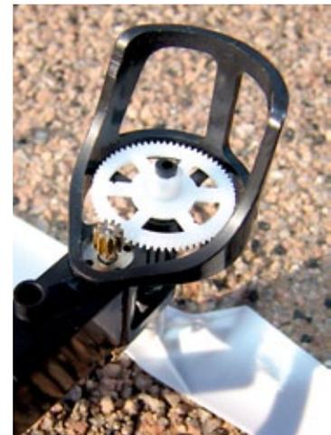
Der Antrieb der Rotorwelle erfolgt über ein einstufiges Getriebe, bestehend aus Messingritzel und Kunststoff-Hauptzahnrad
