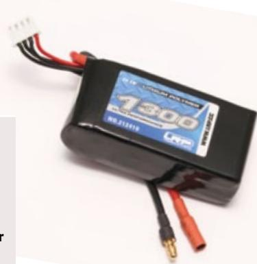
**Der beiliegende 1.300er-LiPo ermöglicht ausreichend lange Flugzeiten**
