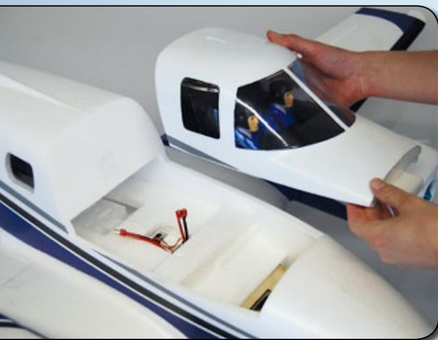
Alle Kabel werden zentral an einem Punkt im Rumpf zusammengeführt
