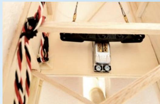
**Das Savöx-Seitenruderservo, erhältlich bei [www.rc-dome.de](http://www.rc-dome.de), ist relativ weit hinten im Rumpf platziert**
