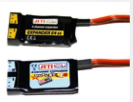
**Achtung: Alte Duplex-Expander (unten) degradieren neue Duplex-EX-Telemetriesensoren zu Messfühlern der ersten Generation. Wer in neue EX-Sensoren investiert, sollte deshalb gleich neue EX-Expander (oben) anschaffen**
