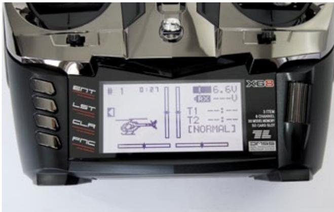
Das Display ist gut ablesbar. Über vier Taster und einen Roll-Druck-Taster (rechts) scrollt man durchs Menü und programmiert das Modell
