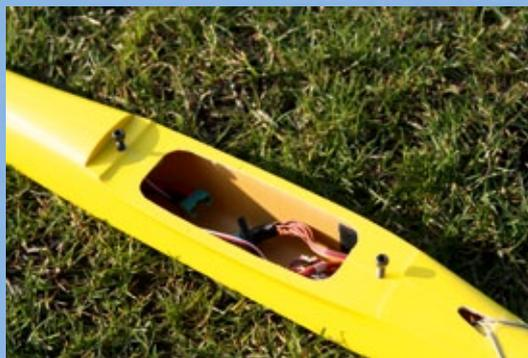
**Dank zwei Schrauben lässt sich das Höhenleitwerk demontieren**
