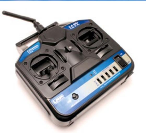
*Die beiliegende 2,4-Gigahertz-Fernsteuerung ist einfach, aber ausreichend für den Elektrosegler*
