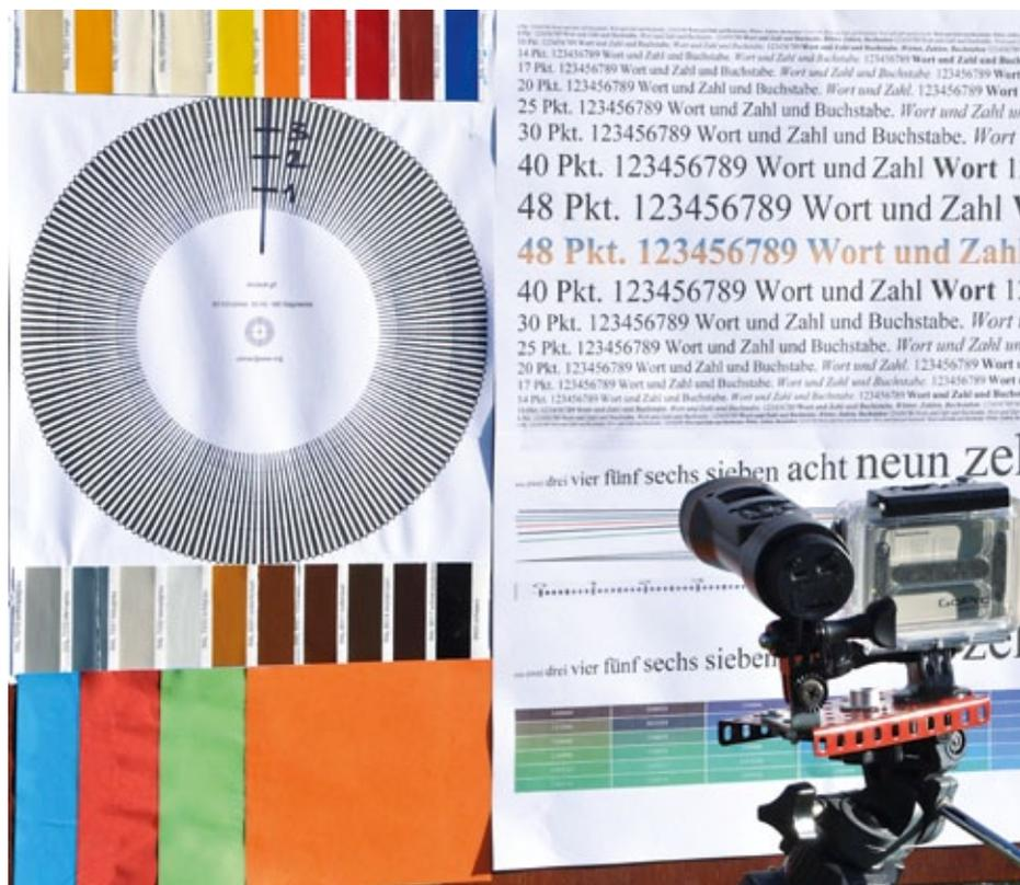
**Die Prüfung. Mit den Kameras nebeneinander montiert, wurden zahlreiche Fotos und Videoclips in verschiedenen Modi gemacht. Wegen der unterschiedlichen Brennweiten musste zusätzlich der Bildausschnitt angepasst werden**
