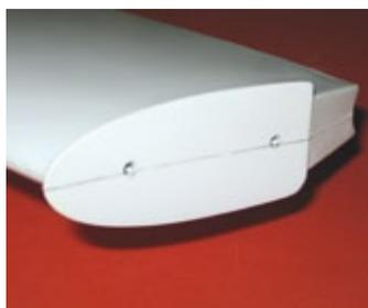
Die Muttern zur Fixierung des Höhenleitwerks sind bereits fertig in die Seitenrudersflosse integriert
