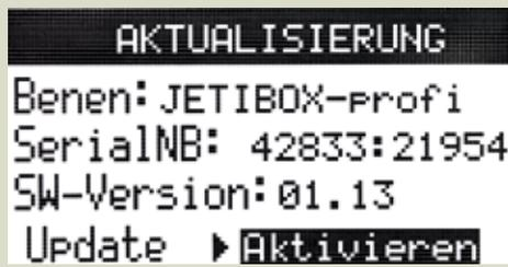
Sensoren. In diesem Betriebsmodus ist die JetiBox Profi dank hochauflösendem Grafikdisplay und sechs Bedienungstasten die Kommandozentrale im gesamten Fernsteuersystem. Dabei ist die Profibox mit der Ti-Buchse am Fernsteuersender angeschlossen.
