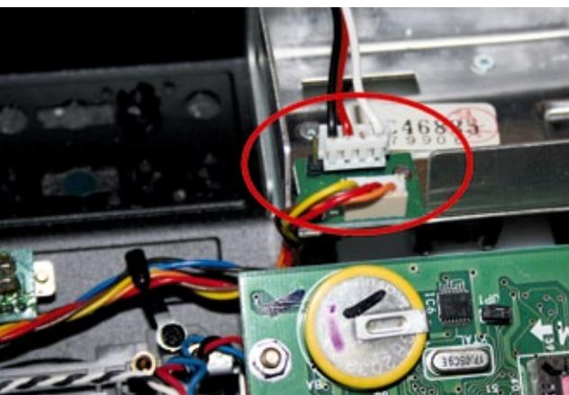
Plus, Minus und der PPM-Datenstrom für die JetiBox Profi werden beispielsweise bei der Graupner MC-24 im Schacht für das 35-MHz-Sendermodul angezapft. Dazu wird der Balancierstecker eines 3s-LiPo-Akkus rechtsbündig auf die Stifte gesteckt, wobei der linke Stift frei bleibt
