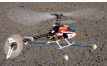
**Hoppla, da ist der Heli abgehoben. Knapp über dem Boden wird der Heli mal nach links oder rechts, vorne oder hinten driften. Diese Bewegungen sind durch vorsichtige Steuerkorrekturen auszugleichen und helfen, den Heli kennen zu lernen**
