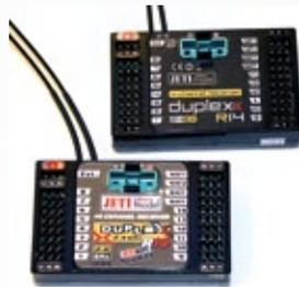
**Gute Nachricht: Alte Jeti Duplex-Empfänger zählen nicht zum alten Eisen, sie können das Protokoll der neuen EX-Telemetriesensoren wie die neuen EX-Receiver (oben) durchschleusen. Wegen Speicher-mangel lassen sich alte Jeti-Receiver leider nicht mit der neuen EX-Firmware updaten**
