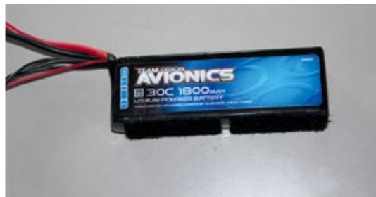
*Der verwendete 3s-LiPo von Team Orion passt perfekt in den Akkuschacht und zur Leistung des Antriebs*
