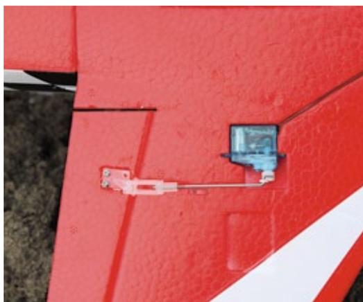
*Pro Fläche ist ein 5-Gramm-Servo verbaut. Leider sind Anlenkung und Servohorn nicht mit einer Abdeckung geschützt*
