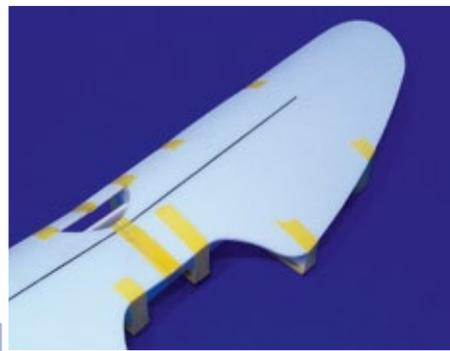
**Tesa- oder Uhu-Por-Scharniere halten die Ruder an den Dämpfungsflossen**
