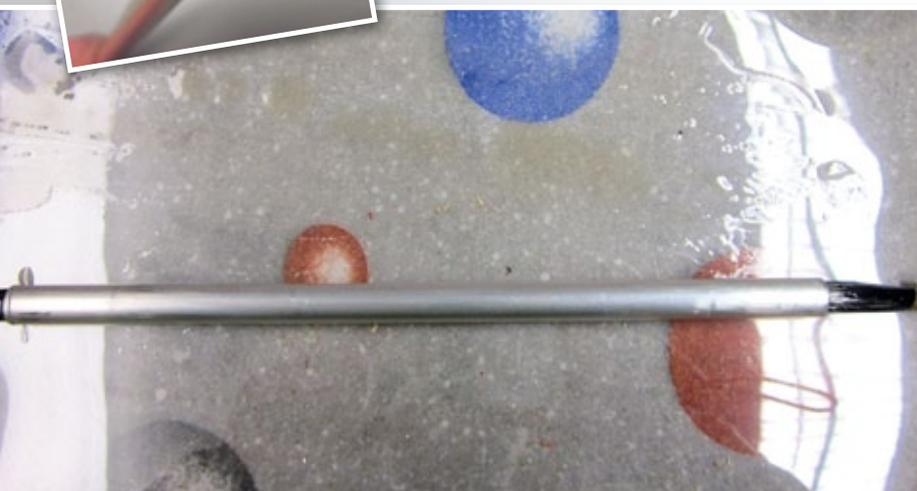
**Nach dem Durchziehen des Harz-getränkten Rovingstrangs, ist das Ganze auf zwei Klötzen zum Aushärten zu legen. Später die Enden abschneiden, verschleifen, fertig**
