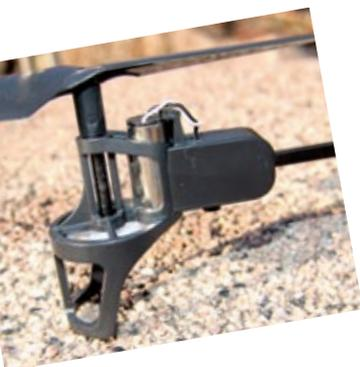
Jede Motorgondel verfügt über einen Kufenbügel, der auch das Getriebe schützt
