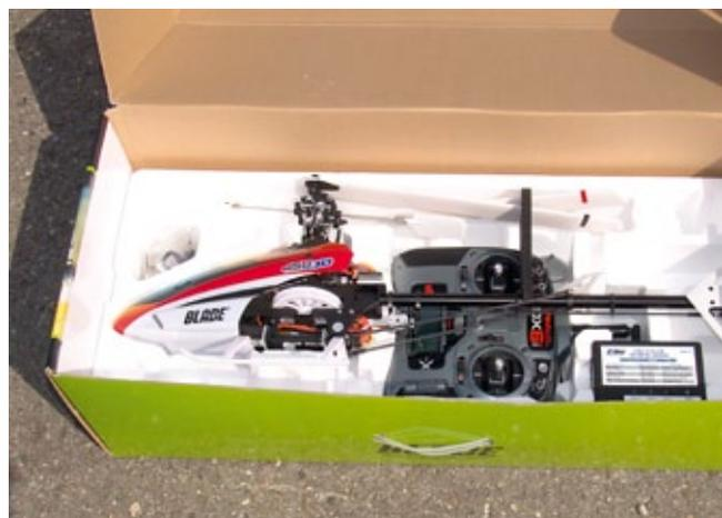
**Der Vorteil eines Komplettsatzes: Eingestellter Heli und Sender sowie erforderliches Zubehör sind alle an Bord. Der Karton kann zum Transport dienen**
