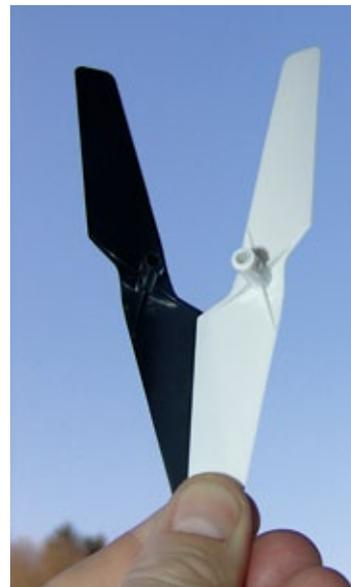
*Dem Set liegen weiße und schwarze Luftschrauben bei, deren Drehrichtung bei der Montage beachtet werden muss*
