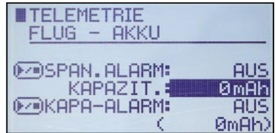
Alarmer können das Unterschreiten eines frei wählbaren Werts, beispielsweise die Kapazität des Flugakkus, signalisieren
