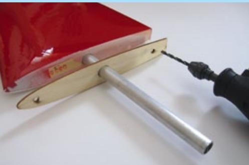
Zur Zentrierung des Höhenleitwerks sind zwei Dübel anzubringen. Eine Schablone hilft beim genauen Bohren
