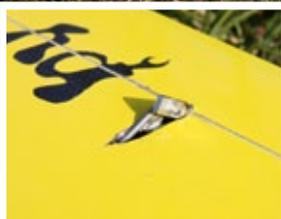
*Zum Erreichen großer Klappenauslässe und eines geringen Luftwiderstands erfolgt die Anlenkung von oben*
