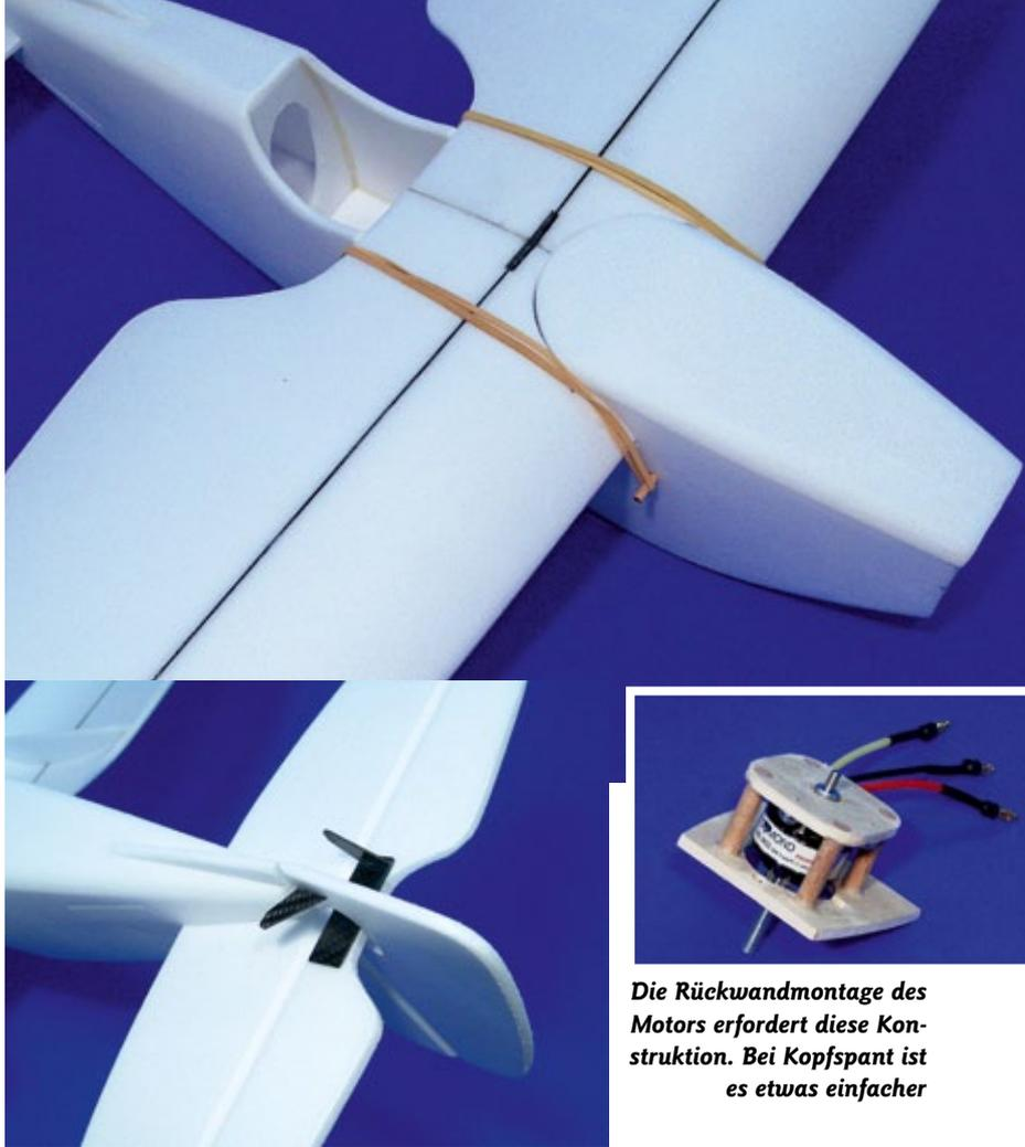
Die Rückwandmontage des Motors erfordert diese Konstruktion. Bei Kopfsant ist es etwas einfacher
