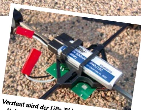
Verstaut wird der LiPo-Akku in entsprechenden Haltebügel auf der Unterseite der Mittelkonsole. Der Anschluss erfolgt über BEC-Stecker
