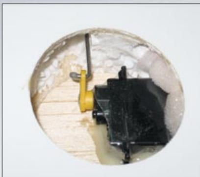
**Die Störklappenanlenkung kommt nahezu mittig vom Servoausschnitt zu liegen. Dadurch ist das Servo stark außermittig einzukleben, um eine geradlinige und leichtgängige Anlenkung zu erreichen**
