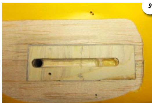
Wieder eingesetztes, verstärktes Brett. Übergänge wurden plan verschliffen
