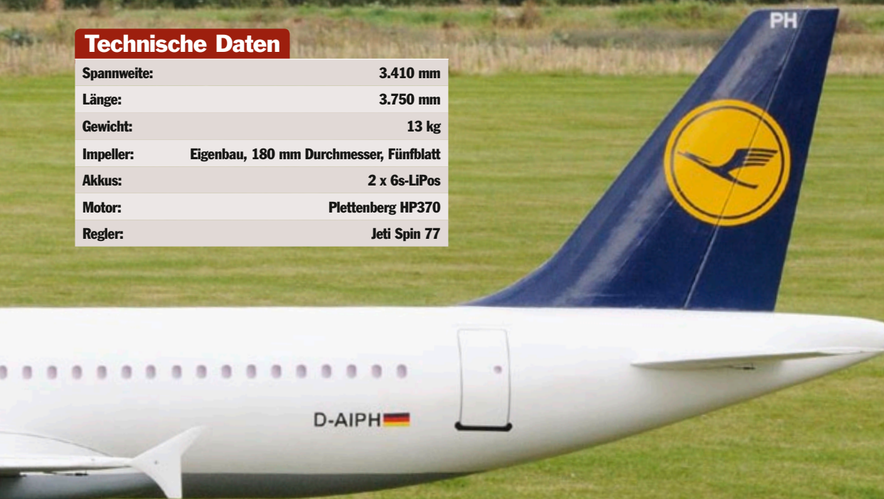
Das Höhen- und Seitenleitwerk lassen sich zum Transport abnehmen
