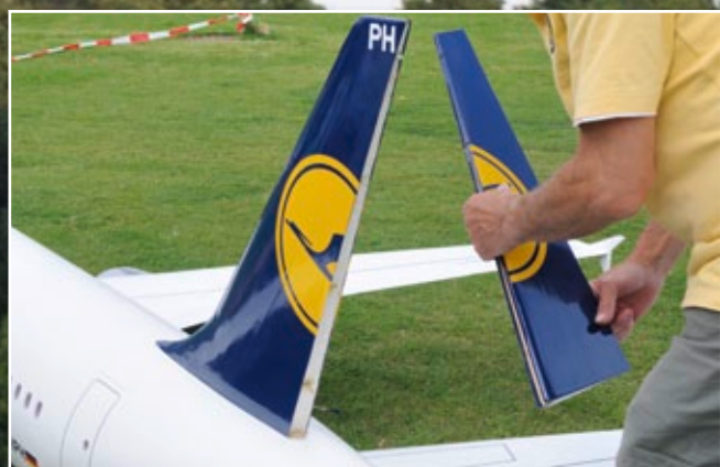
Das Höhen- und Seitenleitwerk lassen sich zum Transport abnehmen
