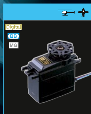
SDX-772 dig. Servo High Torque Servo f. Grossmodelle, Jets und z.B. Taumelscheibensteuerung in Turbinen- und 90er Helikoptern 0.11sec/40° 4.8V | 8.9kg/cm 4.8V 39 x 20 x 37.4mm | 56g
