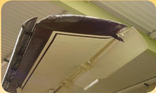
Abbildung 8: Die Vorflügel des Fiessler Storchs gehen auf die kleine Vogelfeder zurück
