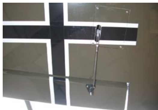
Querruderanlenkung wie üblich. Das mitgelieferte Teilmaterial ist verwendbar
