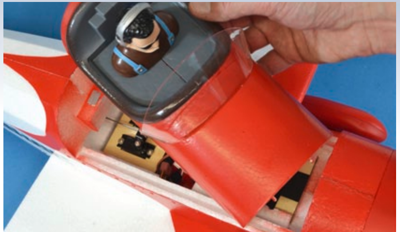
Zwei Stifte vorne und ein kräftiger Magnet hinten halten das Cockpit
