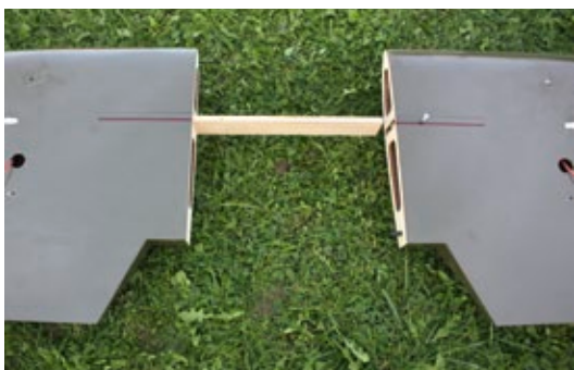
Die Flächenhälften werden mit einer Hartholzleiste verbunden. Die rot aufgemalte Linie oder die randständigen weißen Tabs markieren die Schwerpunktlage
