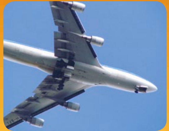
Abbildung 9: Ausfahrbare Vorflügel finden sich bei nahezu allen modernen Passagiermaschinen
