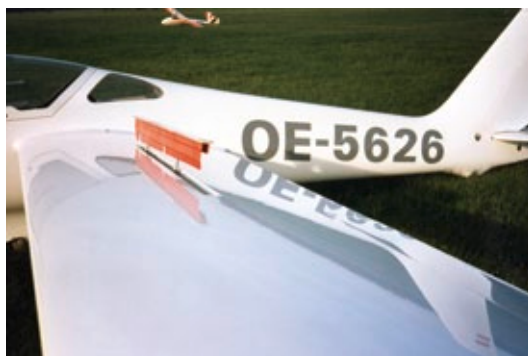
Die geöffneten Schempp-Hirth-Bremsklappen. Sie fahren nur an der Tragflächenoberseite aus
