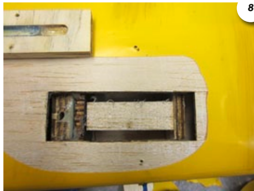
Der Balsablock stabilisiert das Fahrwerksbrett
