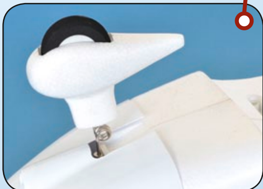
Das Bugrad ist gut gefedert und angelenkt
