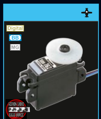
SDX-762 dig. Servo (HS/BB) High End Servo f. Kunstflieger, 3D, Segler, F3B/F3J. Schnell, präzise, höchste Rückstellgenauigkeit. 0.1s / 40° 4.8V | 3.9kg/cm 4.8V 27x12,1x37,4mm | 22,6g
