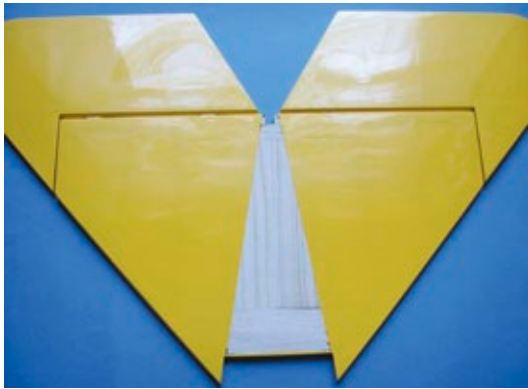
Das Fokker-typische, herzförmige Höhenruder muss vor dem Verkleben partiell enthäutet werden
