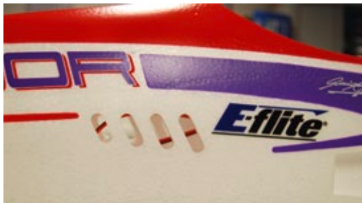
Seitliche Austrittsöffnungen des wirksamen Kühlluft-Systems
