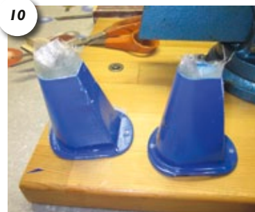
Innen einlamierte GFK-Matten geben den Plastikverkleidungen Halt
