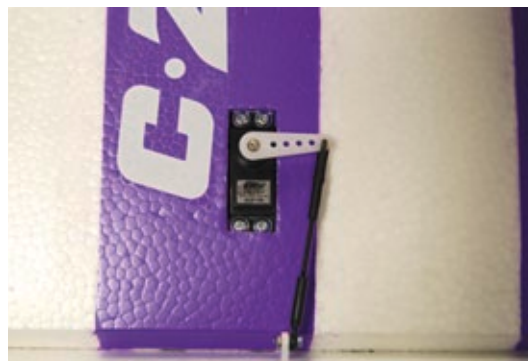
Die Anlenkungen, hier die Querruder, sind sehr robust und spielfrei ausgeführt
