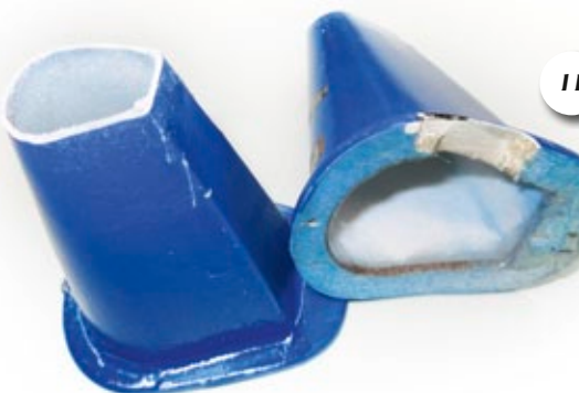
Überstände sind abzuschleifen und Kanten zu versäubern
