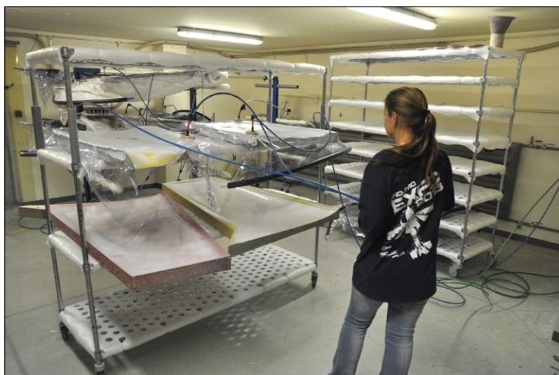
Hier braucht keiner zu frieren. Beheizter Raum mit Vakuumsaugung zum Temperieren von Formen
