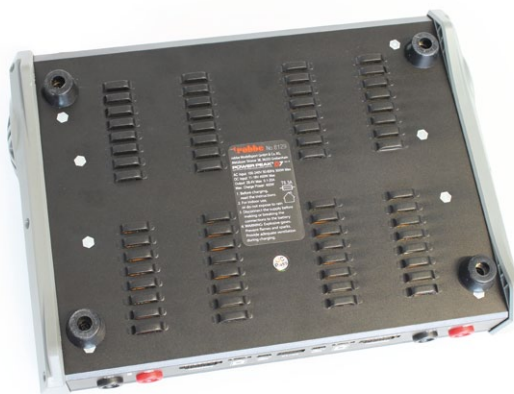
Massiver, stabiler Blechboden mit Kühlluftschlitzen. Die vier gummierten Füße geben dem schweren D7 guten Stand
