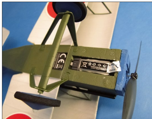
Der LiPo wird mit Klettband im Schacht an der Rumpfunterseite eingesetzt
