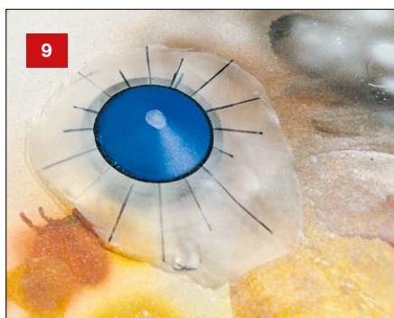
9 Den Rädern war ein Speichen-Look zu verpassen. Dafür ist zunächst eine Schablone aus Selbstklebe-Folie anzufertigen
