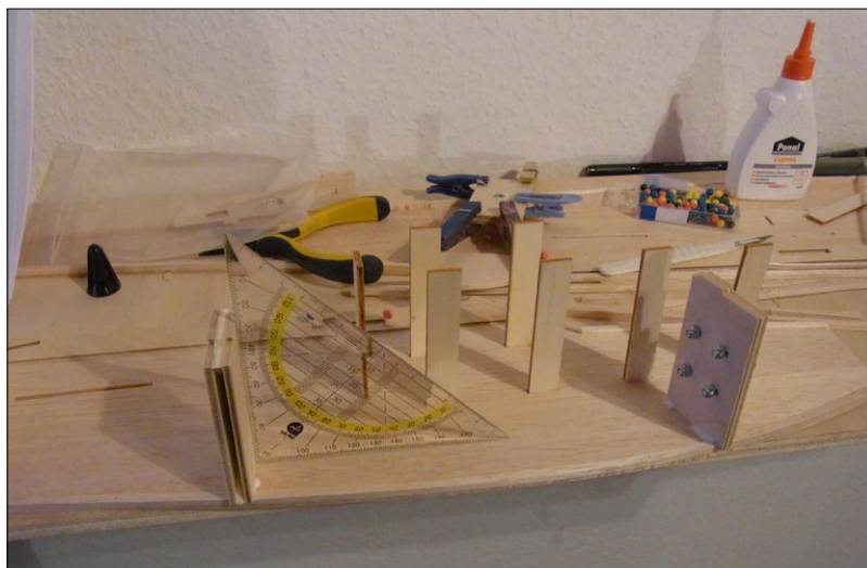
Die Aufnahme für das Hauptfahrwerk (links) und das Bugrad (rechts) werden absolut rechtwinklig und mit reichlich Weißleim verklebt und die kleinen Querbrettchen für die Akkurutschs sind auch schon eingebaut
