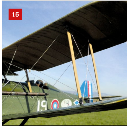
15 Das Modell bekam dann noch eine vorbildgetreue Verspannung. Ich habe keine Fäden, sondern 0,3-mm-Karbonstäbe eingesetzt. Die haben den Vorteil, dass sie mit der Zeit nicht schlaff durchhängen können. Ein wenig Silberlack sorgt für den Stahlraht-Effekt
