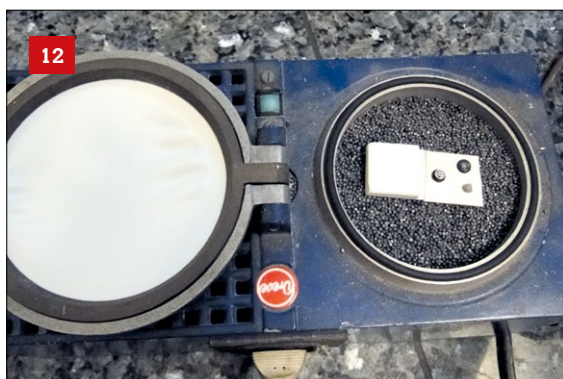
12 Mit einer kleinen Tiefzieh-Maschine – ausrangiertes Modell aus dem Dental-Bedarf – sind ein paar schicke Details entstanden. Rechts die Formen für die Sitzwanne, Kühlerverschluss, Kopfpolster und Trittstufe
