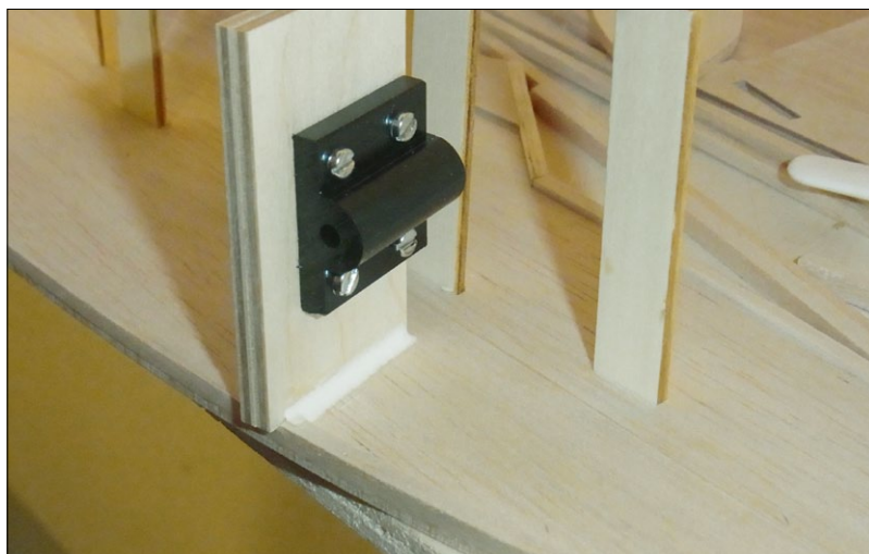
Bei einem Modell mit Dreibeinfahrwerk wie dem Big Easy wird das Bugrad bei Start und Landung am stärksten belastet. Daher muss dessen Aufnahme besonders stabil ausfallen
