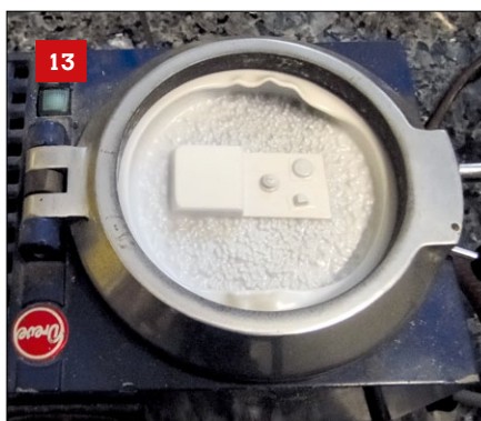
13 Nach dem Abformen mit dünner Polystyrol-Folie sieht das dann so aus
