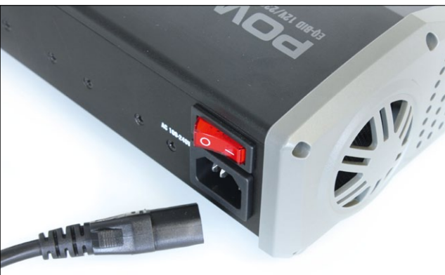
Für den 230-Volt-Betrieb hat das Peak D7 einen Ein-Aus-Schalter. Rechts einer von zwei Kühlflütern
