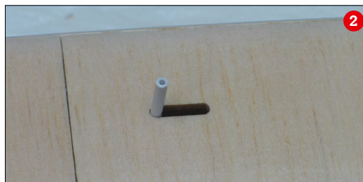
So sieht der Übergang vom Rumpf zum Motorspant schon sehr gut aus (1), Der Rumpfdeckel-Verschluss und dessen seitlichen Verstärkungen bei der Libelle (2+3)
