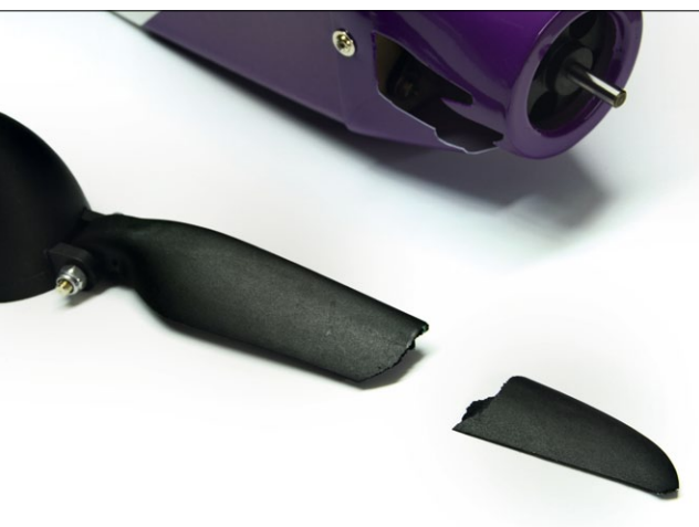
Abriss beim ersten Probelauf. Prop und Mitnehmer wurden gegen einen 11 x 6-Zoll-aero-naut-Propeller getauscht
