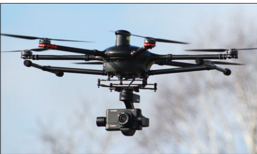
Per Schalter an der ST12 wird das Landegestell des H920 hochgefahren. Auf diese Weise wird eine störungsfreie Rundumsicht für die CGO4 erreicht
