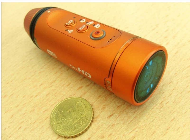
Abbildung 4: Eine aktuelle Action-Cam mit 150-Grad-Bildwinkel – noch dazu ist sie recht aerodynamisch geformt.
