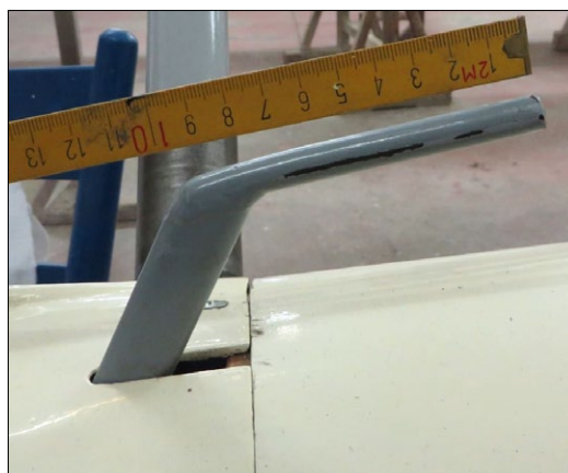
Am Heck befindet sich ein Transportgriff für die bessere Handhabung am Boden
