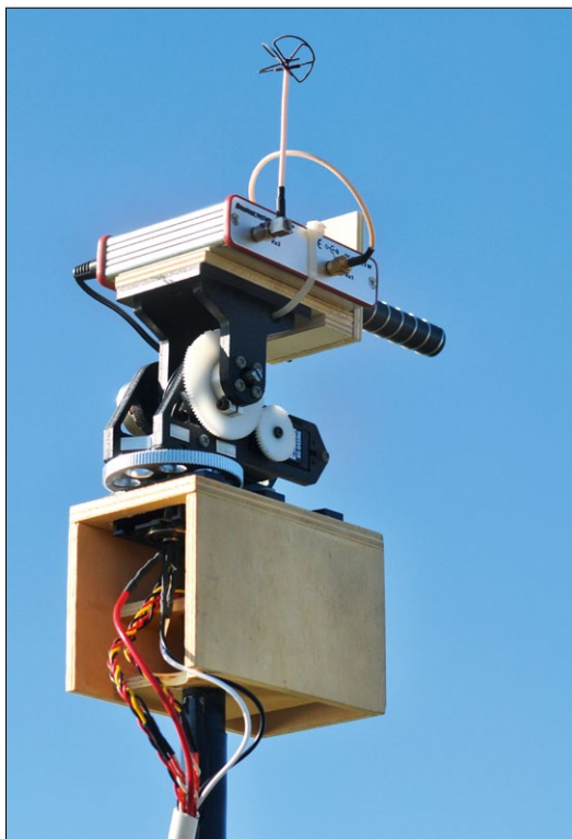
Der mechanische Teil eines Antennen-Trackers. Es handelt sich um eine in seinem Prinzip und seiner Funktion hochinteressante Vorrichtung, die es erlaubt, eine besonders leistungsfähige Richtantenne wie Helix oder Patch zu verwenden
