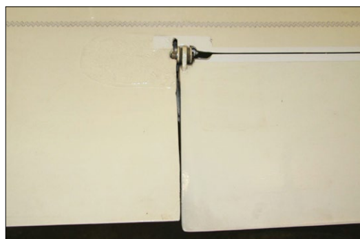
Die Querruderlager stehen etwas über die Flächen-Oberseiten hervor, ansonsten stört nichts die Oberfläche. Der Ruderantrieb liegt innerhalb der Fläche
