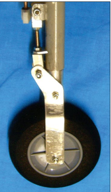
Fahrwerk eingefahren – so kann es längs in Rumpf, Motorgondel oder Fläche verschwinden
