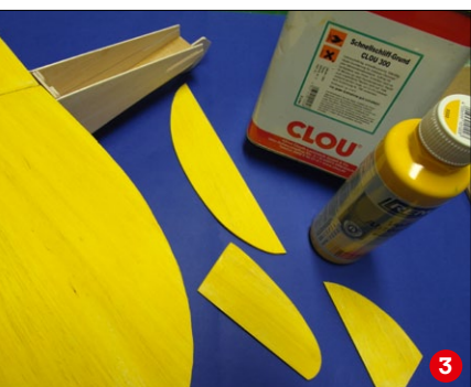
Die Rumpfkonstruktion kommt bei beiden Varianten mit nur zwei Spanten aus (1). Der fertige Rumpfkasten des Balsa-Modells (2). Schnellschliffgrund – mit etwas Abtönfarbe vermischt – erzeugt ein leuchtendes Finish, lässt aber die Holzstruktur durchscheinen (3). Die Servos sind einfach an die Rumpfseitenwände geklebt (4)
