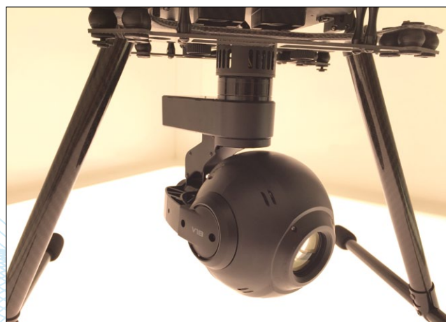
Abbildung 6: Zoom-Kameras an einem Multikopter sind geeignet für stationäre FPV-Anwendungen
