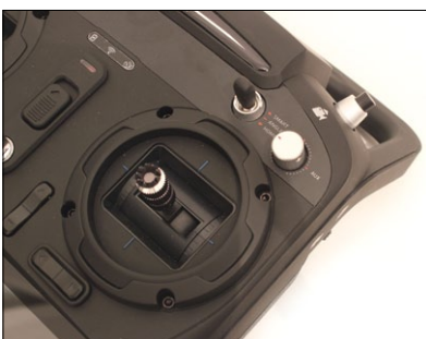
Per Schalter an der ST12 wird das Landegestell des H920 hochgefahren. Auf diese Weise wird eine störungsfreie Rundumsicht für die CGO4 erreicht
