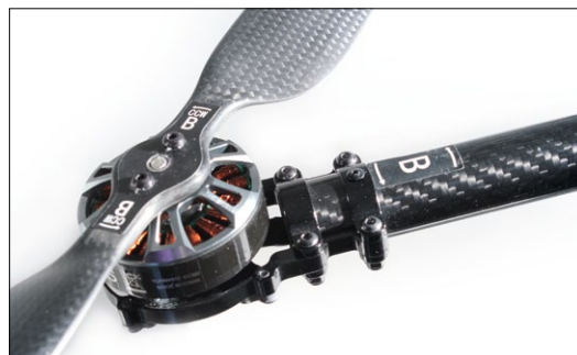
A zu A, B zu B: Buchstaben auf den Props sowie den Auslegern geben Aufschluss über die richtige Montage
