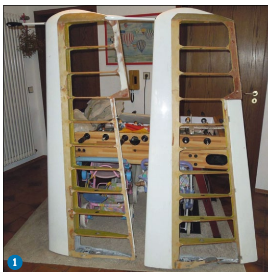
Das V-Leitwerk im Rohbau (1). Die Heckverkleidung hat eine sehr interessante Formgebung (2)
