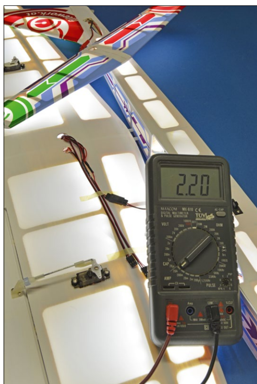
Rund zwei Ampere zieht die gesamte Beleuchtung an einem 3s-LiPo
