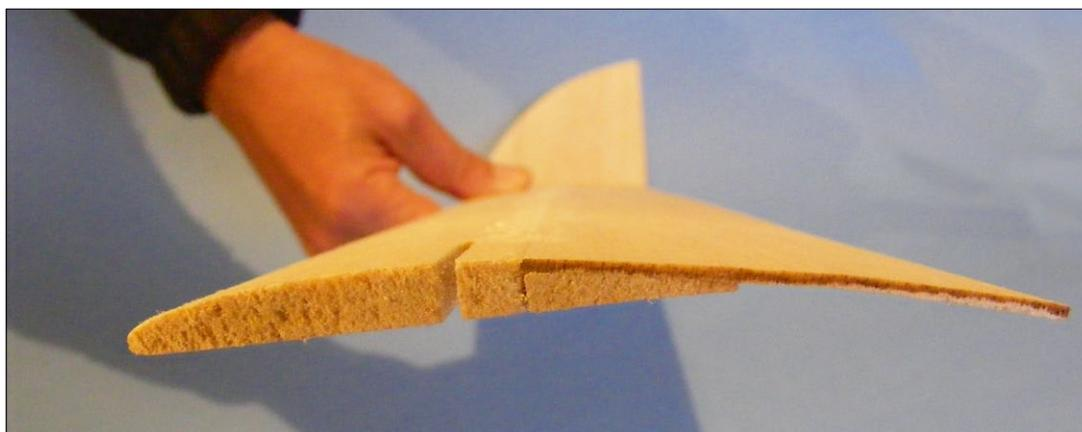
Auf diese Weise entsteht das Vogelprofil Graupner 6642 – Wurzelprofil mit 6,6 Prozent Dicke und 4,2 Prozent Mittellinienwölbung
