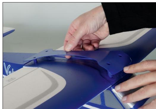
Mit dem Fixieren und Verschrauben des Flügelanschlusses aus Plastik ist die Montage abgeschlossen
