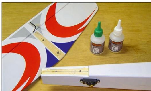
Ohne das angelenkte Spornrad wäre das Höhenleitwerk tatsächlich demontierbar. So erscheint eine Verklebung mit dem Rumpf die sinnvollste Lösung zu sein
