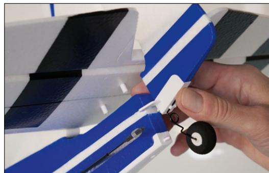
Eingelassene Plastikführungen garantieren korrekten und sicheren Sitz
