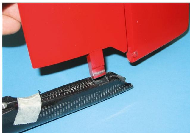
Das separate Seitenruder wird von oben auf den Rumpf aufgesteckt und formschlüssig mit dem Rumpf verbunden, es muss lediglich mit Klebeband gesichert werden
