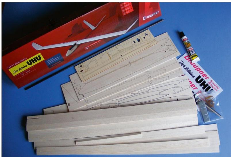
Im Baukasten sind alle Teile zum Bau des kleinen UHU als Freiflugmodell enthalten. Zur Aufrüstung gibt es ein extra RC-Set
