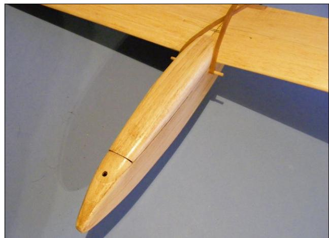
Die Tragflächengummis halten auch den Deckel zuverlässig an seinem Platz. Durch das Loch in der Rumpfnase werden Trimmblei-Kügelchen eingefüllt
