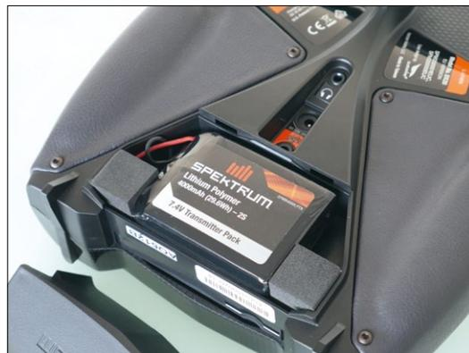
Lange Betriebszeiten ermöglicht der 2s-LiPo. Im Akkufach befindet sich auch der SD-Kartenslot
