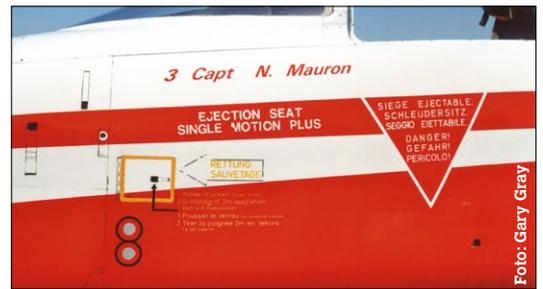
An der Rumpfsseitenwand im Cockpitbereich befindet sich der Nothandgriff zum Abwurf des Kabinendachs
