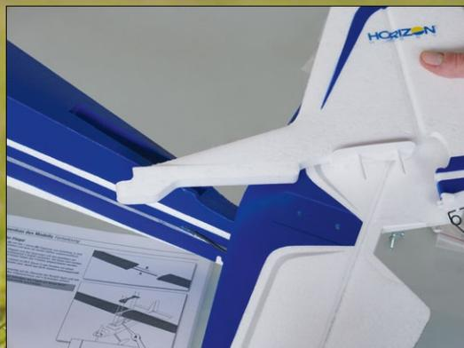
Zum Transport und Lagern ließen sich beide fest positionierten und verschraubten Leitwerke auch wieder demontieren
