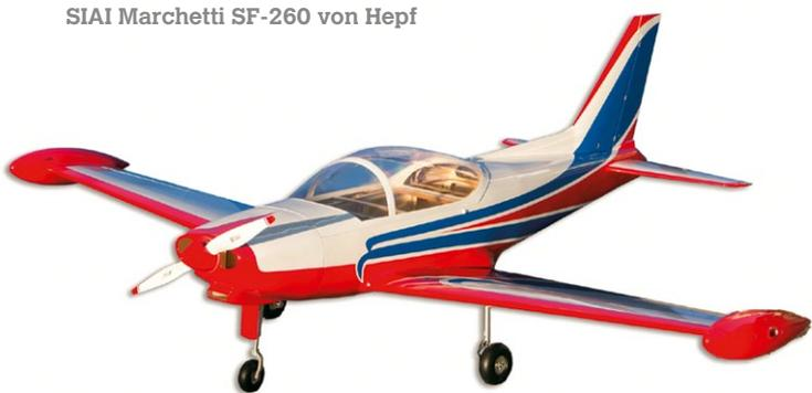
Das von Gernot Bruckmann entwickelte und von Hepf angebotene ARF-Modell ist an die italienische SIAI Marchetti SF-260 angelehnt. Trotz ihrer gutmütigen Eigenschaften im Kunstflug ist die SF-260 auch für schnelle Flüge und somit für jeden Piloten geeignet. Bei einer Spannweite von 2.300 Millimeter wiegt sie 7.500 Gramm. Erhältlich ist sie in den Farben Weiß/Rot und Weiß/Rot/Blau. Der Preis beträgt 629,- Euro. [www.hepf.at](http://www.hepf.at)
