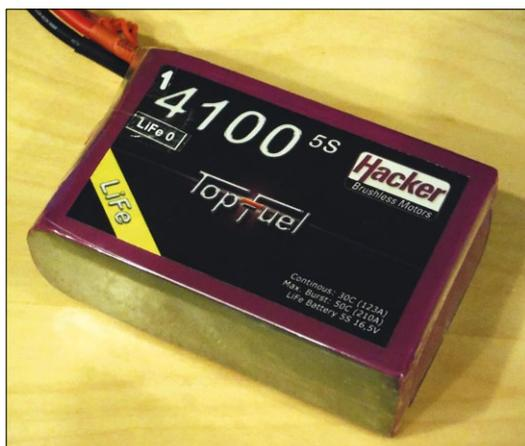
Abbildung 6: Eine moderne LiFePO<sub>4</sub>-Zelle mit geringem Innenwiderstand
