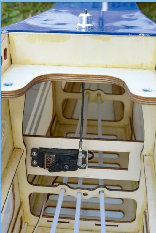
Die Schleppkupplung samt Servo ist eingebaut
