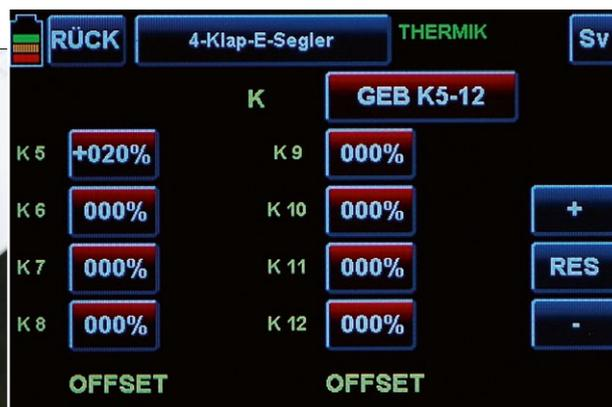
Funktion DR/Exp – Display GEB K5-12: Festlegung der flugphasenspezifischen Wölbklappenstellungen der Querruder. Hier Flugphase Thermik, Querruder 20 Prozent nach unten. Obwohl die Prozentzahl höher ist als die der Wölbklappen sind die Querruder natürlich weniger weit nach unten ausgeschlagen als die Wölbklappen
