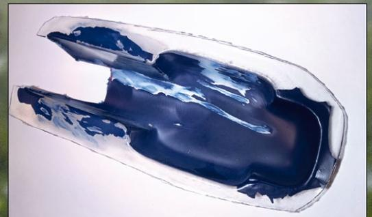
Die GFK-laminierten Einlaufrohre wurden für den Open-Duct-Betrieb angepasst
