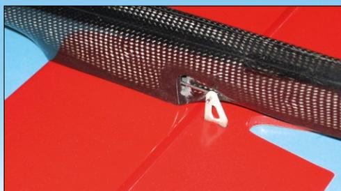
**Blick auf die Höhenruderanlenkung. Der Draht wird bei der Montage des Höhenruders im Ruderhorn eingefädelt und sichert sich bei aufgesetztem Leitwerk selbst**
