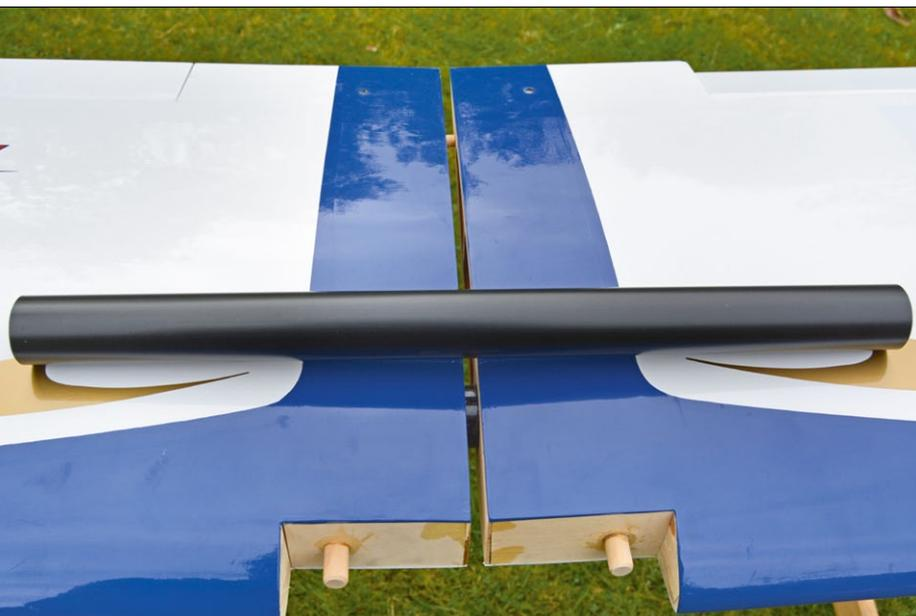
Ein 30 × 1,5-Millimeter-Alurohr mit einer Länge von 380 Millimeter verbindet die beiden Tragflächenhälften
