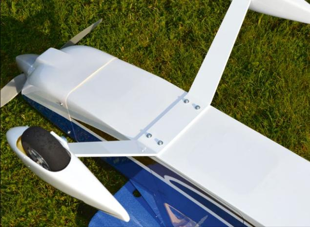
Mit vier Inbusschrauben wird das stabile Fahrwerk gehalten
