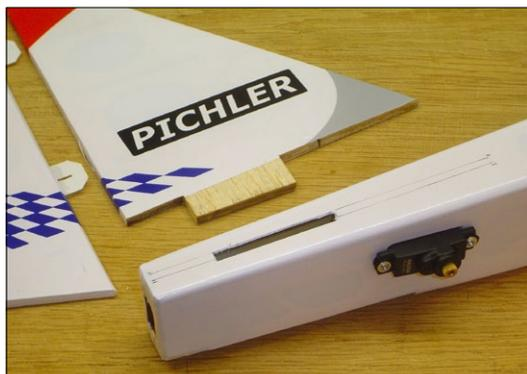
Auf dem Rumpfrücken und dem Seitenruder sollte die gesamte Auflagefläche von Folie befreit sein, damit eine vollflächige Verklebung erfolgen kann
