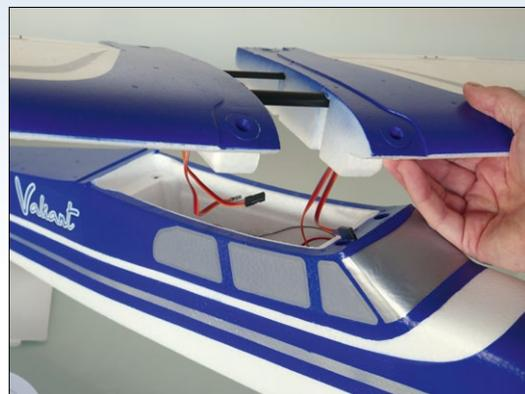
Vor dem endgültigen Aufsetzen sind die Kabel korrekt anzuschließen
