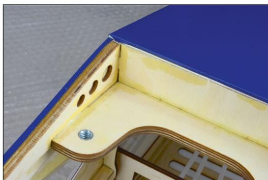
Gerade an tragenden Bauteilen sollte hier nachgebessert werden
