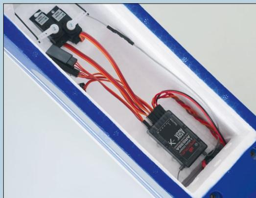
In der BNF-Version bereits eingebaut ist der AR636A-Empfänger mit AS3X-Funktion
