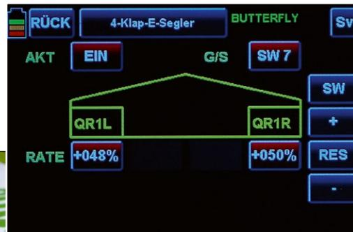
Maximale Butterfly-Position der Querruder: gemäß Empfehlung des Herstellers 17 Grad nach oben
