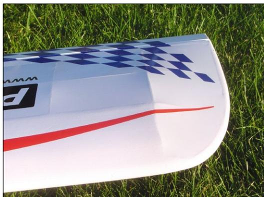
Die sichtbaren Rippenfelder verraten die Bauweise des Tragflügels. Der Randbogen ist nicht massiv, aber dennoch stabil
