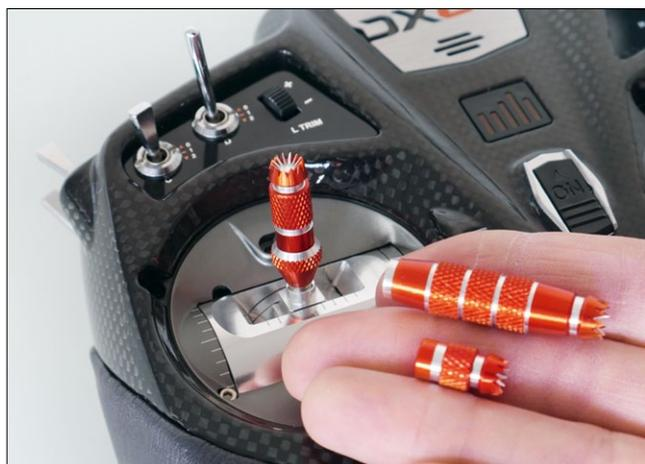
Zum Lieferumfang gehören wechselbare Alusticks und Bedienhilfen für den Schiebegeber
