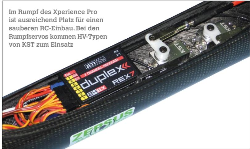
Im Rumpf des Xperience Pro ist ausreichend Platz für einen sauberen RC-Einbau. Bei den Rumpfservos kommen HV-Typen von KST zum Einsatz
