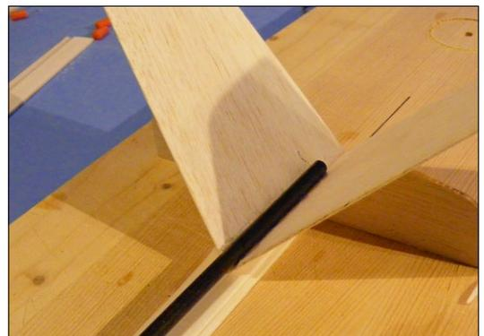
Der Rumpfdeckel (Kabinenhaube) wird aus mehreren Schichten Balsa verleimt
