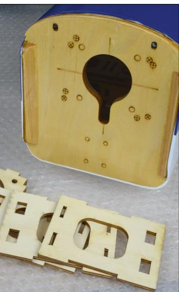
Der Motorspant ist bereits für unterschiedliche Typen vorbereitet
