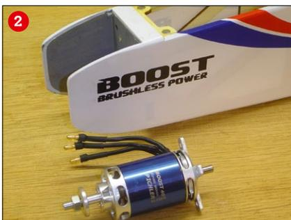
Das Befestigungskreuz des Motors lässt sich mit einem 12 mm starken Bolzen zum Ankönnen der Bohrpunkte exakt zentrieren (1). Der Überstand der Seitenwände passt perfekt zur Gehäuselänge des Boost-40-Motors (2)
