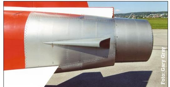
Die Schubdüse des Nachbrenner-Triebwerks, unter der keilförmigen Verkleidung befindet sich ein Radarwarn-Empfänger
