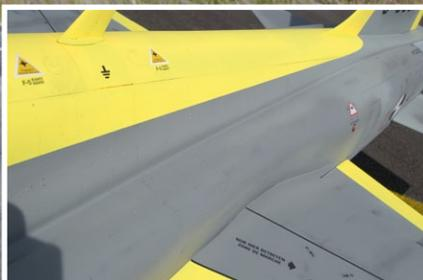
Der Rumpf ist in GFK-Wabenbauweise aufgebaut, die Tragfläche und die Leitwerke entstanden in GFK-Balsa-Sandwich-Bauweise
