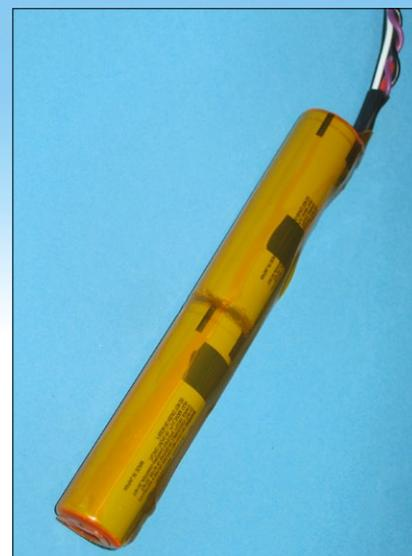
**Der Lilon-Empfängerakku wird als Stange verlötet, dadurch passt er bis ganz nach vorne in den Rumpf. Durch die eigensicheren Becherzellen kann der Akku auch bedenkenlos im Rumpf gelagert werden**
