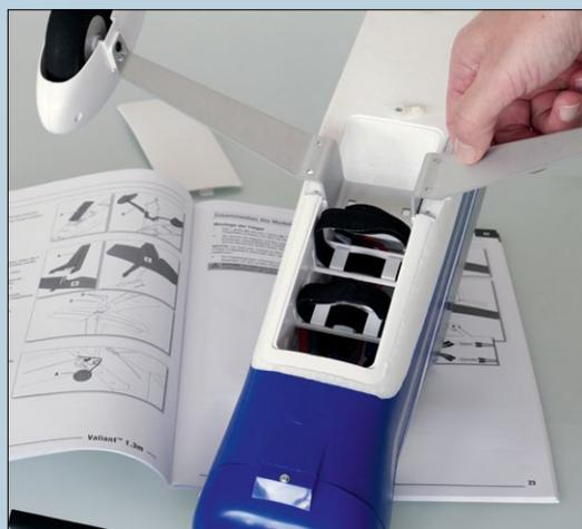
Das massive Alu-Fahrwerk ist mit dem eingeklebten Plastik-Akkuschacht sicher verschraubt
