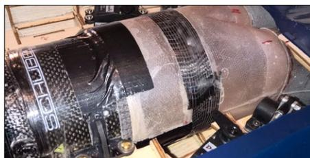
Wie hier zusammengesteckt, passt das Hosenrohr samt Düsen nicht in das Rumpfheck. Leider mussten zum Einpassen die angeformten Düsen vom Rest getrennt werden, um schiefe Schubachsen zu vermeiden. Der Schübeler DS-51-AXI HDS V2015 sorgt für den nötigen Schub
