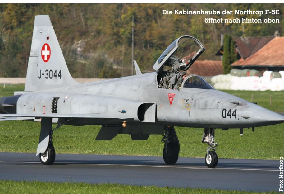
Die Kabinenhaube der Northrop F-5E öffnet nach hinten oben
