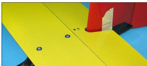
**Für die Höhenrudernullstellung wird das Modell aufgebaut, eine EWD von knapp einem Grad am Höhenleitwerk eingestellt und per Hilfsmarkierung am Seitenleitwerk zur Überprüfung kenntlich gemacht**
