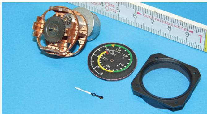
Der Hauptgang: Stepper im Pertinax-Gehäuse unter Glas mit Zeiger
