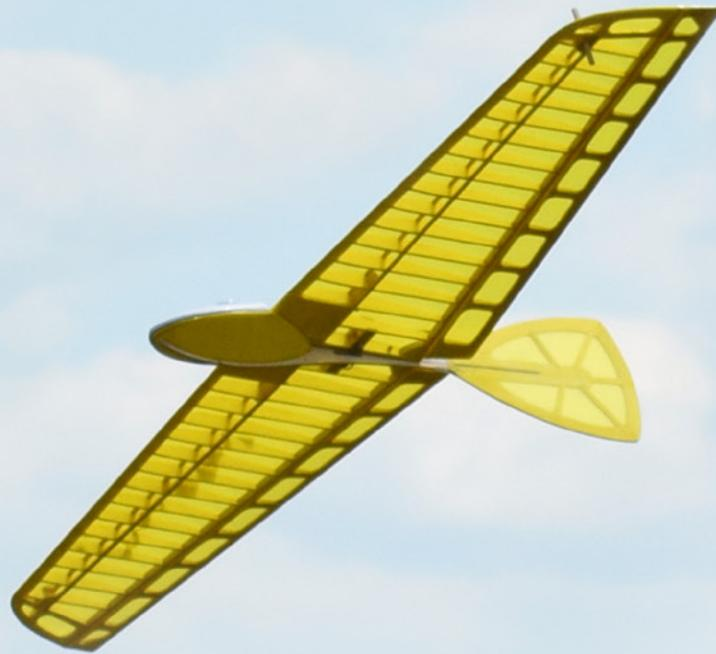
**S**o wiederlegt der kleine, nur 760 Millimeter (mm) spannende Nani überzeugend die drei häufigsten Vorurteile die Holzmodellen in Rippenbauweise üblicherweise entgegengebracht werden. Demnach verursachen sie einen hohen zeitlichen Bauaufwand, sind kaum belastbar und nur bei Windstille einsetzbar. Dem ist nicht so.
