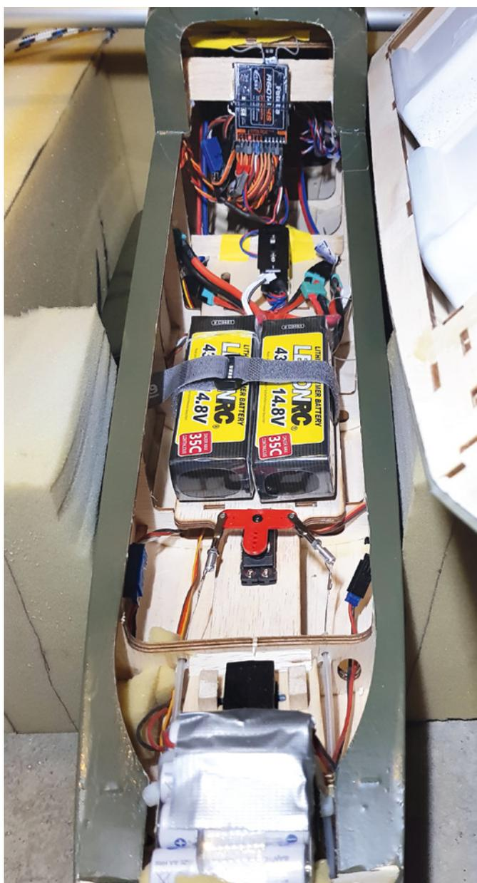
Vorne im Mittelrumpf sind die beiden 2.500er-NiMH-Akkus eingeschoben. Dahinter sieht man das Servo für die Bugradsteuerung. Die Motorpower wird von zwei 4s-LiPos geliefert, die parallel verdrahtet sind. Mit dieser Ausstattung stimmt der Schwerpunkt bei 85 mm perfekt
