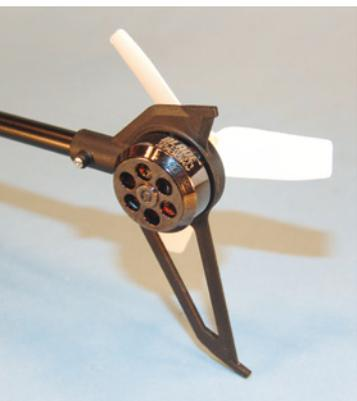
Der Heckrotor wird von einem bürstenlosen Außenläufer direkt angetrieben, ist wartungsfrei und liefert viel Leistung
