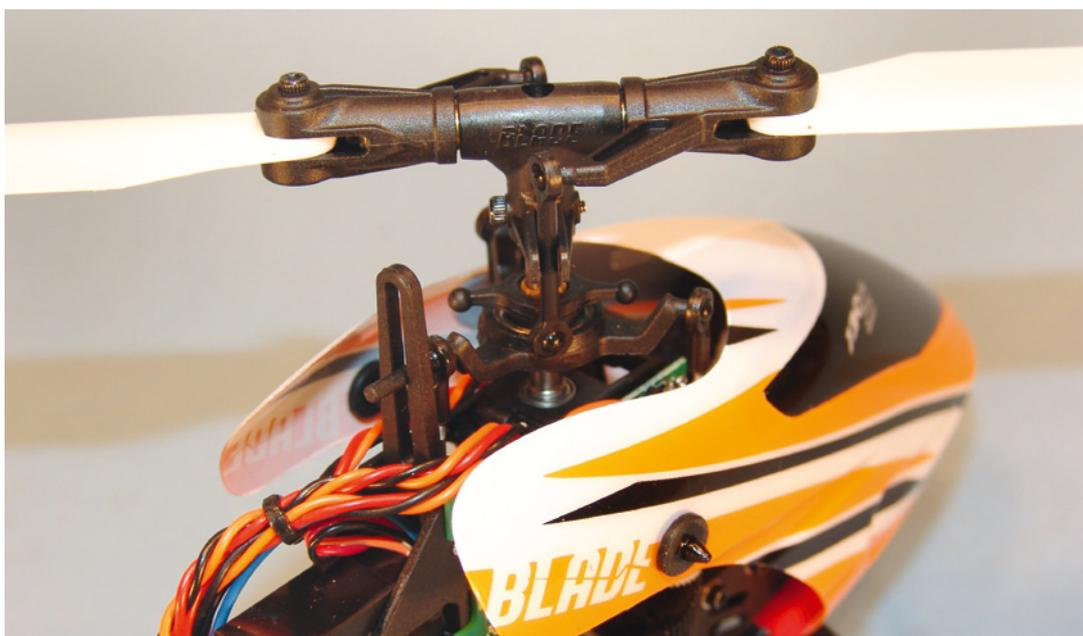
Der Hauptrotor ist ein Übernahmeteil vom größeren Blade 180X, deshalb sehr robust und in den Blattgriffen mit Drucklagern ausgestattet. Das ist nicht selbstverständlich in dieser Klasse
