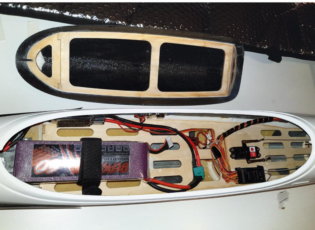
Der 6s-LiPo lässt sich verschiebbar platzieren. Die Seilanlenkung des Seitenruders funktioniert zuverlässig. Die passgenaue, glänzend schwarz lackiert GFK-Haube hat im Innenbereich eine sauber gearbeitete Verstärkung
