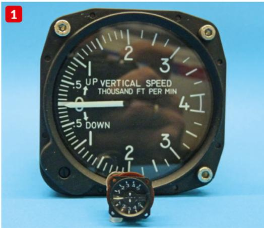
1) Vor dem großen Bruder das funktionierende Vario in 1:4. Noch kleiner lassen sich die Instrumente allerdings kaum realisieren. 2) Ob Drehbank, 3D-Drucker oder CNC-Fräse, die Gehäuse sind nach Art des Hauses selbst zu erstellen
