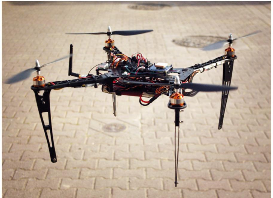
Abbildung 8: Ein Quadrocopter mit hohem Landegestell – es reduziert etwas den Bodeneffekt, da Rotoren und Bodenfläche einen größeren Mindestabstand einhalten
