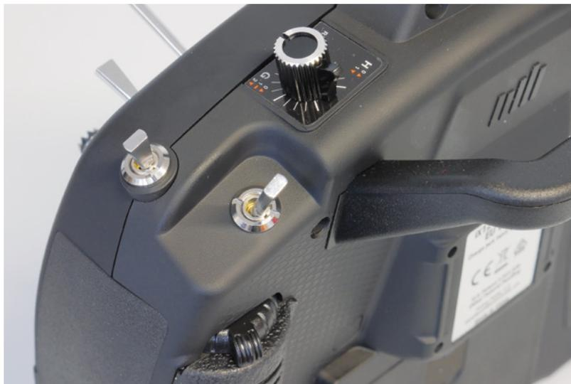
Die iX12 ist mit zahlreichen, frei belegbaren Gebern versehen, die auch das Steuern komplexerer Modelle ermöglichen. Praktisch und gut erreichbar sind die rückwärtig platzierten Drehgeber
