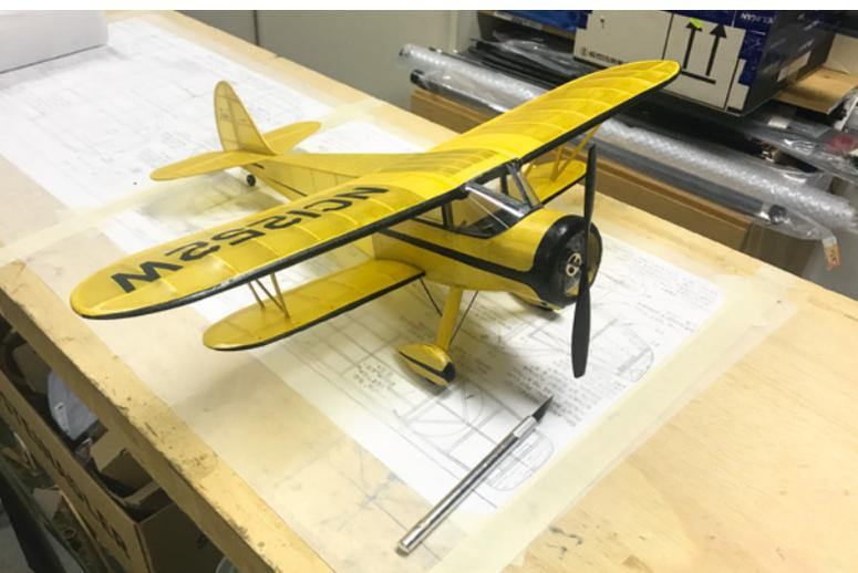
Nur 480 Millimeter Spannweite hat die Waco und passt damit locker auf den Bautisch. Der Plan und die Teile von Manzano Laser Kits sind sehr gut gemacht
