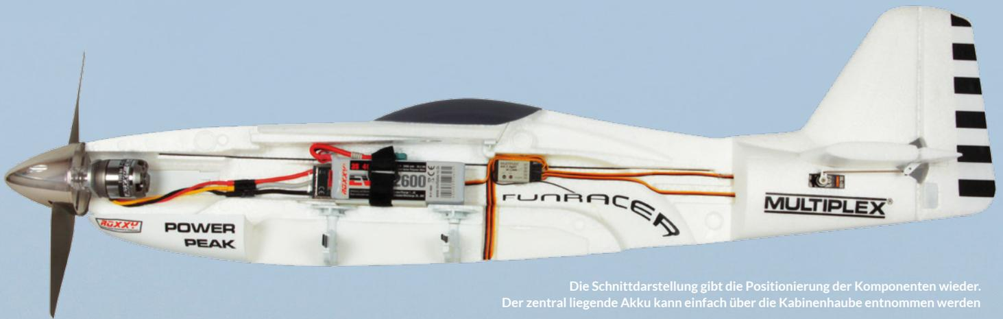
Die Schnittdarstellung gibt die Positionierung der Komponenten wieder. Der zentral liegende Akku kann einfach über die Kabinenhaube entnommen werden
