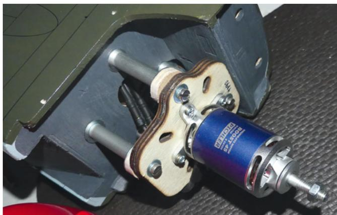
Da die Alu-Distanzröhrchen bei Verwendung des Pichler Elektromotors Boost 45 zu kurz sind, ist der Motorträger mit 5-Millimeter-Sperrholzscheiben und zwei 1 Millimeter dicken Unterlagscheiben aufzufüttern, um die erforderlichen 7 Millimeter Verlängerung zu erzielen
