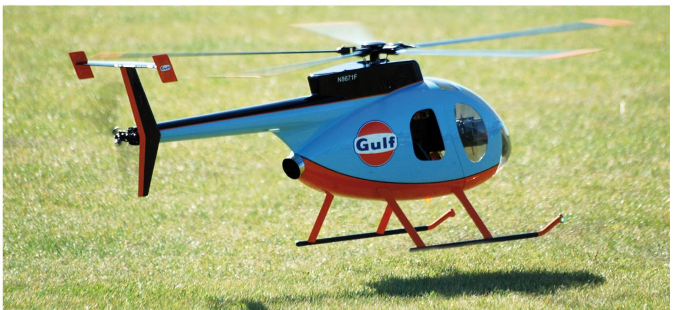
Abbildung 5: Hughes 500E von Frank Pock mit Turbinenantrieb beim Abheben - der Bodeneffekt ist auch bei diesem großen Modell vorhanden (Foto: Raimund Zimmermann)
