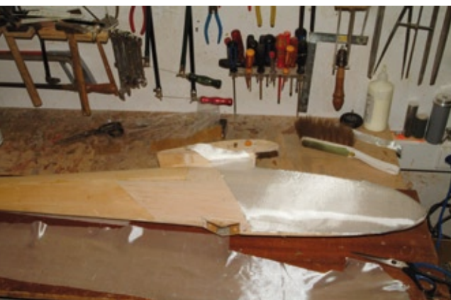
Die erste Glasmatte wird angepasst
