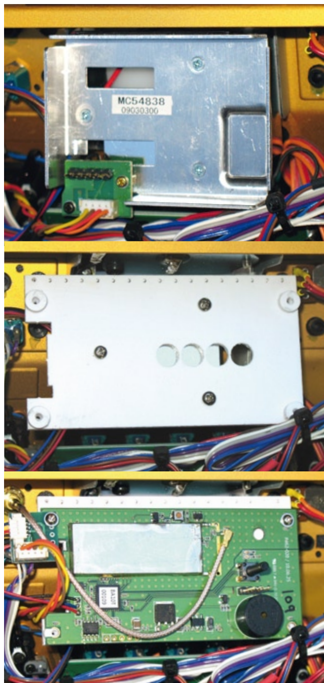
Dieser HF-Baustein mit dem Anschlusssteckmodul, der Antennenzuleitung und der Antenne soll in die mc-24 eingebaut werden
