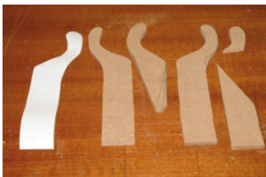
Mit Papierschaablonen wird die Größe der Halterung bestimmt und dann aus einem 6 Millimeter starken Holzstück ausgesägt
