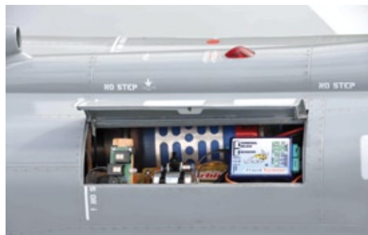
Mit einer Frank TJ 70 Raptor-Turbine wurde dem Eurofighter Kraft unter die Haube gepflanzt
