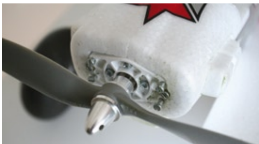
Vier Schrauben für Seitenzug und Motorsturz gestatten eine optimale Einstellung
