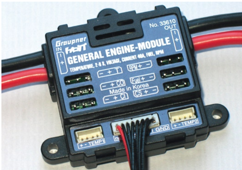
Das General-Engine-Modul ohne Variosensor – ansonsten ist es baugleich mit dem General-Air-Modul
