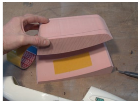
Den Beschnitt der Oberseite kann man wiederverwenden – und zwar zur Unterfütterung. Somit kann man das Teil erneut auf dem Bandsägetisch auflegen und nun die am Rumpf entlang angezeichnete Druntersicht-Kontur absägen
