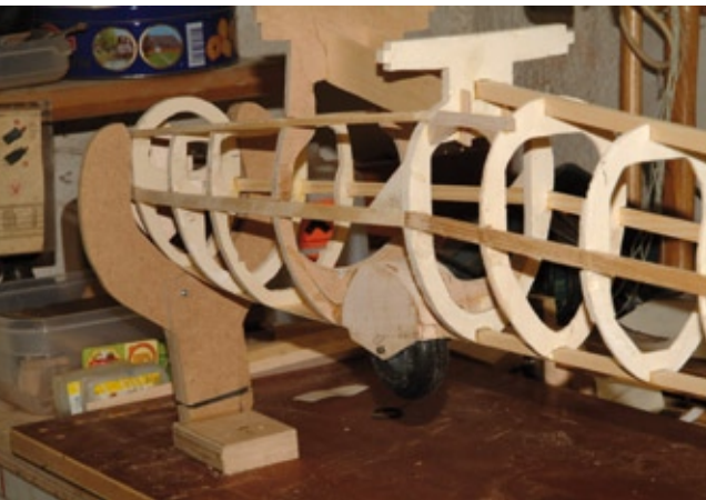
Ein größerer Halter fixiert den Rumpf im Bereich der Kabine
