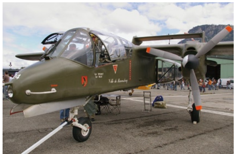
Die beiden gegenläufigen Dreiblattpropeller haben einen Durchmesser von 2,54 m und werden von Turboprop-Triebwerken mit je 715 PS angetrieben
