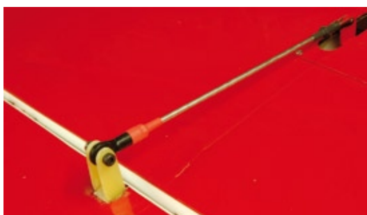
Aus jeweils zwei 2-Millimeter-GFK-Platten sind jetzt die kräftigen Ruderhörner erstellt
