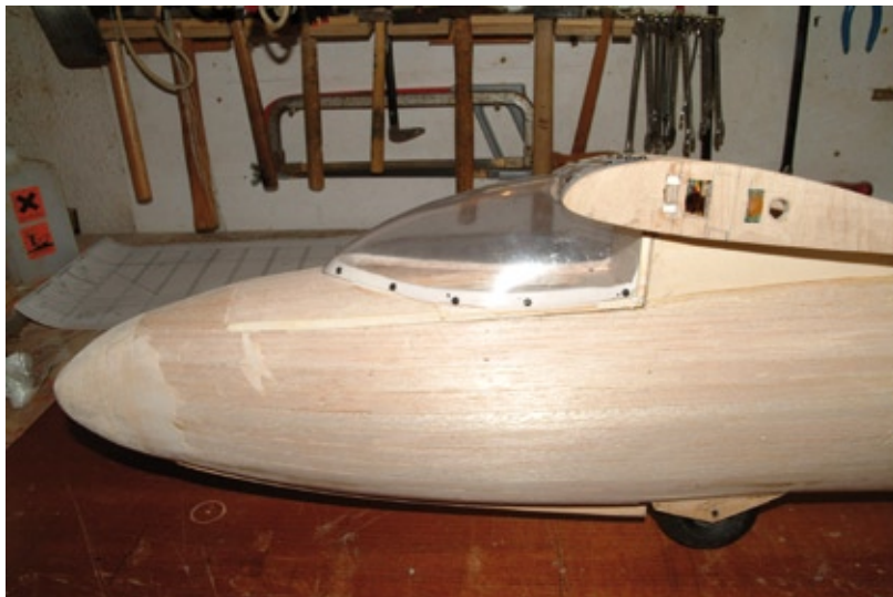
Der Rumpf ist fertig zum Beschichten mit GFK
