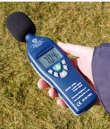
Trotz der recht einfachen Schalldämpferanlage ein guter Wert – 70 dB(A) bei Vollgas
