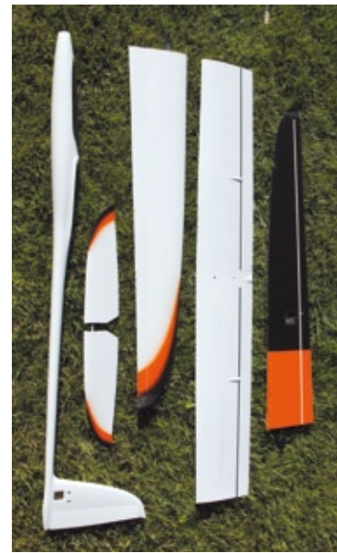
Die Voll-GFK-Bauteile sind von hoher Oberflächenqualität und guter Passgenauigkeit
