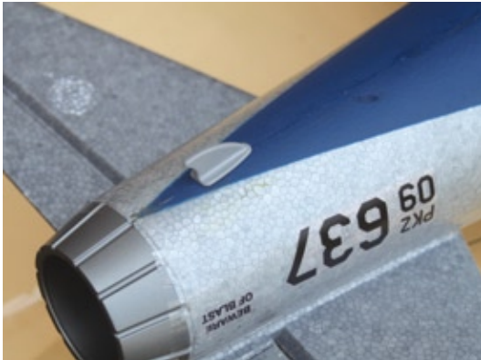
Um ohne Fahrwerk zu landen, liegen zwei kleine Kufen bei, auf denen der Habu den Boden entlang schlittern kann
