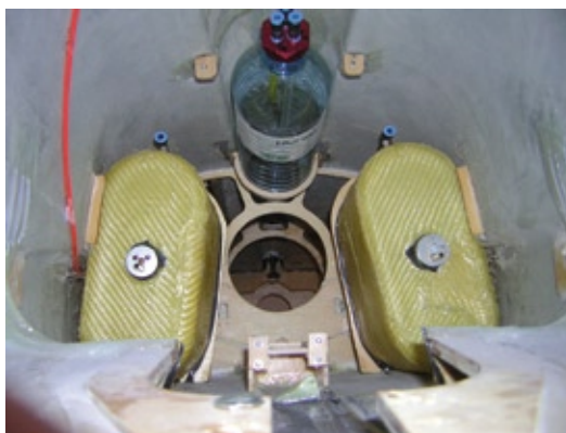
Die beiden Kerosintanks bestehen aus Kevlar und fassen je 2.200 Milliliter Treibstoff
