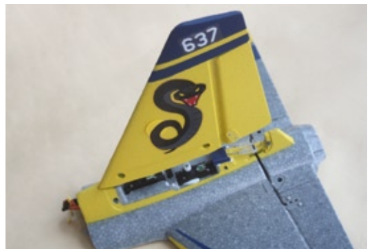
Das Seitenleitwerk hat ein Kohlerohr, das in das Höhenleitwerk gesteckt wird. Anschließend wird auf beiden Seiten eine Verkleidung angeschraubt
