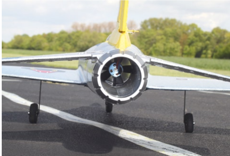
Im Impeller ist ab Werk bereits ein hochdrehender Brushlessmotor eingebaut
