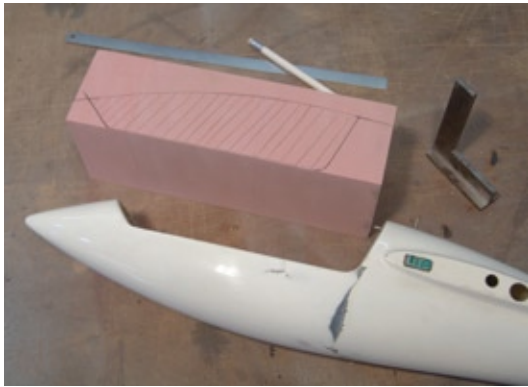
An einem PUR-Hartschaumblock zeichnen wir die exakte Seitenkontur mit dem Bleistift an
