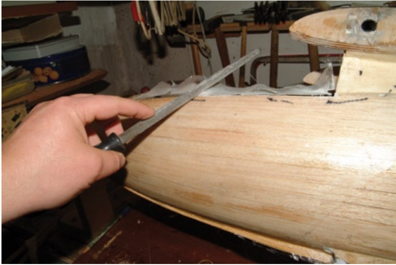
Überstände werden nach dem Aushärten mit der Feile entfernt
