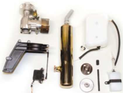
Die ausgebauten Verbrennerbauteile bestehend aus dem Methanolmotor, dem Schalldämpfer, dem Lüfterschacht, dem Gasservo, der Kupplung, der Anlasserwelle und der Tankanlage
