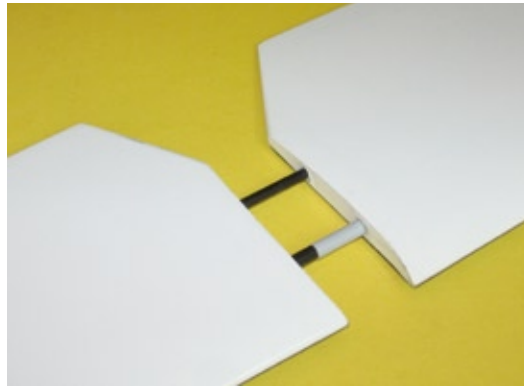
Das Höhenleitwerk wird mittels CFK-Bolzen am Rumpf gehalten, für eine spielfreie Drehbewegung des Pendelruders sorgt eine Teflonhülse
