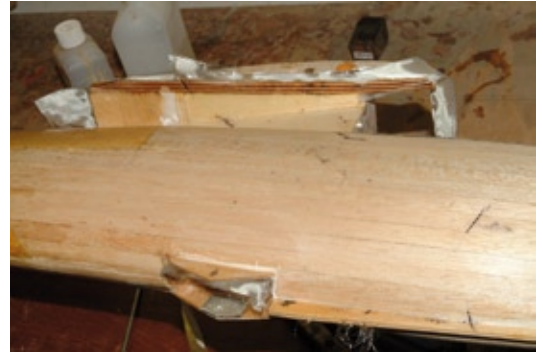
Die GFK-Schicht wird aufgetragen
