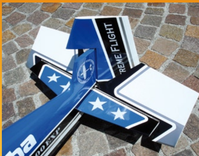
Extreme Ausschläge beim Höhen- und auch beim Seitenruder sind bei 3D-Modellen erforderlich
