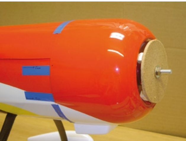
Für das exakte Positionieren der Haube wurde eine Zentrierlehre erstellt
