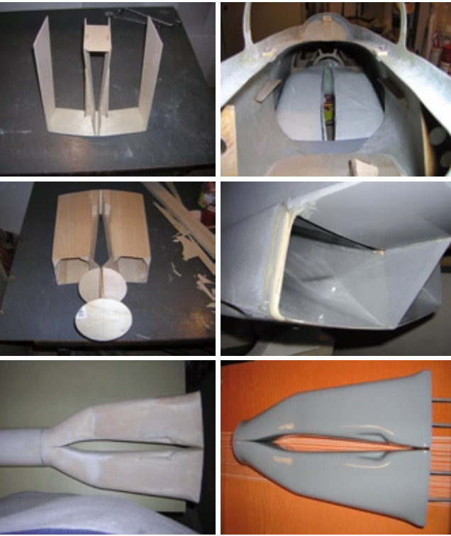
Der als Dukt bezeichnete Lufteinlass in den verschiedenen Stufen seiner Fertigung
