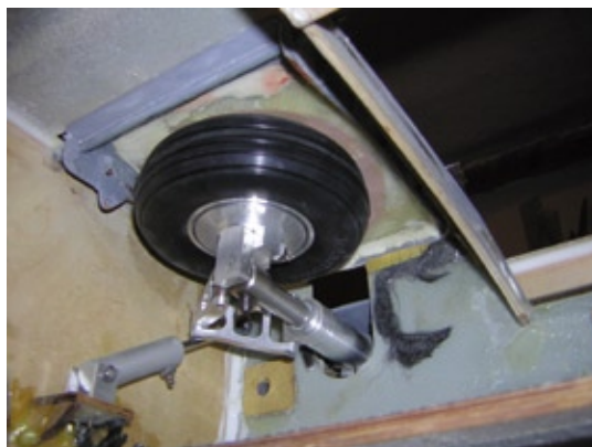
Das pneumatische Einziehfahrwerk arbeitet mit einem Druckluftsystem. Im rechten Bild ist eine der Fahrwerksklappen im Rumpfmittelteil ohne Fahrwerk zu sehen
