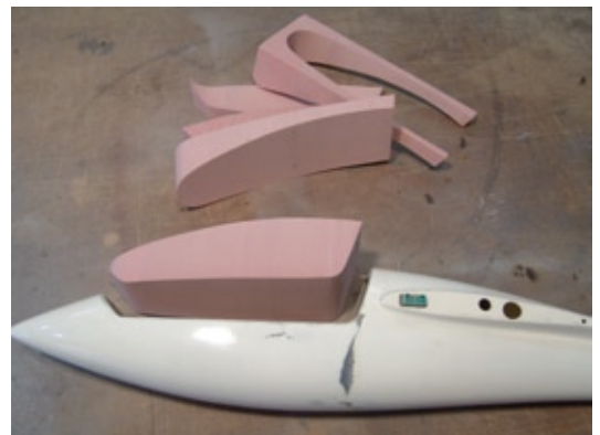
Jetzt passt der Klotz schon prima in den Rumpfausschnitt. Die übrigen Sägereste können nun entsorgt werden
