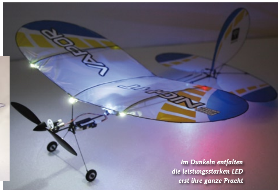
Die gesamte Elektronik für die Micro-Servos, der Empfänger und die LED-Beleuchtung befindet sich zentral auf einer Platine
