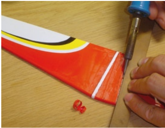
An den Klebestellen wird die Folie am besten mit einem Lötkolben entfernt
