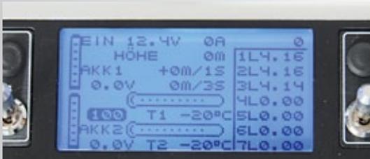
Auch beim Stromsensor bekommt man zunächst alle wichtigen Informationen auf einen Blick. Das Electric-Air-Modul zeigt neben der Spannung und dem aktuellen Strom auch die Höhe an. Zudem sind rechts die Spannungen aller Einzelzellen ablesbar
