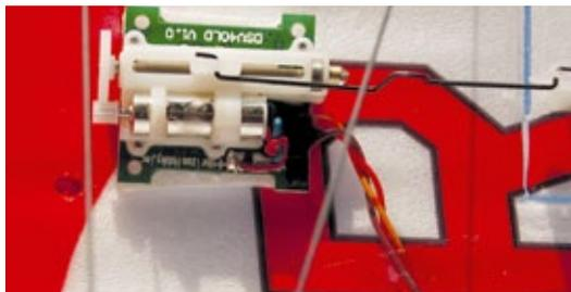
man auf der Platine im Inneren des Rumpfes vergebens. Also Akku anstecken, Bind-Taste am Sender gedrückt halten und einschalten. Nach ein paar Sekunden zeigt die Mini-LED auf der winzigen Empfangsplatine durch Dauerlicht den erfolgreichen Bind-Vorgang an und die Ruder hören auf die Kommandos des Senders.
