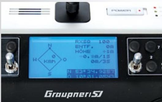
Auf dem oberen Display werden Telemetrie-Daten angezeigt. Hier ist das GPS-Modul angeschlossen
