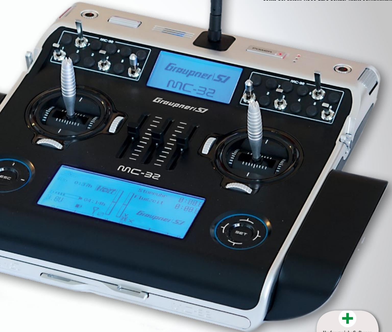
kann man zum Beispiel auf die Schnelle eine Kreiselempfindlichkeit einstellen. Allerdings sollte man den so ermittelten Wert hinterher im entsprechenden Menüpunkt fixieren. Denn wird dieser Geber später auch bei einem anderen Modell benötigt, verstellt man ihn sinngemäß. In der Sendermitte befinden sich drei Schieberegler, die zwar keine Rastung, dafür jedoch einen definierten Mittelpunkt besitzen.
