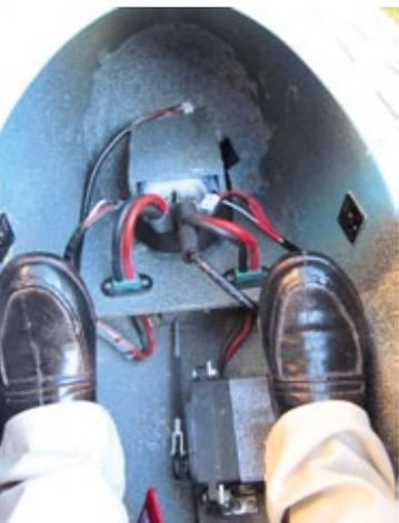
Vorne in der Rumpfnase befinden sich die beiden sicher verpackten Empfänger-Akkus
