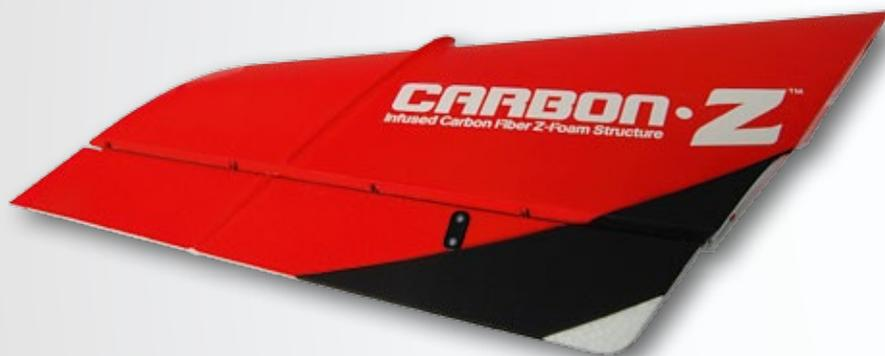
**Die kombinierten Höhen- und Querruder sind wie auch die Seitenrunder mit Ringscharnieren angeschlagen, durch dessen Ösen ein Kohlefaserstab gezogen wurde**
