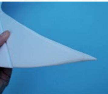
**Die Endleiste wird im äußeren Bereich der Elevons von der Unterseite her schräg angeschliffen**
