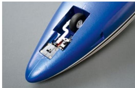
**Das Bugfahrwerk ist einziehbar und lenkbar**
