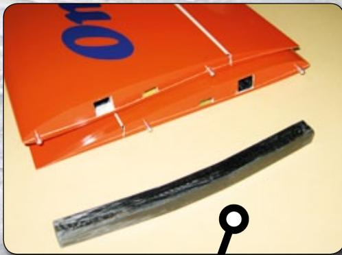
Bei den Tragflächen ist die Steckung betriebsfertig eingebaut. Die Vierkant CFK-Flächensteckung liegt bei
