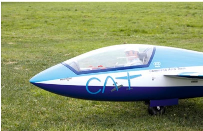
*Das weit ausgefahrene Fahrwerk stellt sicher, dass das Modell schnell aus dem Gras kommt und sicher hinter der Schleppmaschine stabilisiert werden kann.*
