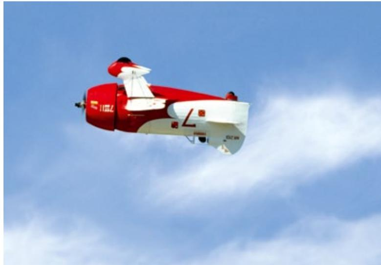
Die zweite Rennmaschine, die 1932 in Springfield entstanden war, trug die Bezeichnung R-2 und unterschied sich optisch kaum von der R-1. Im Gegensatz zur ersten war sie jedoch mit einem zierlicheren Pratt & Whitney R985-Triebwerk mit einem Durchmesser von nur 1,16 Meter und 535 PS ausgestattet, wodurch die Triebwerksverkleidung etwas stromlinienförmiger gestaltet werden konnte.
