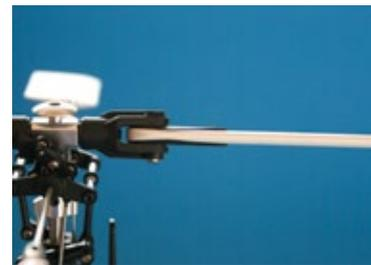
**Der Einstellwinkel mit maximal negativem Pitch, ungefähr -10 Grad – der Heli sinkt**
