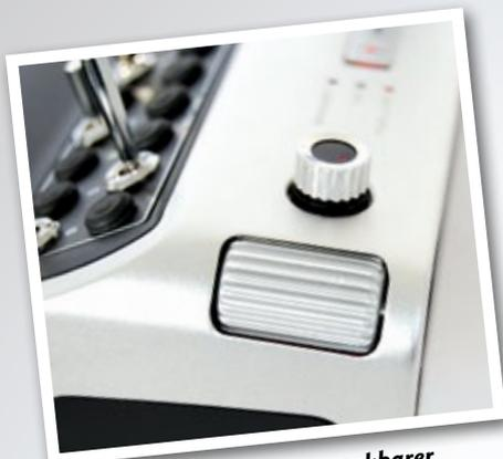
**Walzengeber und ein versenkbarer Drehknopf finden sich rechts und links oben am Eck des Alu-Gehäuses**
