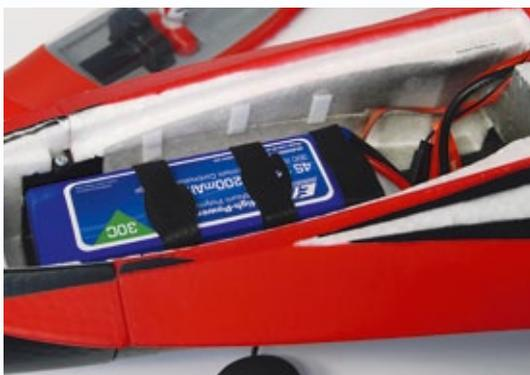
**Der 4s-LiPo passt bestens in die Rumpfspitze und wird von Klettbindern gehalten. Magnete dagegen halten die Kabinenhaube an Ort und Stelle**
