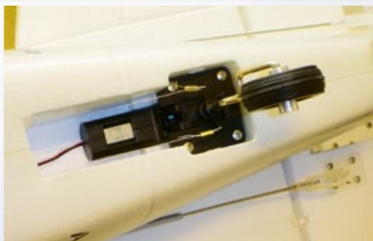
Die Steuerseile für das einziehbare Spornrad müssen passend abgelängt, verknotet und mit gequetschten Messinghülsen gesichert werden
