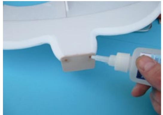
**Abschließend sind die Schaschlikspieße abzusägen, zu verschleifen und mit Sekundenkleber zu fixieren**
