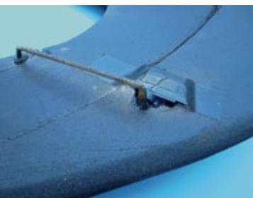
**Schaschlikspieße, Heißkleber und Schrumpfschlauch kamen bei der Ruderanlenkung zur Verwendung**
