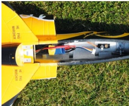
**Das Bugfahrwerksservo ist bereits eingebaut. Im Rumpf ist genügend Platz für einen 4s-LiPo**
