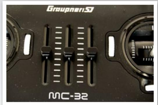
In der Mitte des Senders befinden sich drei Schieberegler, mit denen man zum Beispiel auch den Gaslimiter bedienen könnte. Sie sind frei belegbar
