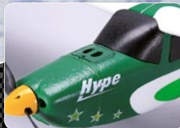
Der Antrieb des U-Can-Fly-Trainers erfolgt durch ein LiPo-Brushless-Power-System, das perfekt auf das Modell abgestimmt ist. Der Wechsel des Antriebsakkus erfolgt einfach und bequem über einen Deckel auf der Rumpfoberseite.
