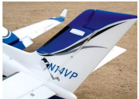
*Das Servo für das Seitenruder ist im Seitenleitwerk untergebracht*
