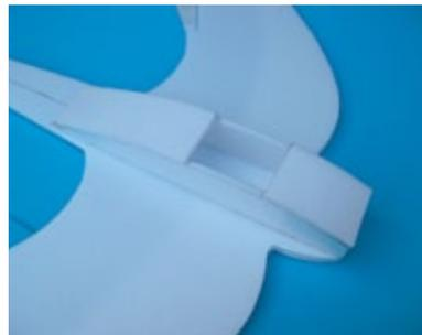
Vorderer und hinterer Rumpfboden schließen und stabilisieren den Rumpf
