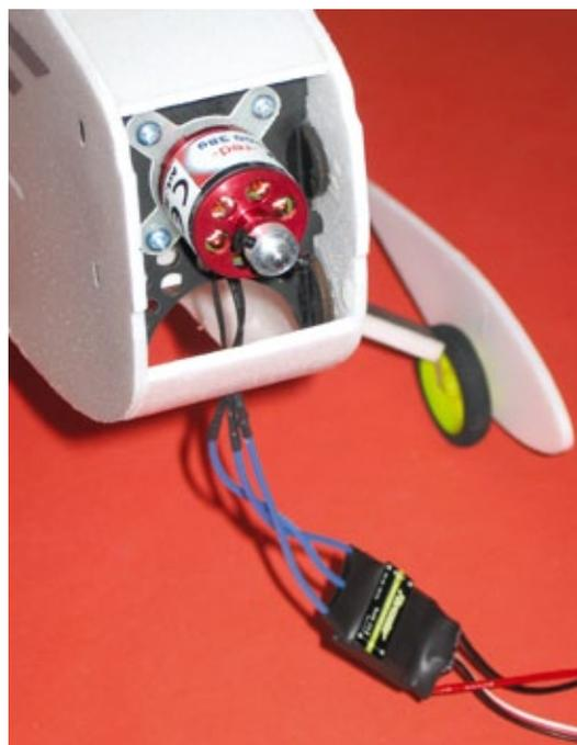
**Der Motor wird vorne über ein mitgeliefertes GFK-Befestigungskreuz mit dem Rumpf verschraubt**
