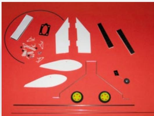
**Zum Kleinteilesatz gehören das vorgebogene Fahrwerk, leichte Kunststoffräder und sämtliches Material für die Ruderanlenkungen**
