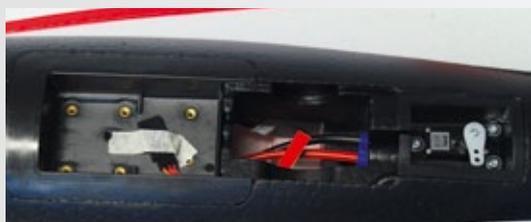
**Die Fahrwerksaufnahmen sind bereits für den Einbau der Einziehfahrwerke vorbereitet**
