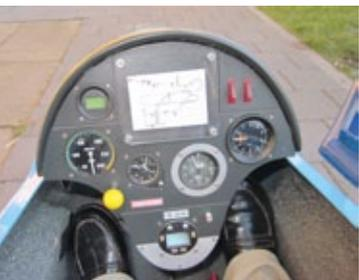
Das vorbildgetreue Panel lässt sich über zwei Schrauben lösen und entfernen, um den Zugang zu den dahinterliegenden Akkus freizulegen
