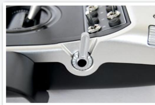
**Der seitliche Geber ist gerastet und besitzt einen deutlichen Mittenpunkt. Das prädestiniert ihn für Gasvorgaben von Drehzahlregler**
