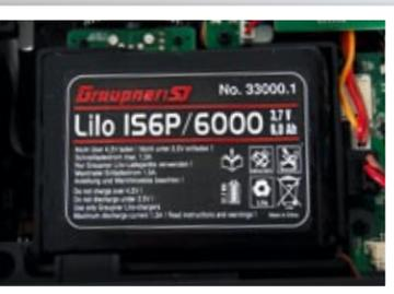
**Der 1s-LiPo mit satten 6.000 Milliamperestunden Kapazität genügt für Sender-Betriebszeiten von mindestens fünf Stunden**
