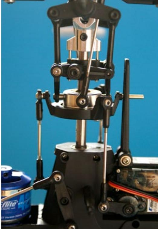
◀ **Die Taumelscheibe in waagerechter Ausrichtung. Der Hubschrauber schwebt, zumindest für kurze Zeit, stationär ohne Beschleunigung in eine Richtung**
