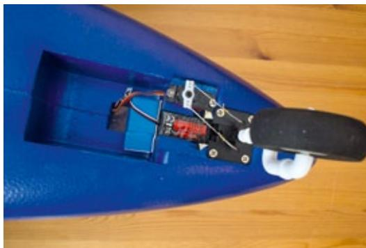
*Das Hauptfahrwerk wird elektrisch eingefahren*
