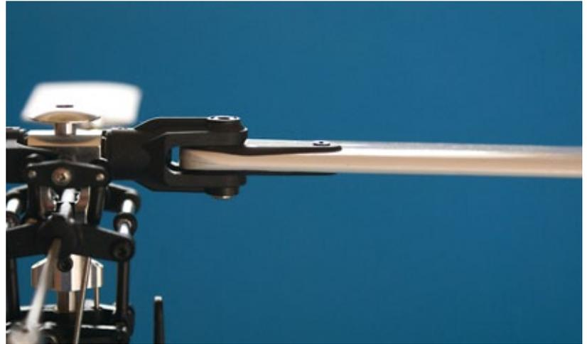
**Der Einstellwinkel des Blatthalters und damit auch des Rotorblatts auf etwa null Grad**
