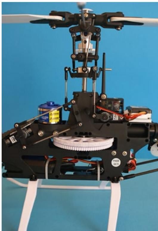
**Das einstufige Getriebe:** Das Motorritzel greift direkt in das Hauptzahnrad, mit Hauptrotorwelle, Taumelscheibe, Pitchkompensator, Stabilisierungsstangenmikromik und Rotorkopf
