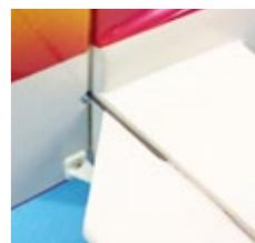
**Bei kleineren Modellen, deren Höhenruderhälften mittels eines dünnen Stahldrahts miteinander verbunden sind, muss geprüft werden, ob die Verbindung genügend torsionsfest ist**
