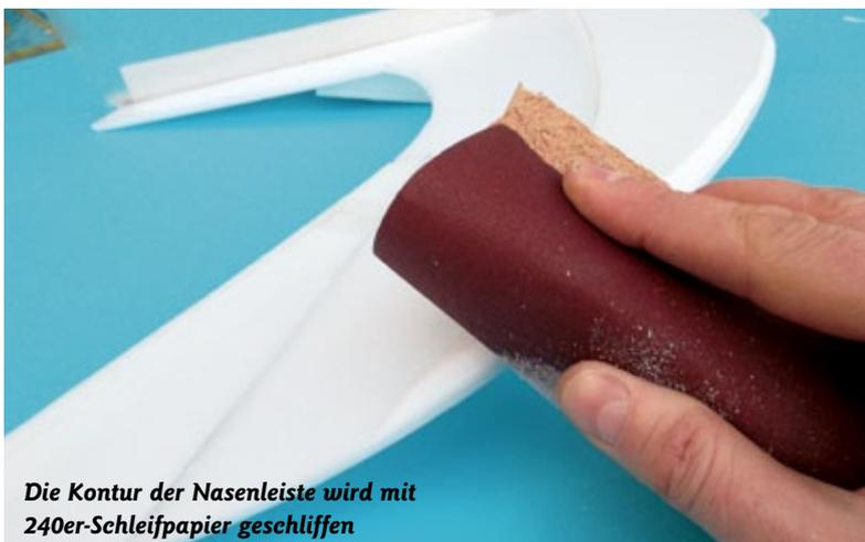
Die Kontur der Nasensteife wird mit 240er-Schleifpapier geschliffen
