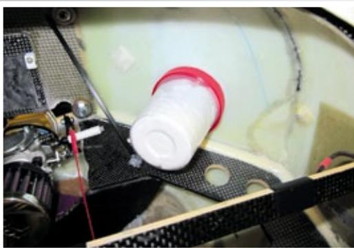
**Die Dose für den Auswurf des Öls aus der Überdruckleitung**
