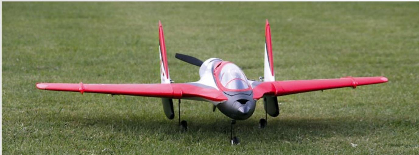
**Das optionale Bugfahrwerk schwenkt mit einem eigenen Motor aus und ist natürlich auch lenkbar**
