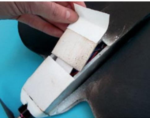
Vorne greift die Akkuklappe über eine Zunge in den Rumpf, hinten hält sie mit Tape
