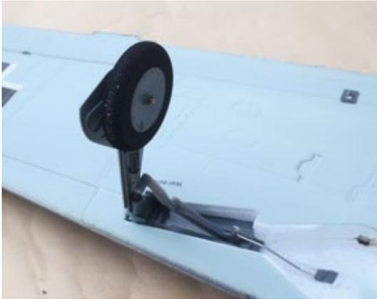
**Das mechanische Einziehfahrwerk ist fertig montiert, reichlich detailliert und funktioniert gut**
