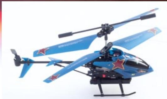
**Die Nickfunktion übernimmt der kleine, nach oben gerichtete Heckrotor. Die Drehung um die Hochachse (Çier) wird über die unterschiedliche Drehzahl der beiden Hauptrotoren realisiert**
