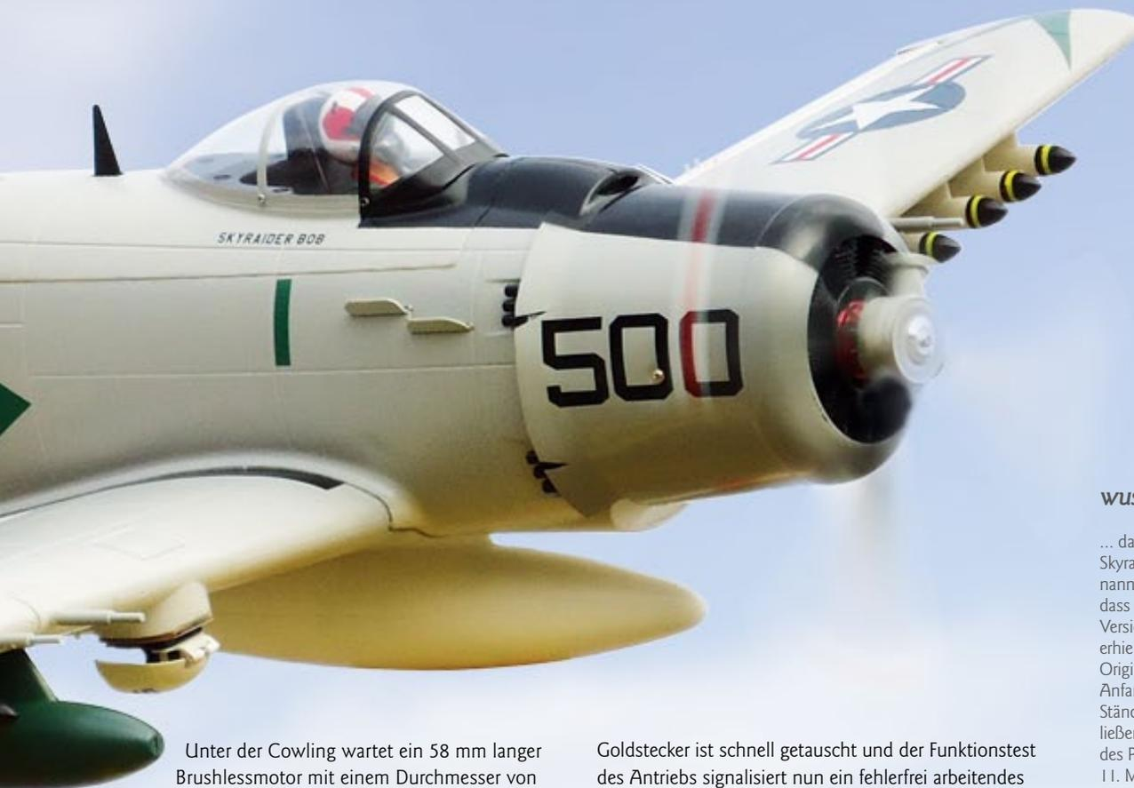
Unter der Cowling wartet ein 58 mm langer Brushlessmotor mit einem Durchmesser von 42 mm und einer spezifischen Drehzahl von 400 Umdrehungen in der Minute pro Volt auf seinen Einsatz. Vorher muss jedoch eine gelöste Verbindung bei einem der 3,5-mm-Goldkontaktstecker zwischen Motor und Regler untersucht werden. Leider verhindert die Akkuaufgabe trotz Sichtkontakt einen direkt Zugriff, sodass der Ausbau des gesamten Antriebsstrangs ansteht.
