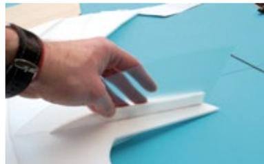
Die Depronleiste dient zur Befestigung und Stabilisierung der durchsichtigen Seitenflosse
