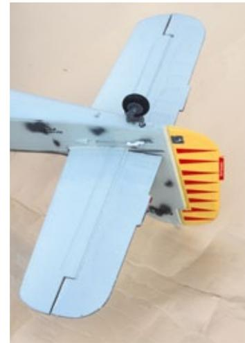
**Das Höhenleitwerk wird von unten mit einer langen Schraube gesichert.**
