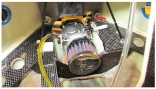
Hier der K+N-Filter auf dem Valach-Vergaser. Der durchtrennte Spant wird wieder mit einem neuen abgefangen
