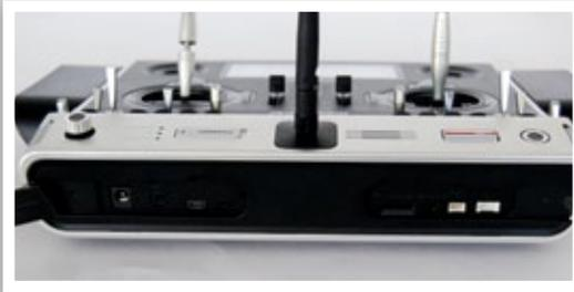
*An der Stirnseite der mc-32 liegen noch insgesamt acht Schnittstellen unter zwei Abdeckungen verborgen. Von links nach rechts: Ladebuchse, Lehrer-Schüler-Buchse, Mini-USB-Schnittstelle, Data-Anschluss für die Smart-Box, Micro-SD-Slot, Kopfhörer-Anschluss, Buchse für den Anschluss eines externen HF-Moduls und die SPI-Schnittstelle, die zurzeit noch nicht belegt ist*
