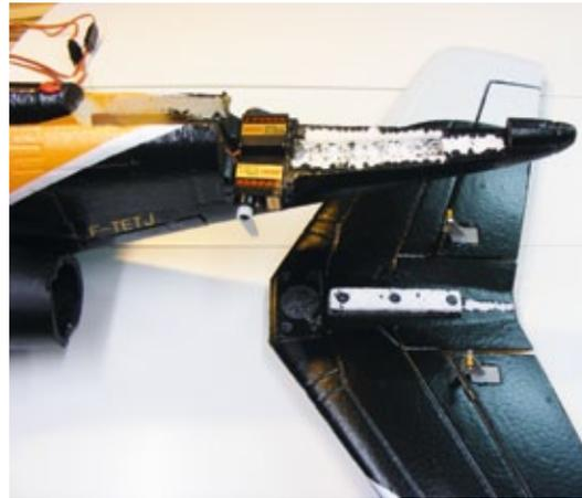
**Bei allen Klebestellen sollte vorher unbedingt der Lack abgekratzt werden, zum Beispiel beim Einkleben von Flügel und Höhenleitwerk**
