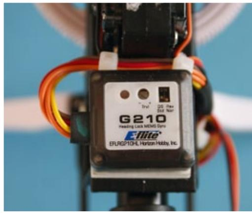
**Der Gyro (Kreisel) ist für die Heckrotorsteuerung verantwortlich. Er ist schwingungsgedämpft (Klebepad) über dem Heckrohr befestigt**
