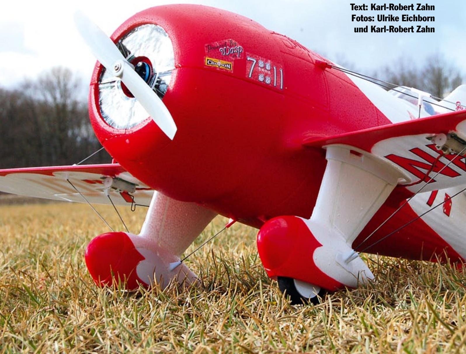
Die GeeBee zeichnet sich ja weder im Original noch im Modell als besonders gutmütiges Flugzeug aus. Ein dicker Rumpf, dessen Frontgröße im Original der kräftige Sternmotor bestimmt, ein Tragwerk, das nicht mehr als unbedingt nötig Auftrieb erzeugt, und die kleine Pilotenkanzel kurz vor dem Seitenleitwerk sind die markantesten Merkmale des Racers.
