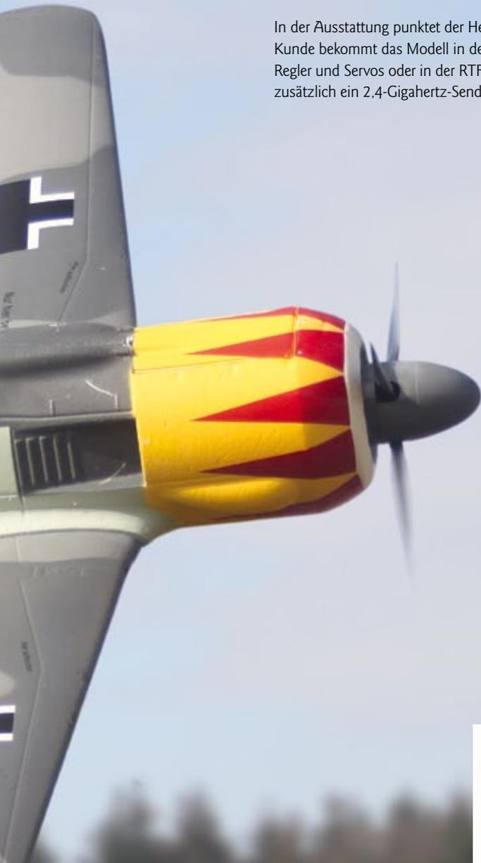
Viele Anbieter führen eine FW-190 in ihrem Programm. Entsprechend groß ist die Vielfalt in Bezug auf das Material und die Größe des Modells. LRP bietet seine Version in geschäumter Ausführung aus EPO an, das durch seine tadellose Oberfläche voll überzeugen kann. Auch die Wahl der Spannweite mit 1.1300 Millimeter passt, da man das Modell zusammengebaut in den meisten PKW transportieren kann.
