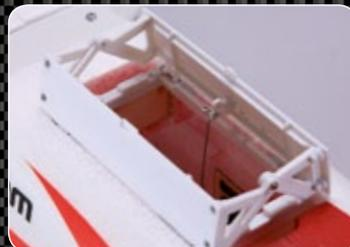
Die Klappenmechanik der Ladeluke wird über ein Servo angelenkt. Sowohl die Ladeluke als auch das Servo und die Anlenkung sind im Modell fertig eingebaut. Über den Sender kann die Luke im Flug geöffnet werden.
