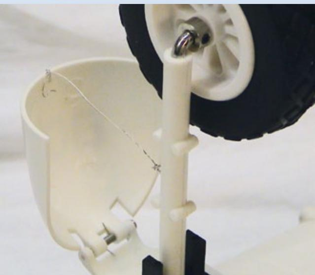
**Die bewegliche Klappe am Fahrwerk wird durch eine Feder unter Spannung gehalten und von einem feinen Draht geführt**
