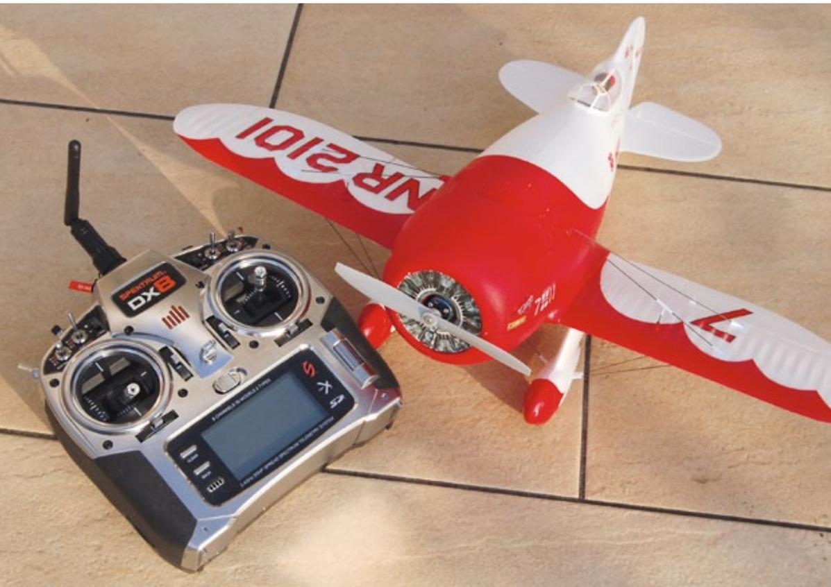
**510 Millimeter Spannweite ist wirklich nicht viel. Jeder Spektrum-Sender mit DSM2-Technik eignet sich zum Steuern des Modells**
